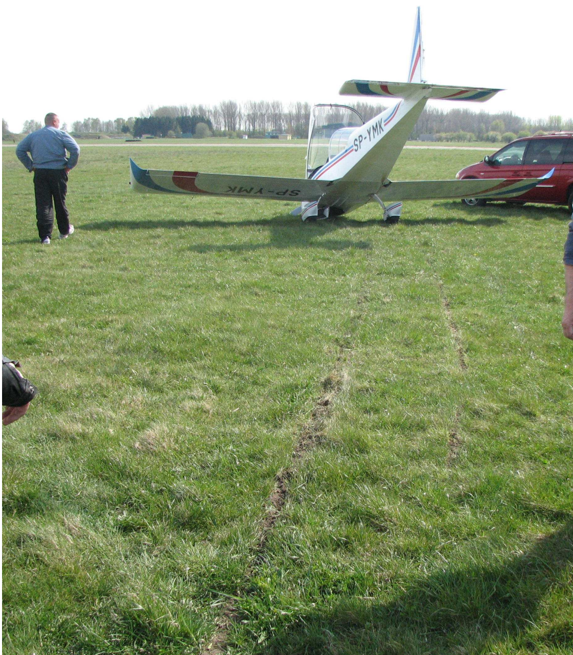
Fot. 5 Ślady pozostawione przez uszkodzoną goleń przedniego podwozia po jej złamaniu.
