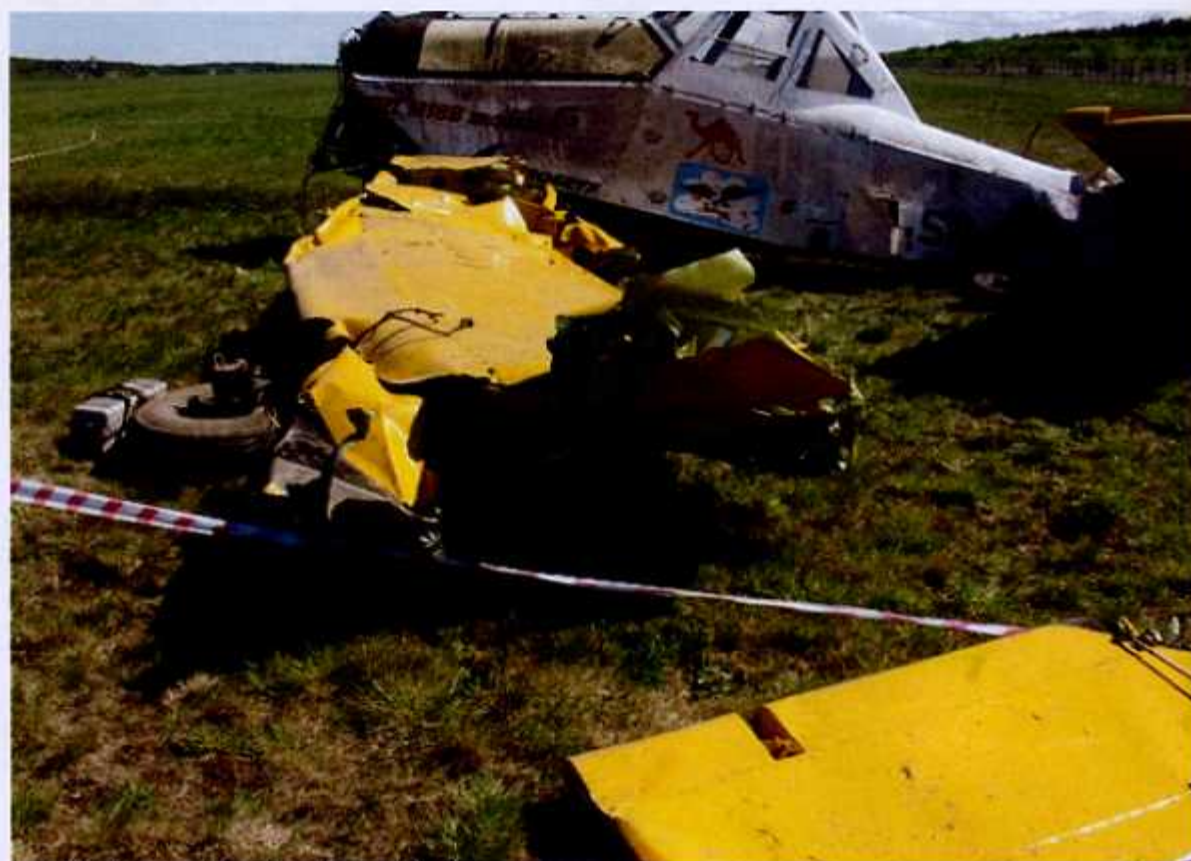
Fot. 14. Zniszczone lewe skrzydło samolotu.
