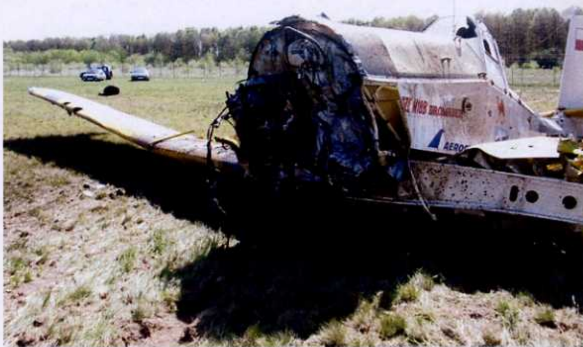
Fot. 11. Przegroda ogniowa z resztkami łoża silnika i instalacji zespołu napędowego.
