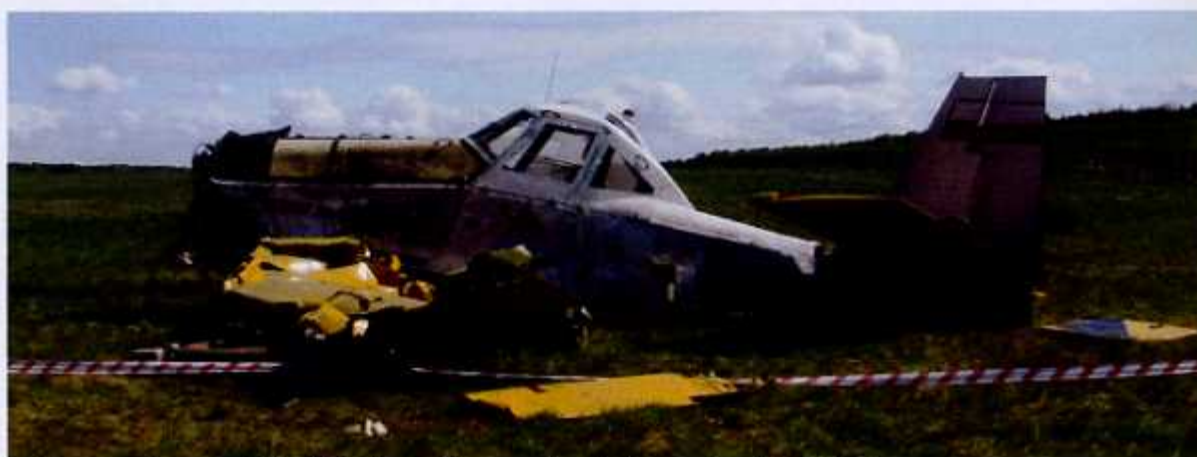
Fot. 4. Lewa strona samolotu; zbliżenie na zniszczone skrzydło lewe – patrz dalsze zdjęcia.
