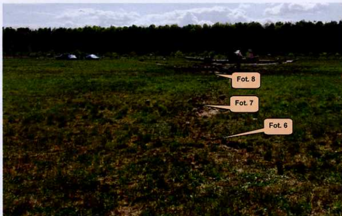
Fot. 5. Ślad jaki zostawiło lewe skrzydło i przód (zespół napędowy) samolotu; zbliżenia – patrz dalsze zdjęcia.
