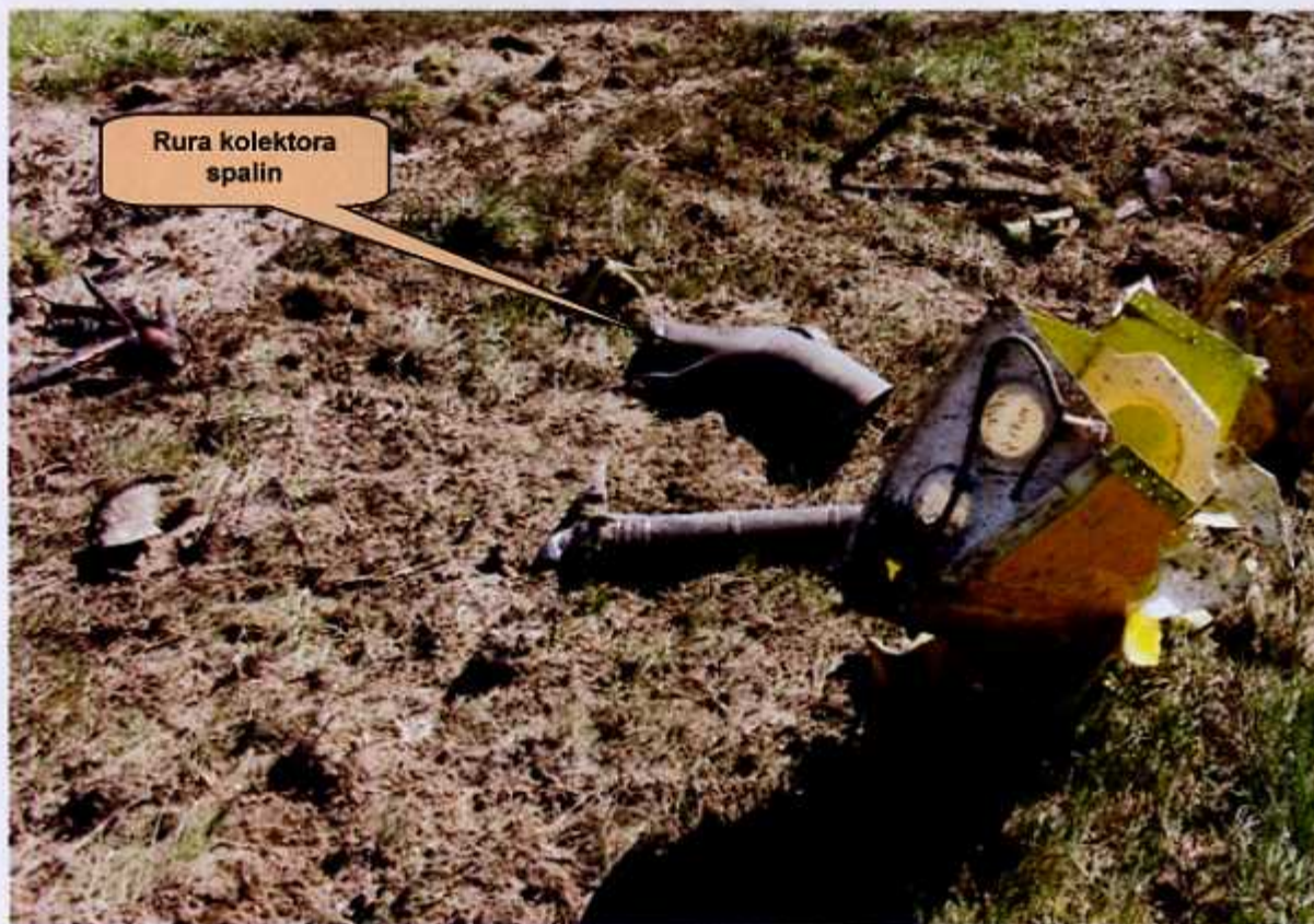
Fot. 10. Rura kolektora spalin; od tego miejsca są wyraźne ślady oleju na trawie.
