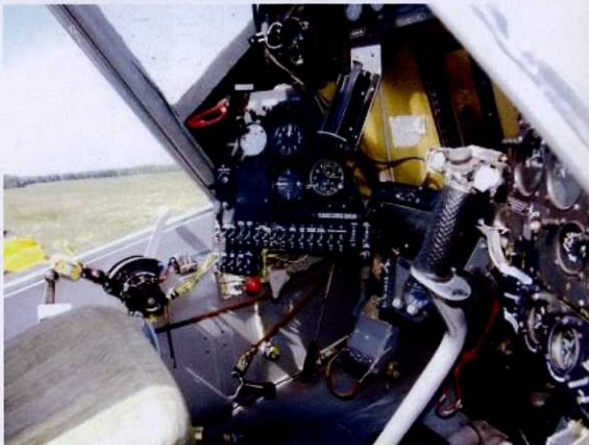
Fot.17. Wnętrze kabiny z lewej strony. Dźwignia sterowania trymerem steru wysokości w przednim położeniu.
