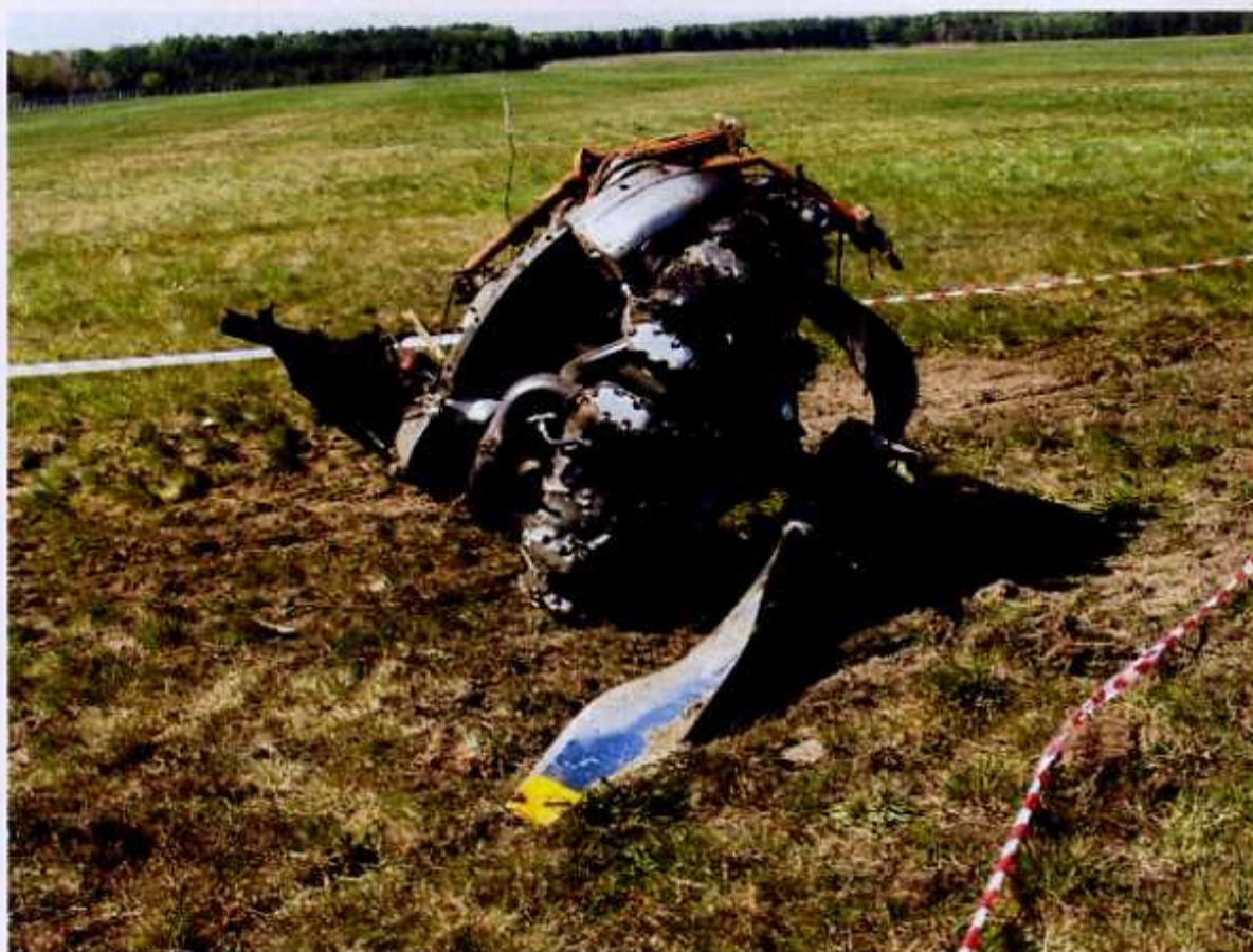
Fot. 12. Oddzielony od samolotu silnik ze śmigłem
