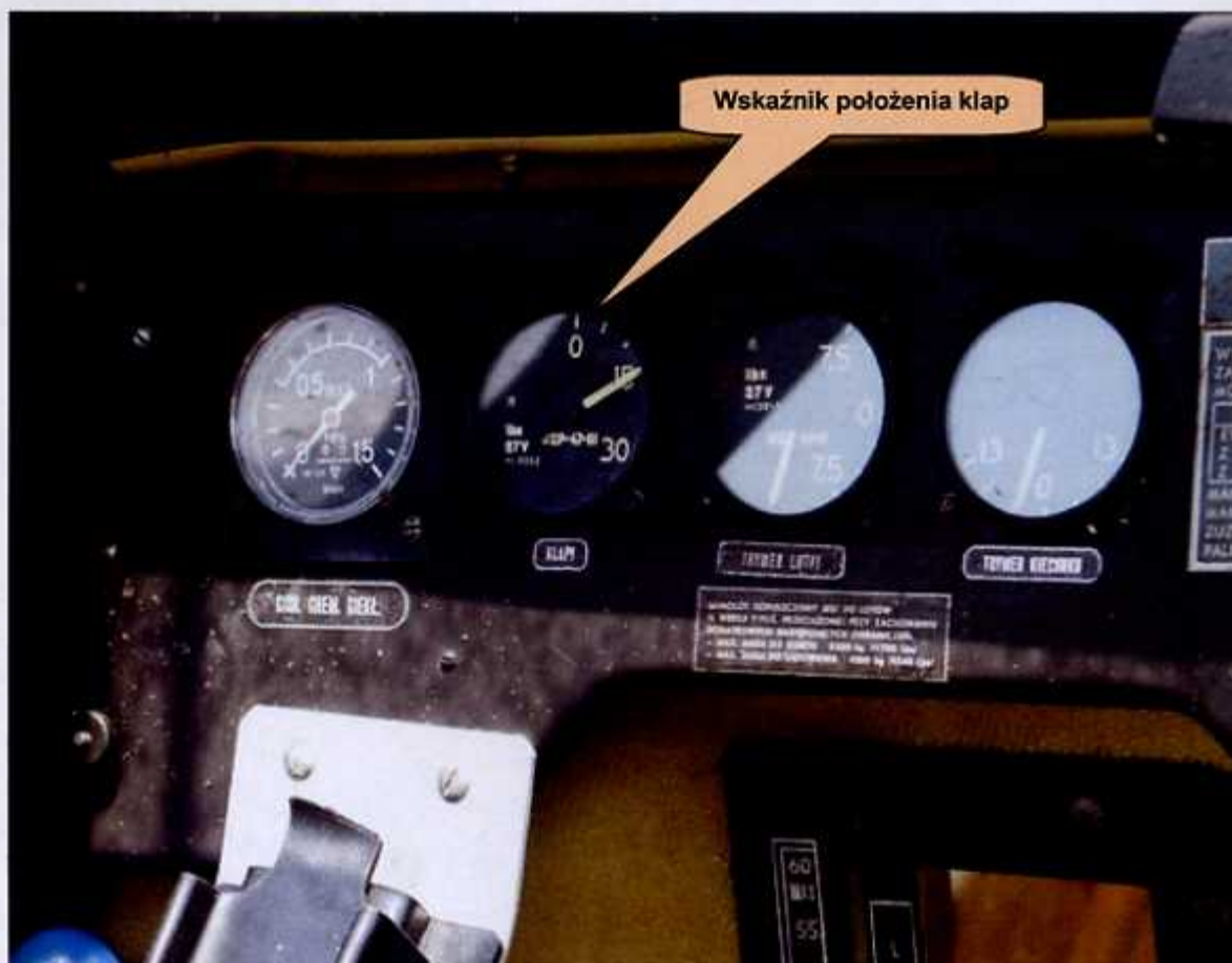
Fot. 19. Tablica przyrządów, część środkowa - wskaźnik położenia klap wskazuje 15°.
