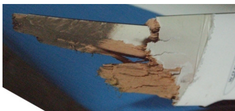
16, 17, 18, 19 – Końcowe fragmenty połamanych pozostałych łopat śmigła, pokazane od przodu (górne zdjęcia) i od tyłu (dolne zdjęcia)
