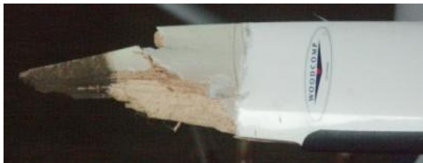
14 – Kołpak śmigła, widoczna wyłamana u nasady łopata.
