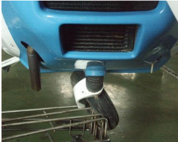
12, 13 – Złamane podwozie przednie pokazane od przodu (po lewej) i z lewej strony (prawe zdjęcie).
