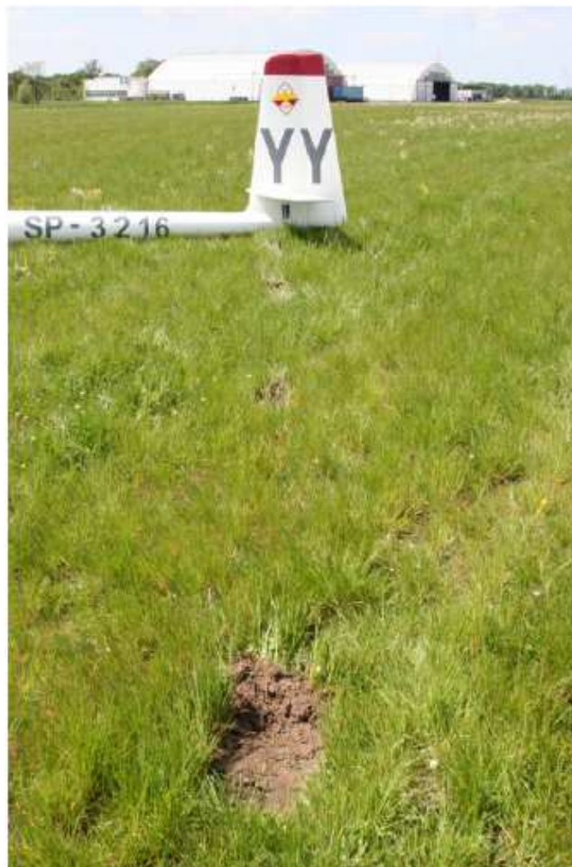
Rys. 2. Ślady uderzenia koła ogonowego przed zatrzymaniem.
