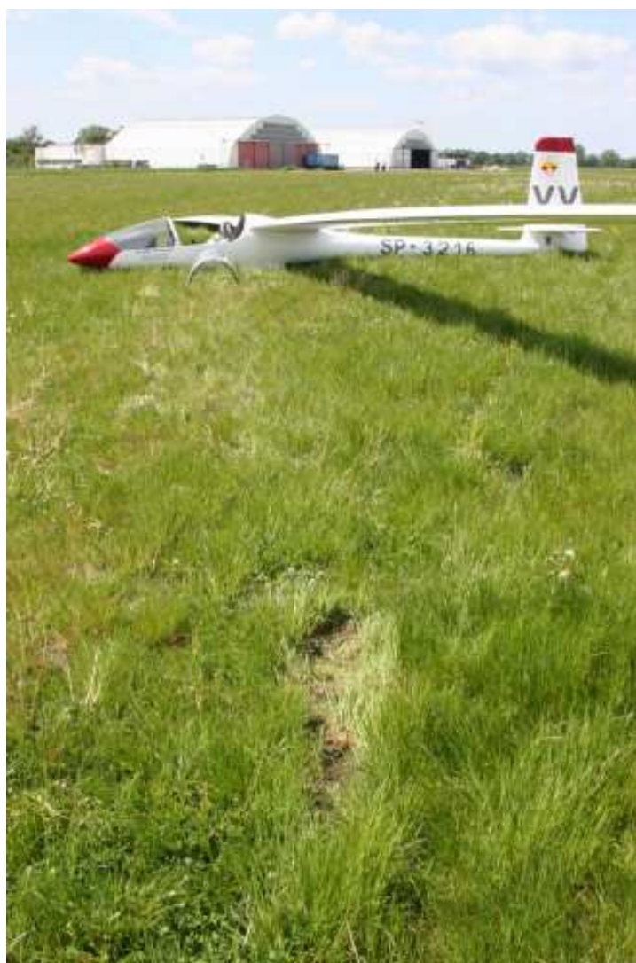
Rys. 1. Ślad uderzenia koła głównego 11 m przed zatrzymaniem.
