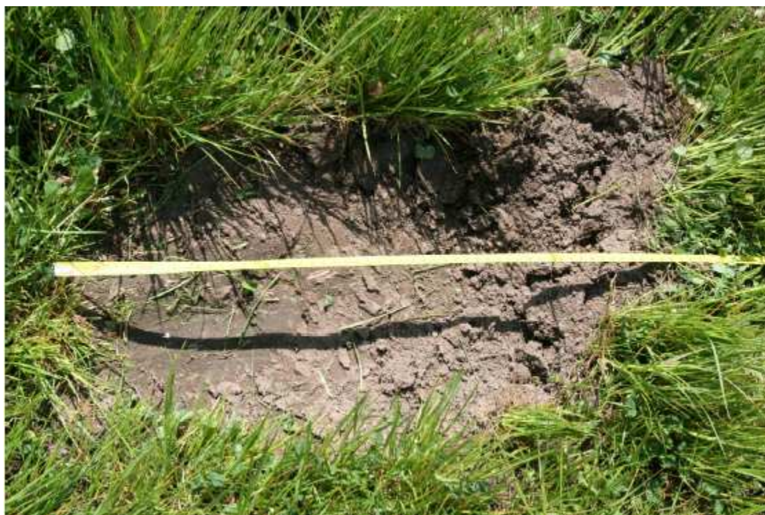
Rys. 3. Pierwszy ślad uderzenia koła ogonowego długości 54 cm.
