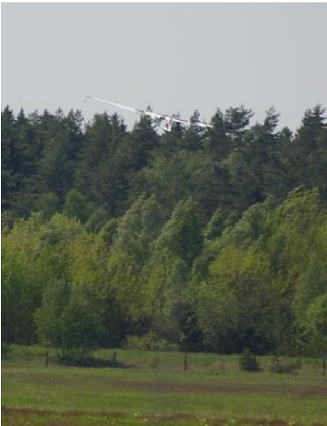
15 – Początek wejścia w prawy korkociąg wskutek przeciągnięcia [J]. Prawe skrzydło ominęło już pierwsze wysokie drzewa i opada poniżej poziomu ich koron. Hamulce aerodynamiczne cały czas otwarte. Widać pochylone bocznym wiatrem wierzchołki drzew. [fot.P.Paczkowski].
