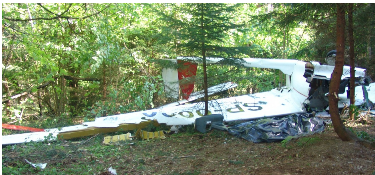
32 – Widok lewego skrzydła motoszybowca – widać zniszczenia kesonu noskowego i odsłonięty dźwigar [fot.AWM].
