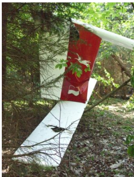
69 i 70 – Usterzenie. Widoczne ukłucie statecznika pionowego, przebicia statecznika poziomego, złamany prawy oraz oderwany lewy segment steru wysokości [fot.PKBWL].
