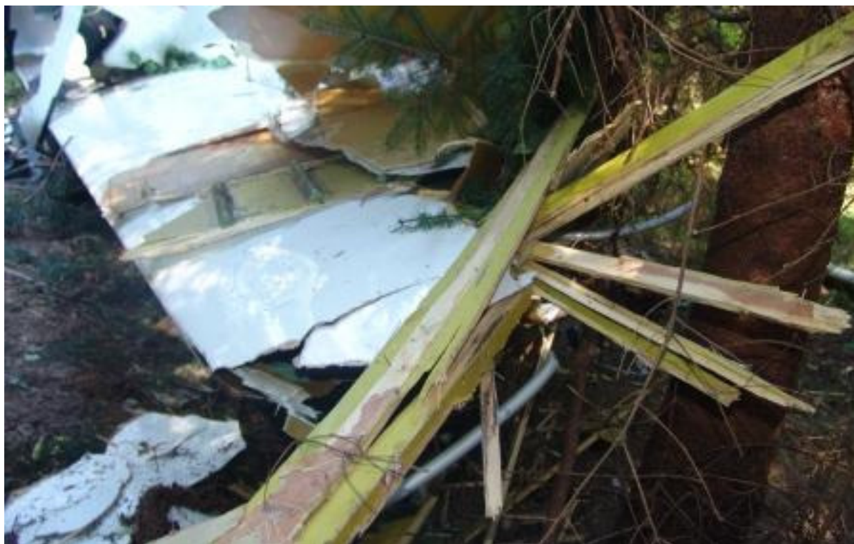
39 – Przełom prawego skrzydła – widać rozszczepiony i rozklejony dźwigar i pogięty popychacz lotki [fot.PKBWL].
