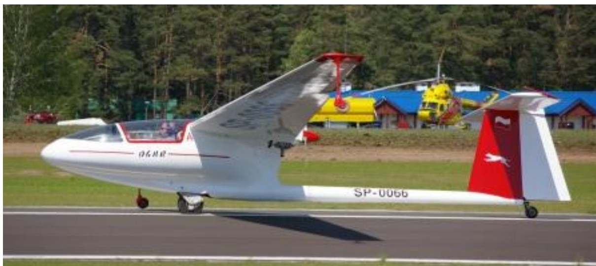
5 – Kontynuacja rozbiegu [C] – widać silnie ugięty pneumatyk podwozia głównego [fot.P.Paczkowski].
