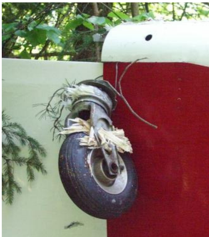
73 – Oderwane od kadłuba podwozie tylne [fot.PKBWL].
