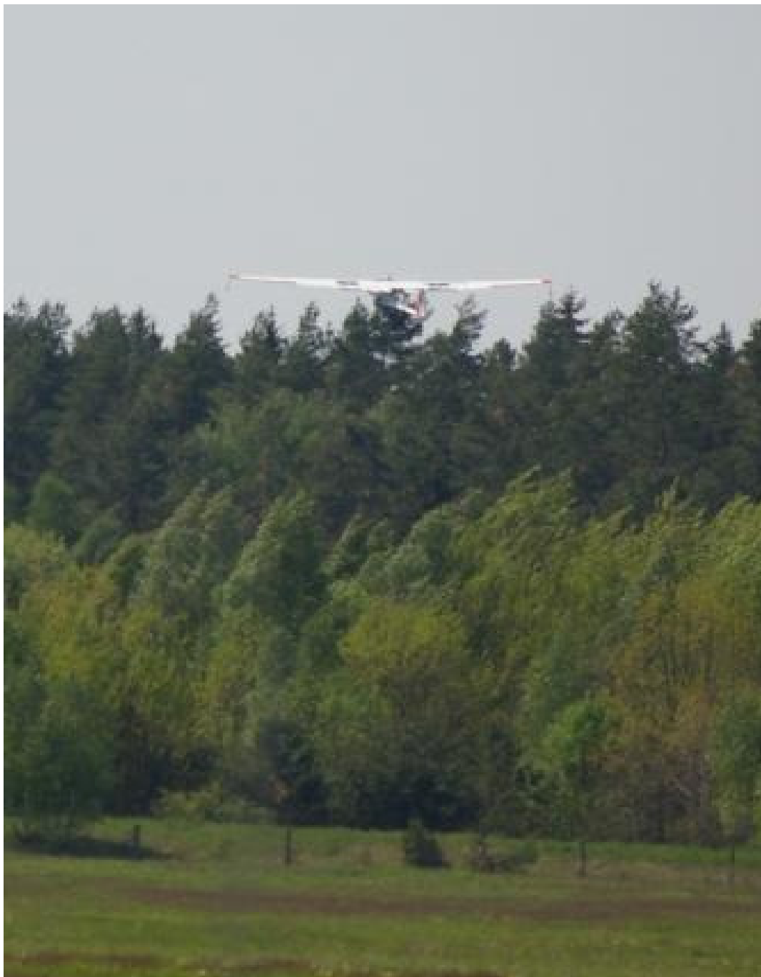
13 – Wejście na wysokość ok.25 m [I] ze znaczną utratą prędkości wskutek wymuszonego naboru wysokości w celu „przeskoczenia” nad koronami drzew. Hamulce aerodynamiczne cały czas otwarte. Widać pochylone bocznym wiatrem wierzchołki drzew. [fot.P.Paczkowski]
