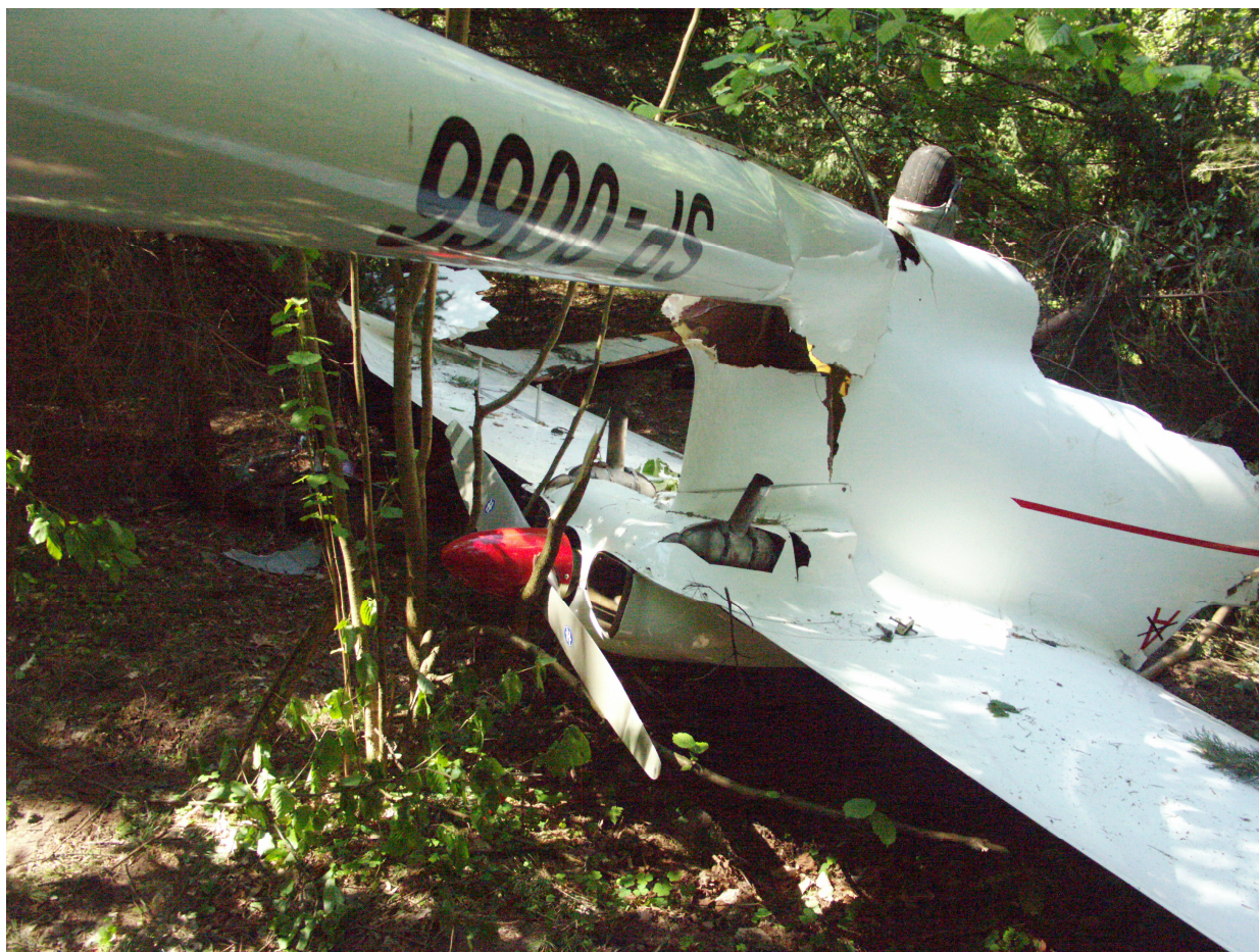
46 – Widok na gondolę kadłuba, belkę ogonową i zespół napędowy. Widoczne liczne i rozległe uszkodzenia [fot.AWM].
