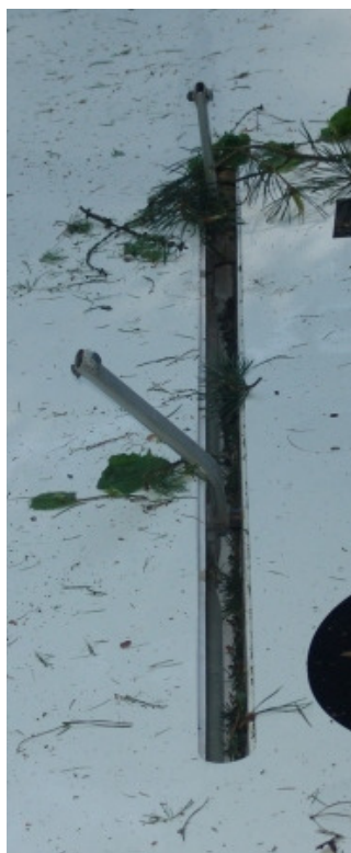
54 – Zgięty wahacz płyty hamulca [fot.PKBWL].
