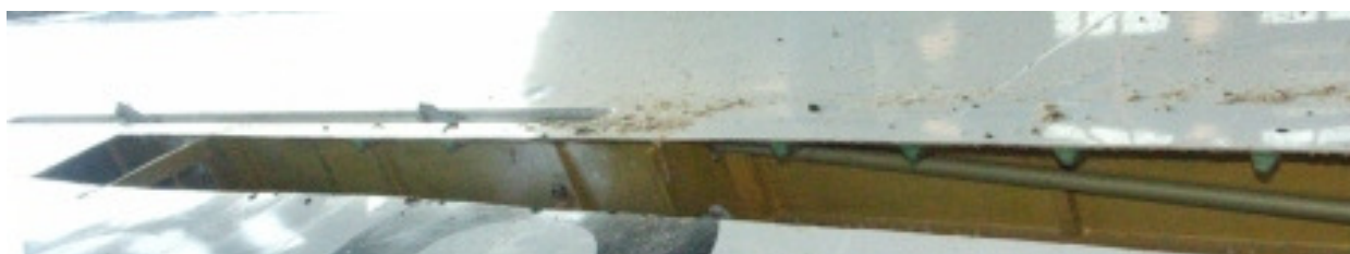
80 – Keson lewego skrzydła otwarty dla stwierdzenia ciągłości układów sterowania [fot.PKBWL].
