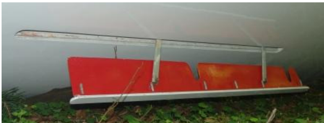
45 – Otwarta lewa górna płyta hamulca aerodynamicznego, nadal zamocowana na wahaczach [fot.AWM].
