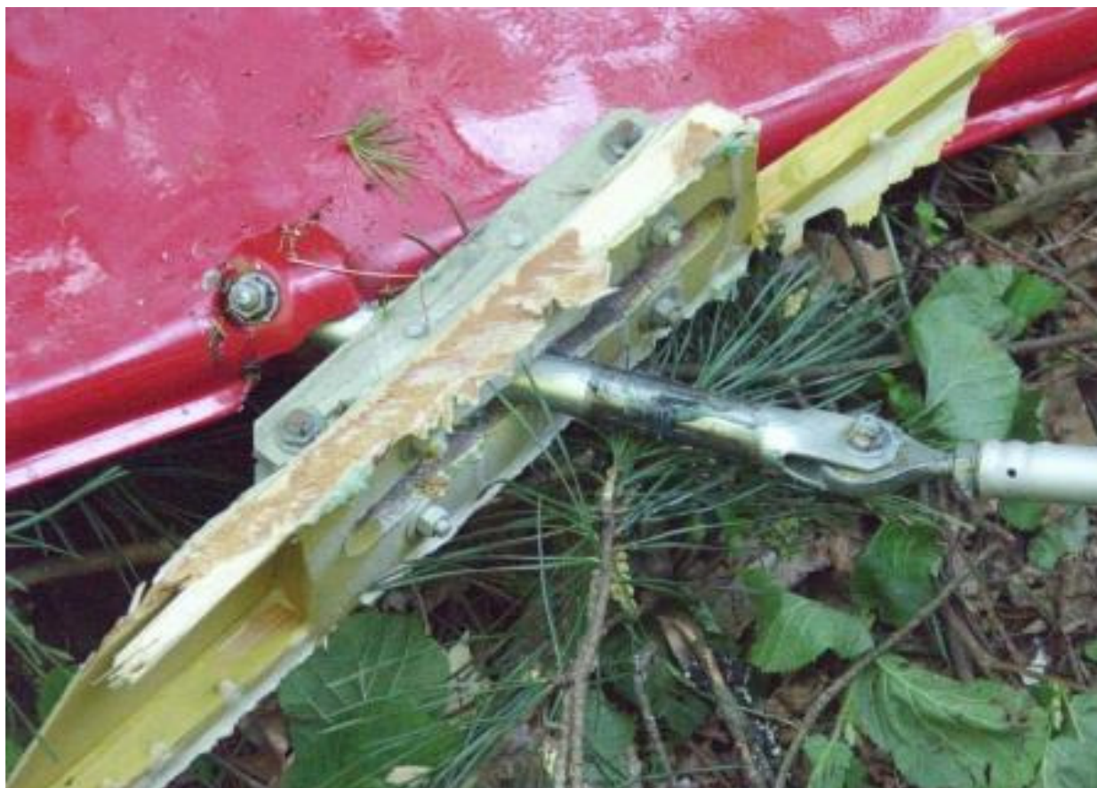
51 – Wyrwany ze struktury płata wspornik i popychacz napędu lewej lotki [fot.PKBWL].
