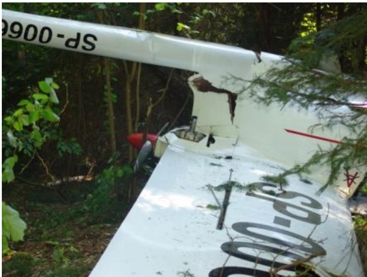
48 – Widok z lewej na gondolę kadłuba, belkę ogonową i zespół napędowy z rozległymi uszkodzeniami [fot.PKBWL].
