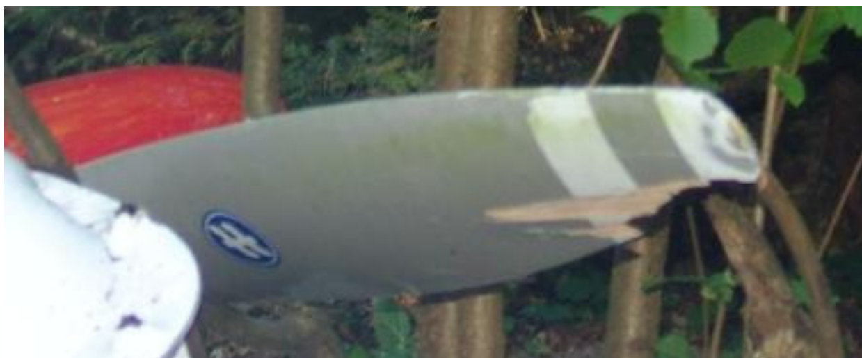
43 – Uszkodzona końcówka jednej z łopat śmigła [fot.PKBWL].
