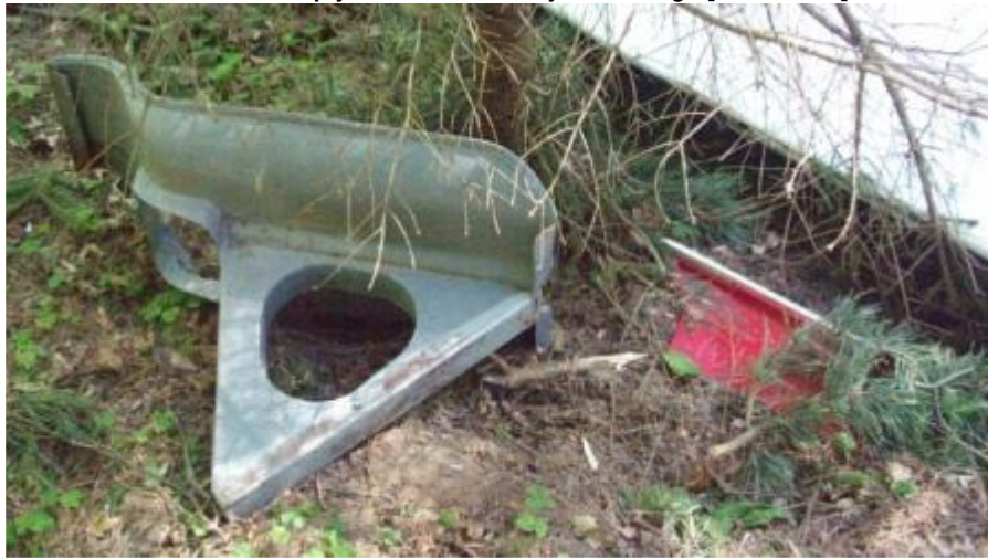
55 – Oparcie lewego fotela i fragment połamanej dolnej lewej płyty hamulca aerodynamicznego [fot.PKBWL]
