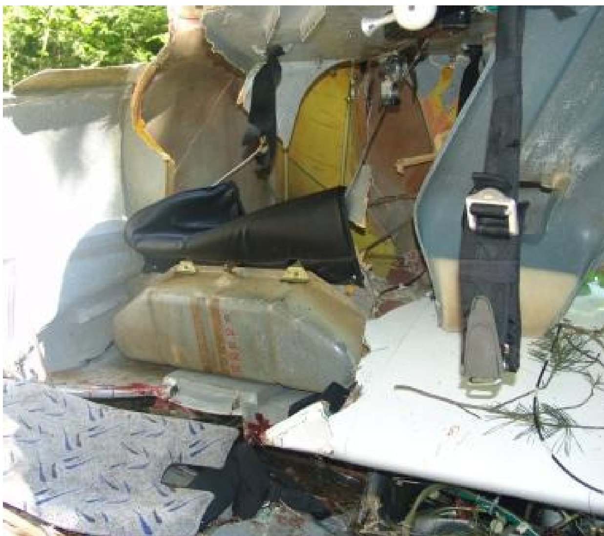
58 – Wnętrze zniszczonej gondoli kabiny – widoczny zbiornik paliwa i rozcięte pasy bezpieczeństwa [fot.AWM].
