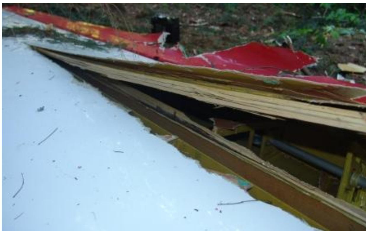
40 – Zbliżenie na rozerwany fragment kesonu prawego skrzydła. Wewnątrz kesonu widoczny popychacz sterowania lotką [fot.PKBWL].
