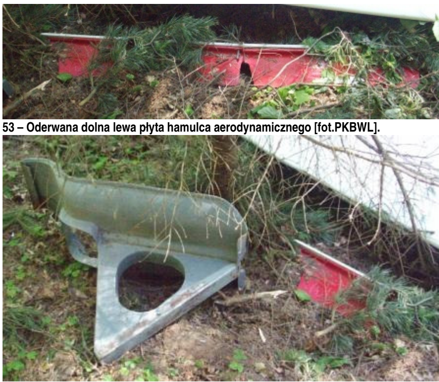
55 – Oparcie lewego fotela i fragment połamanej dolnej lewej płyty hamulca aerodynamicznego [fot.PKBWL]
