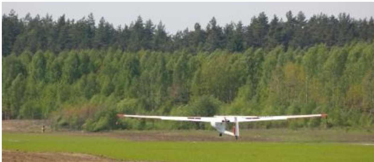
9 – Zwiększenie kąta natarcia po oderwaniu od pasa [G] – widać „wyssane” hamulce aerodynamiczne i skutki boczego wiatru – pochylone wierzchołki drzew [fot.P.Paczkowski].
