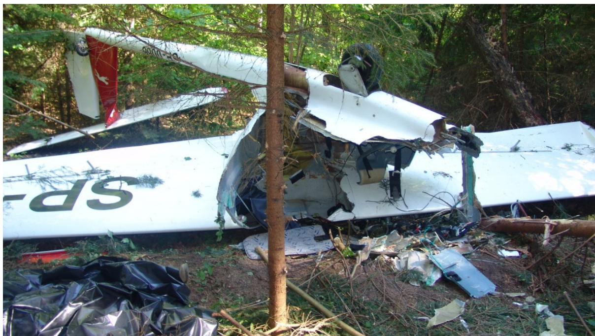
35 – Ogólny widok motoszybowca 3/4 z przodu od lewej. Widać całkowicie zniszczoną kabinę załogi. [fot.AWM]
