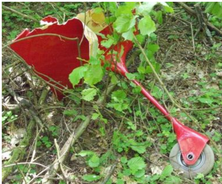
33 – Lewe podwozie podporowe z fragmentem skrzydła [fot.PKBWL].
