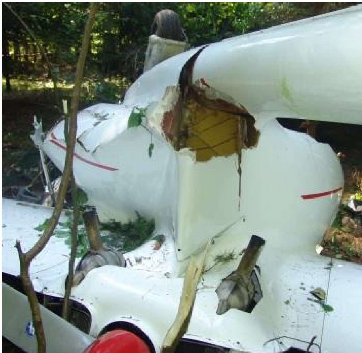
44 – Widok od tyłu na rozerwaną gondolę kadłuba [fot.AWM].
