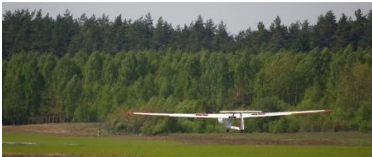
11 – Początek wznoszenia [H] – widać „wyssane” hamulce aerodynamiczne [fot.P.Paczkowski].
