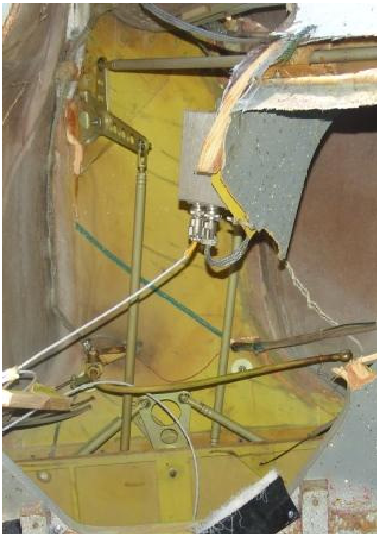
67 - Tylna część gondoli kadłubowej – widoczne nieuszkodzone połączenia popychaczy sterowania i odłączony od zdemontowanego zbiornika przewód paliwowy [fot.AWM].
