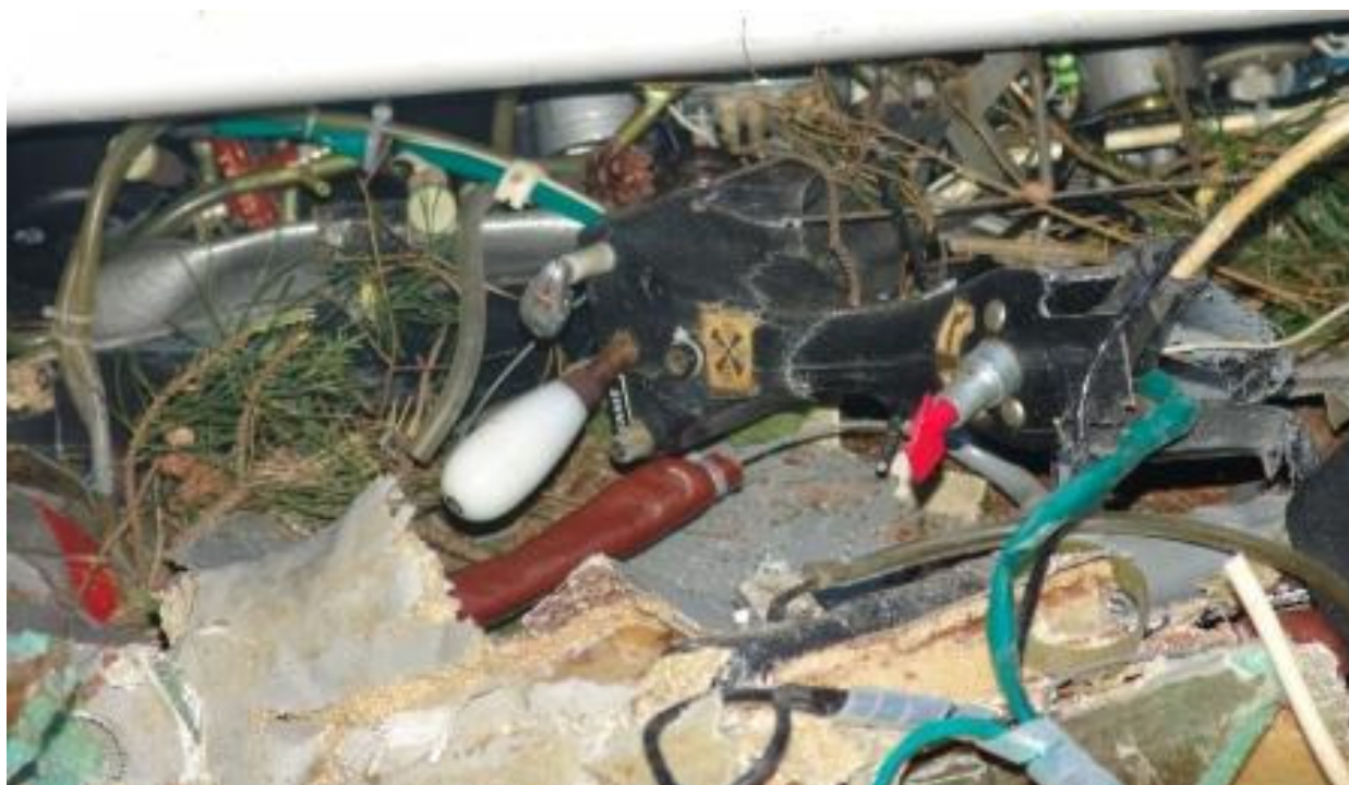
62 – Szczątki wyposażenia kabiny – widać przyciśniętą kadłubem tablicę przyrządów i zespół manetek sterowania silnikiem [fot.AWM].
