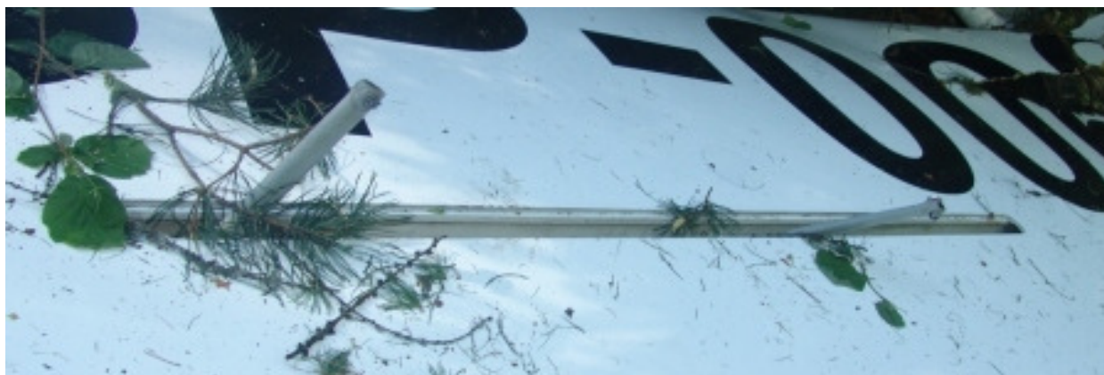
52 – Szczelina oderwanej dolnej lewej płyty hamulca aerodynamicznego – widoczne uszkodzone wahacze [fot.PKBWL].
