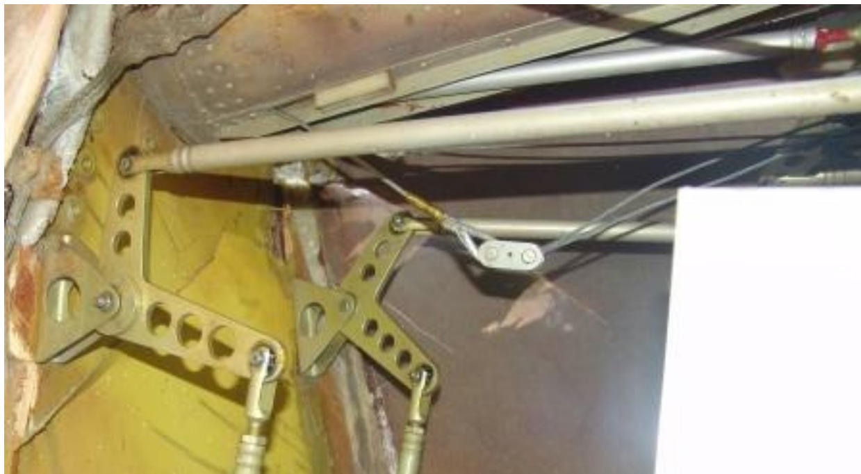
68 – Dźwignie kątowe i popychacze sterowania po bokach gondoli kabiny [fot.AWM].
