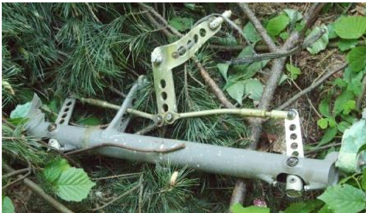
66 – Poprzeczna rura skrętna układu sterowania płotowcem w kabinie, z popychaczami, resztkami dźwigni i drążków sterowych [fot.PKBWL].
