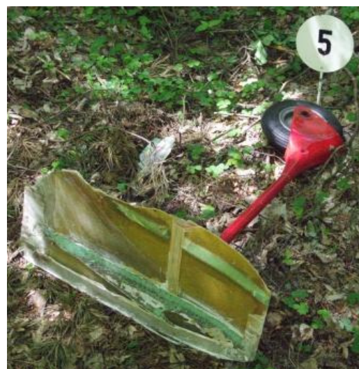
27 i 28 – Prawe podwozie podporowe, wyrwane z fragmentem końcówki skrzydła [fot.PKBWL].
