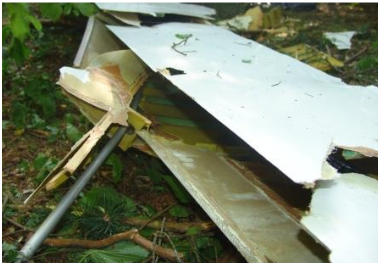
49 – Zniszczona struktura kesonu lewego skrzydła w części tylnej. Widoczny zgięty popychacz lotki [fot.AWM].
