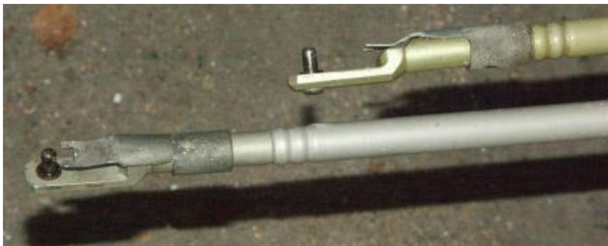
79 – Końcówki popychaczy lotek (dolny) i hamulców aerodynamicznych (górny) prawego skrzydła [fot.PKBWL].
