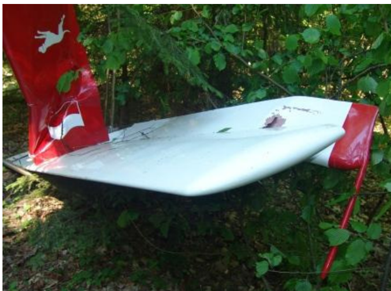
69 i 70 – Usterzenie. Widoczne ukłucie statecznika pionowego, przebicia statecznika poziomego, złamany prawy oraz oderwany lewy segment steru wysokości [fot.PKBWL].
