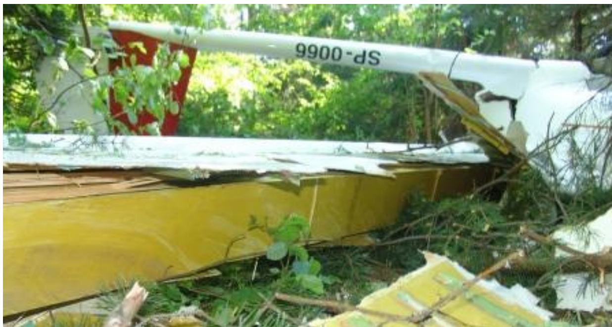
57 – Uszkodzenia noska i dźwigara lewego skrzydła na zbliżeniu [fot.AWM].
