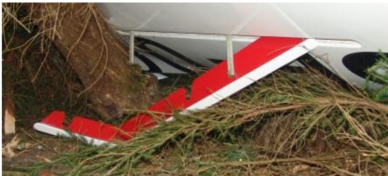
41 – Połamana prawa górna płyta hamulca aerodynamicznego, wciąż zamocowana na jednym wahaczu [fot.AWM].
