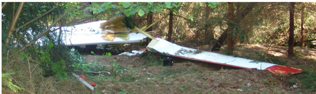
36 – Widok na prawe skrzydło motoszybowca, złamane i ukręcone [fot.PKBWL].
