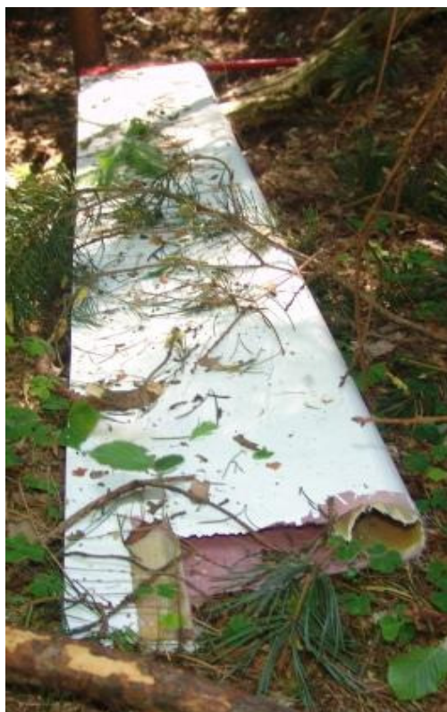
72 – Oderwana część steru wysokości [fot.AWM].
