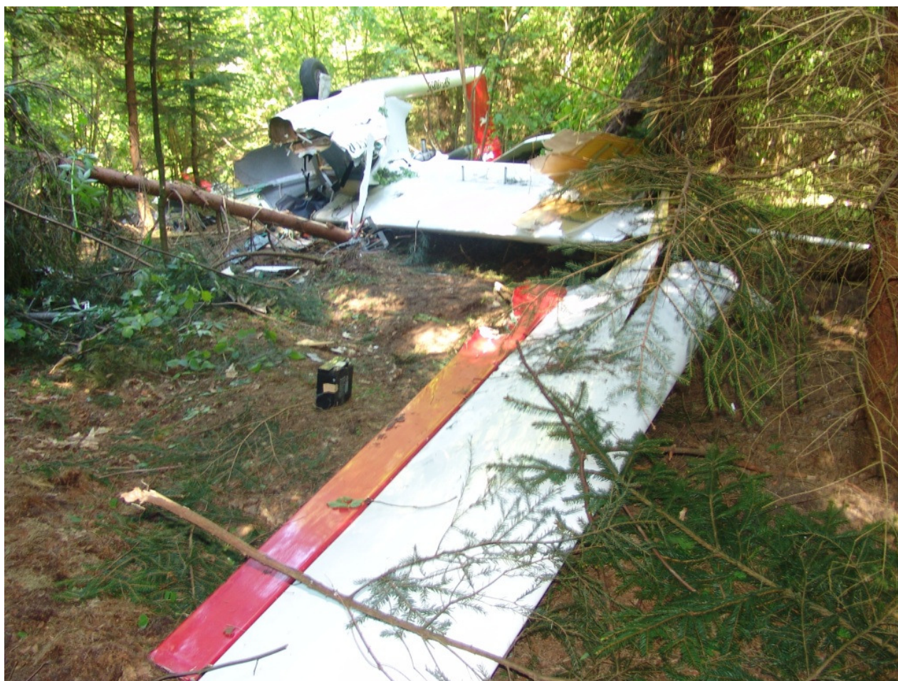
38 – Widok na prawe skrzydło motoszybowca, złamane i ukręcone. Widoczne niewielkie drzewo, powalone prawym skrzydłem przez spadający motoszybowiec [fot.AWM].
