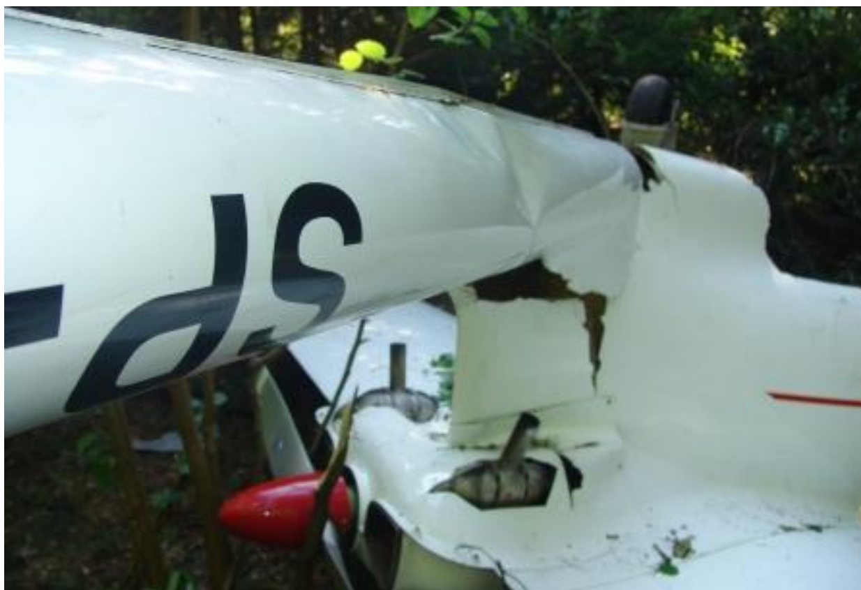
47 – Belka ogonowa zgięta w bok w lewo przy zamocowaniu do gondoli kadłuba [fot.PKBWL].
