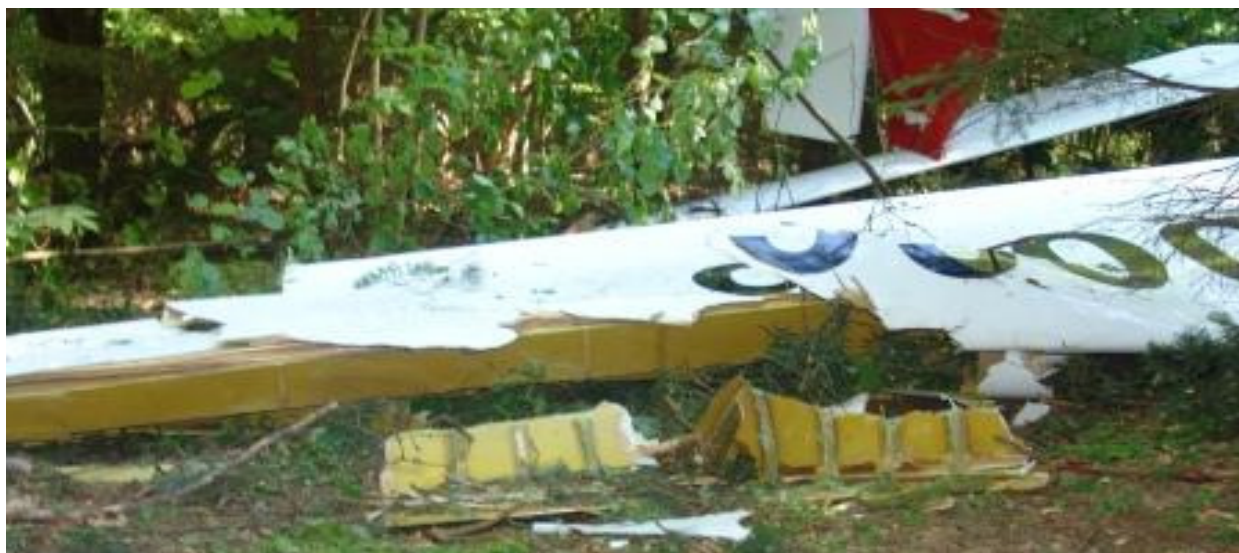
56 – Zniszczenia noska lewego skrzydła – odsłonięty, porozszczepiany i porozklejany dźwigar główny [fot.PKBWL].
