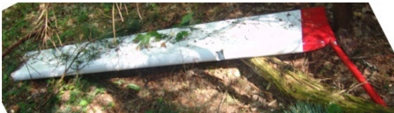
71 – Lewy segment steru wysokości, oderwany od reszty steru [fot.PKBWL].
