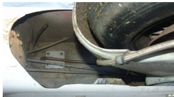
76 – Wnęka chowanego podwozia głównego [fot.AWM].
