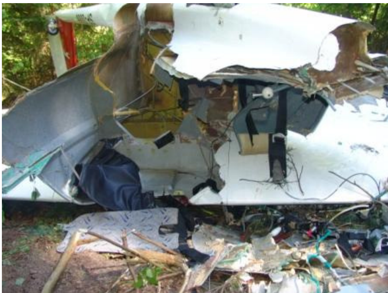
60 – Wnętrze zniszczonej gondoli kabiny i szczątki jej wyposażenia, zbiornik paliwa zdemontowany [fot.PKBWL].
