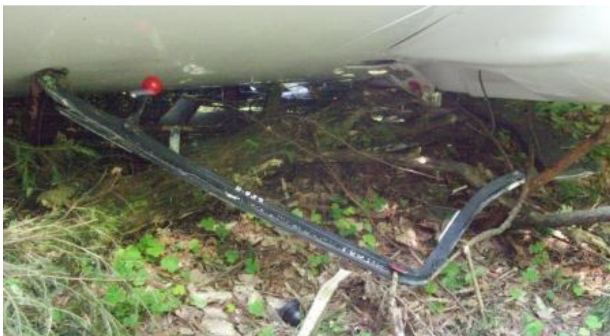
42 – Szczątki ramy osłony kabiny, przyciśnięte kadłubem motoszybowca [fot.PKBWL].
