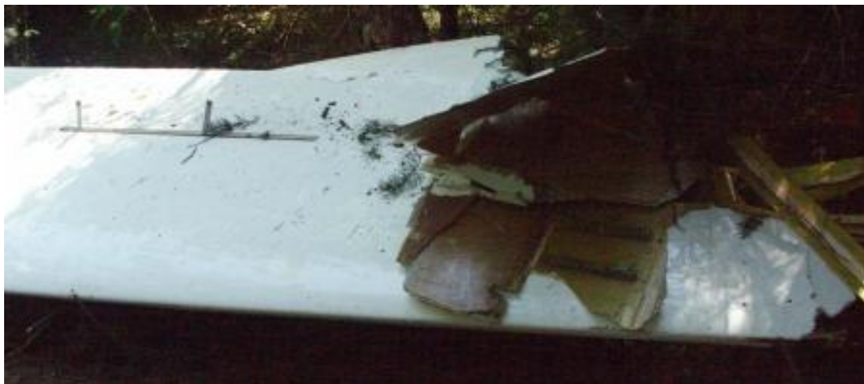
37 – Przełom prawego skrzydła. Po lewej stronie zdjęcia widać szczelinę oderwanej dolnej płyty hamulca aerodynamicznego i jej wahacze [fot.AWM].
