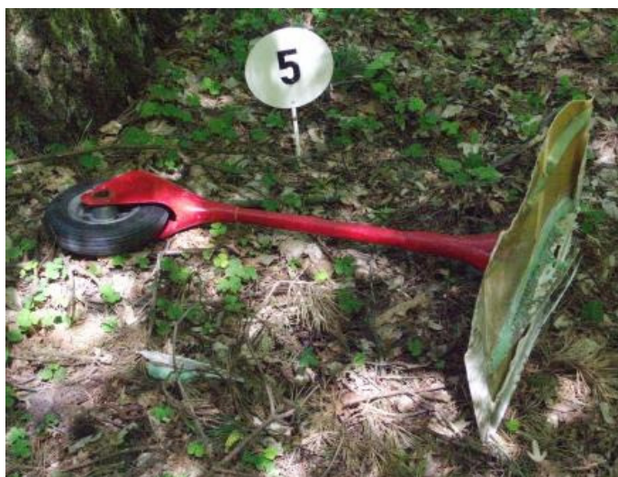
27 i 28 – Prawe podwozie podporowe, wyrwane z fragmentem końcówki skrzydła [fot.PKBWL].
