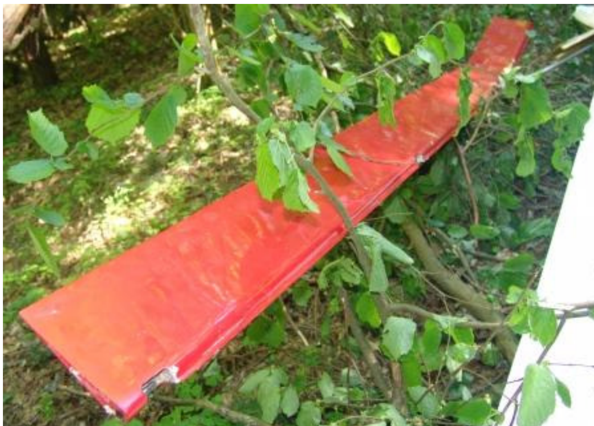
50 – Wyrwana z zawiasów lewa lotka, połączona jeszcze z popychaczem napędu [fot.AWM].
