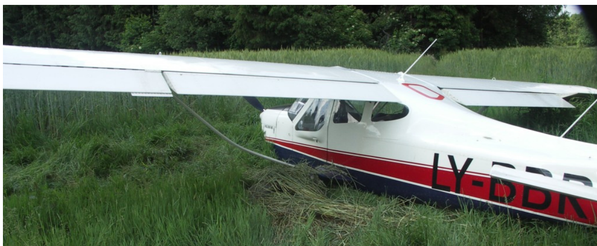
5 – Zbliżenie samolotu \frac{3}{4} od tyłu z lewej strony – widoczne wychylenie klap i zgięty lewy zastrzał.
