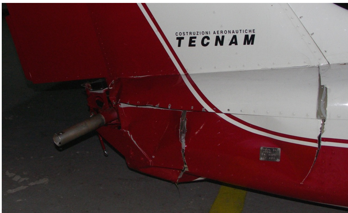
17 – Uszkodzenia tylnej części kadłuba z prawej strony po demontażu usterzenia poziomego.
