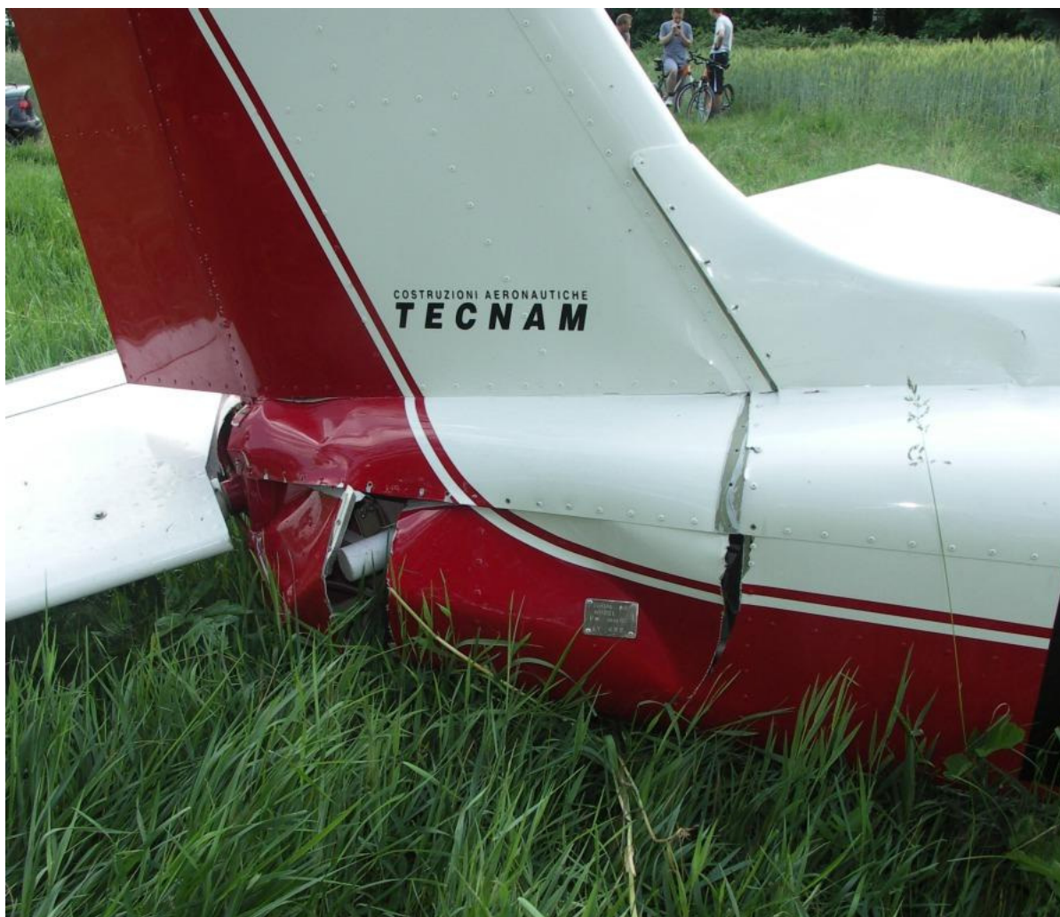
16 – Uszkodzenia tylnej części kadłuba z prawej strony przed demontażem usterzenia poziomego.
