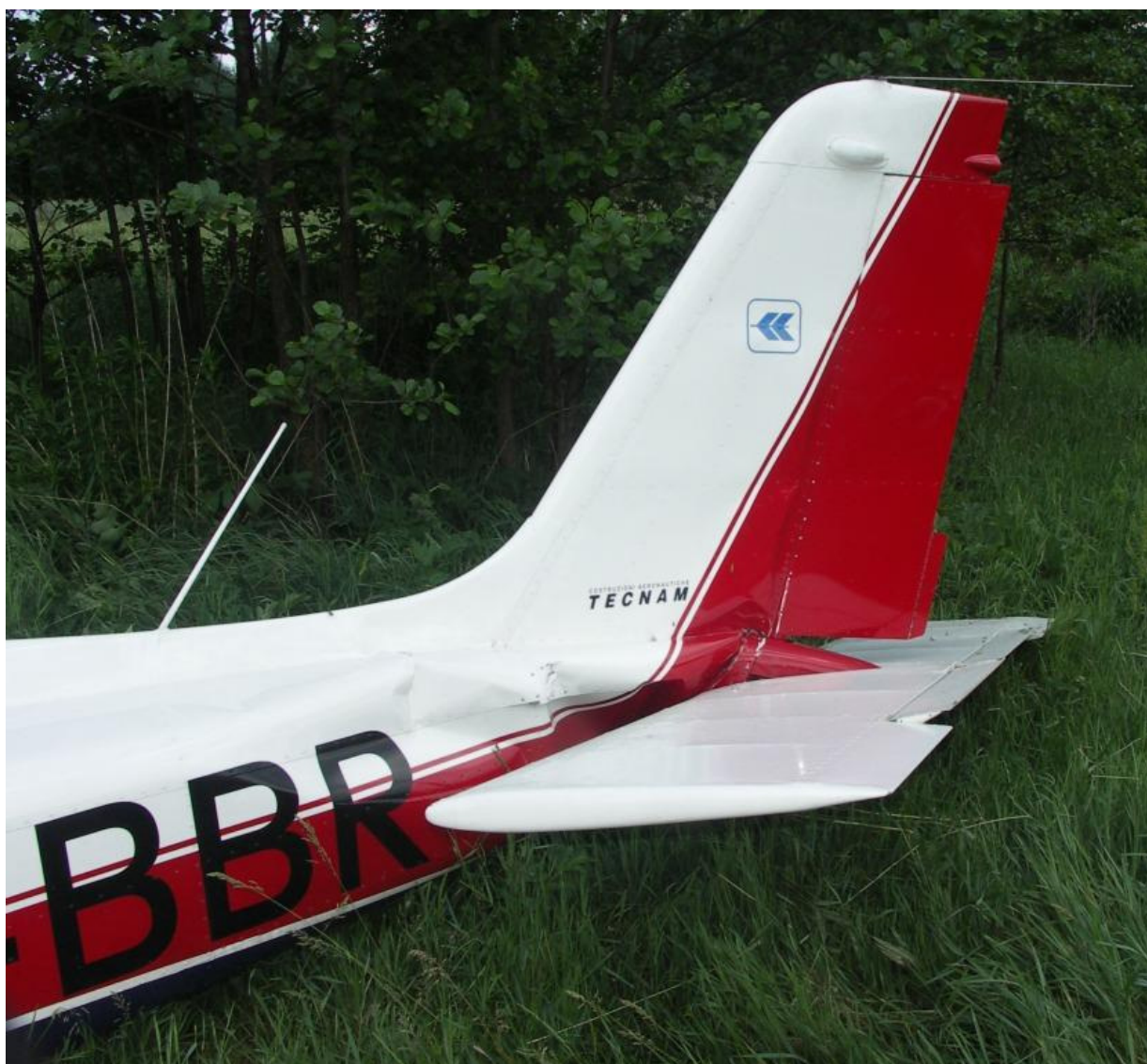
13 – Usterzenie i uszkodzenia tylnej części kadłuba – widok ogólny.
