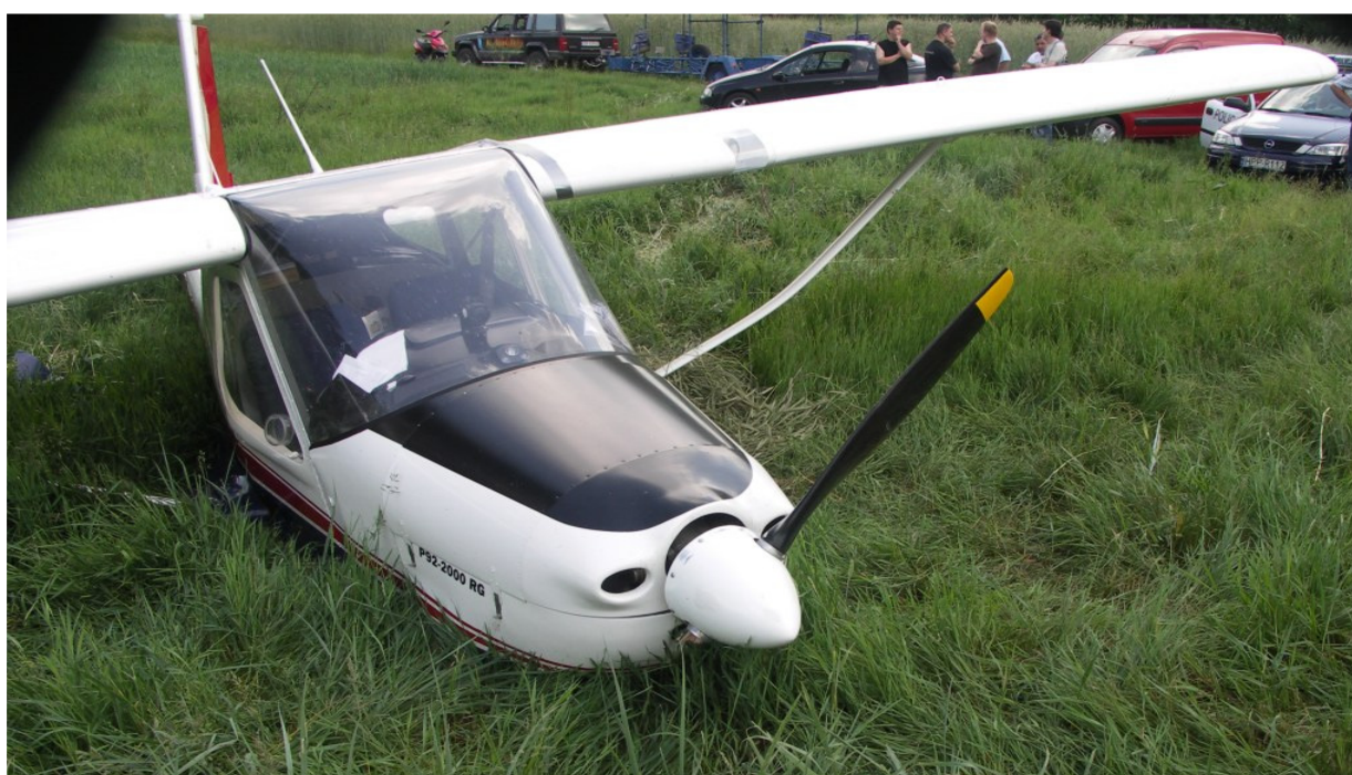
8 – Zbliżenie samolotu z przodu z prawej strony – widoczny zgięty lewy zastrzał i zniszczone śmigło.
