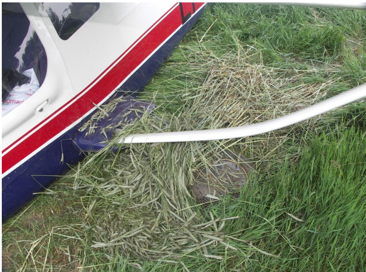
11 – Lewa strona samolotu od przodu – widać oderwane podwozie główne i zgięty zastrzał skrzydła.
