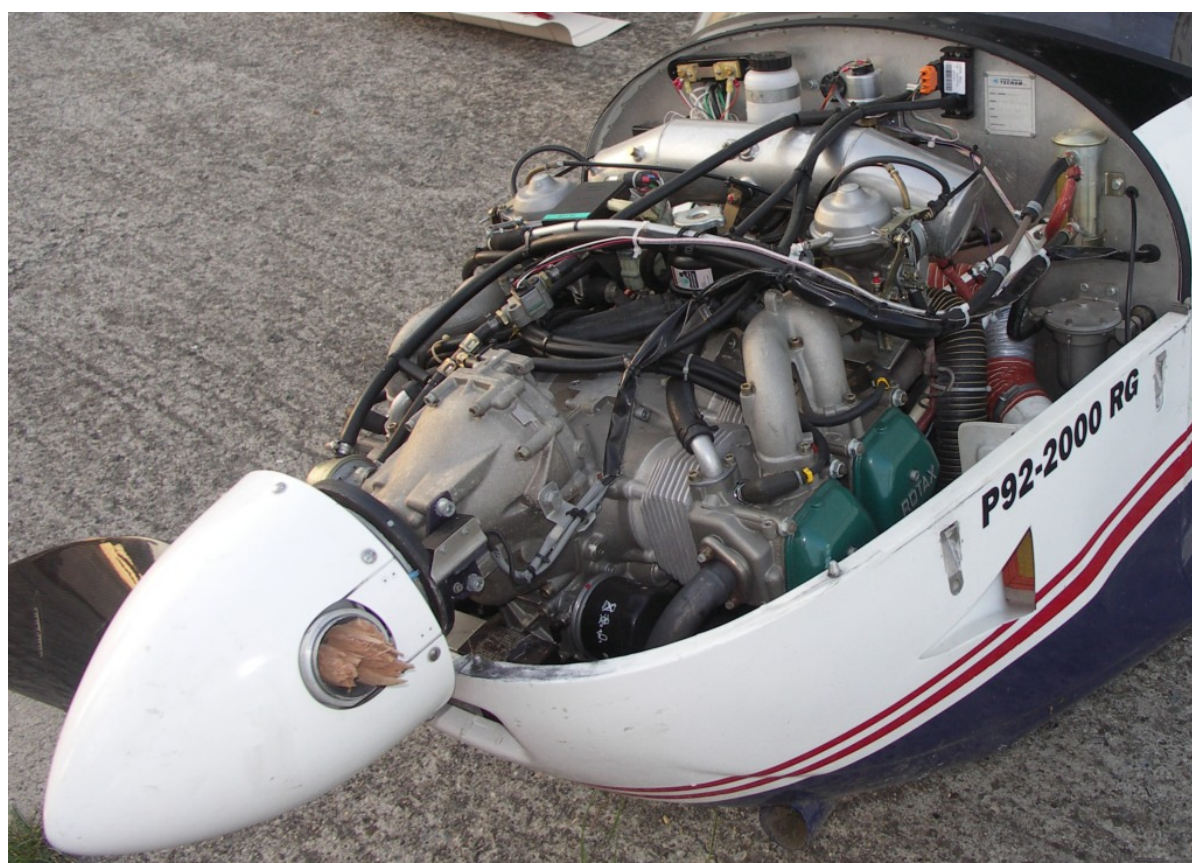
19 – Zespół napędowy z lewej strony – widok ogólny. Widoczny przełom oderwanej łopaty śmigła.
