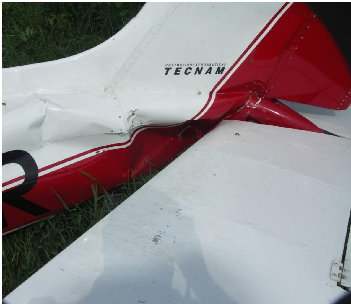
14 – Uszkodzenia tylnej części kadłuba z lewej strony przed demontażem usterzenia poziomego.
