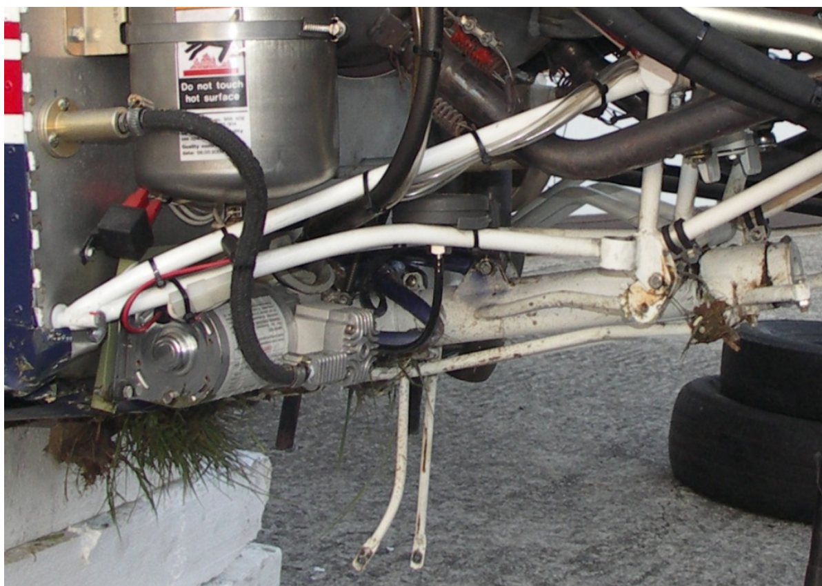
25 – Uszkodzona dolna część łoża silnika i przednie podwozie wbite do luku – strona prawa.
