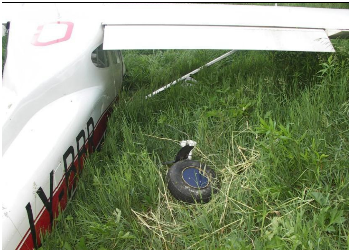
10 – Prawa strona samolotu od tyłu – widać oderwane podwozie główne.
