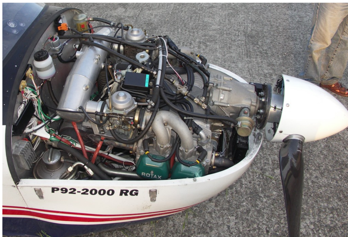
18 – Zespół napędowy z prawej strony – widok ogólny. Zwraca uwagę brak jednej łopaty śmigła.
