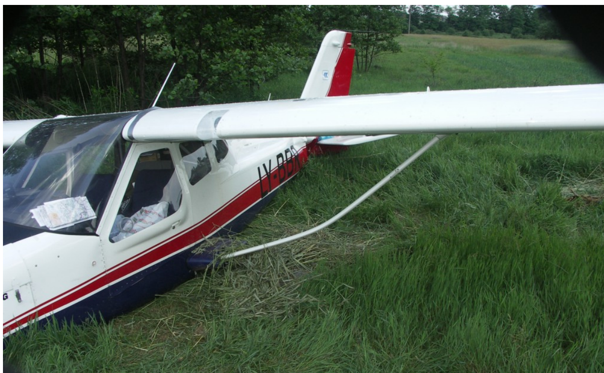
6 – Zbliżenie samolotu \frac{3}{4} od przodu z lewej strony – widoczny zgięty lewy zastrzał.
