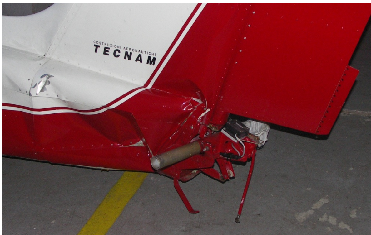
15 – Uszkodzenia tylnej części kadłuba z lewej strony po demontażu usterzenia poziomego.
