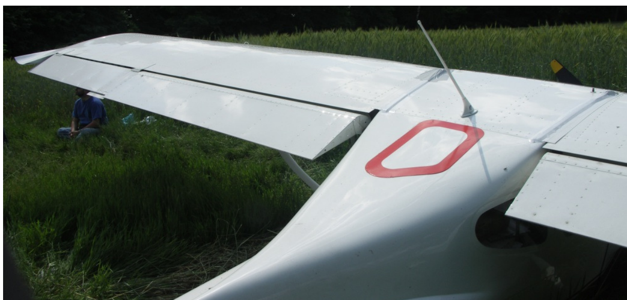
9 – Zbliżenie grzbietu kadłuba samolotu – widoczne oznakowanie luku spadochronu systemu GRS.
