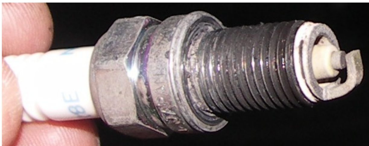
23 – Jedna ze świec zapłonowych pokazana przykładowo – dobrze widoczny stan elektrod.
