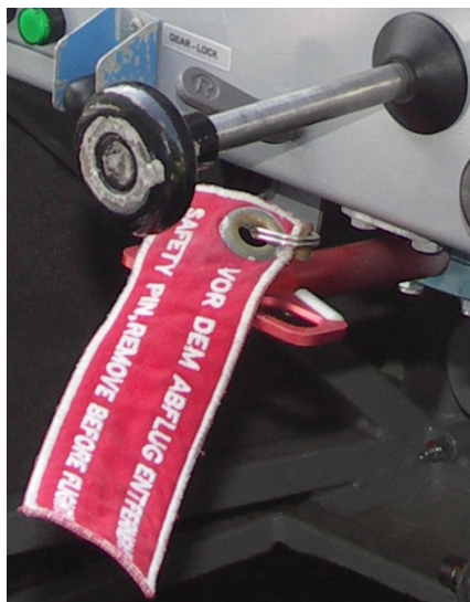
29 – Zawleczka zabezpieczająca uchwyt wyzwalania spadochronowego systemu ratunkowego GRS.
