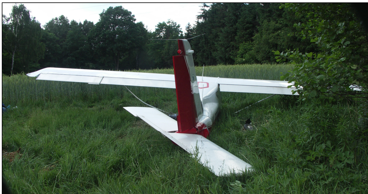
12 – Ogólny widok samolotu od tyłu. Dobrze widoczne uszkodzenia i wychylenie klap.
