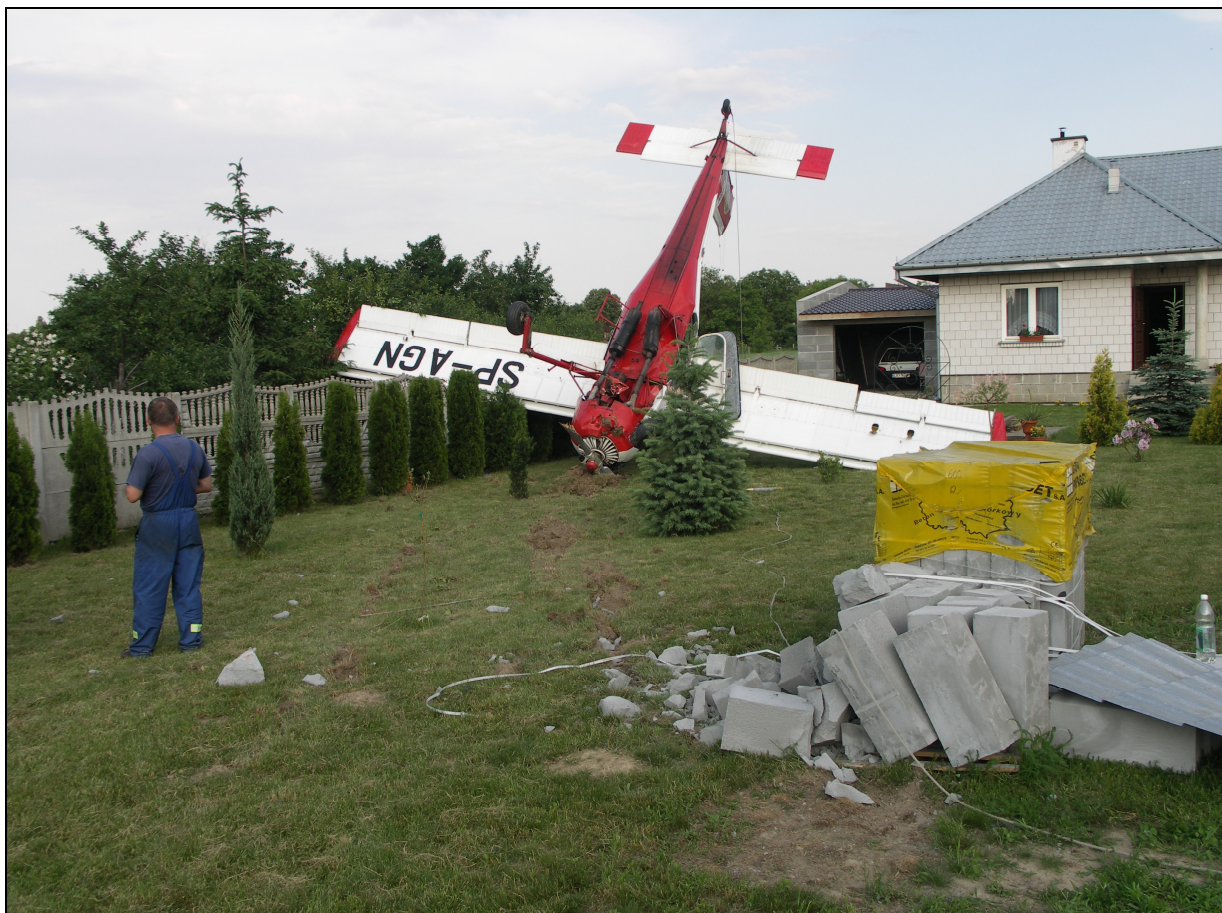
4 – Ogólny widok miejsca wypadku w kierunku lądowania – widoczne ślady przyziemienia ze zmianą kierunku po uderzeniu prawym podwoziem głównym w betonowe bloczki.
