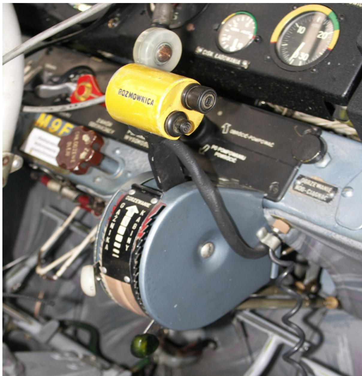
24 - Manetki zespołu napędowego, umieszczone pośrodku tablicy przyrządów.
