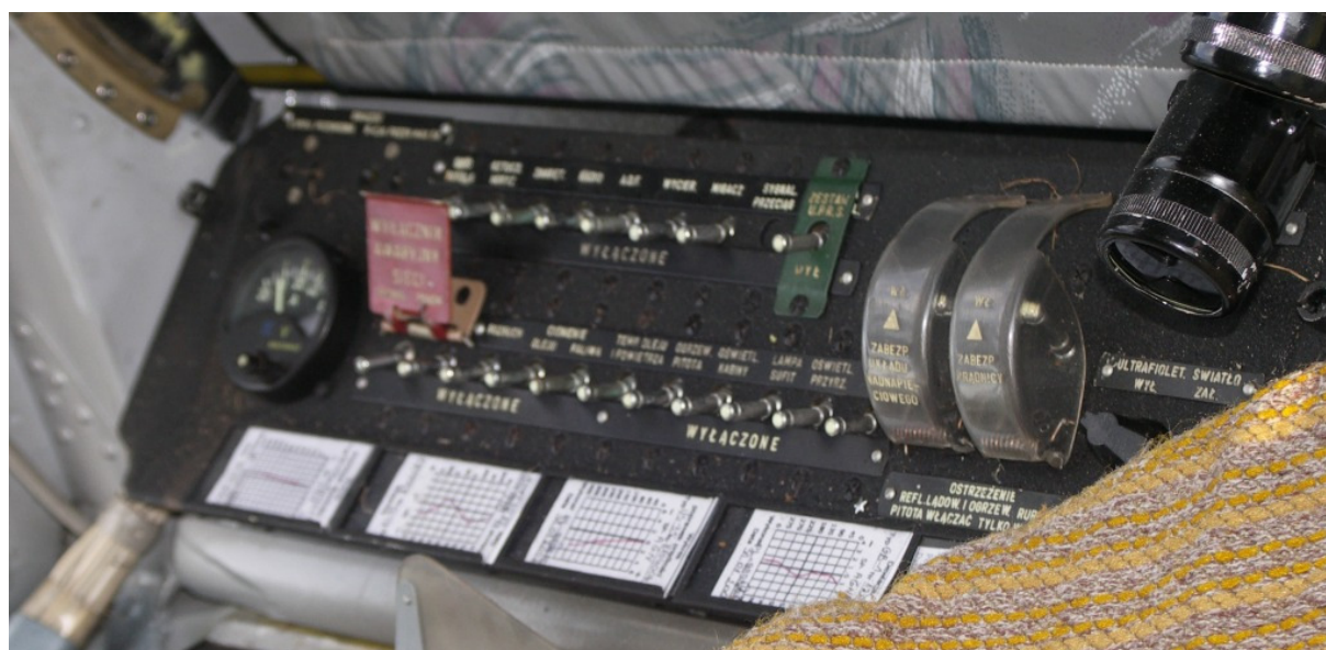
25 - Pulpit górny z przełącznikami pokładowej instalacji elektrycznej.
