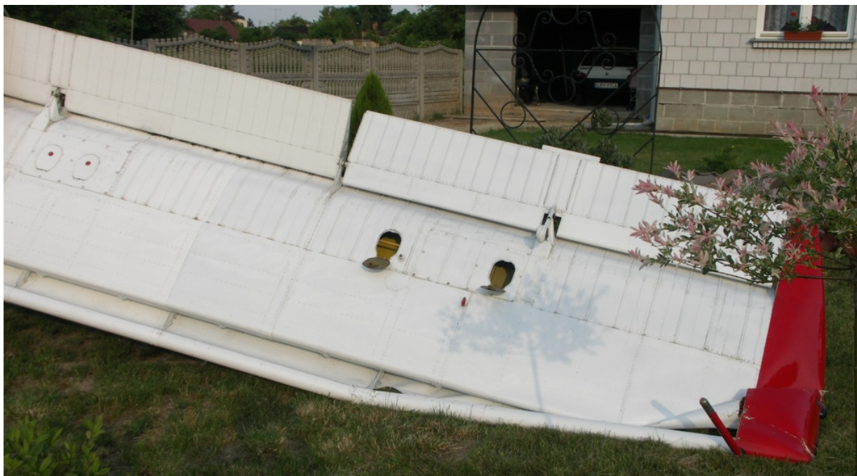
15 – Uszkodzenia prawego skrzydła, widok od spodu.
