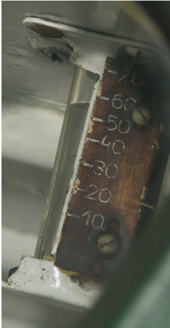
27a, 27b – Prawy paliwomierz na innym samolocie PZL-104 Wilga 35 sfotografowany przy PUSTYM prawym zbiorniku. Zdj. 27a (lewe) pokazuje widok od strony pilota, a zdj.27b (prawe) – od przodu. Widoczne wzajemne położenie menisku płynu i pływaka w rurce oraz ich widoczność, a ściślej brak odpowiedniej widoczności pływaka od strony pilota, któremu za to położenie menisku płynu może sugerować ok.55 l zapasu paliwa w prawym zbiorniku [przy nieodpowiedniej interpretacji odczytu lub braku doświadczenia na samolocie PZL-104 Wilga 35].
