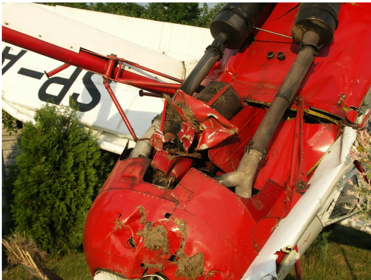
16 – Uszkodzenia zespołu napędowego i jego osłon, po prawej stronie kadru widoczne urwane okucia prawej goleni podwozia głównego.
