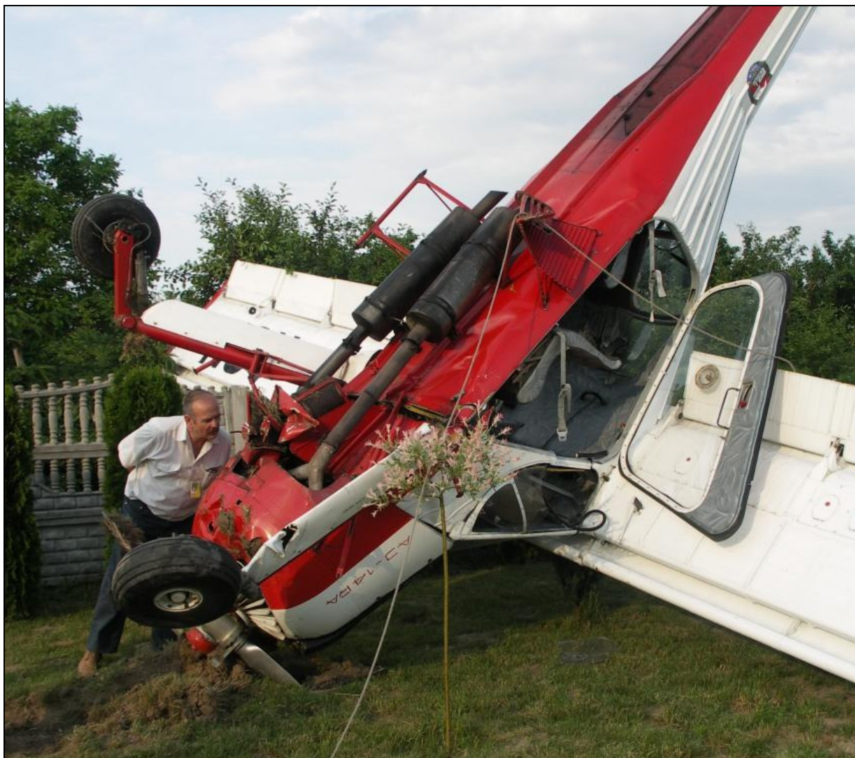
14 – Widok na środkową część kadłuba z prawej strony, dobrze widoczne wyłamane prawe podwozie główne i połamane śmigło.
