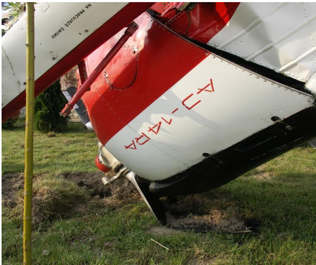
18 – Widok na osłony silnika i połamane śmigło.
