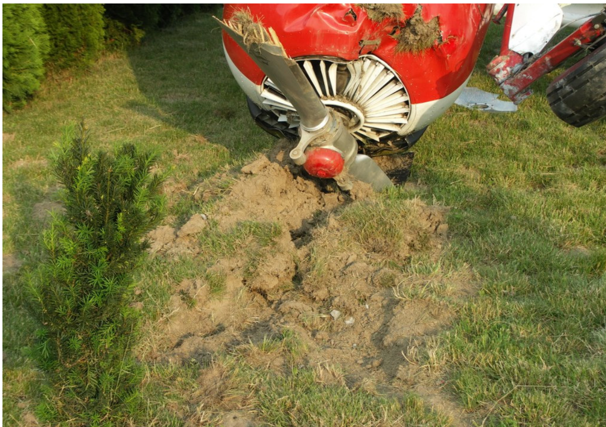
6 – Ślad zarycia śmigłem w ziemię – „punkt obrotu” samolotu w trakcie niedokończonego kapotażu.
