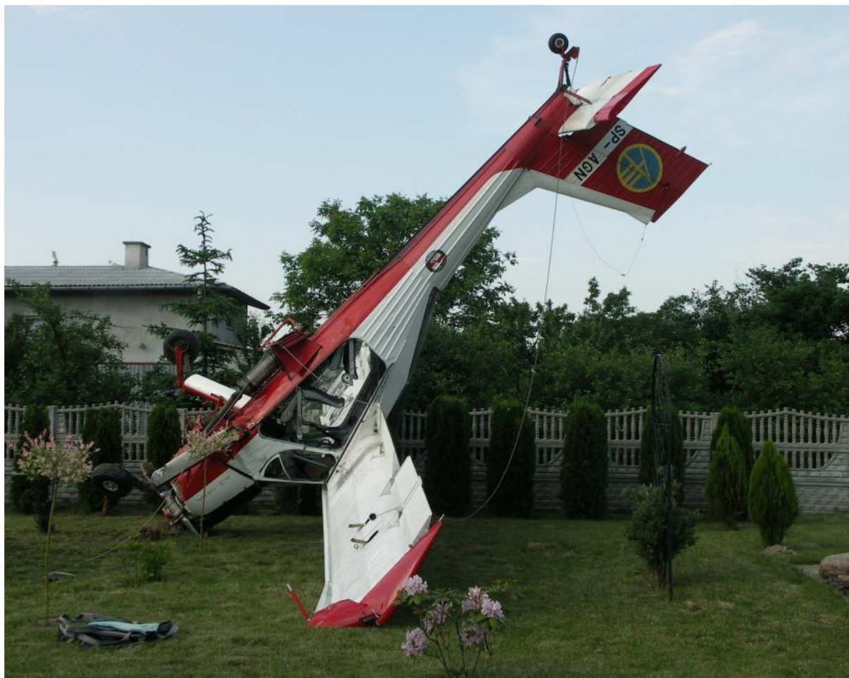
11 – Samolot na miejscu wypadku, doskonale widać kąt, o jaki obrócił się samolot podczas niedokończonego kapotażu.
