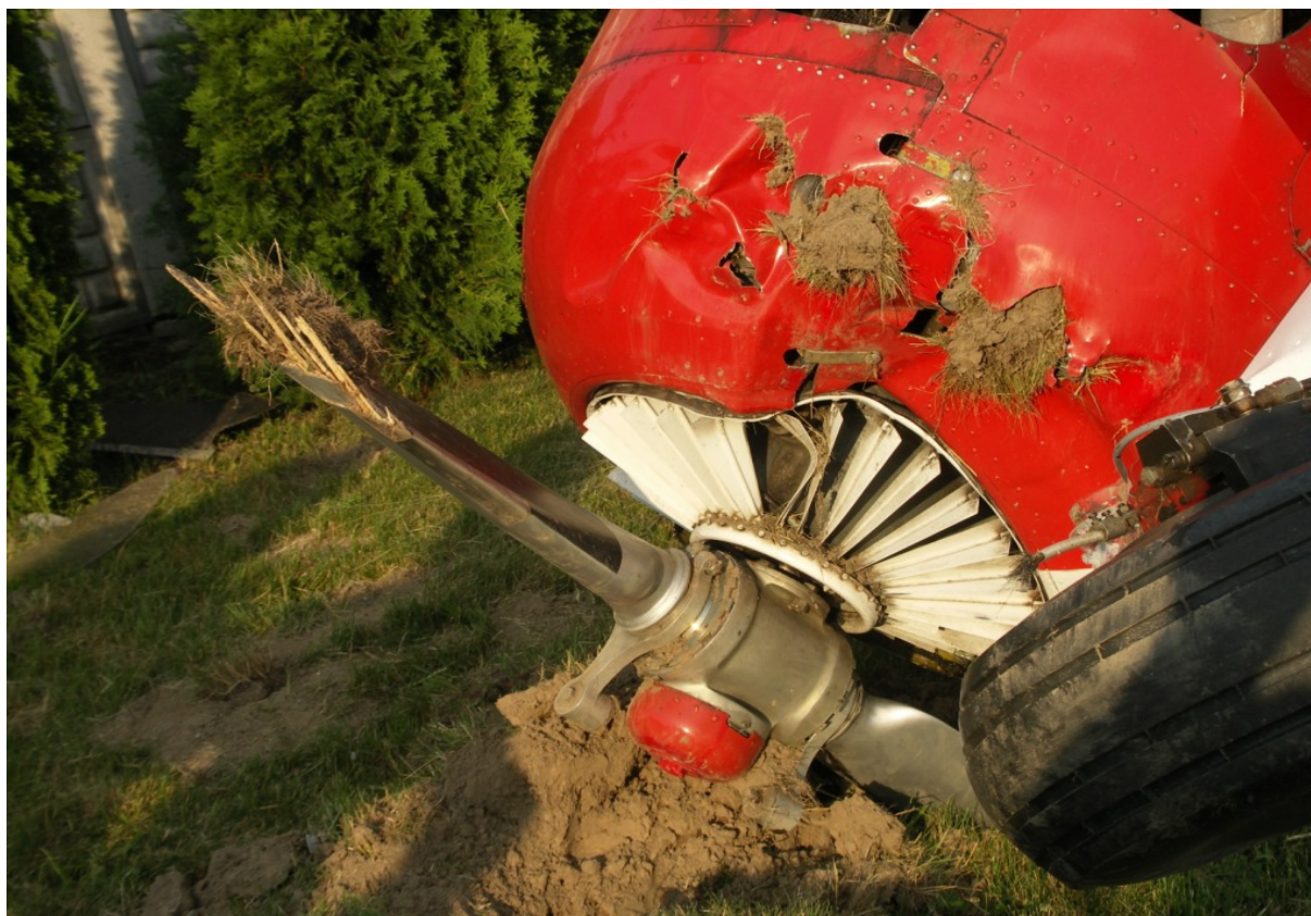
19 – Połamane śmigło i zniszczone osłony silnika, po prawej stronie widać koło wyłamanego prawego podwozia głównego.
