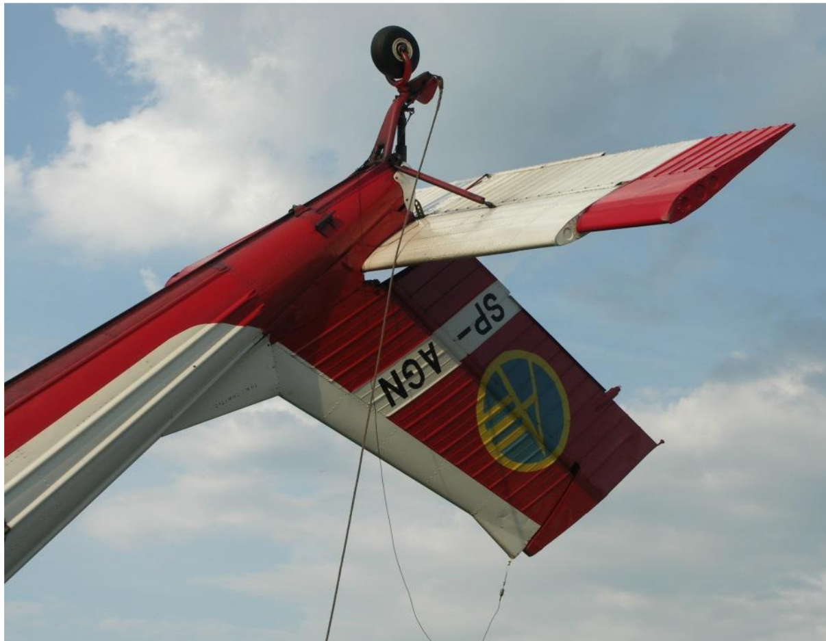
21 – Tylna część kadłuba z usterzeniem i podwoziem tylnym w widoku z prawej strony, widoczna lina holownicza i zerwana antena.
