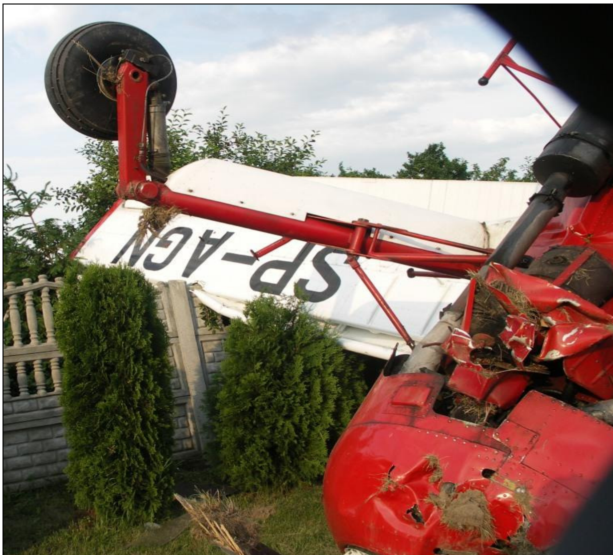
13 – Uszkodzenia lewego skrzydła, lewego podwozia i spodu kadłuba, widoczna strzaskana łopata śmigła.
