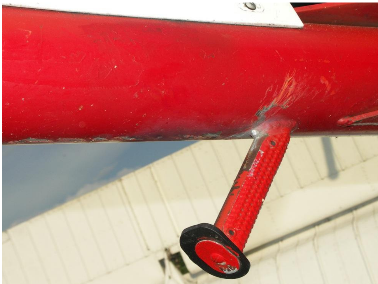
17 – Ślad przewodów linii energetycznej na goleni lewego podwozia głównego.
