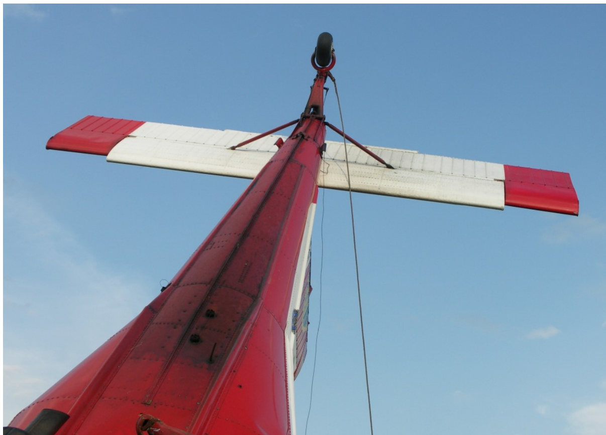
20 – Tylna część kadłuba z usterzeniem i podwoziem tylnym w widoku od spodu, widoczna lina holownicza i zerwana antena.
