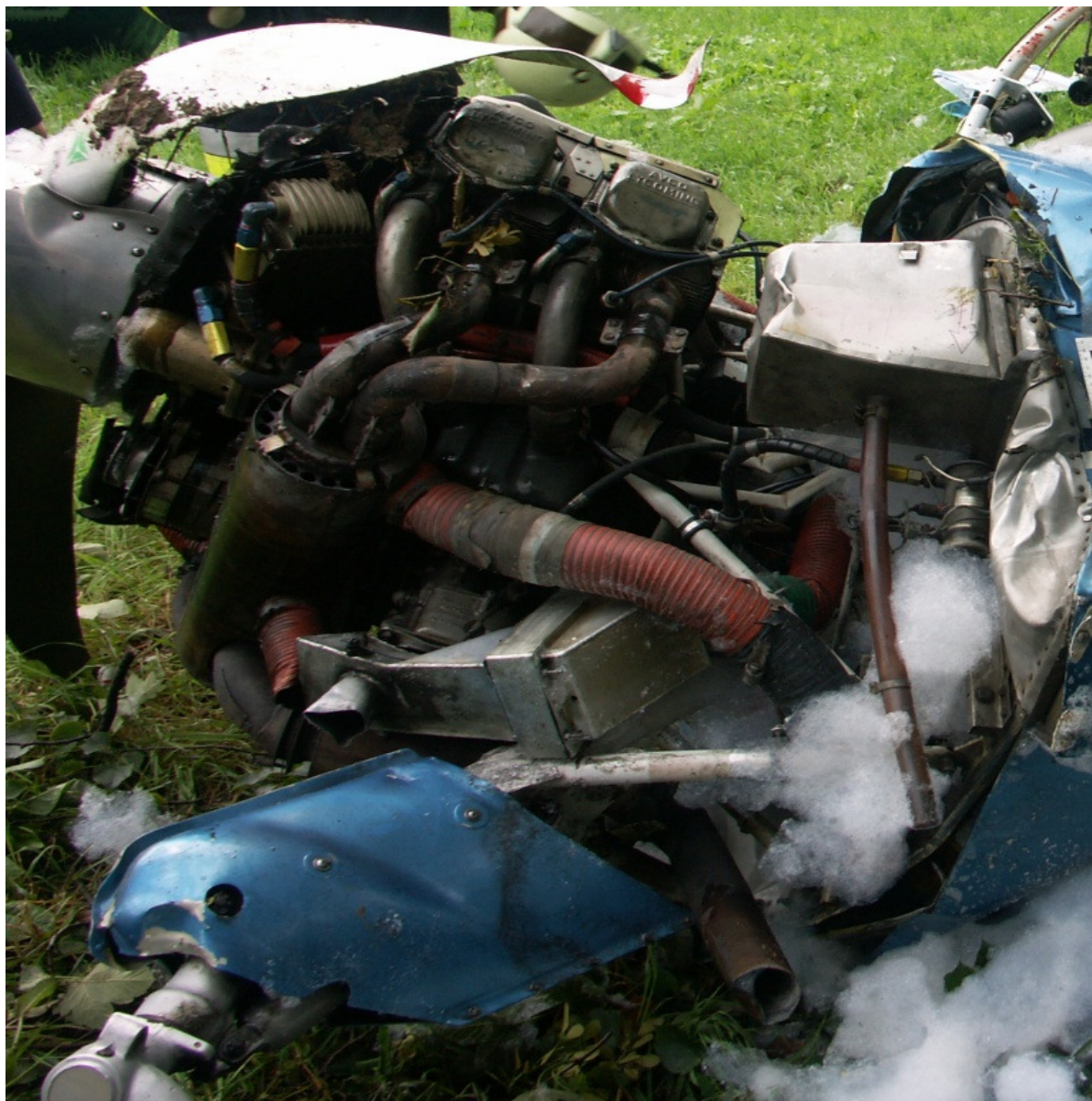
20 – Zniszczony zespół napędowy z lewej strony podczas demontażu wraku, na pierwszym planie podwozie przednie.
