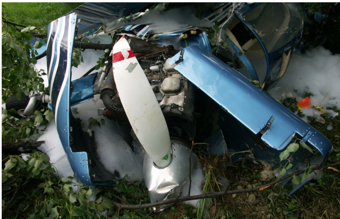
19 – Zniszczony zespół napędowy.
