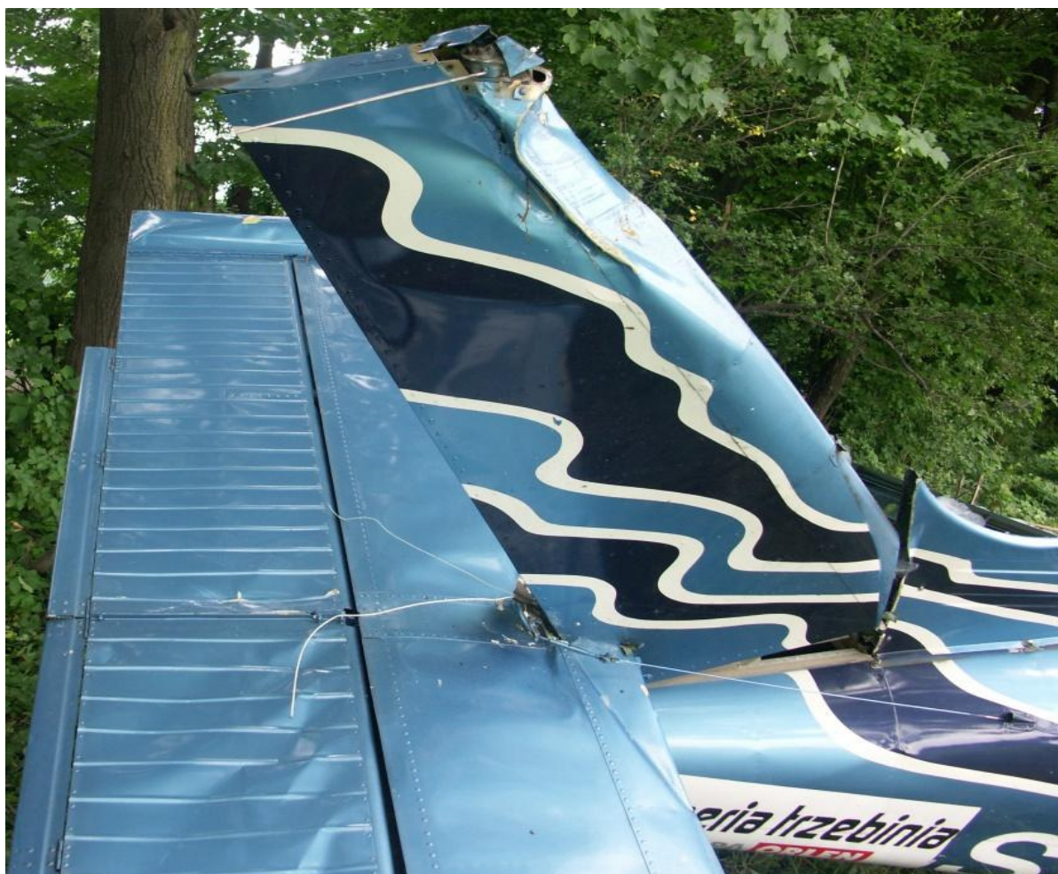
30 – Zniszczone usterzenie samolotu. Widoczne cięgna sterowania sterem kierunku.
