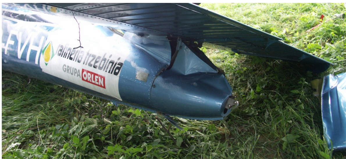
28 – Tył kadłuba samolotu – widoczne uszkodzenia owiewek i zaczep do holowania szybowców. Po prawej stronie kadru oderwana końcówka prawego segmentu steru wysokości.
