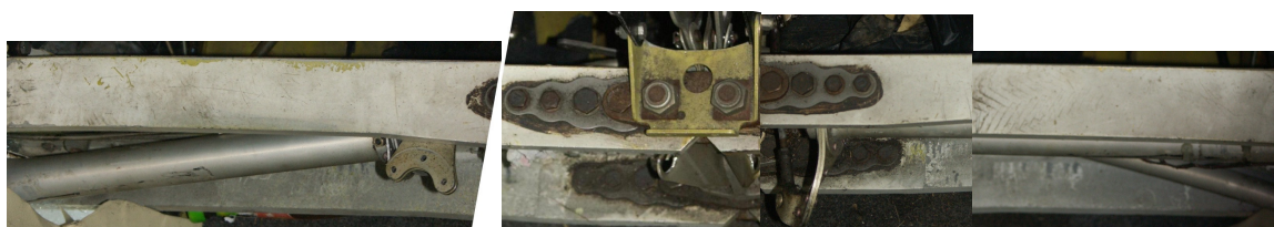
16 – Dźwigary skrzydeł w obrębie kadłuba, widok od góry – widoczne połączenie dźwigarów z okuciami biodrowych pasów bezpieczeństwa, okuciami siedzisk foteli, rury skrętne napędu kłap i popychacz prawej lotki. Widok odtworzony z 4 oddzielnych kadrów. Zwraca uwagę znaczne zaawansowanie korozji niektórych elementów i części łącznych połączenia dźwigarów skrzydeł.
