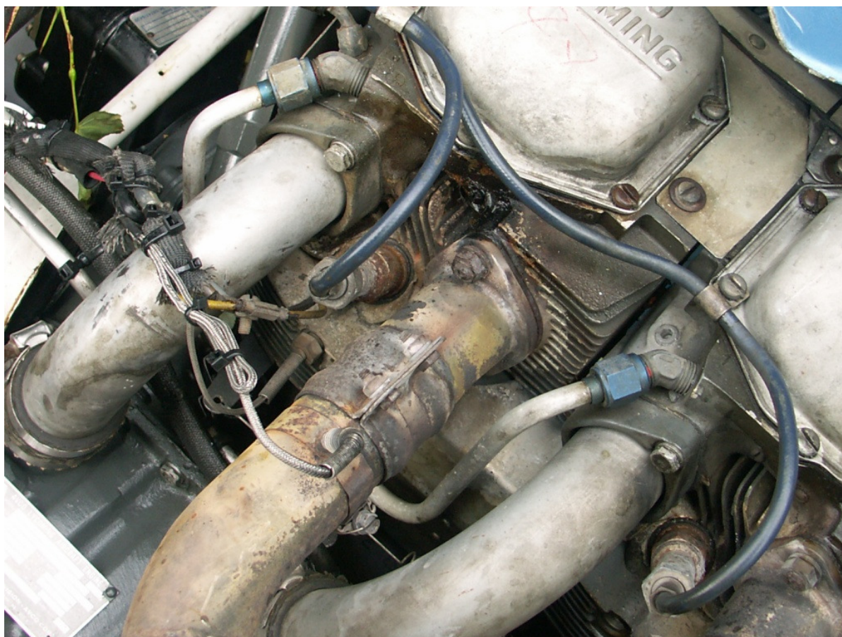
25 – Przewody ssące, wydechowe i zapłonowe na cylindrach silnika – widoczne objawy zużycia i korozji.
