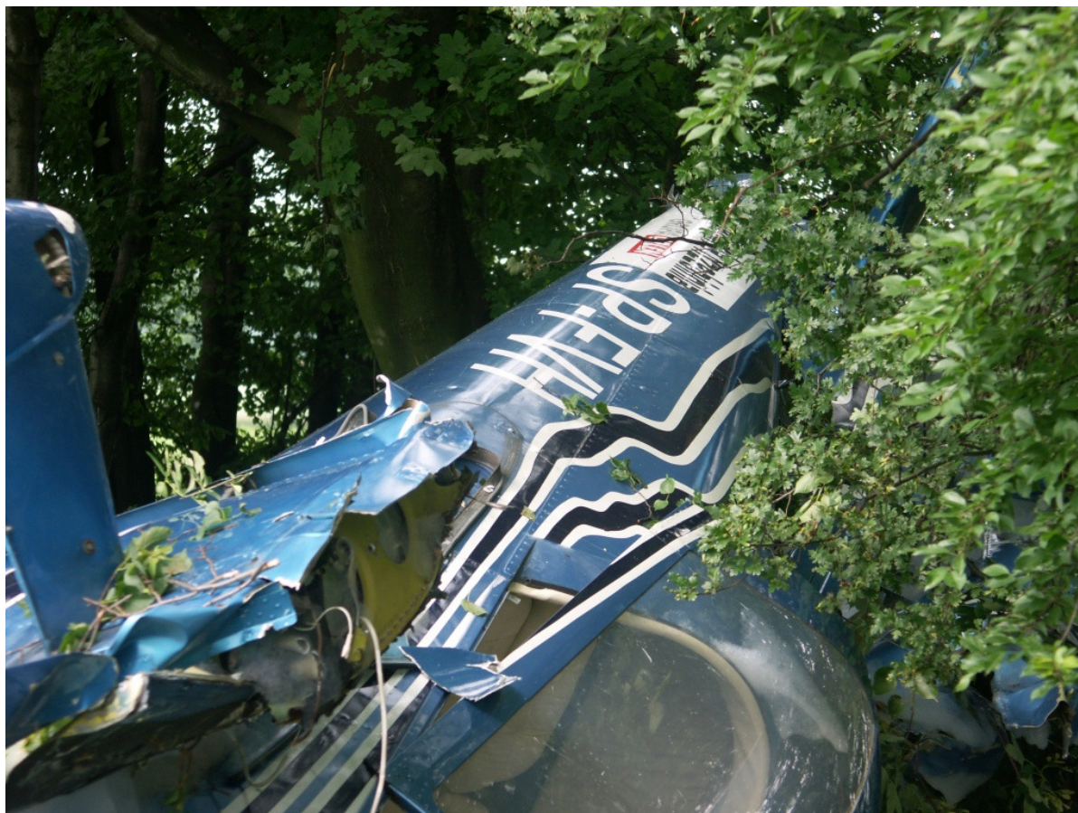
13 – Prawa burta kadłuba samolotu, widoczna oddzielona od kadłuba osłona kabiny i nasada wyłamanego prawego skrzydła.
