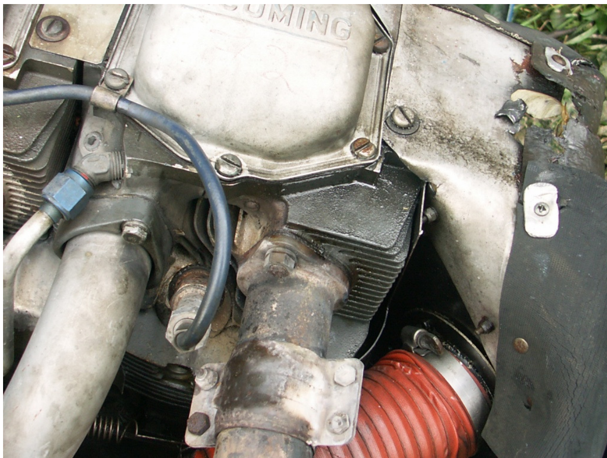
26 – Przewody ssące, wydechowe i zapłonowe na cylindrach silnika – widoczne objawy zużycia i korozji.
