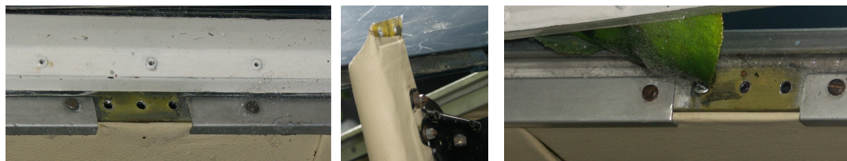
34, 35, 36 – Na zdjęciach po lewej i prawej stronie widoczne miejsca na profilu burt kabiny po wyrwanej belce poprzecznej, stanowiącej podporę dla oparcia foteli przednich i będącej miejscem zamocowania okuć pasów barkowych pilota i pasażera siedzącego obok niego. Na zdjęciu środkowym jedna z końcówek belki poprzecznej z widocznym okuciem pasa barkowego – pas ten został wyrwany z okucia podczas wypadku.
