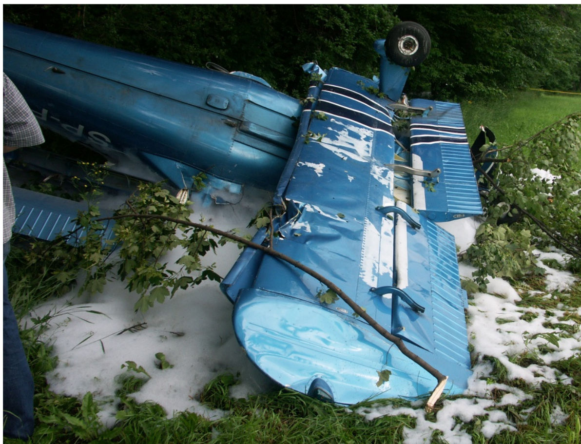
14 – Widok na odłamane prawe skrzydło i kadłub samolotu od spodu; widoczne zniszczenia wskutek kolizji z drzewami.
