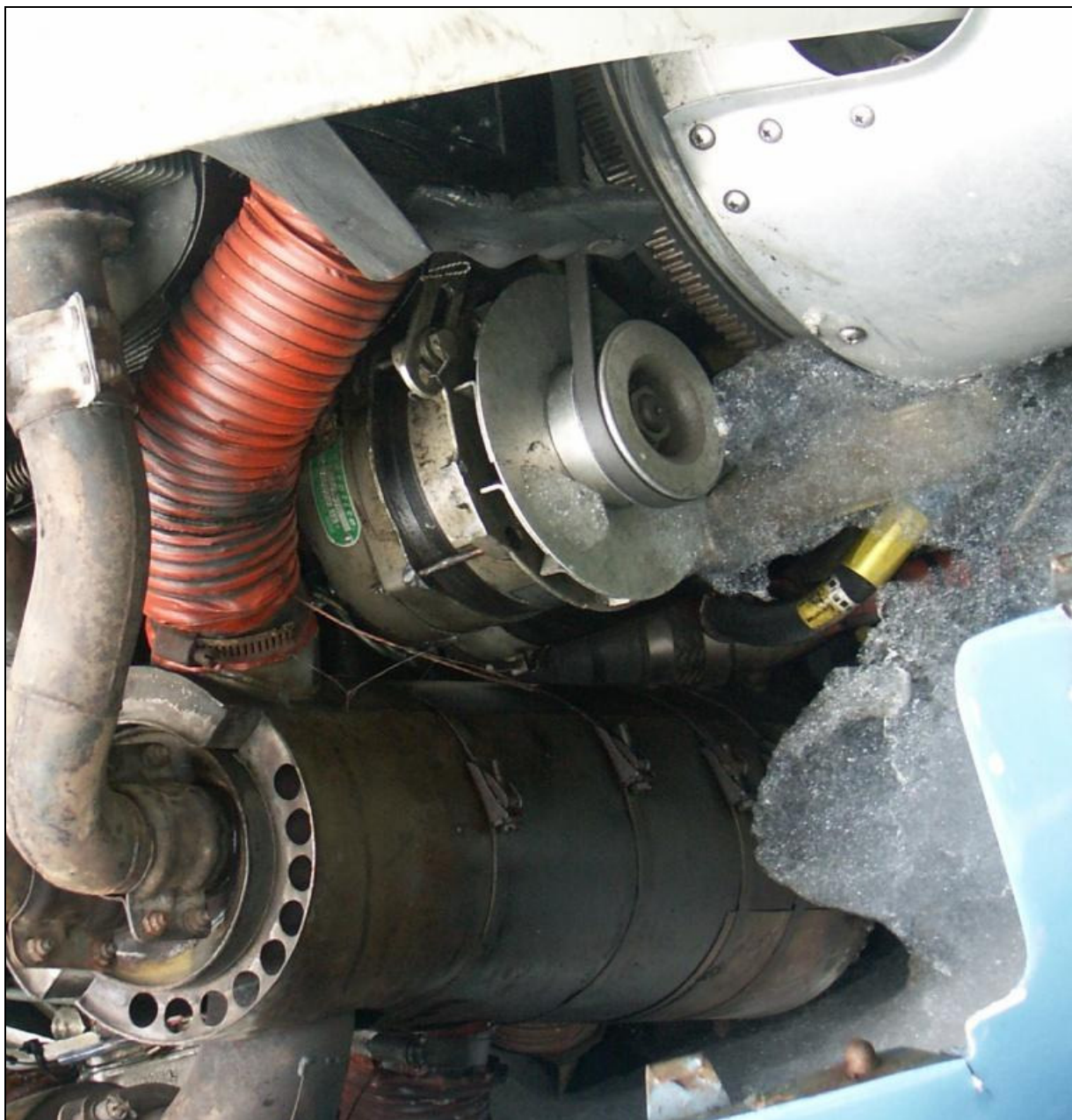
22 – Zespół napędowy – widoczny napędzany paskiem zębatym alternator i kolektor spalin z nagrzewnicą. Widoczne zaawansowane zużycie elementów.
