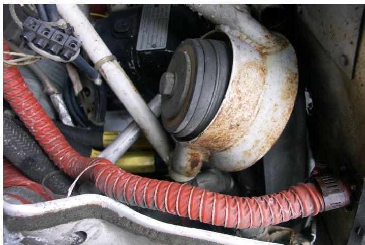
23 – Jeden z amortyzatorów zawieszenia silnika – widoczne ślady korozji.
