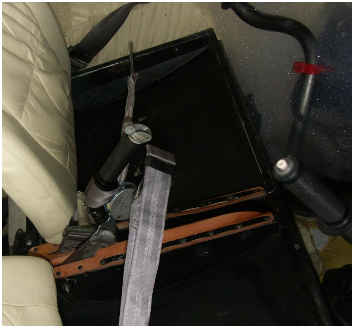
39 – Wnętrze kabiny - widoczne siedziska foteli i umieszczona między nimi dźwignia sterowania klapami w położeniu maksymalnego wychylenia. Zwraca uwagę zerwany jeden z pasów bezpieczeństwa pilota (owinięty wokół dźwigni klap) i nie odpięty zamek pasa bezpieczeństwa pasażera, siedzącego obok pilota. Po prawej stronie kadru widoczne drążki sterowe.
