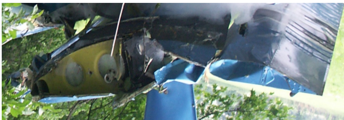
17 – Nasadowe żebro oderwanego prawego skrzydła, widoczna końcówka przewodu paliwowego na zbiorniku paliwa.
