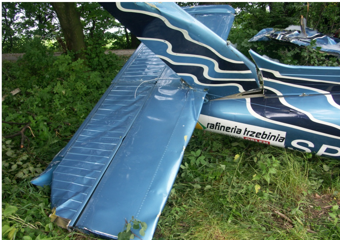
29 – Zniszczone usterzenie samolotu. Widoczne cięgna sterowania sterem kierunku.
