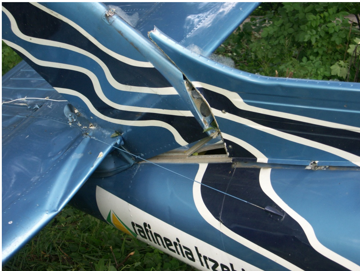
31 – Zniszczone usterzenie samolotu. Widoczne cięgna sterowania sterem kierunku.
