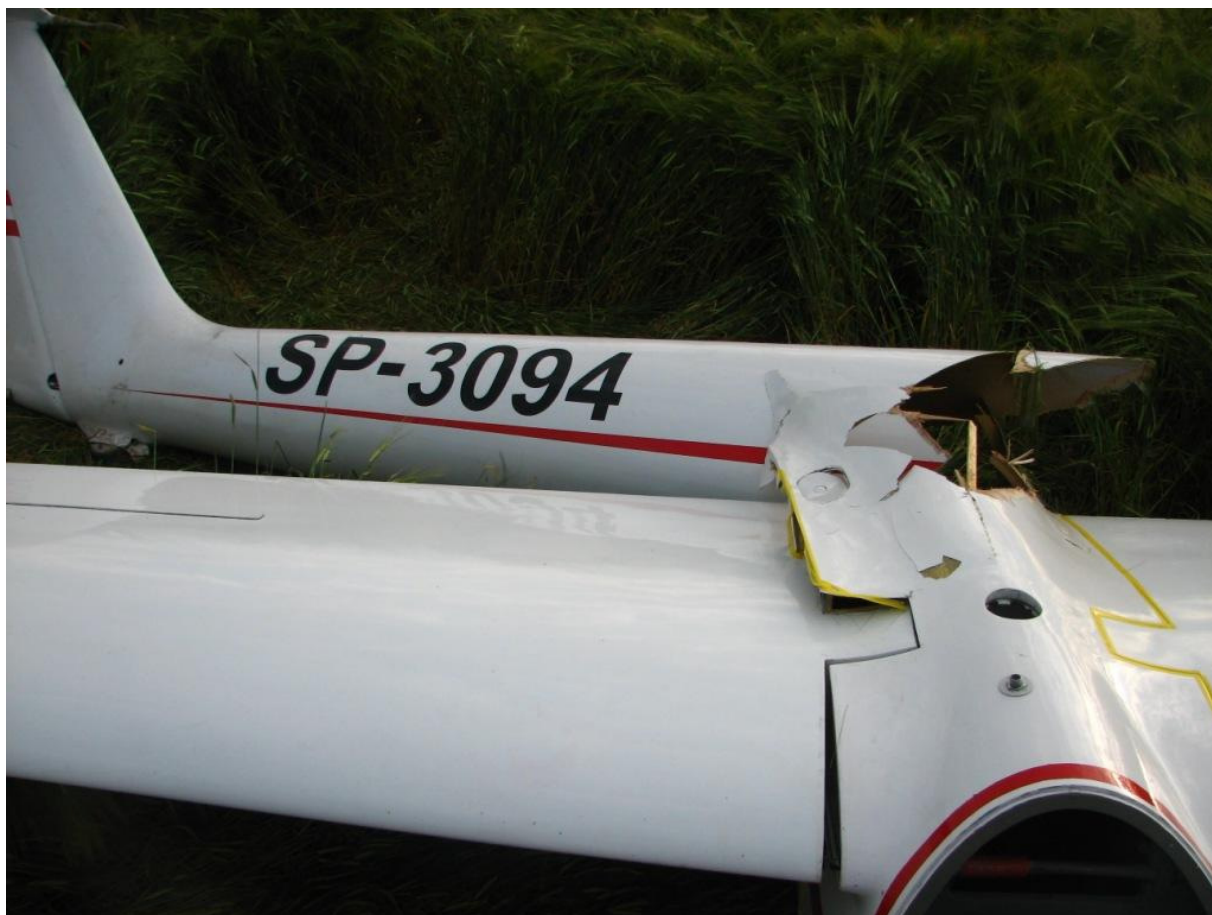
10 – Przełom kadłuba. Widoczne objawy uszkodzenia mocowania prawego skrzydła – szpara u nasady.
