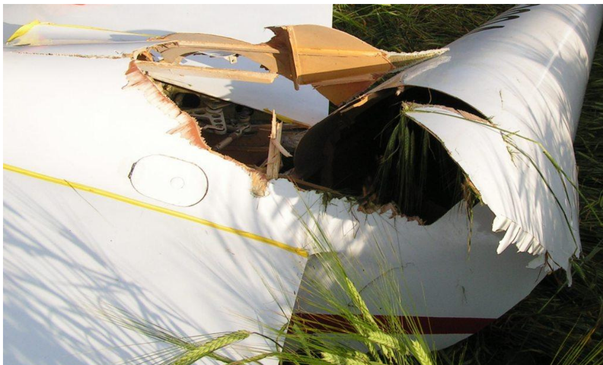
14 – Przełom kadłuba z lewej strony od góry.
