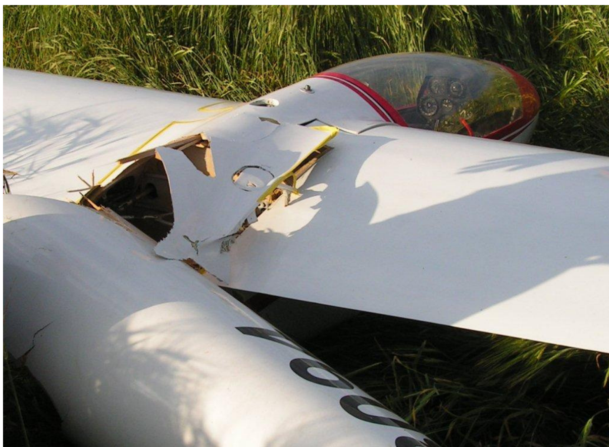
11 – Przełom kadłuba w widoku \frac{3}{4} od tyłu z prawej strony.
