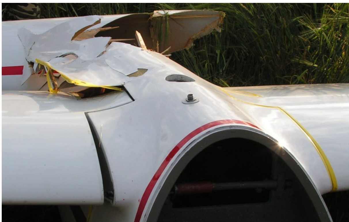
13 – Przełom kadłuba od przodu. Widoczne objawy uszkodzenia mocowania prawego skrzydła – szpara u nasady.
