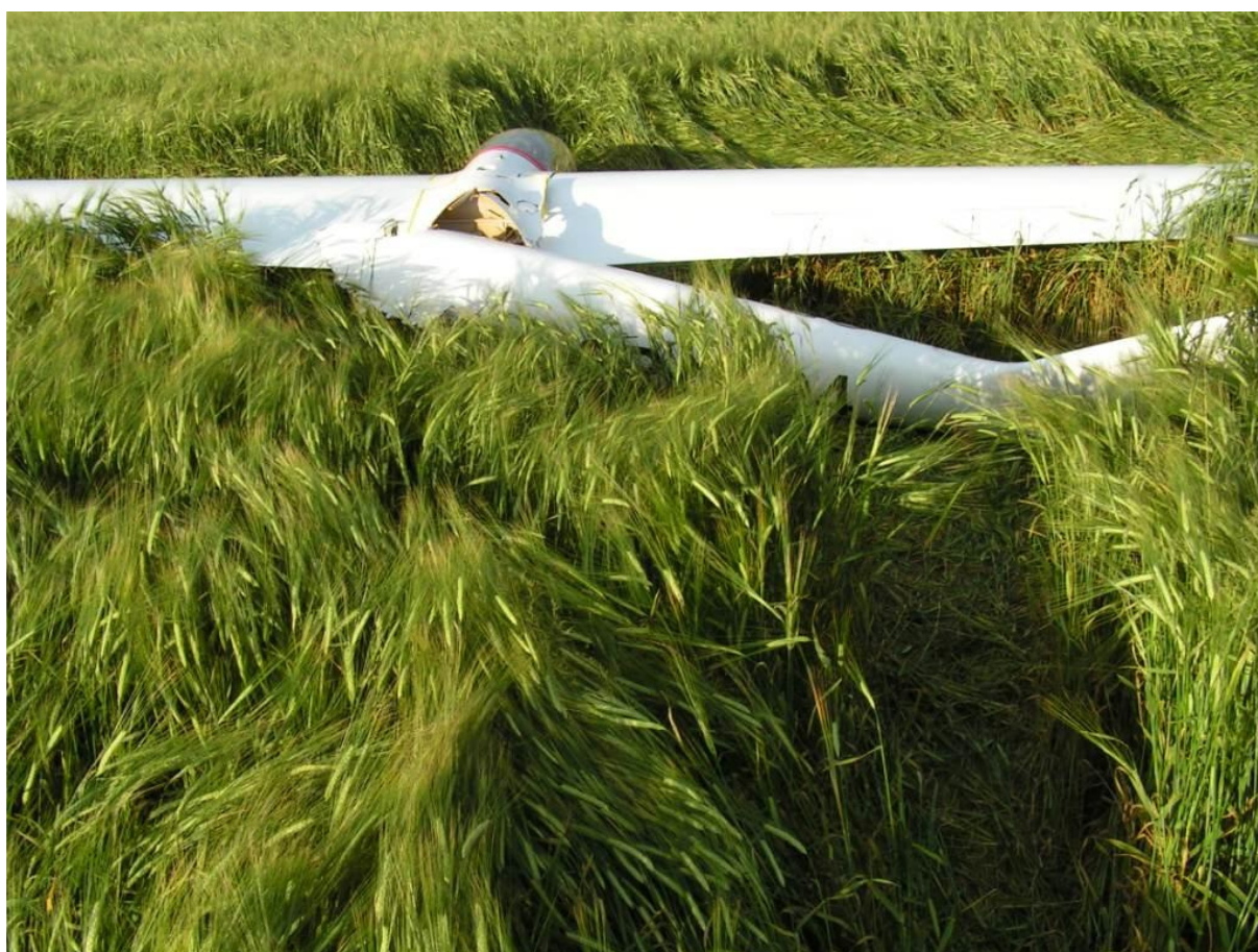
5 – Uszkodzony szybowiec i ślad ostatniej fazy przyziemienia.
