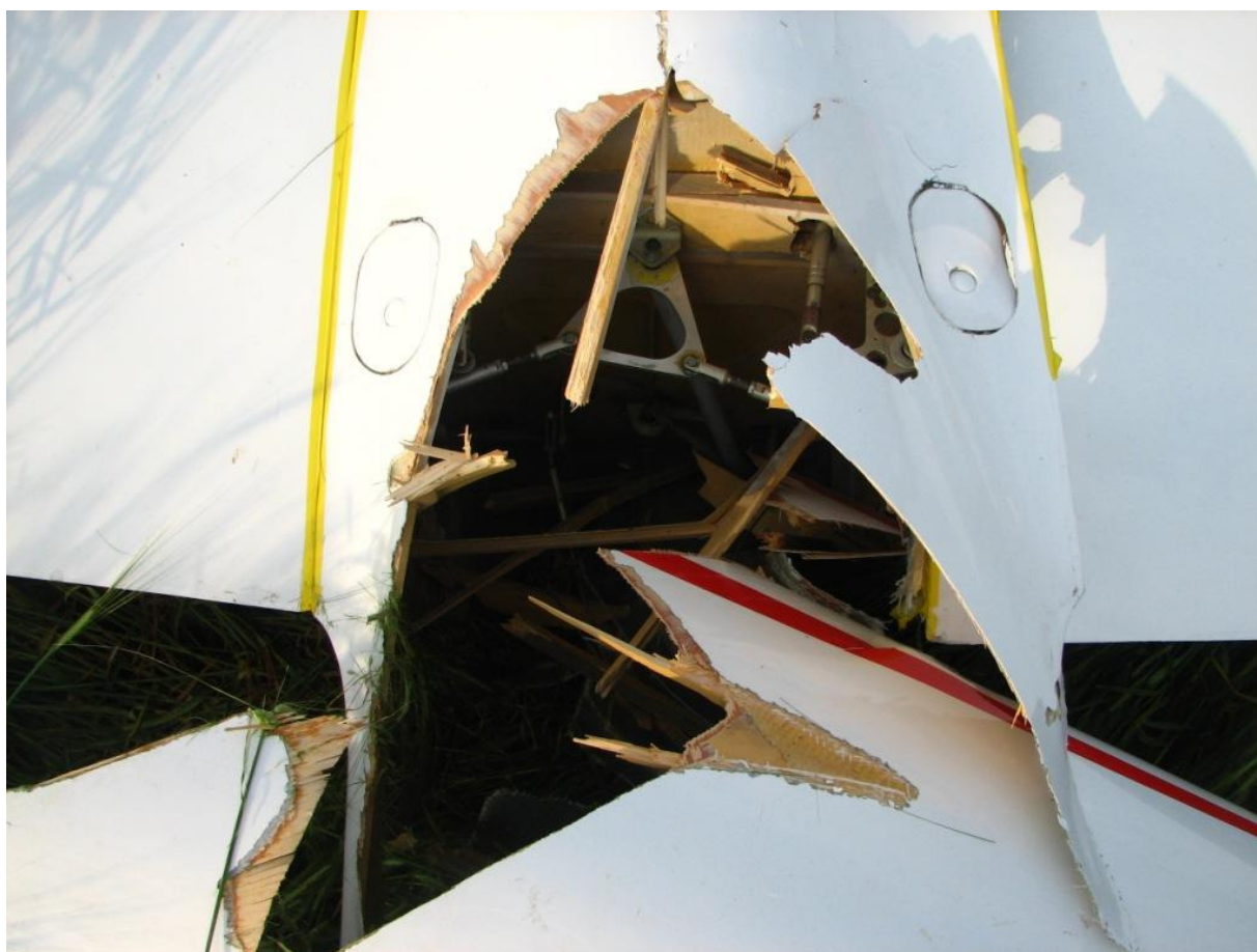
12 – Przełom kadłuba, widok od tyłu.
