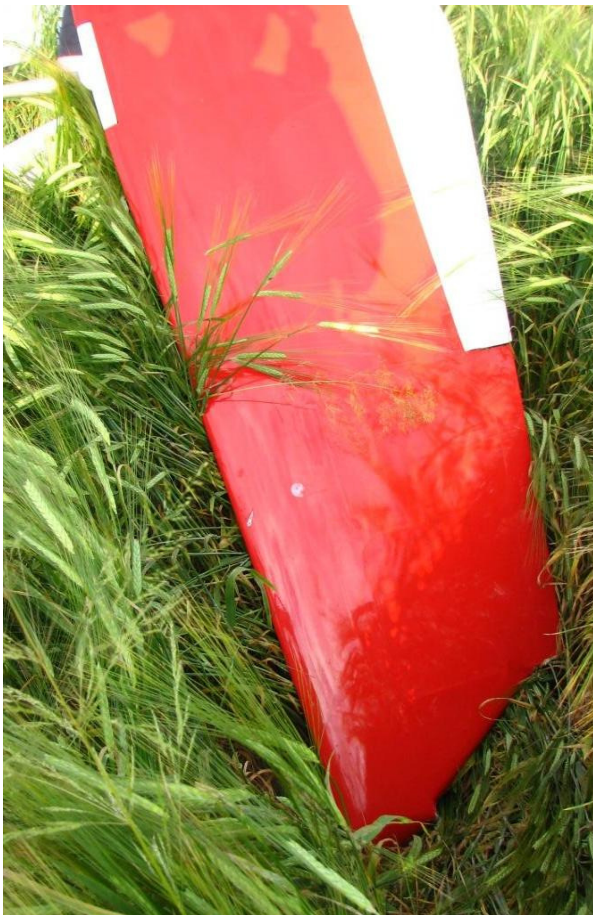
8 – Uszkodzenie lewej końcówki usterzenia poziomego.
