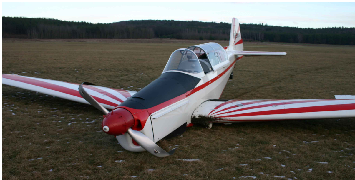
10 – Ogólny widok samolotu w zbliżeniu, strona lewa. Widoczny ślad lądowania.
