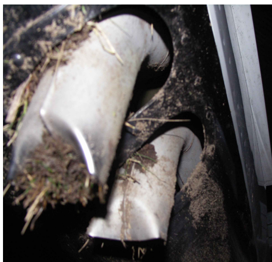
15 – Uszkodzone wyloty spalin z silnika.
