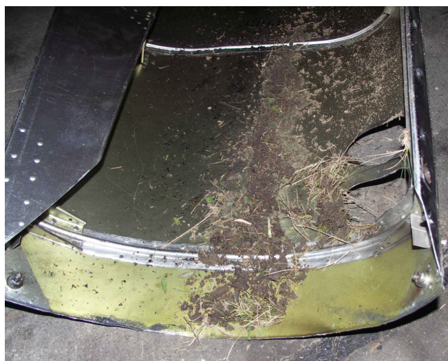
16 – Uszkodzona lewa pokrywa silnika.
