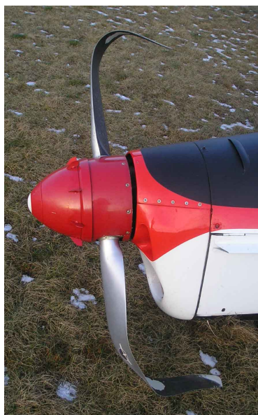
13 i 14 – Zniszczone śmigło samolotu.
