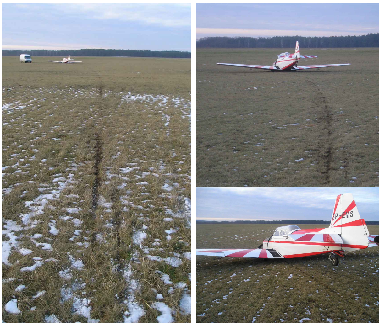
3, 4 i 5 — Samolot na miejscu wypadku po zatrzymaniu, dobrze widoczny ślad na ziemi.
