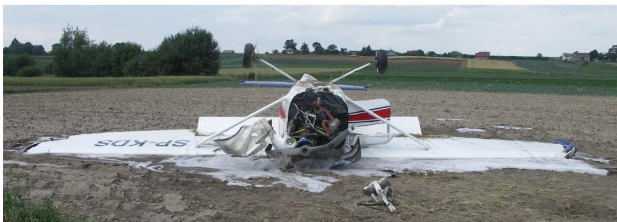
8 – Ogólny widok rozbitego samolotu od strony południowej. Na pierwszym planie oderwane podwozie przednie. Dobrze widoczne wychylone klapy.
