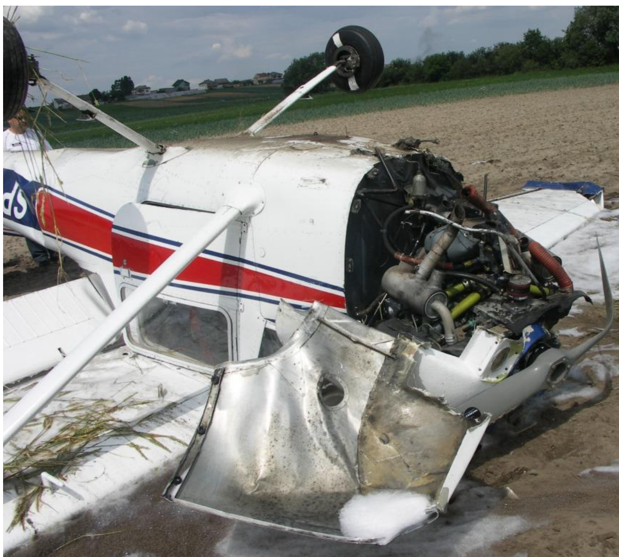
11 – Przednia część kadłuba rozbitego samolotu. Widoczne uszkodzenia łoża silnika i instalacji zespołu napędowego, zniszczone śmigło i dolna osłona silnika.
