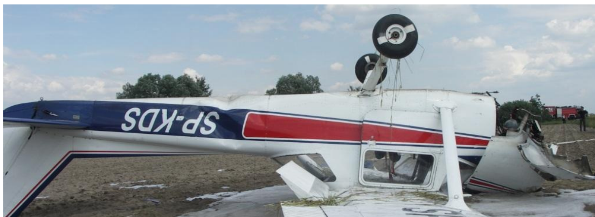
12 – Uszkodzenia kadłuba widoczne z lewej strony. Widoczna zniszczona dolna i fragment górnej osłony silnika.
