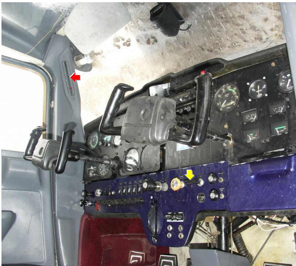
20 – Ogólny widok tablicy przyrządów i sterownic. Przełącznik sterowania klapami na pulpicie poziomym pod tablicą przyrządów oznaczony żółtą, a sygnalizator położenia klap na lewym słupku wiatrochronu - czerwoną strzałką.
