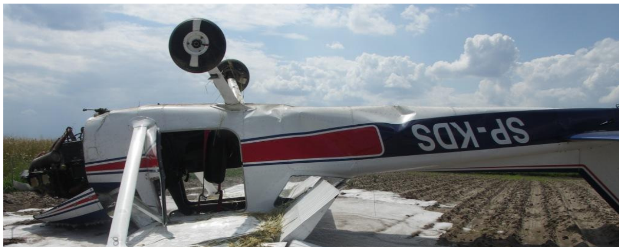
14 – Uszkodzenia kadłuba widoczne z prawej strony. Częściowo widoczna górna osłona silnika.
