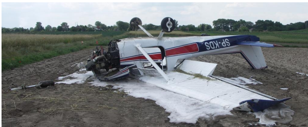
10 – Ogólny widok rozbitego samolotu z prawej strony. Dobrze widoczne uszkodzenia płatu i kłapy wychylone na maksymalny kąt.
