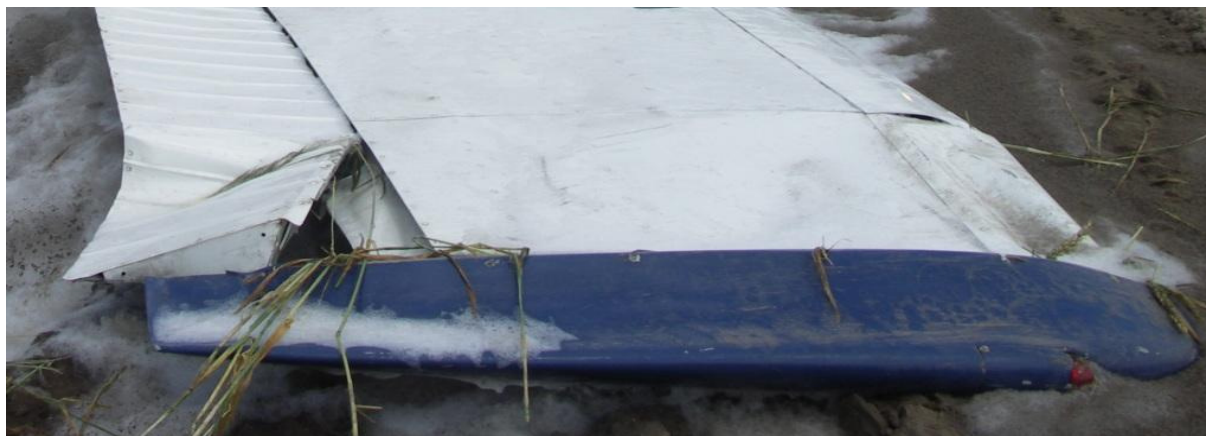
15 – Uszkodzona końcówka lewego skrzydła i lewej lotki.
