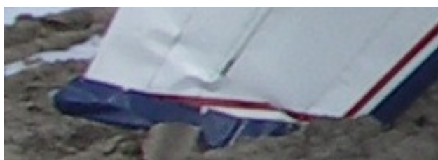
17 | 18 – Uszkodzona końcówka statecznika pionowego i steru kierunku z lewej i z prawej strony.
