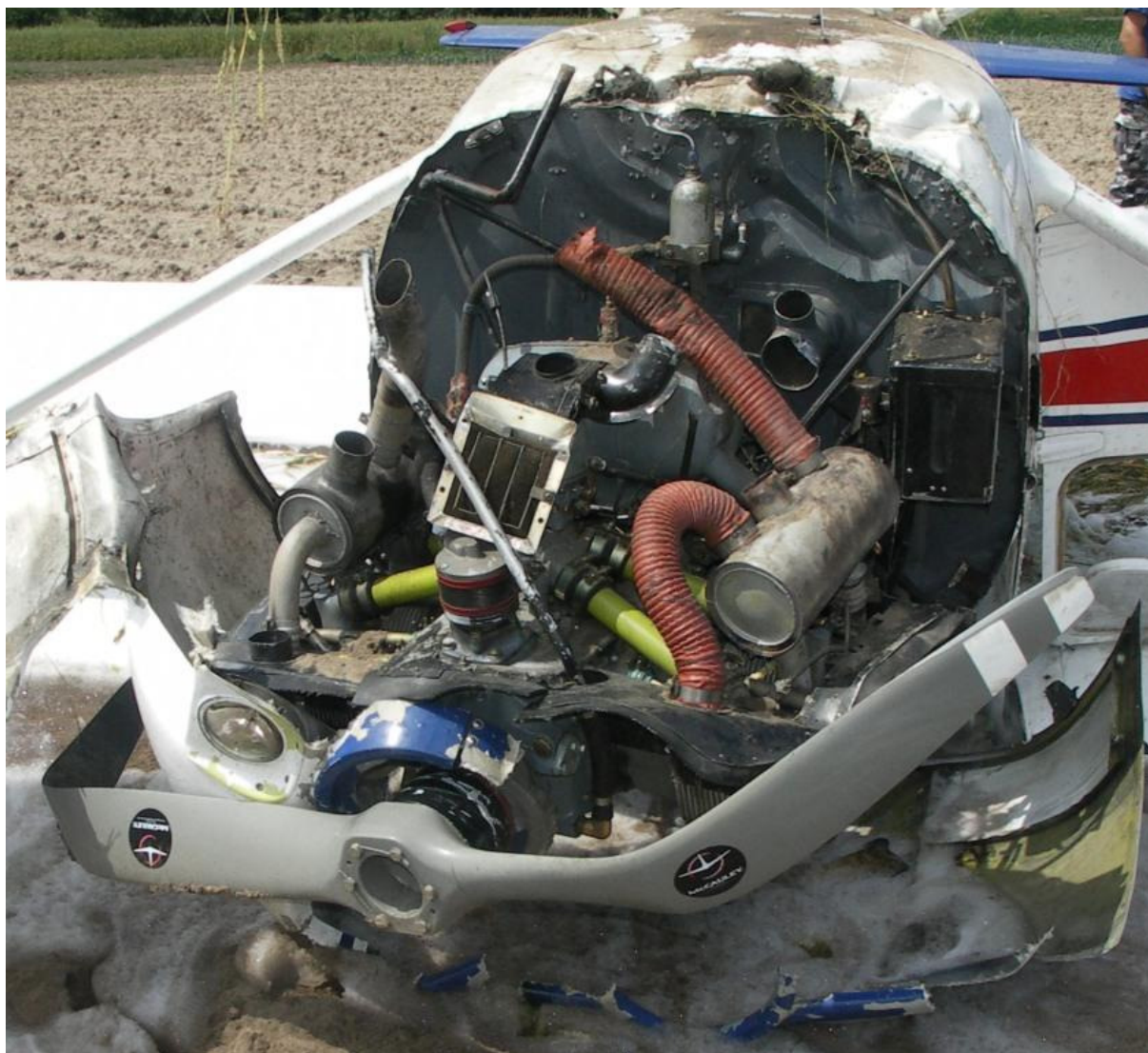
13 – Widok samolotu z przodu. Widoczny silnik odłamany wraz z łóżem od płatownca, wyłamane i uszkodzone agregaty i instalacje zespołu napędowego, zniszczone śmigło oraz zniszczona przegroda ogniowa, górna osłona silnika i dolne pokrycia przedniej części kadłuba.
