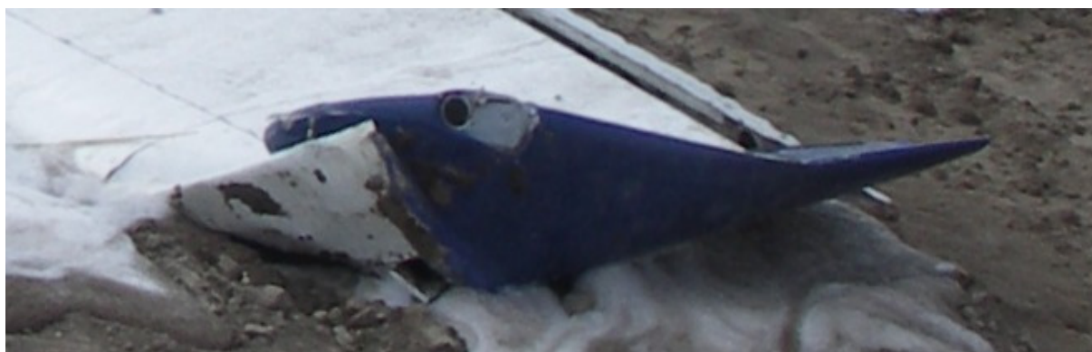
16 – Uszkodzona końcówka prawego skrzydła.
