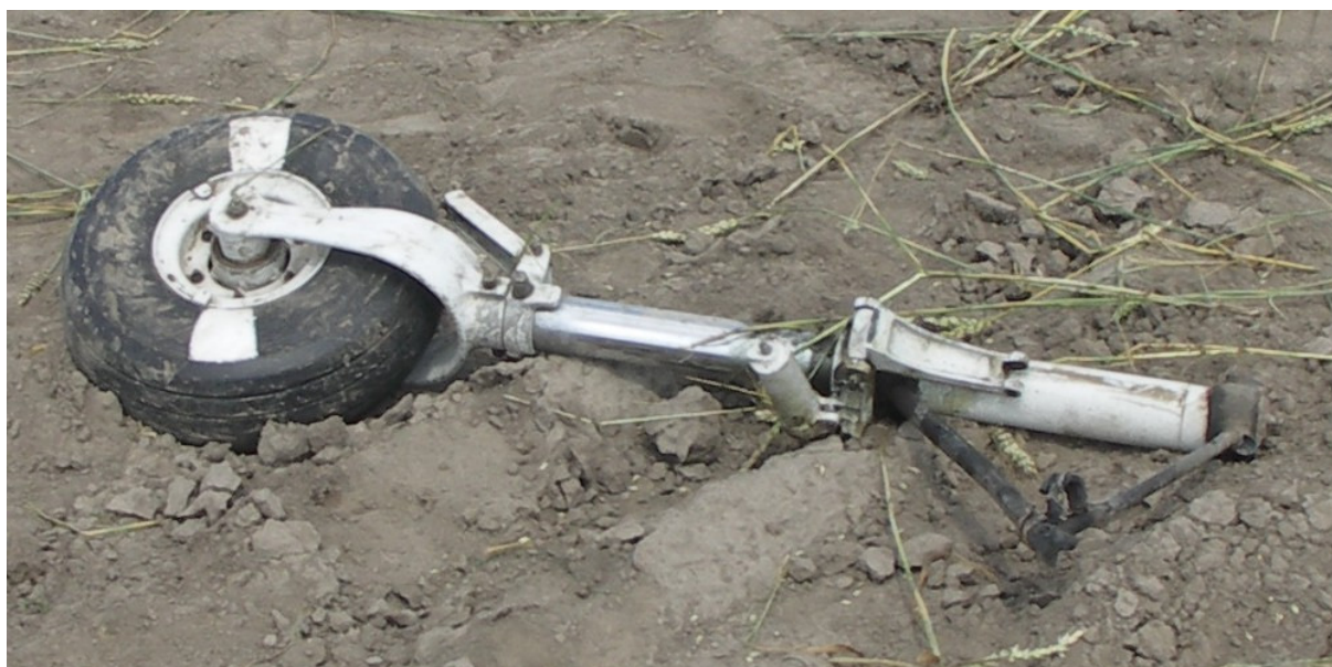
19 – Wyłamane podwozie przednie z fragmentem łoża silnika.
