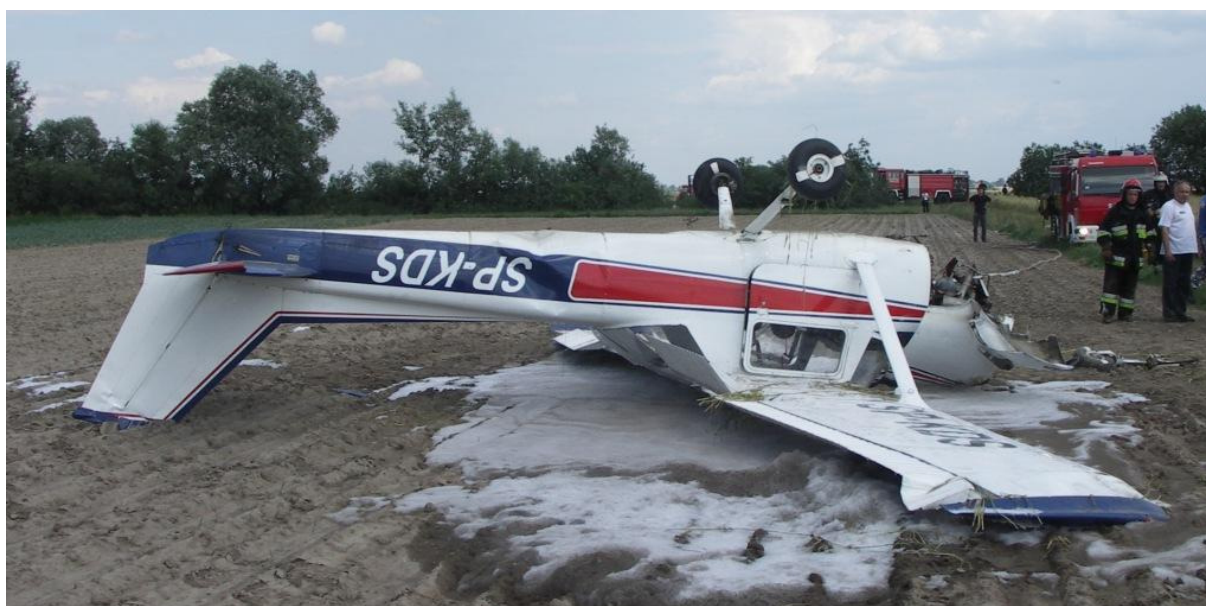
9 – Ogólny widok rozbitego samolotu z lewej strony. Dobrze widoczne uszkodzenia płatu i klapy wychylone na maksymalny kąt.
