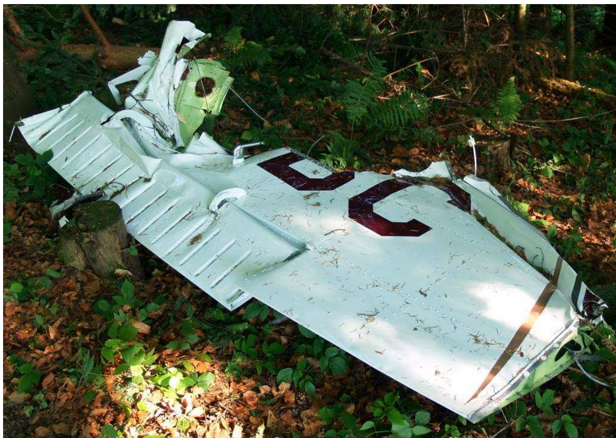
22 – Lewe skrzydło, oderwane wskutek kolizji z drzewami.
