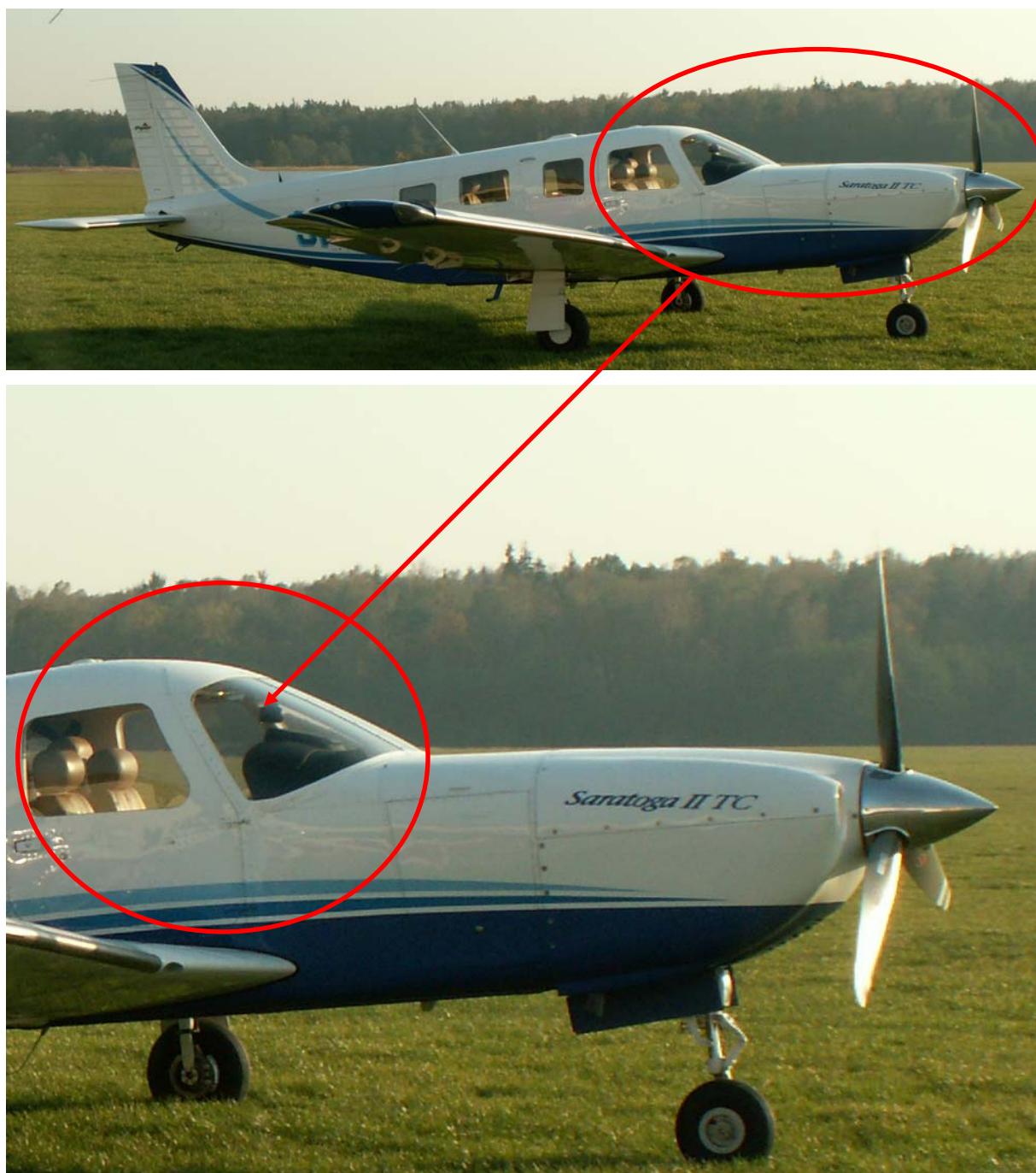
Fot. 6 Widok kabiny samolotu PIPER PA-32 – zwraca uwagę wysokie położenie górnej obudowy tablicy przyrządów w porównaniu do zagłówka fotela pilota
