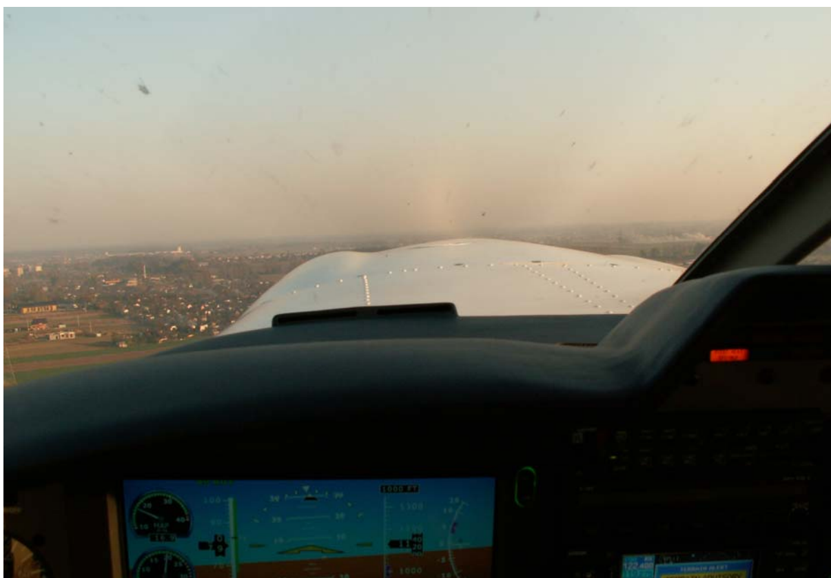
Fot. 9 Zdjęcia dokumentujące widoczność do przodu z miejsca pilota dla prędkości 85 kt i klap w pozycji „małe” – obserwacja na wprost
