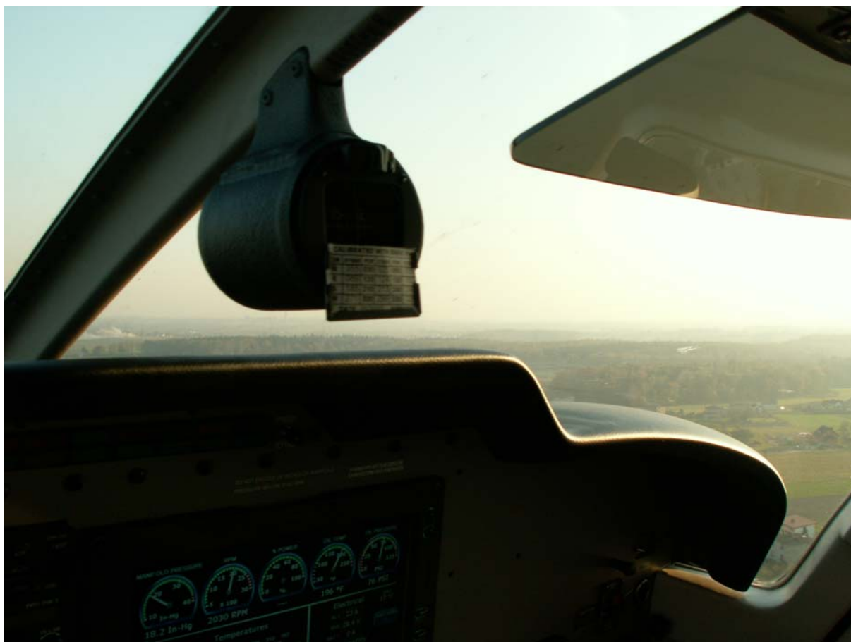
Fot. 10 Zdjęcia dokumentujące widoczność do przodu z miejsca pilota dla prędkości 85 kt i klap w pozycji „małe” – obserwacja w prawo
