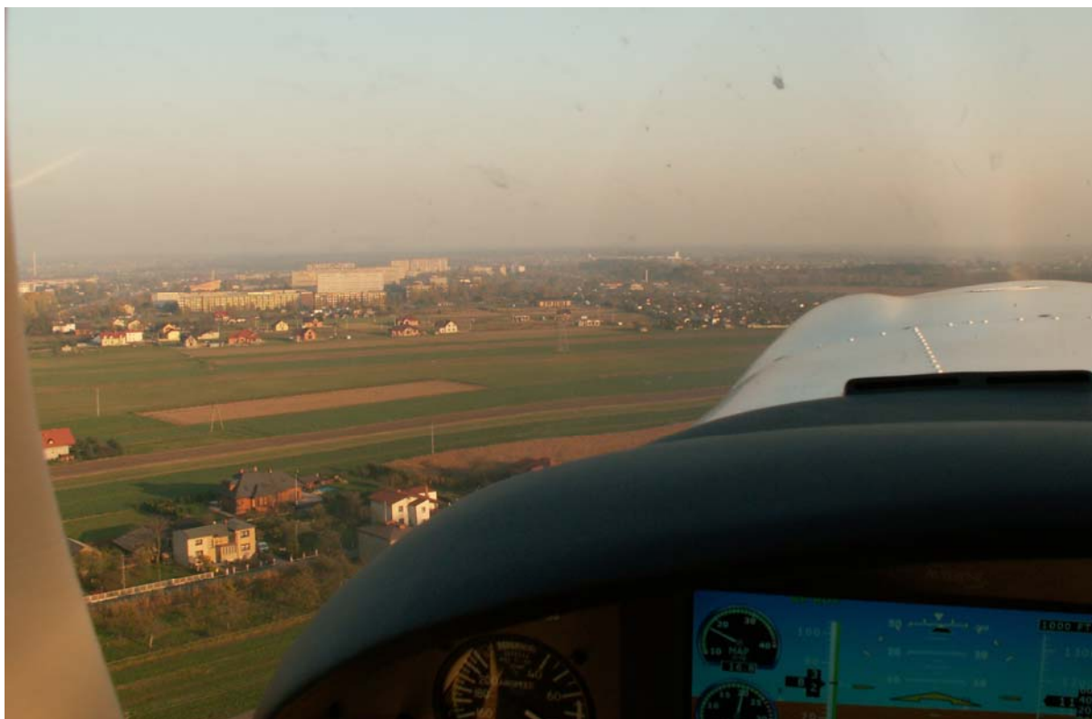
Fot. 8 Zdjęcia dokumentujące widoczność do przodu z miejsca pilota dla prędkości 85 kt i klap w pozycji „małe” – obserwacja w lewo
