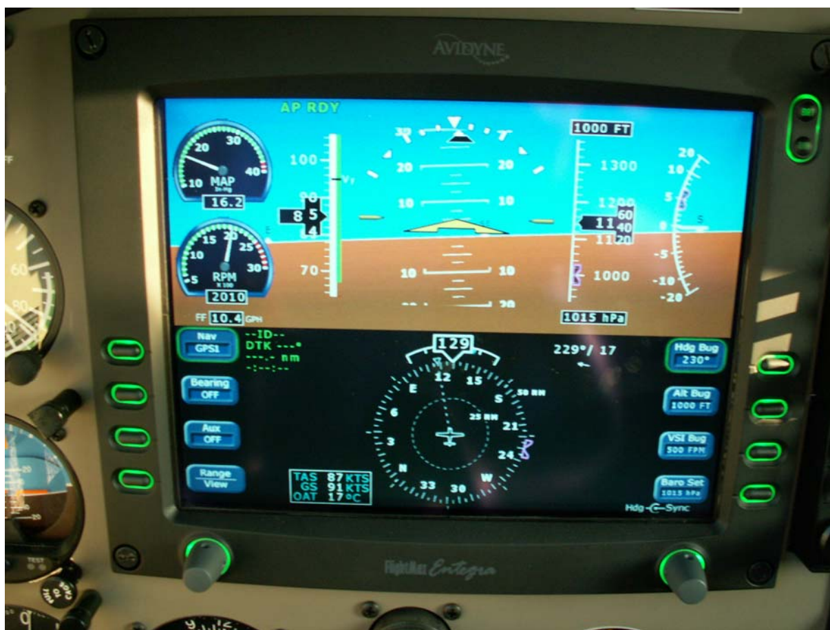
Fot. 7 Widok panelu z parametrami lotu samolotu. Kąt osi samolotu od linii horyzontu ponad 5°, prędkość lotu 85 kt (157 km/h), ciśnienie 1015 hPa, temperatura powietrza 17 °C, kłapy w pozycji „małe”
