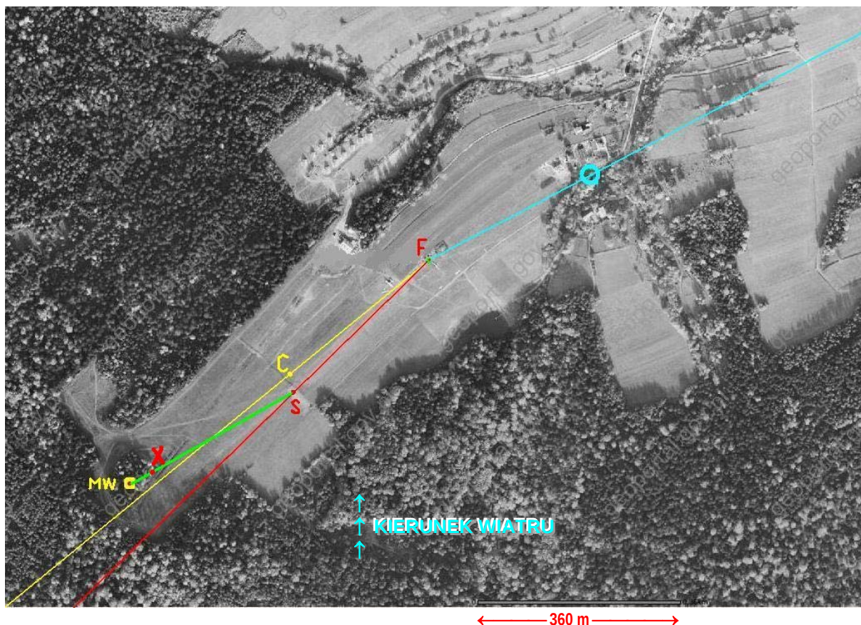
Ryc. 1 Zobrazowanie usytuowania najważniejszych dla analizy wypadku punktów i linii na zdjęciu lotniczym lądowiska w Weremieniu i jego otoczenia: punkt F – miejsce, w którym znajdował się fotograf wykonujący zdjęcia [„kwadrat”]; punkt C – cień samolotu na ziemi w chwili wykonywania zdjęcia nr 3a/4 (Album Zdjęć); punkt S – rzut położenia samolotu w chwili wykonywania zdjęcia nr 3a/4; punkt X – miejsce pierwszego kontaktu samolotu z koronami drzew, punkt MW – miejsce wypadku. W dolnej części zdjęcia podziałka liniowa.
