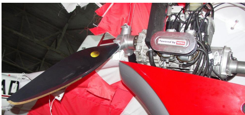
17 i 18 – Zespół napędowy pokazany z tyłu i z prawej strony od dołu, widoczne śmigło z odłamaną łopata
