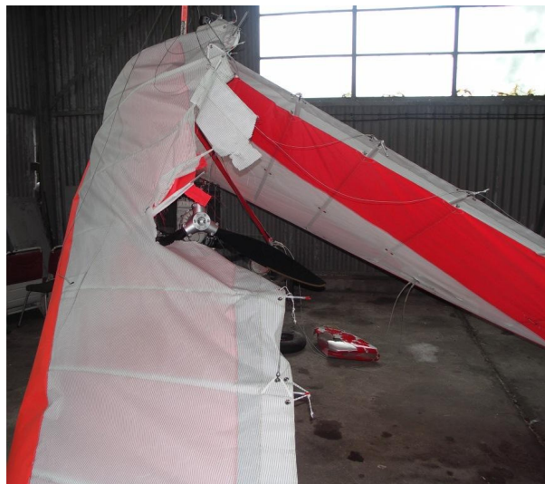
4 – Ogólny widok motolotni po wypadku – lewa strona. Widoczne podarte pokrycie.
