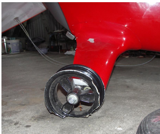
13 i 14 – Uszkodzone podwozie ze zniszczonym prawym kołem.
