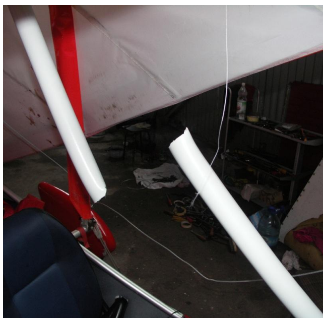
7 – Złamany w ok. ½ długości przedni wspornik masztu.
