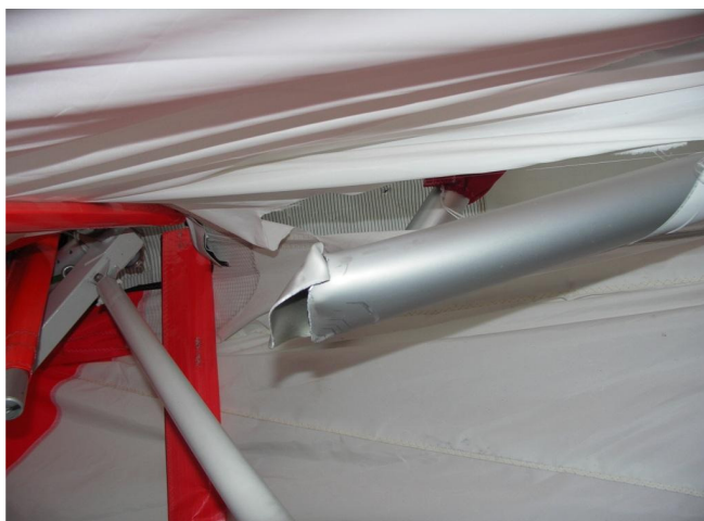
6 – Kil złamany przed przegubem masztu.
