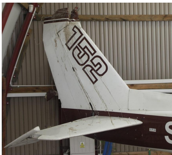
34 – Usterzenie pionowe, prawa strona; widoczne zniszczenia w części górnej.
