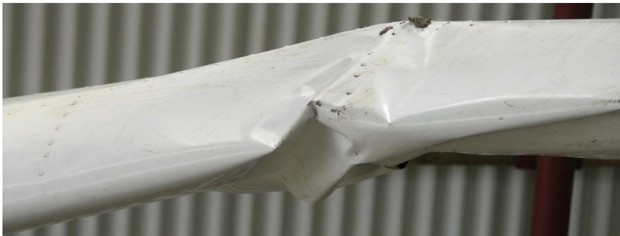
24 – Krawędź natarcia złamanego prawego skrzydła.
