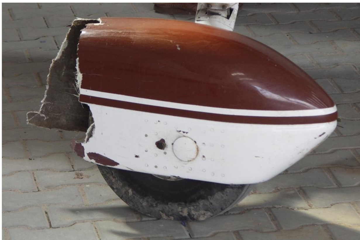
22 – Uszkodzona owiewka koła prawego podwozia głównego.
