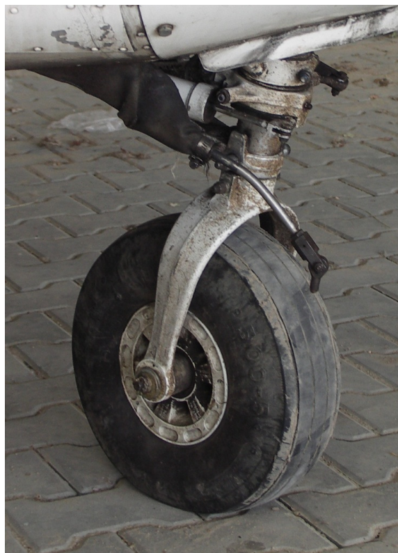
21 – Podwozie przednie, prawa strona, widoczne zerwane elementy sterowania kołem i nienormalne położenie goleni.
