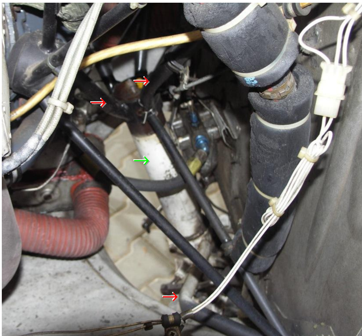
19 – Goleń podwozia przedniego (→) wyłamana wraz z łożem silnika, zaznaczone zniszczenia łoża silnika (→).
