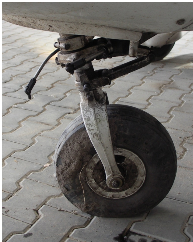
20 – Podwozie przednie, lewa strona, widoczne zerwane elementy sterowania kołem i nienormalne położenie goleni.
