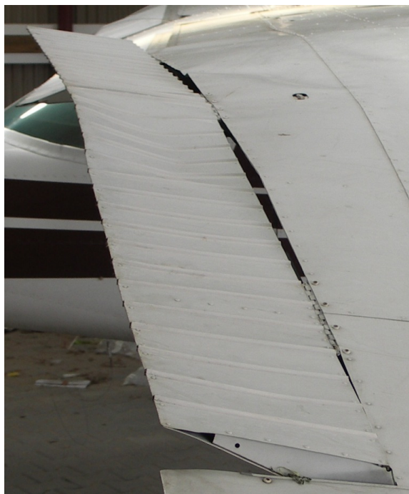
31 – Zniszczona prawa lotka od góry.
