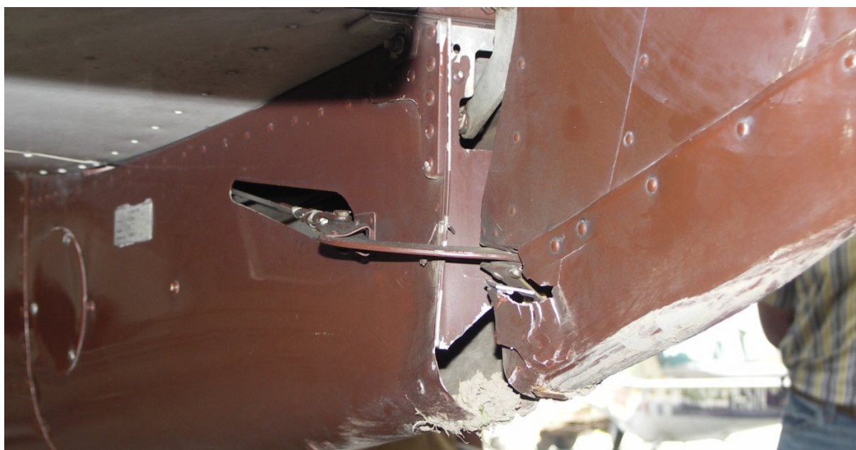
36 – Uszkodzenia spodu kadłuba pod usterzeniem i dolnej części steru kierunku.
