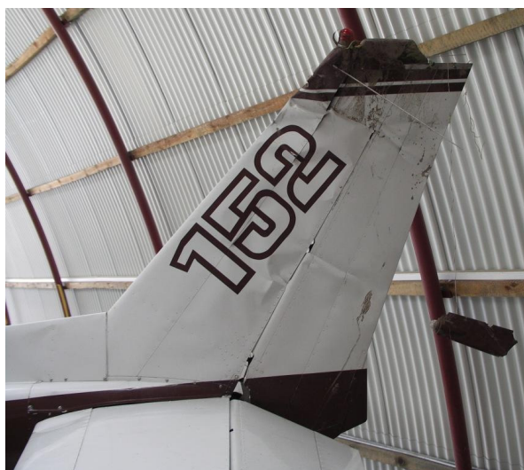
35 – Usterzenie pionowe, lewa strona; widoczne zniszczenia w części górnej.
