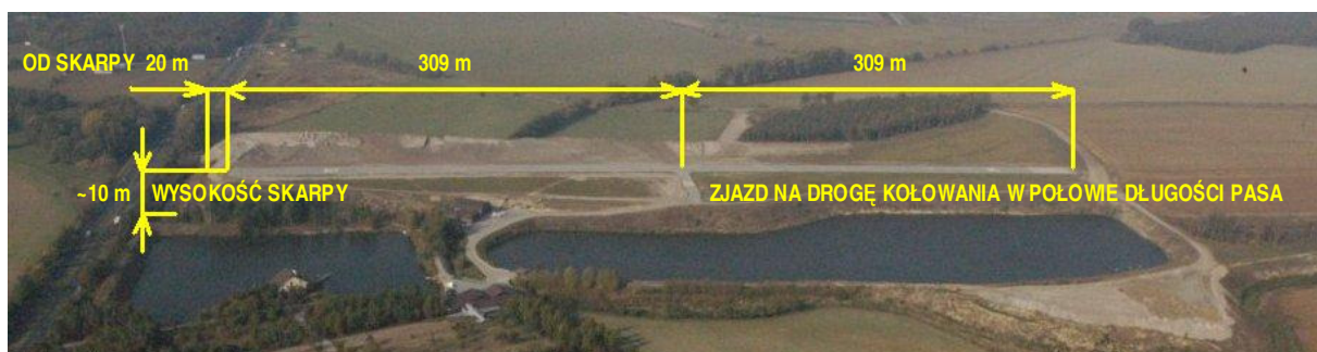
Rys. B-1. Widok drogi startowej (DS) z powietrza w kierunku prostopadłym do podejścia z naniesionymi elementami sytuacyjnymi i wymiarami
