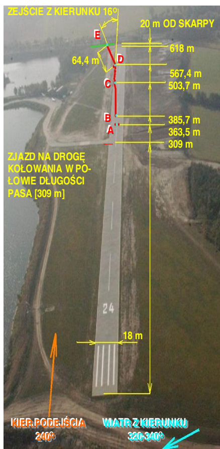
Rys. B-2. Widok drogi startowej (DS) z powietrza w kierunku podejścia z naniesionymi elementami sytuacyjnymi i wymiarami
