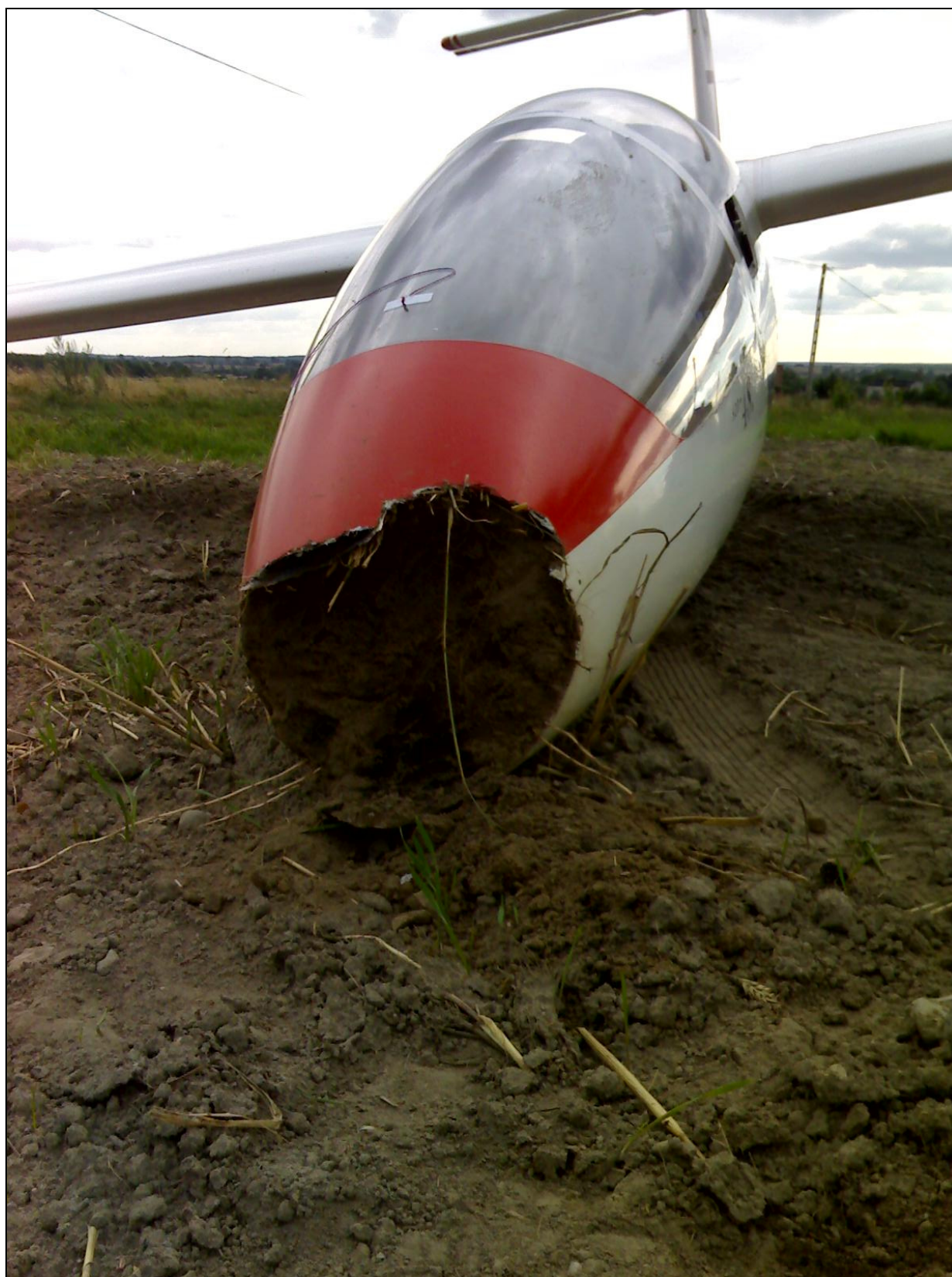
7 – Uszkodzenia kadłuba po wyciągnięciu szybowca z miejsca wypadku.
