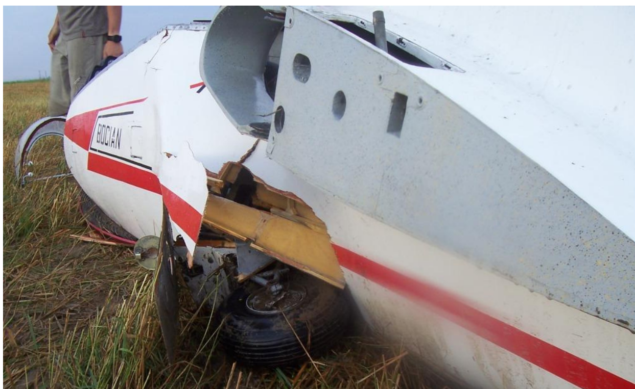
10 – Lewa strona kabinowej części kadłuba po zdemontowaniu skrzydła. Widoczne przełamanie kadłuba, wyłamane podwozie główne i uszkodzona płoza.
