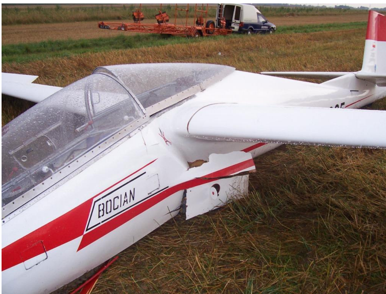
8 – Lewa strona kabinowej części kadłuba, widoczne uszkodzenia.
