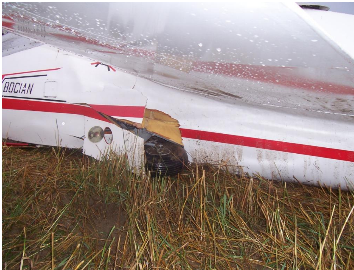
9 – Lewa strona kabinowej części kadłuba spod skrzydła, widoczne uszkodzenia i ślad podwozia na ziemi.
