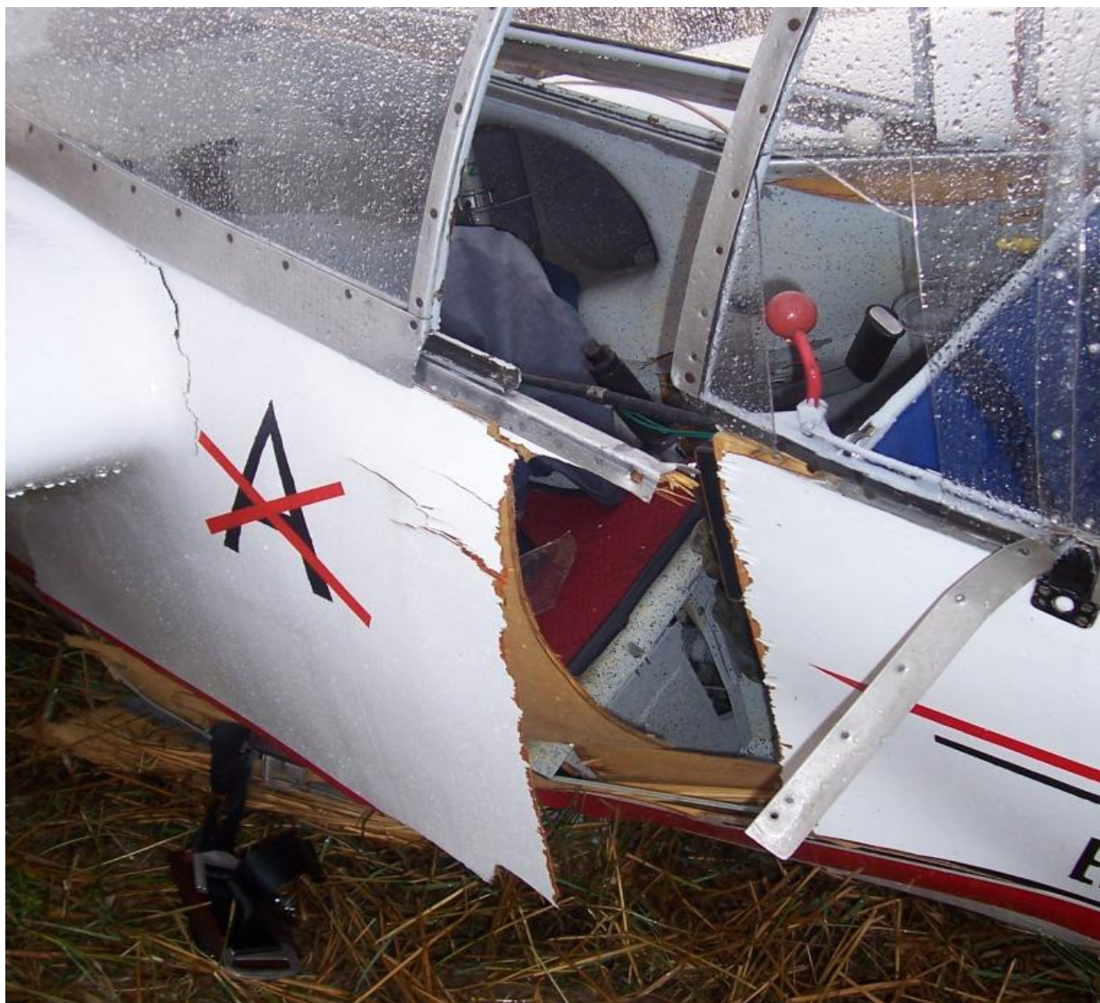
13 – Prawa strona kabinowej części kadłuba, widoczne uszkodzenia pokryć i oszklenia kabiny.
