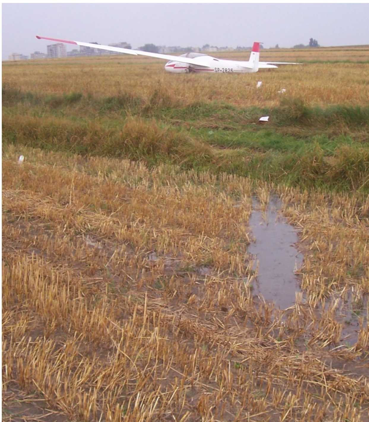
4 – Ślad pierwszego przyziemienia, na drugim planie widoczne drobne szczątki.
