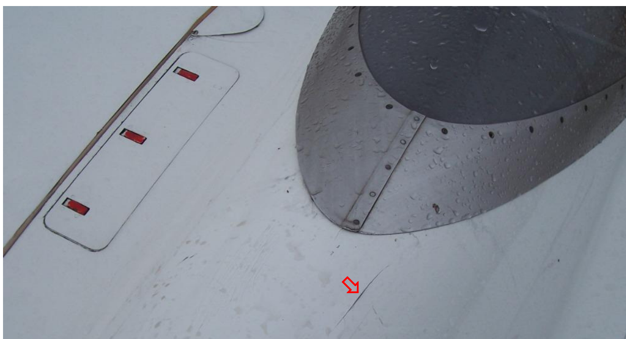
14 – Pęknięcie pokrycia na grzbiecie kadłuba za kabiną.
