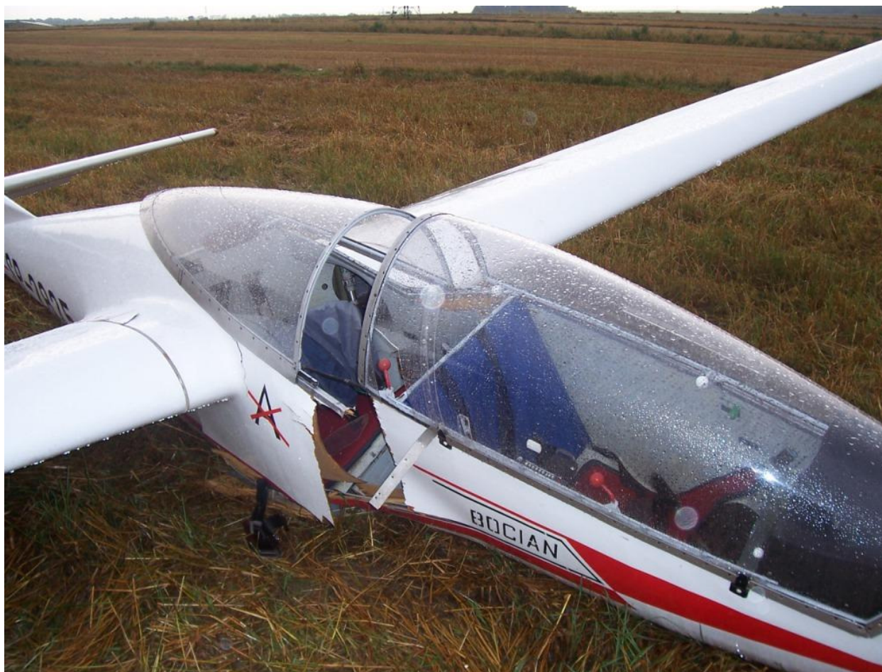
12 – Prawa strona kabinowej części kadłuba, widoczne uszkodzenia – odłamanie przodu kadłuba.
