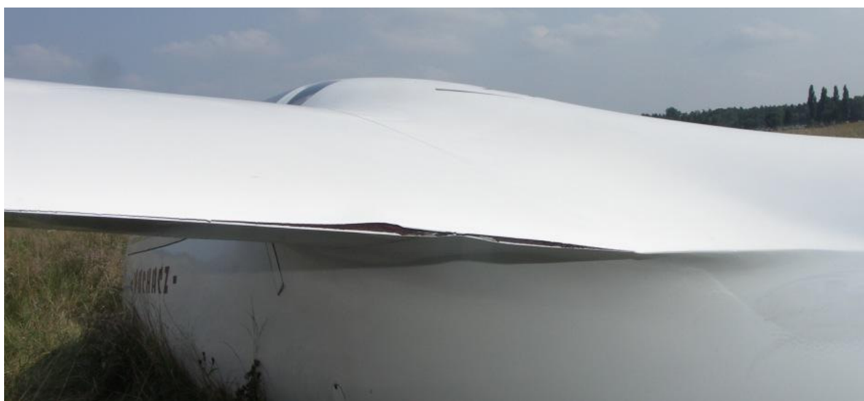
6 – Rozklejenie pokryć górnego i dolnego na krawędzi spływu lewego skrzydła u nasady.
