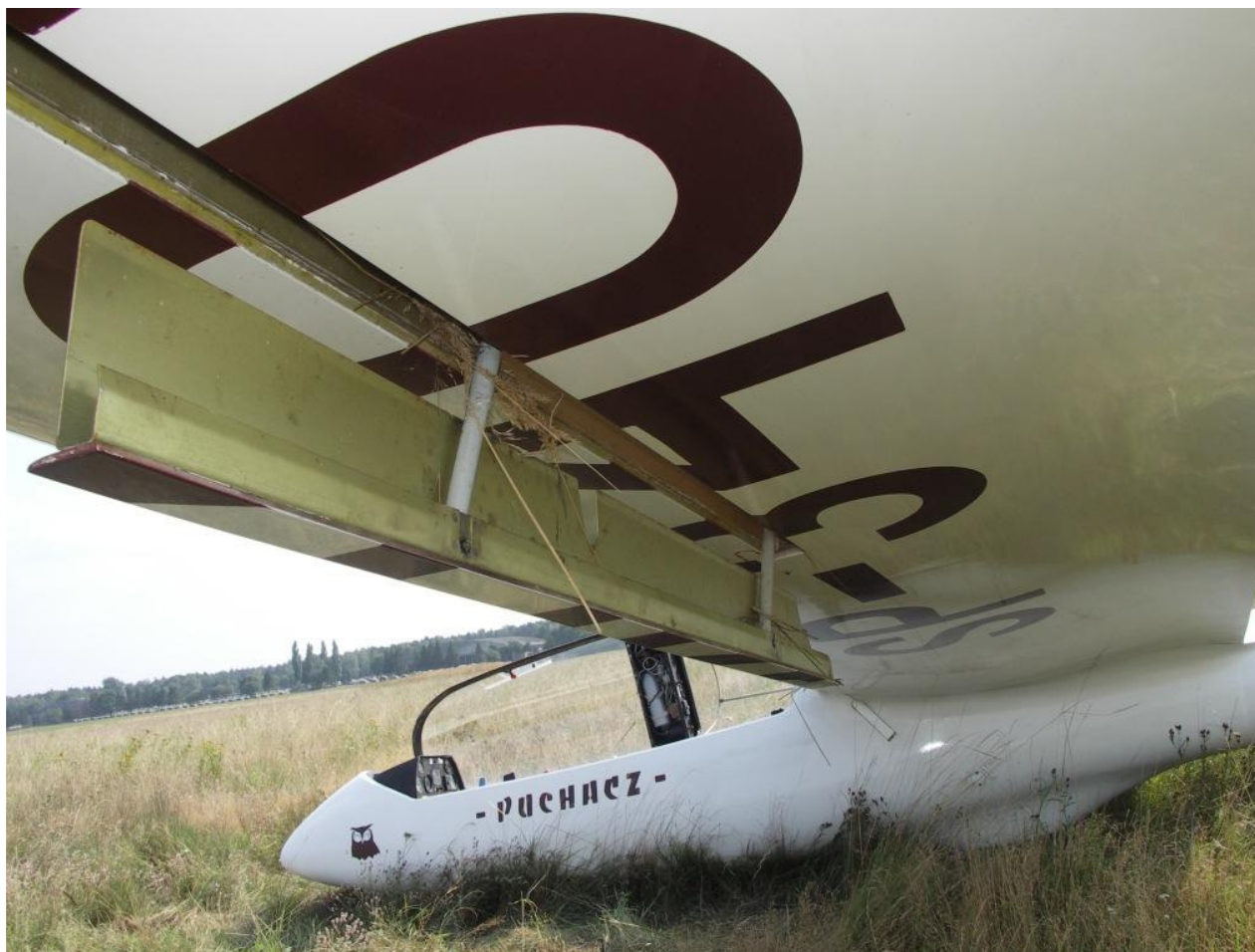
5 – Widok na dolną powierzchnię lewego skrzydła z wysuniętym hamulcem aerodynamicznym.
