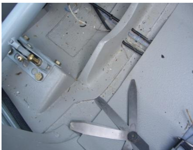
24 i 25 – Odwarstwienia elementów strukturalnych przy wrzędze kadłuba, ukazane za pomocą szczelinomierza.
