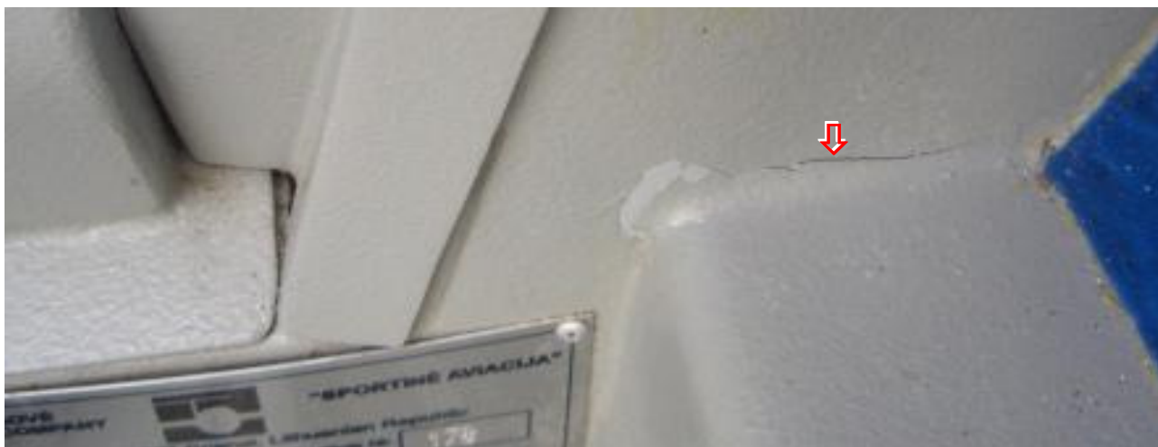
22 – Uszkodzenia struktury przy ścianie tylnej wręgi kabiny z lewej burty kadłuba.
