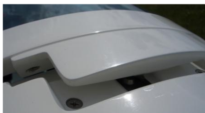
5, 6, 7 – Niedoleganie tylnej krawędzi osłony kabiny i uszkodzenia w rejonie haka Roegera.
