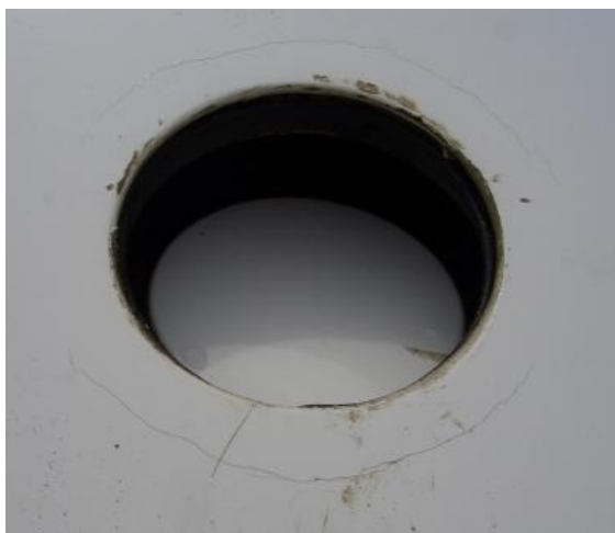
30 i 31 – Wyraźnie widoczne odlaminowanie tulei od struktury dźwigarów skrzydeł.
