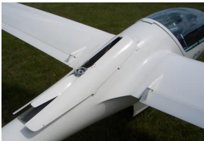
8 i 9 – Niedomykające się wskutek odkształceń struktury pokrywy wnęki chowanego zespołu napędowego.
