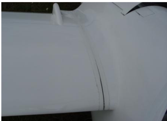
16 – Nosek prawego skrzydła przy kadłubie – widoczna szpara między żebrą nasadowym skrzydła a żebrą kadłuba, spowodowana odkształceniem.
