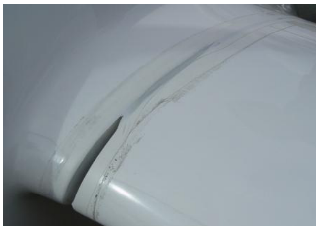
17 – Nosek lewego skrzydła przy kadłubie – widoczna duża szpara między żebrą nasadowym skrzydła a żebrą kadłuba, spowodowana odkształceniem.
