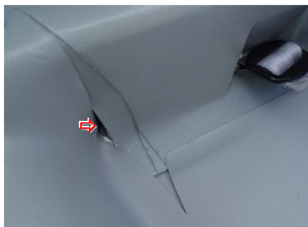
26 i 27 – Uszkodzenia elementów wykładzin wnętrza kabiny i ich zamocowań do struktury.
