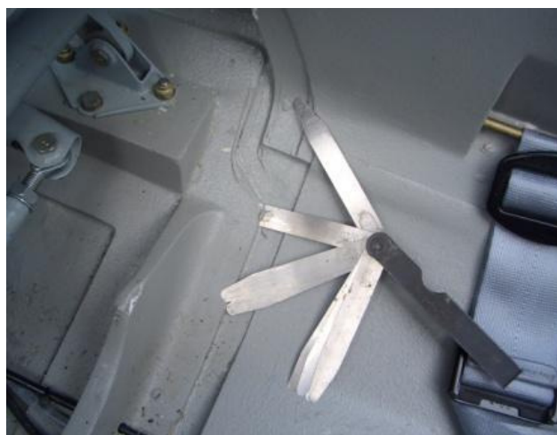
24 i 25 – Odwarstwienia elementów strukturalnych przy wrzędze kadłuba, ukazane za pomocą szczelinomierza.
