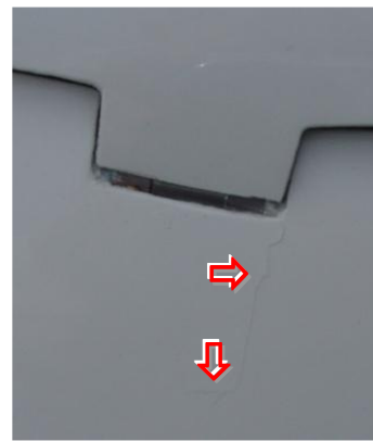
10 – Niedomykające się wskutek odkształceń struktury pokrywy wnęki chowanego zespołu napędowego (z lewej).
