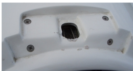
5, 6, 7 – Niedoleganie tylnej krawędzi osłony kabiny i uszkodzenia w rejonie haka Roegera.
