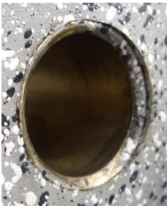
30 i 31 – Wyraźnie widoczne odlaminowanie tulei od struktury dźwigarów skrzydeł.
