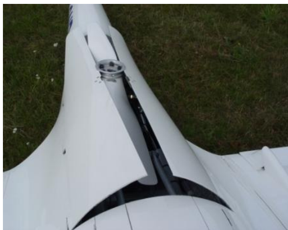
8 i 9 – Niedomykające się wskutek odkształceń struktury pokrywy wnęki chowanego zespołu napędowego.
