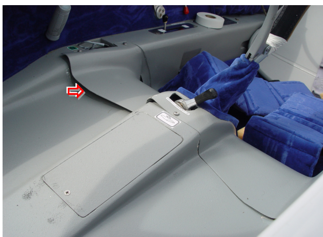
26 i 27 – Uszkodzenia elementów wykładzin wnętrza kabiny i ich zamocowań do struktury.
