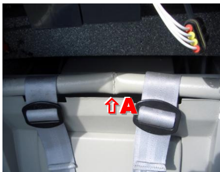
18, 19, 20 – Uszkodzenia wręgi kadłuba i jej właminowania w pokrycia – pęknięcia kompozytu i złamanie rury [A].
