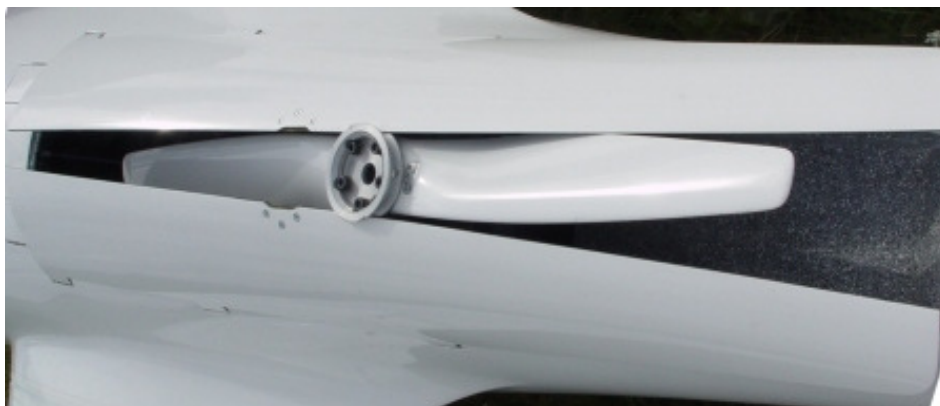
10 – Niedomykające się wskutek odkształceń struktury pokrywy wnęki chowanego zespołu napędowego (z lewej).
