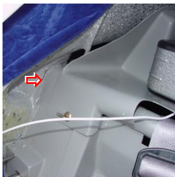
18, 19, 20 – Uszkodzenia wręgi kadłuba i jej właminowania w pokrycia – pęknięcia kompozytu i złamanie rury [A].
