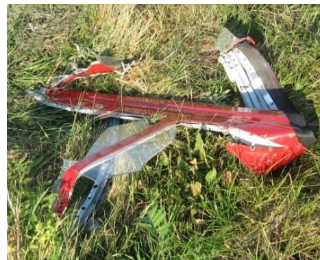
48 – Fragment szkieletu osłon kabiny SP-ELE.
