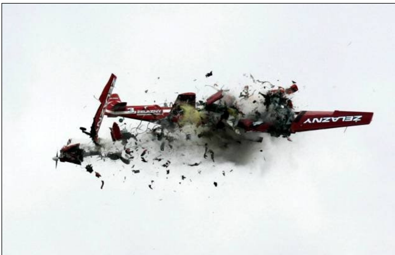
10 – Zderzenie i rozpadanie się samolotów SP-ELE i SP-CDF; za nimi widoczny mijający je SP-CSU. Widać rozpadający się na elementy samolot SP-ELE, pocięty śmigłem samolotu SP-CDF oraz rozprzestrzeniającą się jasną chmurę paliwa wylanego z systemu paliwowego i żółtą chmurę oleju z systemu olejowego samolotu SP-ELE.
