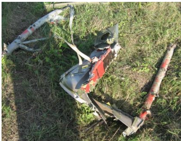
41 – Fragment wręgi kadłuba z resztkami zerwanych barkowych pasów pilota samolotu Zlin Z-526AFS SP-ELE.
