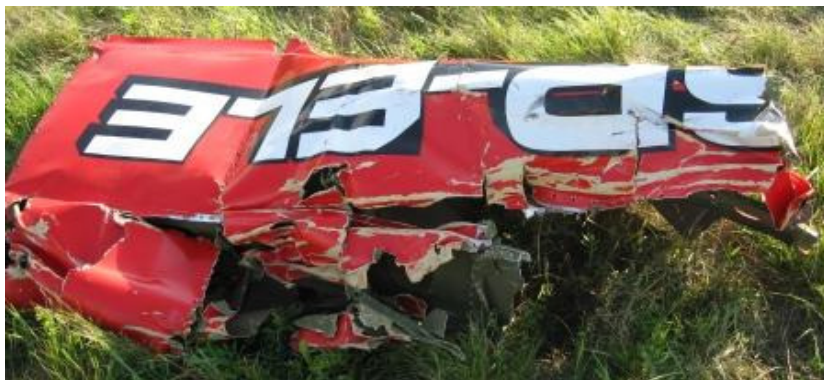
47 - Fragment struktury skrzydła samolotu Zlin Z-526AFS SP-ELE.
