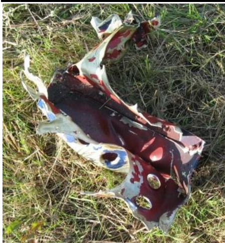
34 – Fragment struktury skrzydła.
