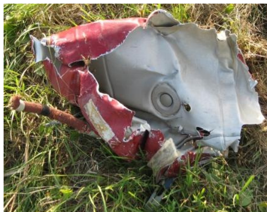
54 – Fragment struktury skrzydła SP-ELE z widocznym płaszczem zbiornika paliwa.
