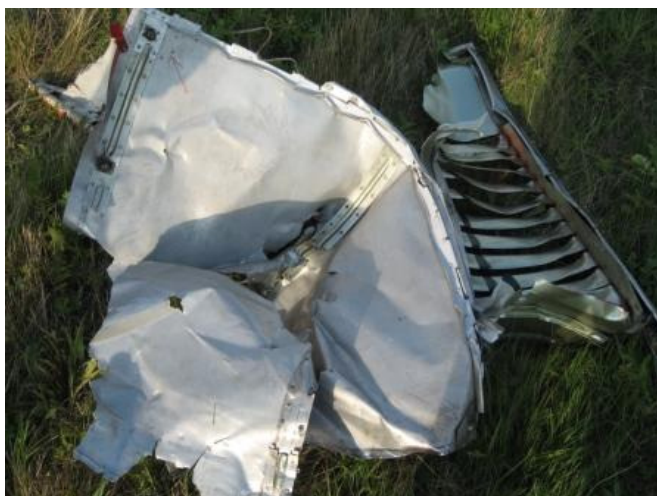
56 – Resztki osłony silnika samolotu Zlin Z-526AFS SP-ELE.
