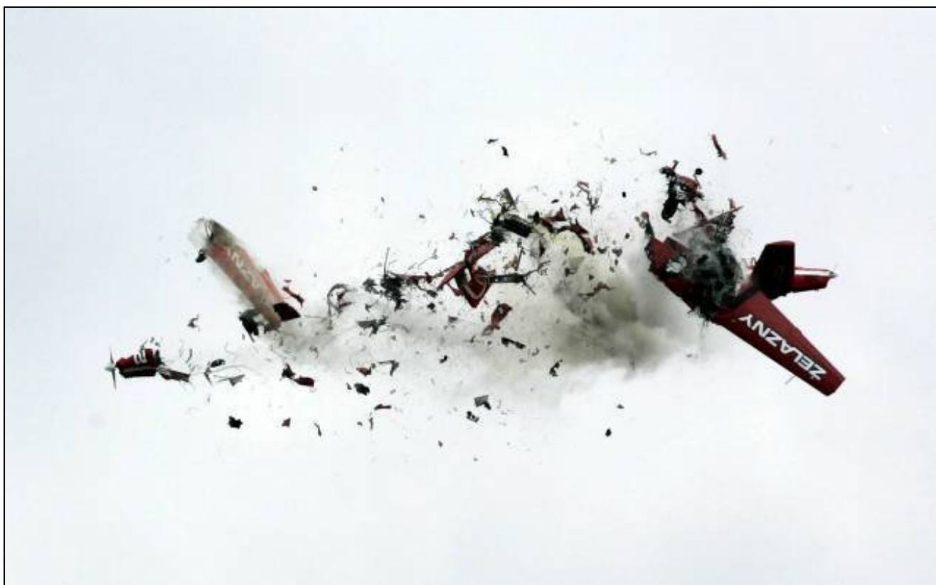
11 – Rozpadanie się samolotów SP-ELE i SP-CDF po zderzeniu; za nimi widoczny mijający je SP-CSU. Widać rozpadający się na elementy samolot SP-ELE (którego szczątki lecą w lewą stronę kadru) oraz samolot SP-CDF ze złamanym kadłubem i oderwaną częścią prawego skrzydła (po prawej stronie kadru).
