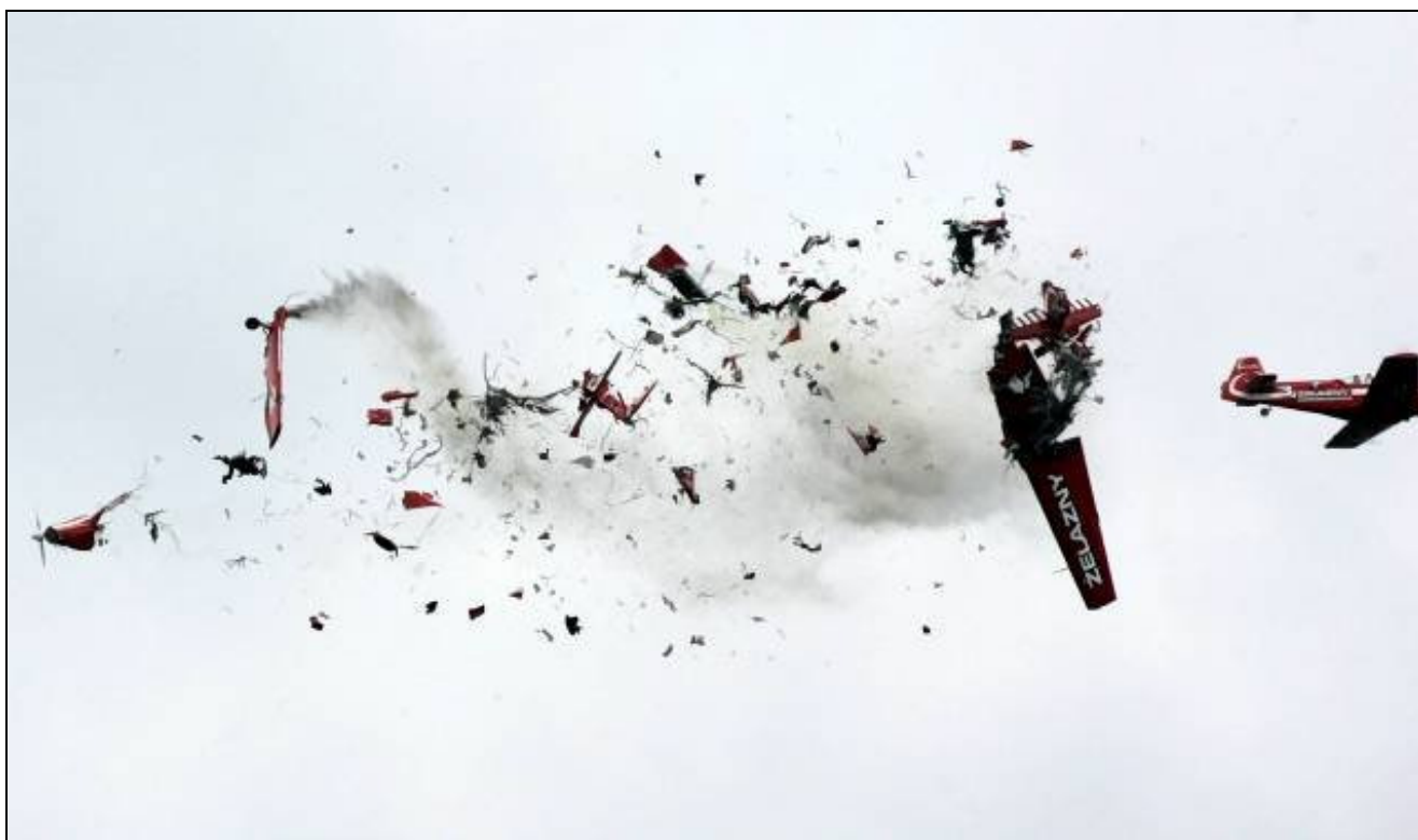
12 – Rozpadanie się samolotów SP-ELE i SP-CDF po zderzeniu; po prawej za nimi widoczny mijający je SP-CSU. Widać rozpadający się na elementy samolot SP-ELE i opadający SP-CDF ze złamanym kadłubem i odciętą końcówką prawego skrzydła.
