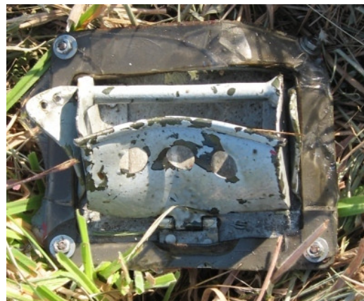
40 – Stopień wyrwany z kadłuba samolotu Zlin Z-526AFS SP-ELE.
