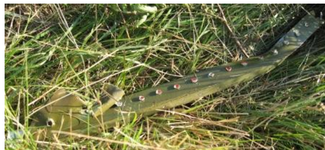
46 – Podłużnica wyrwana ze struktury skrzydła SP-ELE.
