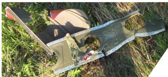
49 - Fragment struktury skrzydła samolotu Zlin Z-526AFS SP-ELE.
