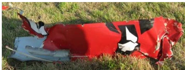
50 – Fragment pokrycia grzbietu kadłuba samolotu Zlin Z-526AFS SP-ELE.
