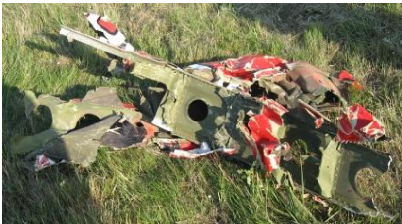
44 – Fragment struktury skrzydła samolotu Zlin Z-526AFS SP-ELE.
