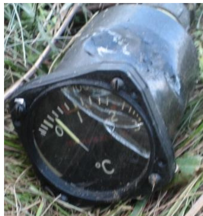
39 – Termometr wyrwany z tablicy przyrządów SP-ELE
