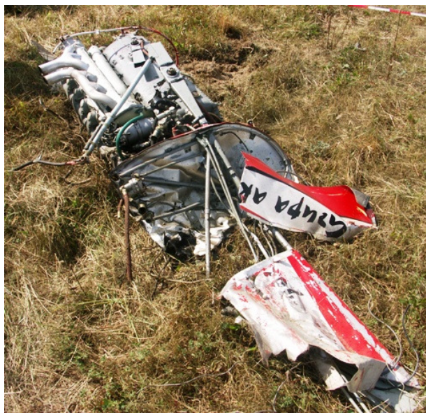
58 – Silnik samolotu Zlin Z-526AFS SP-ELE i szczątki kadłuba.
