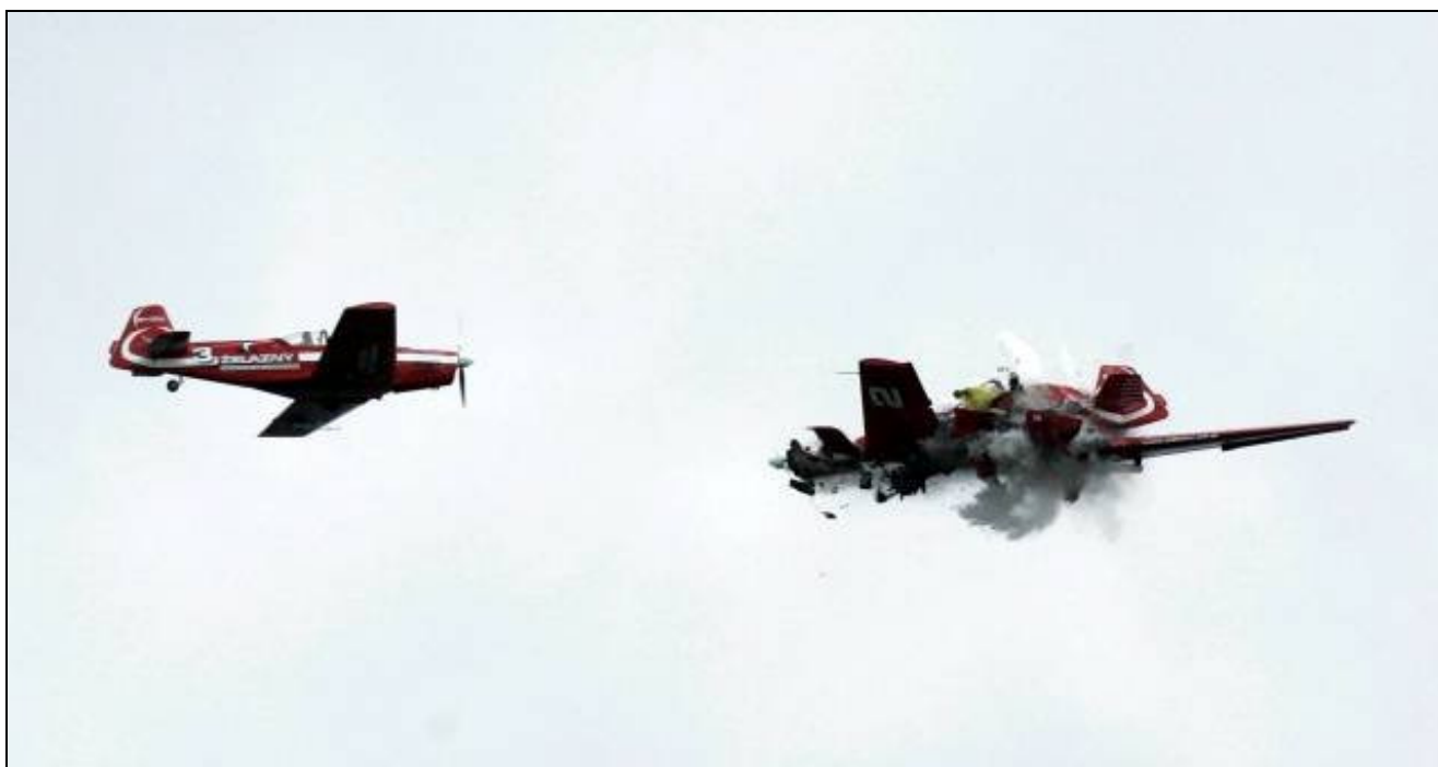
9 – Zderzenie i początek rozpadania się samolotów SP-ELE i SP-CDF; początek formowania się chmury paliwa wylanego z systemu paliwowego samolotu SP-ELE. Z lewej samolot SP-CSU.
