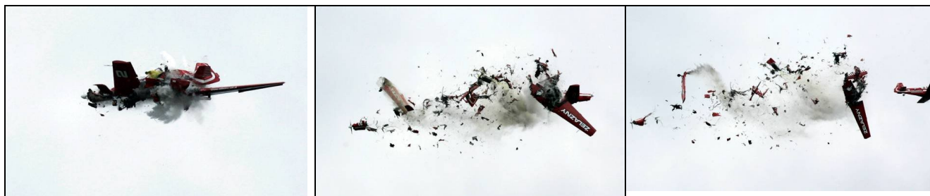
8 a, b, c, d, e, f – Inna sekwencja 6 zdjęć, pokazująca zbliżenie, mijanie, zderzenie i rozpadanie się zniszczonych samolotów
