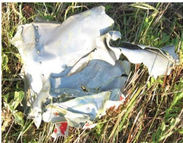
55 - Fragment struktury skrzydła samolotu Zlin Z-526AFS SP-ELE.
