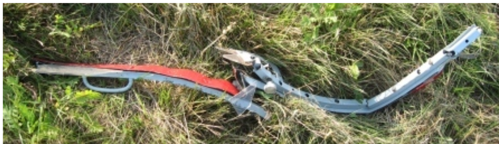
51 – Fragmenty ramy oszklenia osłony kabiny samolotu Zlin Z-526AFS SP-ELE z widocznym uchwytem zamka i uchwytem do otwierania.
