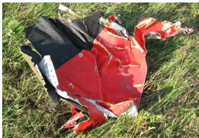
31 – Fragment pokrycia skrzydła samolotu Zlin Z-526AFS SP-ELE.
