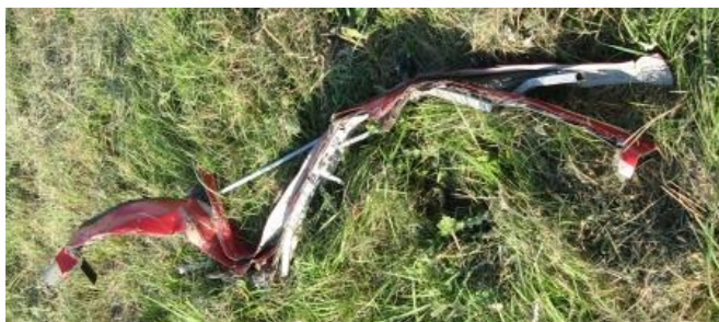
45 – Fragment pokrycia kadłuba w rejonie kabiny SP-ELE.
