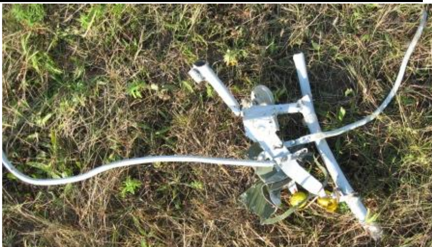
35 – Wyrwane z kadłuba elementy sterowania silnikiem z widocznymi manetkami.
