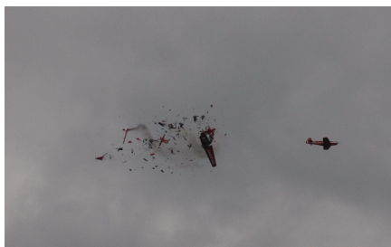
16a – Szczątki SP-ELE i SP-CDF ze złamanym kadłubem; z prawej mijający je SP-CSU
