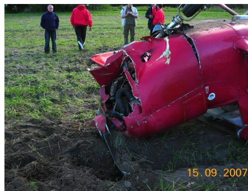
5 i 6– Przednia część kadłuba samolotu, widoczne zniszczone śmigło i osłony silnika oraz wyłamane podwozie przednie.
