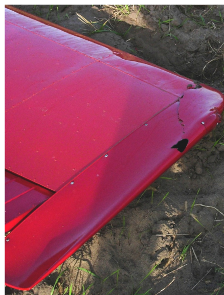
9 - Uszkodzona końcówka lewego skrzydła.
