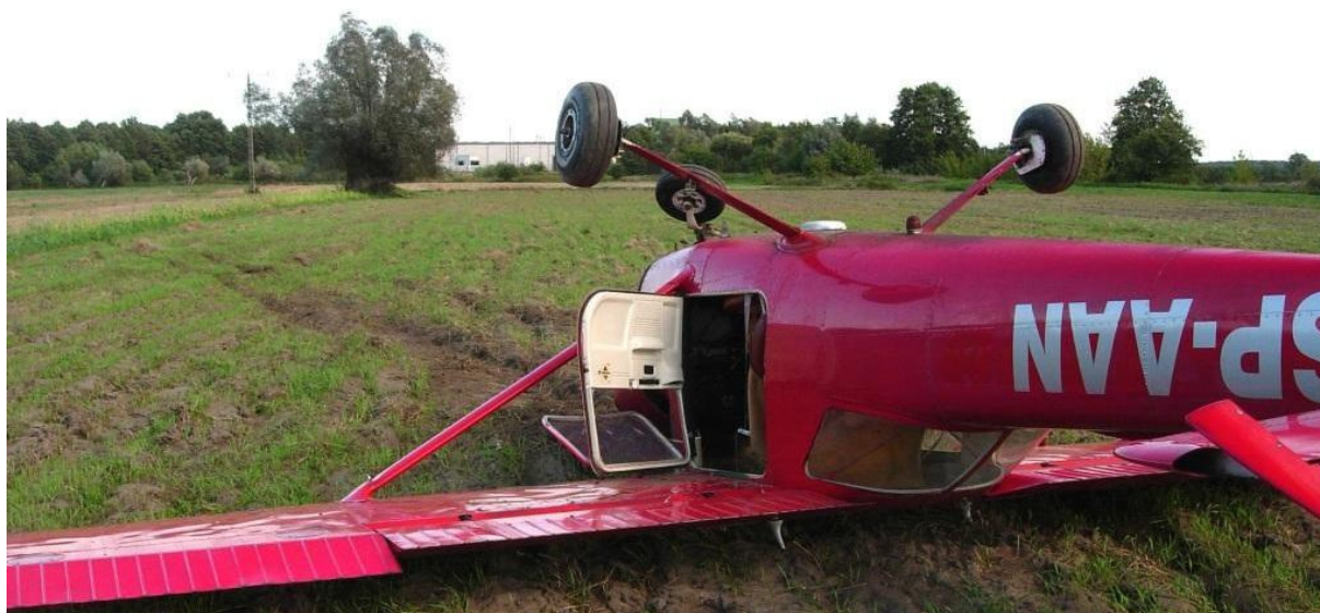
3 – Samolot na miejscu wypadku, prawa strona \frac{3}{4} od tyłu, widoczny ślad przyziemienia na zaoranym gruncie.
