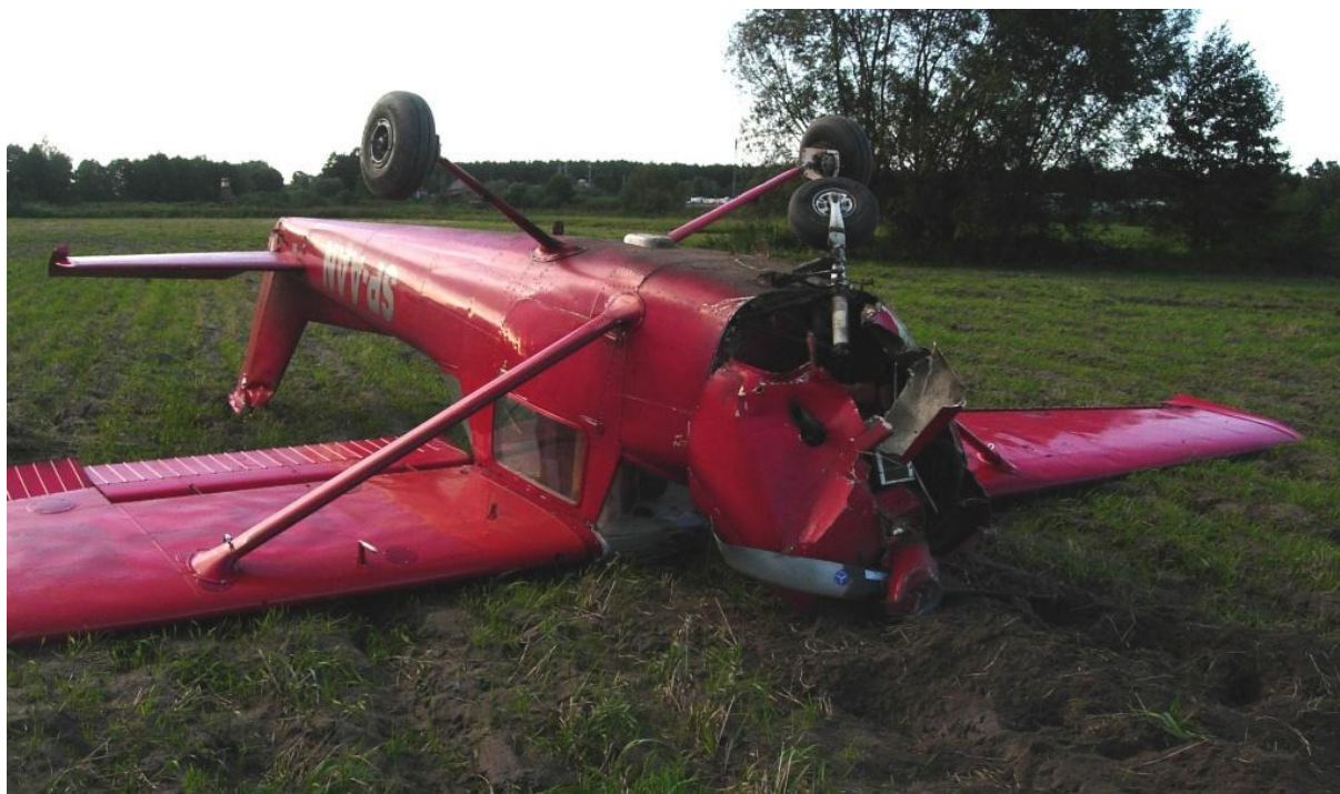
7 – Ogólny widok samolotu na miejscu wypadku, lewa strona \frac{3}{4} od przodu. Widoczne zniszczone śmigło, osłony silnika i wyłamane podwozie przednie.
