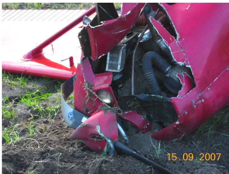
8 - Zniszczone śmigło z kotpakiem, osłony i deflektory silnika.
