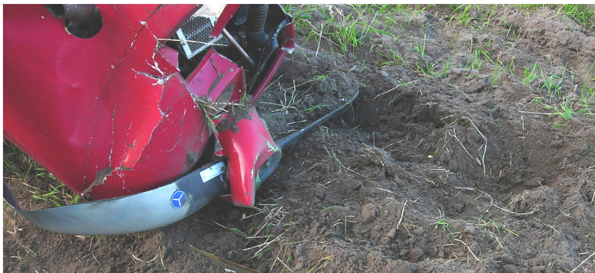
Fot. 2 Uszkodzenia śmigła samolotu
