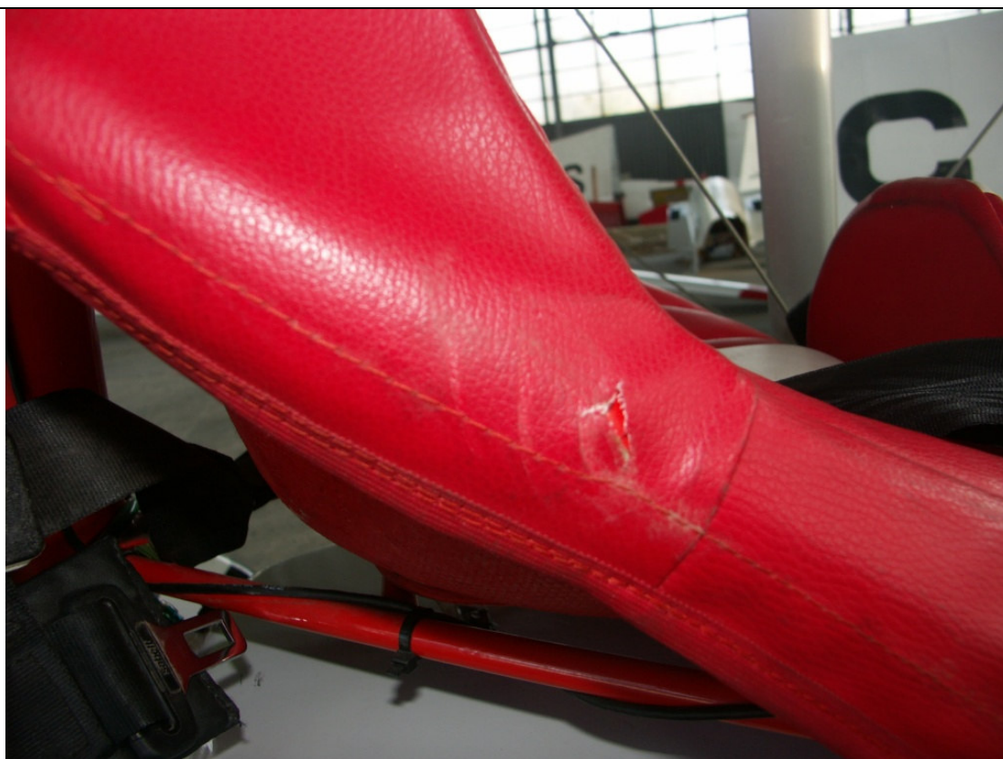
Zbliżenie śladów zderzenia na tylnym siedzeniu motolotni SP-MAXI
