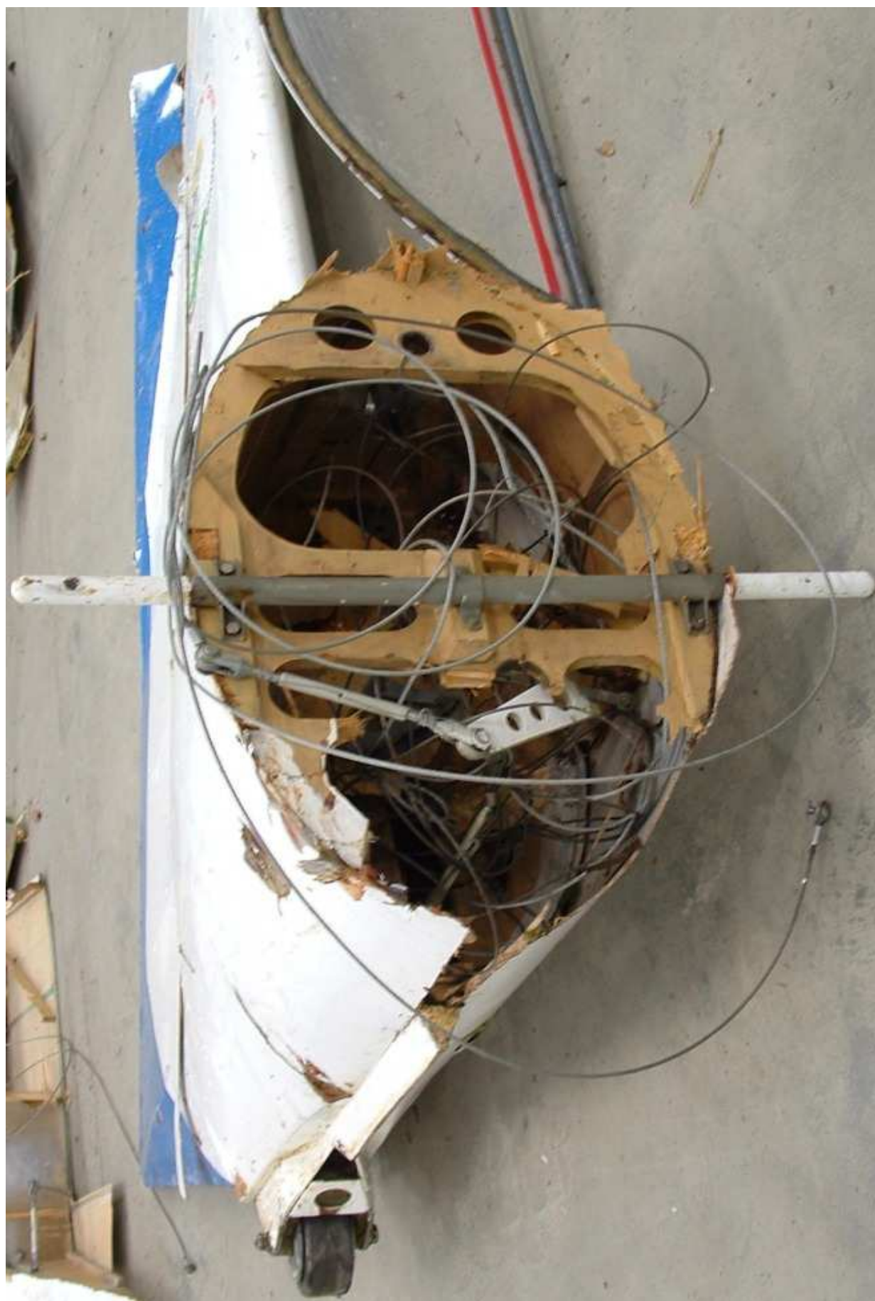
32 – Tylna część kadłuba z usterzeniem pionowym od strony zniszczonej wręgi. Widoczne linki sterowania sterem kierunku.
