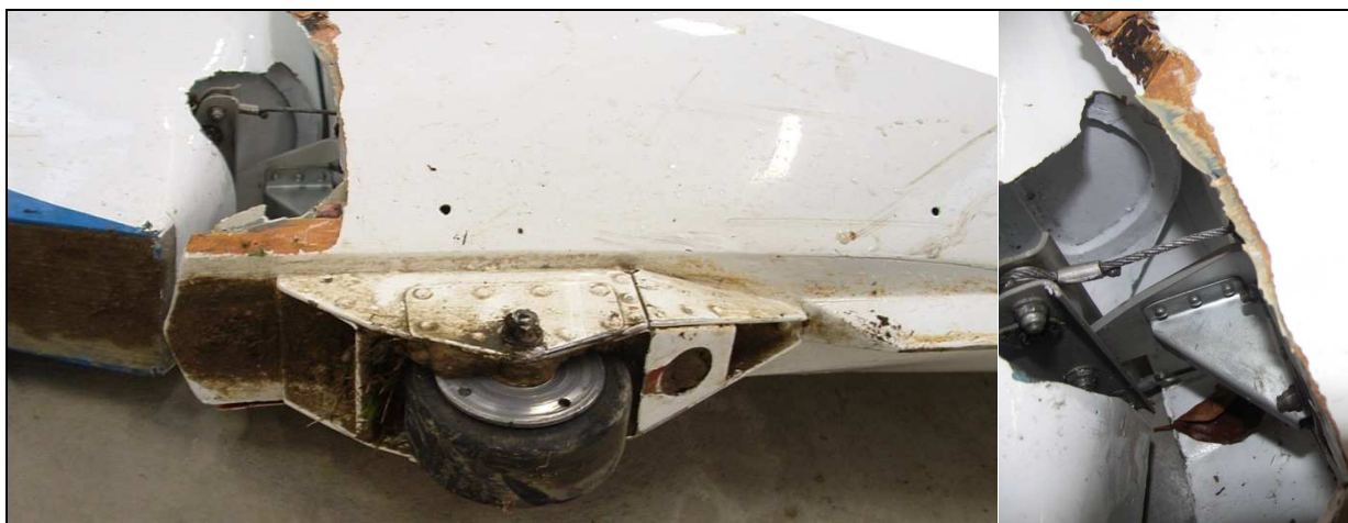
34 i 35 – Kółko tylne i dolna podpora steru kierunku, z prawej zbliżenie dolnej podpory steru kierunku z zachowanymi połączeniami układu sterowania.
