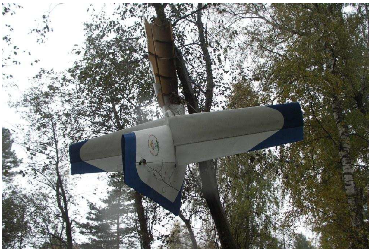
16 – Tylna część kadłuba z usterzeniem odłamana i zawieszona na drzewie.
