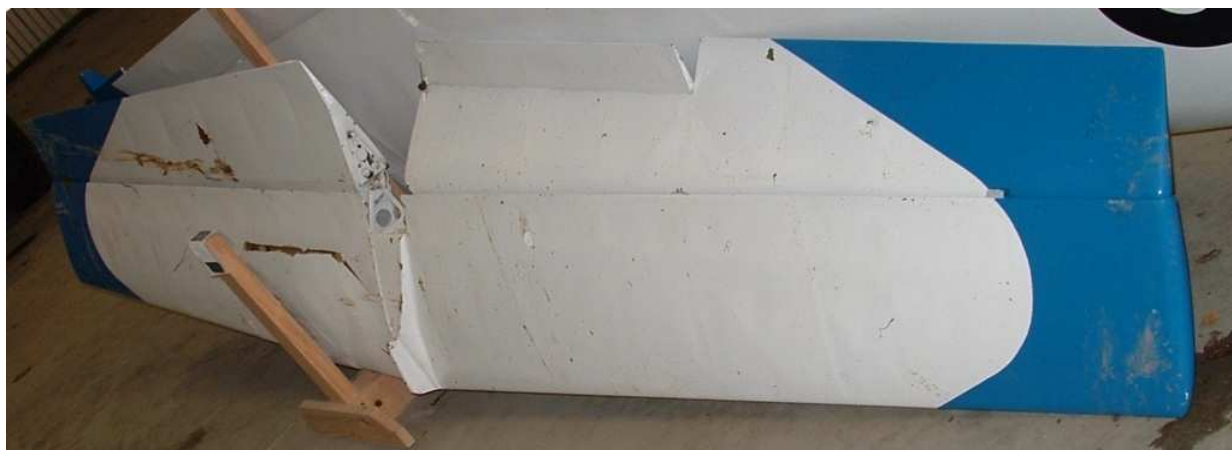
36 – Uszkodzone usterzenie poziome po zdemontowaniu z szybowca.
