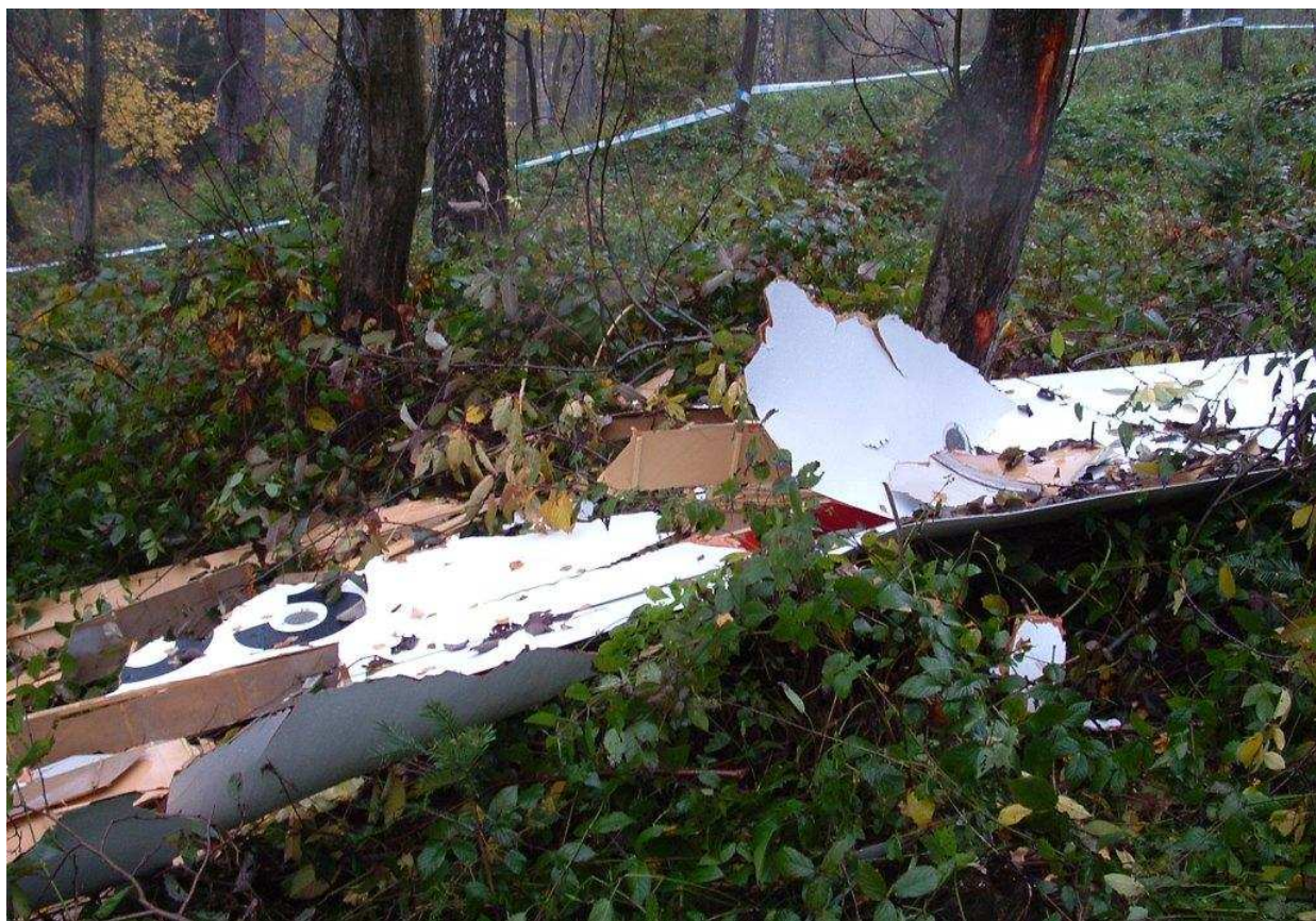
20 - Szczątki lewego skrzydła, widoczne ślady uderzeń na pniach drzew.
