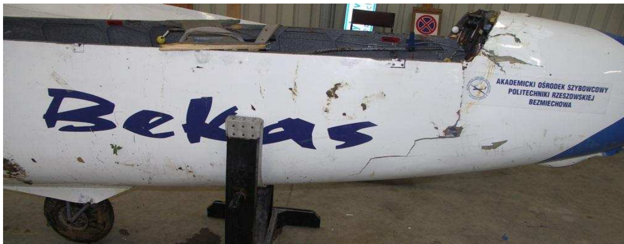
28 – Prawa strona przedniej części kadłuba – widoczne zniszczenia.
