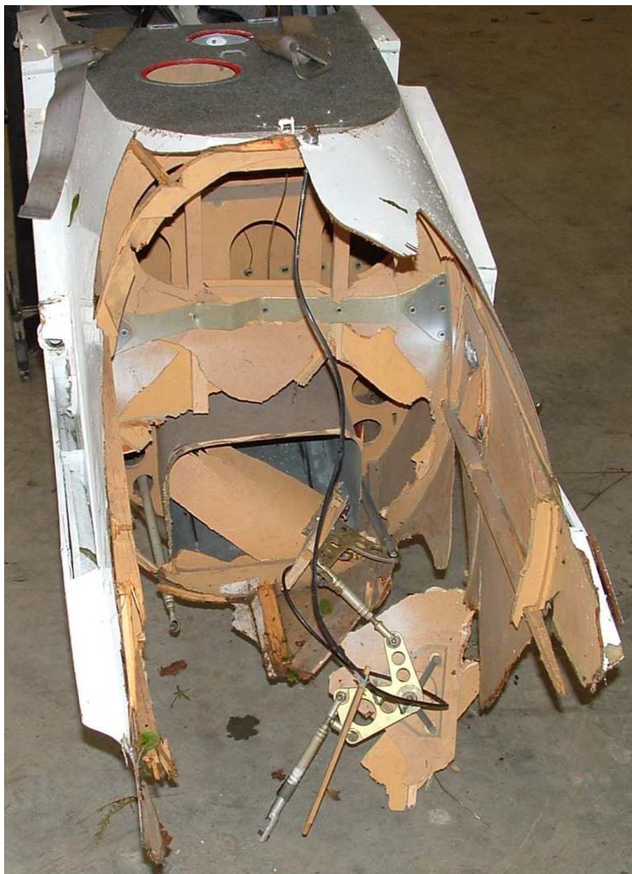
31 – Przednia część kadłuba od tyłu. Widoczne elementy zniszczonego układu sterowania płotowcem.
