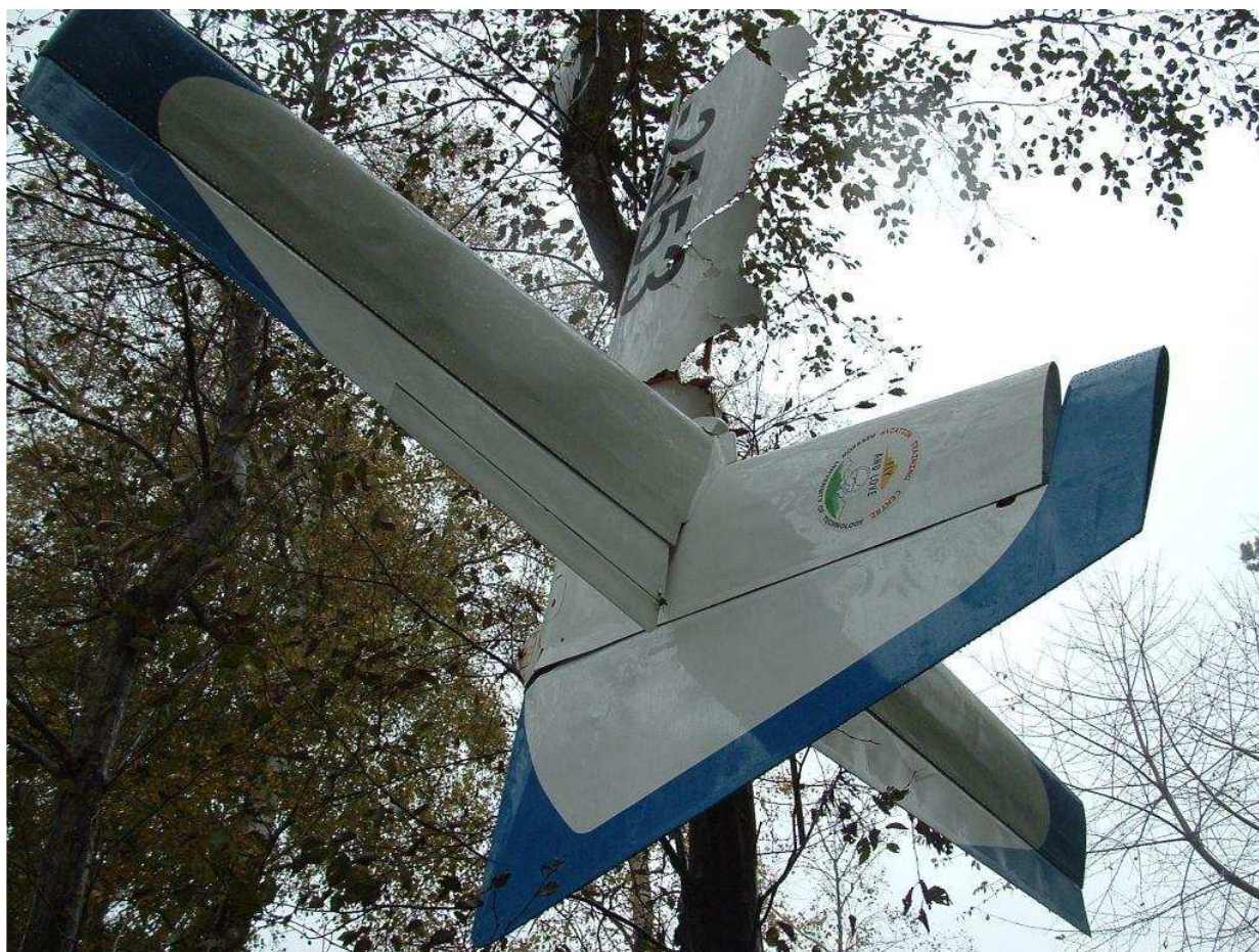
17 - Tylna część kadłuba z usterzeniem odłamana i zawieszona na drzewie.
