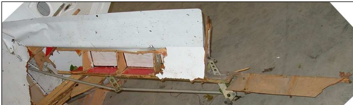
37 – Fragment spływowej części zniszczonego lewego skrzydła z zachowanymi elementami układu sterowania.
