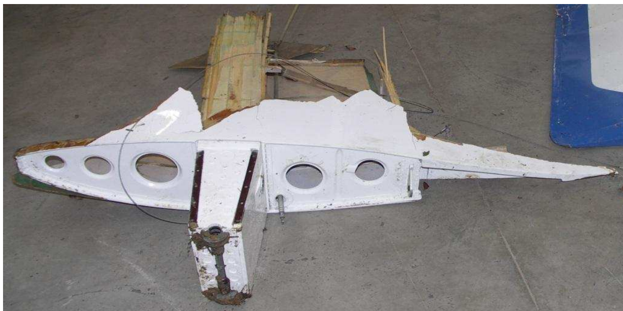
38 – Żebro nasadowe zniszczonego lewego skrzydła z fragmentem dźwigara głównego. Na dźwigarze widoczne okucia mocowania skrzydła do kadłuba.
