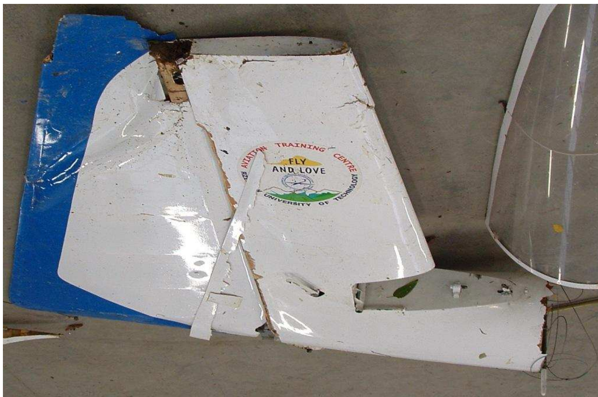
33 – Oderwana tylna część kadłuba z usterzeniem pionowym. Usterzenie poziome zdemontowane.
