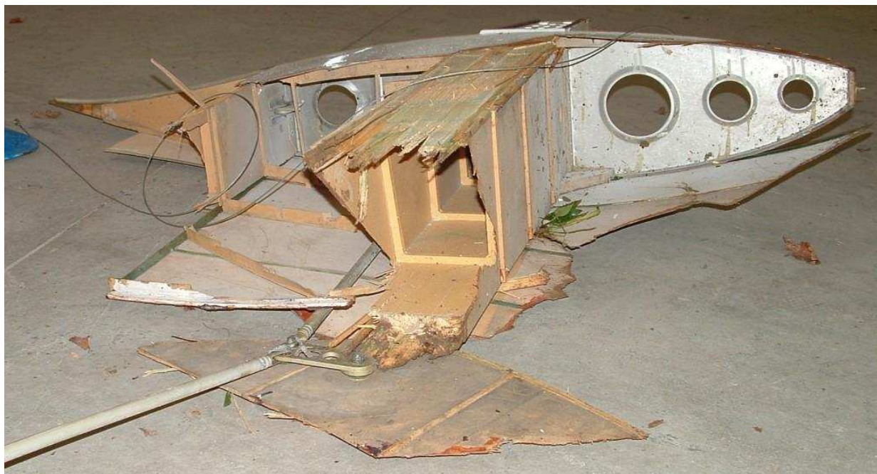
39 – Żebro nasadowe zniszczonego lewego skrzydła z fragmentem dźwigara głównego. Widoczny przełom skrzynkowego dźwigara, fragmenty zniszczonych górnych powłok pokrycia i elementy układu sterowania.
