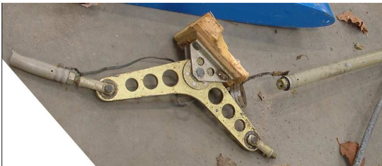
42 – Zniszczony fragment układu sterowania płotowcem: z lewej strony widać zerwany popychacz, na środku dźwignię pośrednią wyrwaną ze struktury płotowca wraz ze swym zamocowaniem; po prawej stronie popychacz z ułamaną końcówką.
