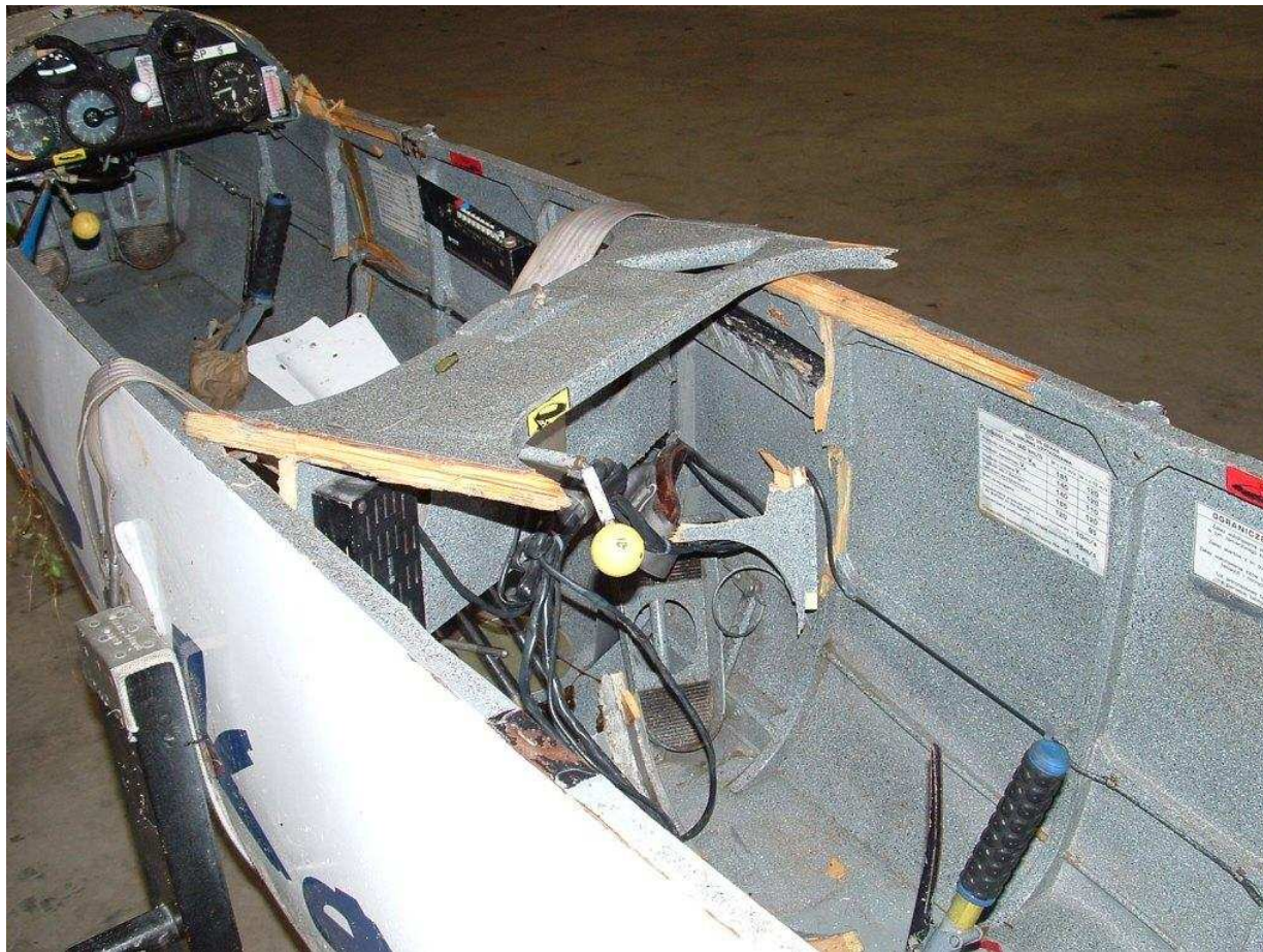
27 – Przednia część kadłuba z lewej strony od tyłu. Wręga struktury między kabinami wyłamana.
