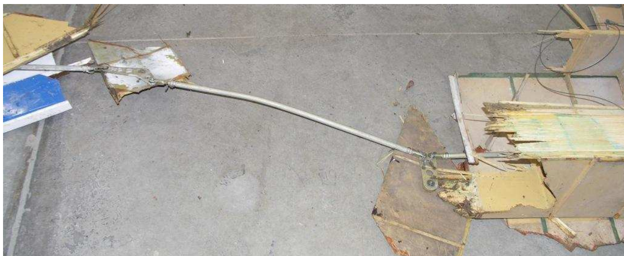
40 – Elementy układu sterowania hamulcami aerodynamicznymi w szczątkach zniszczonego lewego skrzydła. Ciągłość kinematyczna układu sterowania zachowana.
