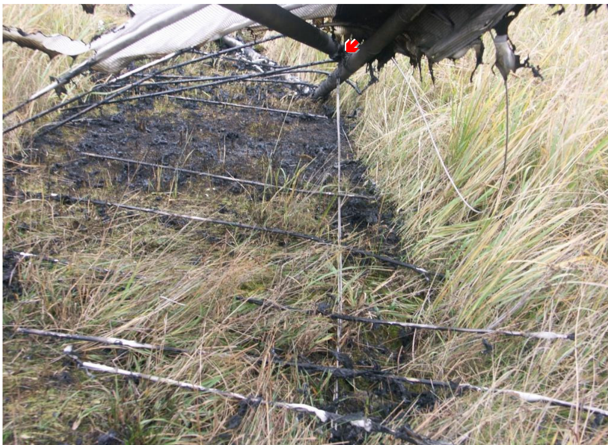
21 – Żeberka spalonej lewej części skrzydła. Strzałką wskazany lewy węzeł boczny.
