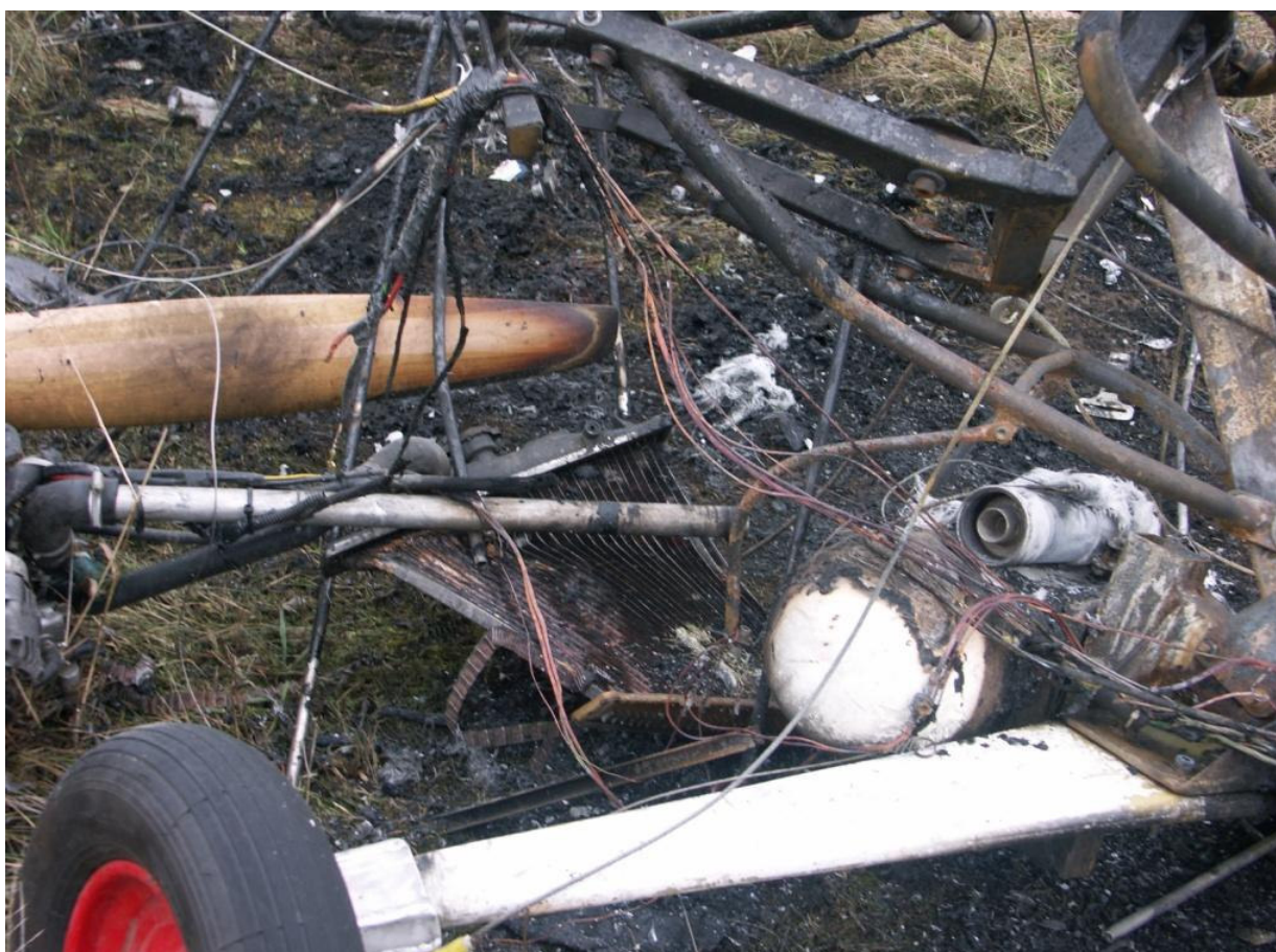
18 – Tylna część wózka z prawej strony. Widać prawą goleń podwozia głównego z kołem, zasobnik i odsłoniętą rakietę systemu ratunkowego BRS, zniszczoną chłodnicę oraz nadpaloną łopatę śmigła.
