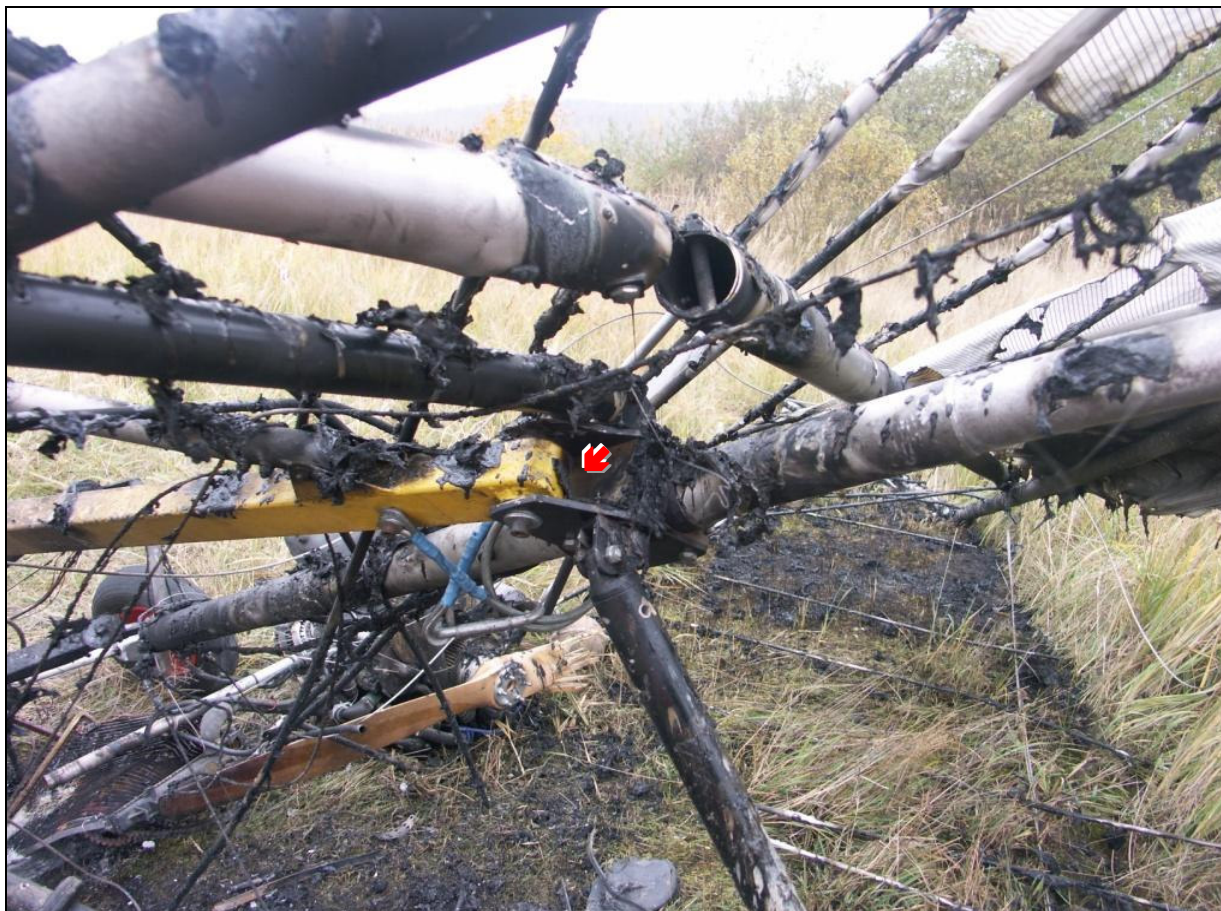
25 – Zbliżenie węzła centralnego (wskazany strzałką). W tle oderwany silnik i szczątki spalonego skrzydła.
