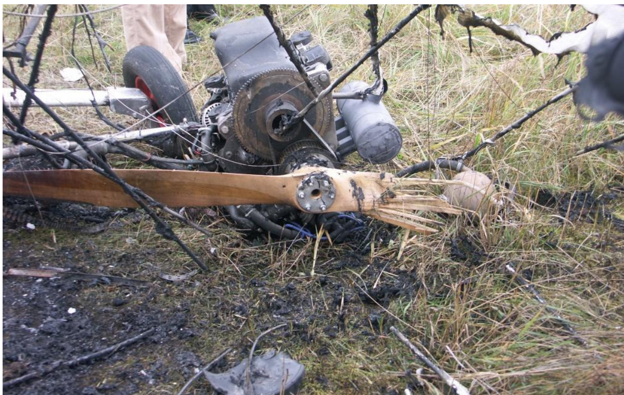
22 – Oderwany od wózka wraz ze swymi instalacjami i agregatami silnik oraz złamane śmigło.
