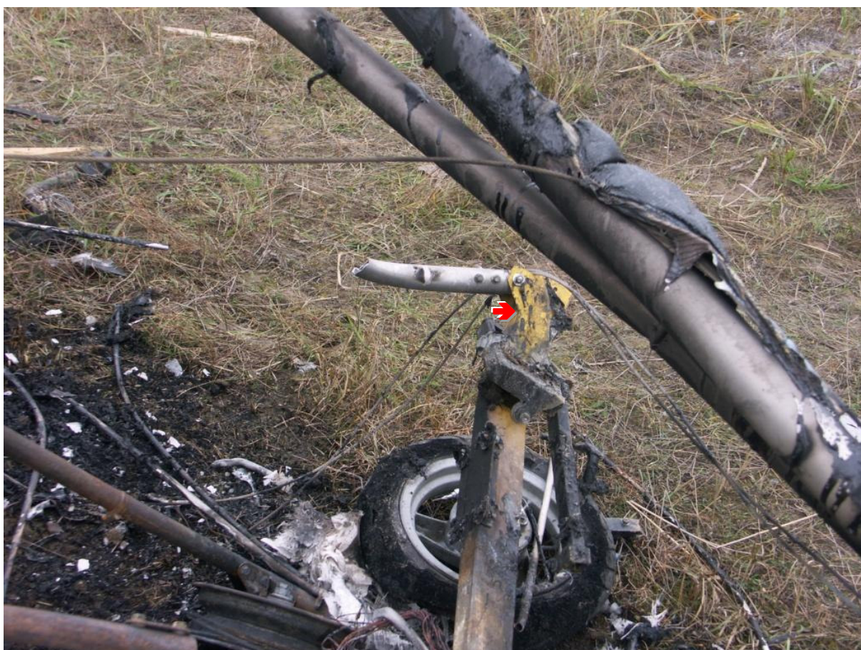
28 – Przedni koniec głównej belki wózka z okuciem i fragmentem przedniego zastrzału, widoczne szczątki podwozia.
