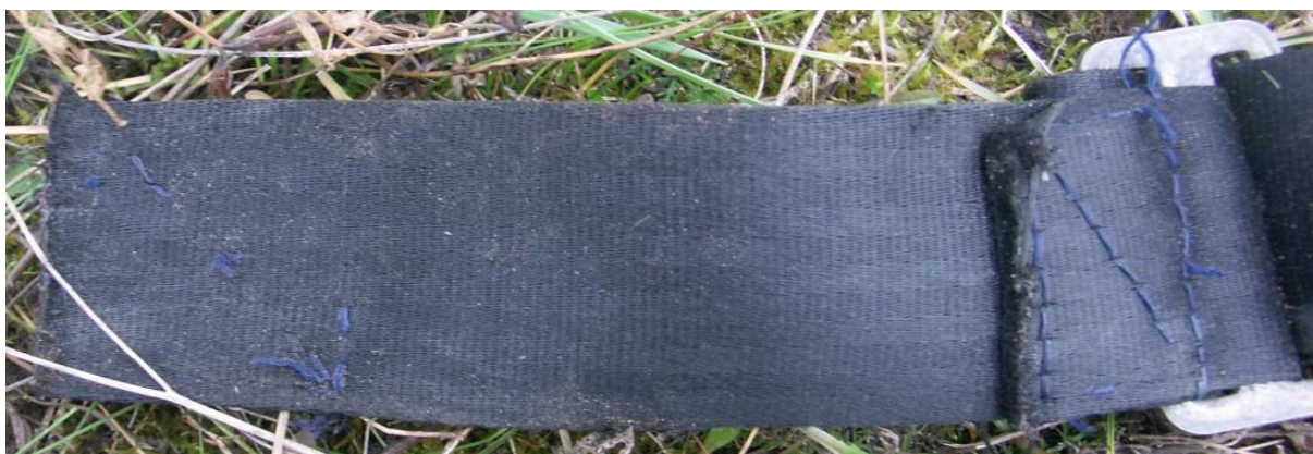
33 – Zbliżenie szwu na pasie bezpieczeństwa, umożliwiające ocenę jakości jego wykonania.
