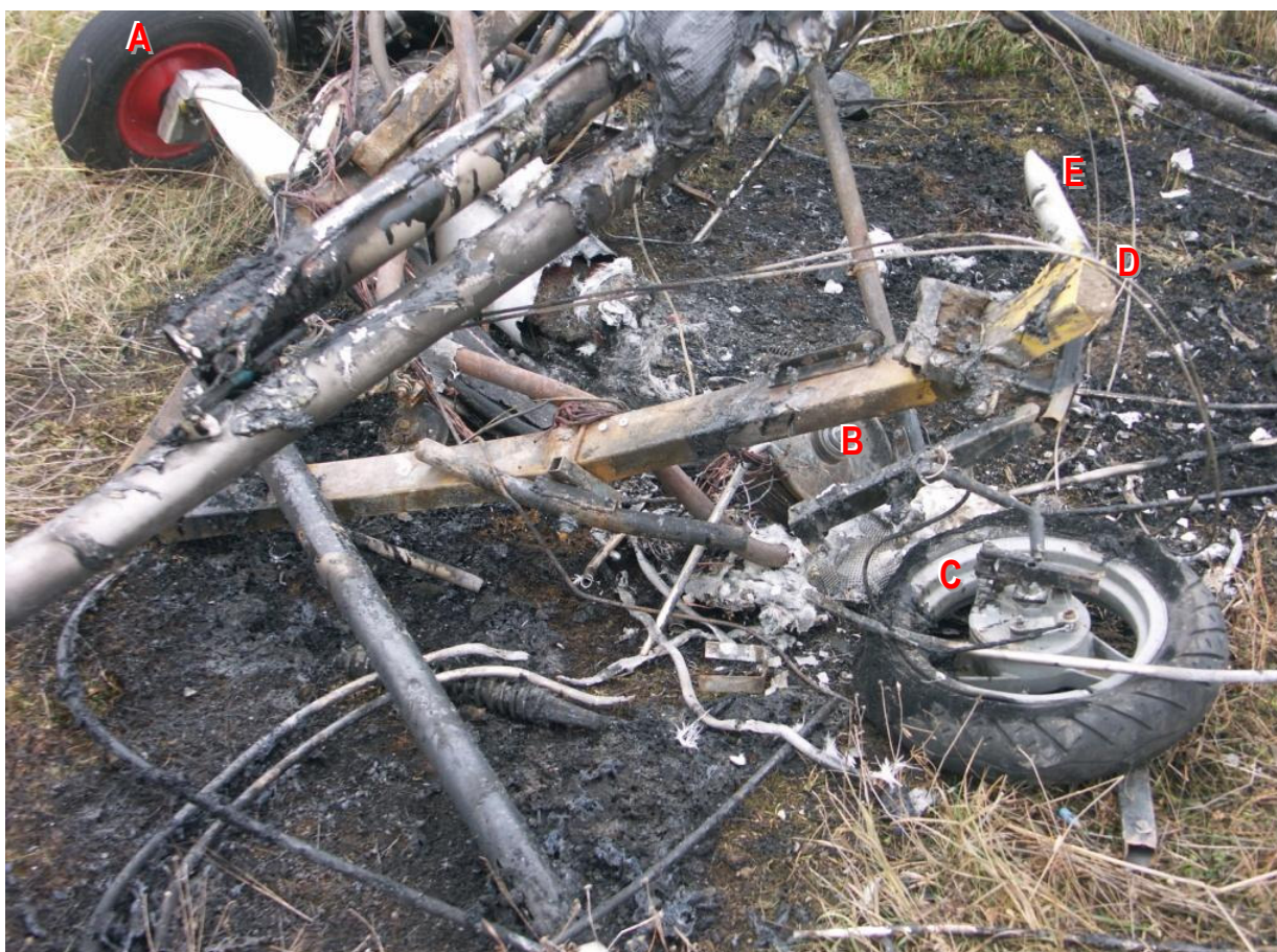
16 – Zbliżenie szczątków spalonej motolotni. Widać przedni koniec belki podłużnej wózka z fragmentem wyłamanej stójki przedniej i zniszczone podwozie przednie. Oznaczenia: A – prawe koło podwozia, B – zniszczone lewe koło podwozia, C – zniszczone koło przednie, D – przedni węzeł wózka, E – fragment złamanego przedniego zastrzału wózka.
