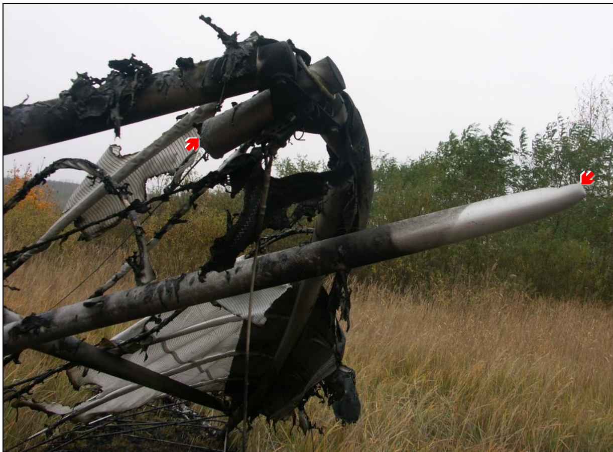
24 – Węzeł dziobowy. Widać złamaną rurę kila (przełom zaznaczony strzałkami) i pogięte rury krawędzi natarcia.
