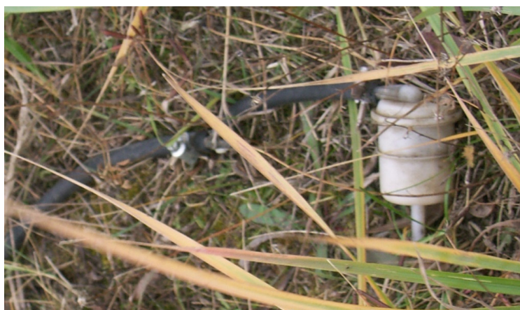
11 – Oderwany fragment systemu paliwowego – filtr z przewodem gumowym.
