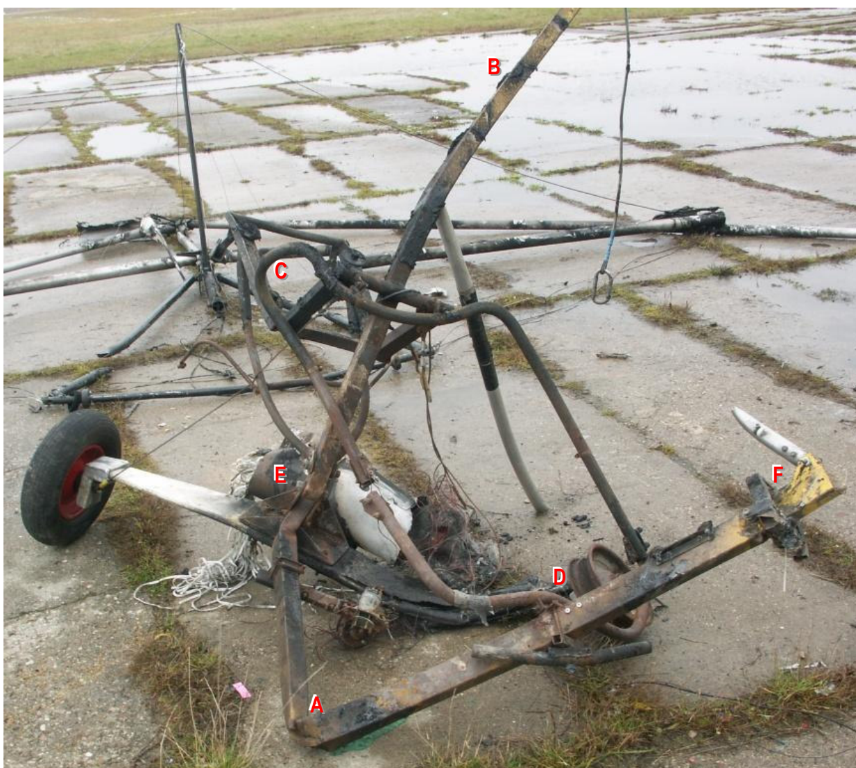
36 – Szczątki wózka. Widać złamaną belkę wzdłużną (A), maszt (B), zniszczone łożo silnika (C), zniszczone podwozie główne (D), zasobnik spadochronu systemu ratunkowego BRS (E) i przedni węzeł wózka z ułamanym fragmentem zastrzału wózka (F). Za wózkiem złożony na ziemi szkielet skrzydła.
