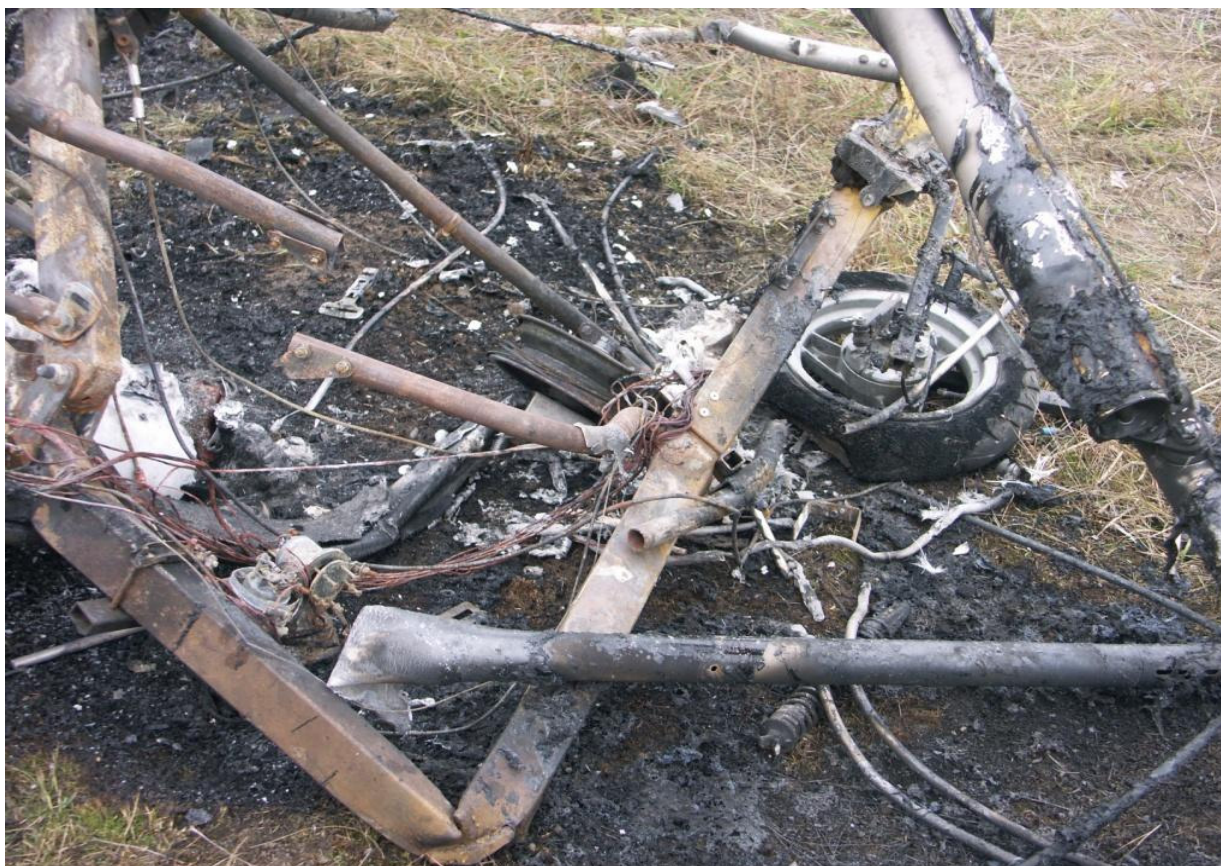
17 – Zbliżenie szczątków spalonej motolotni. Widać złamanie belki wzdłużnej wózka i zniszczone podwozie.
