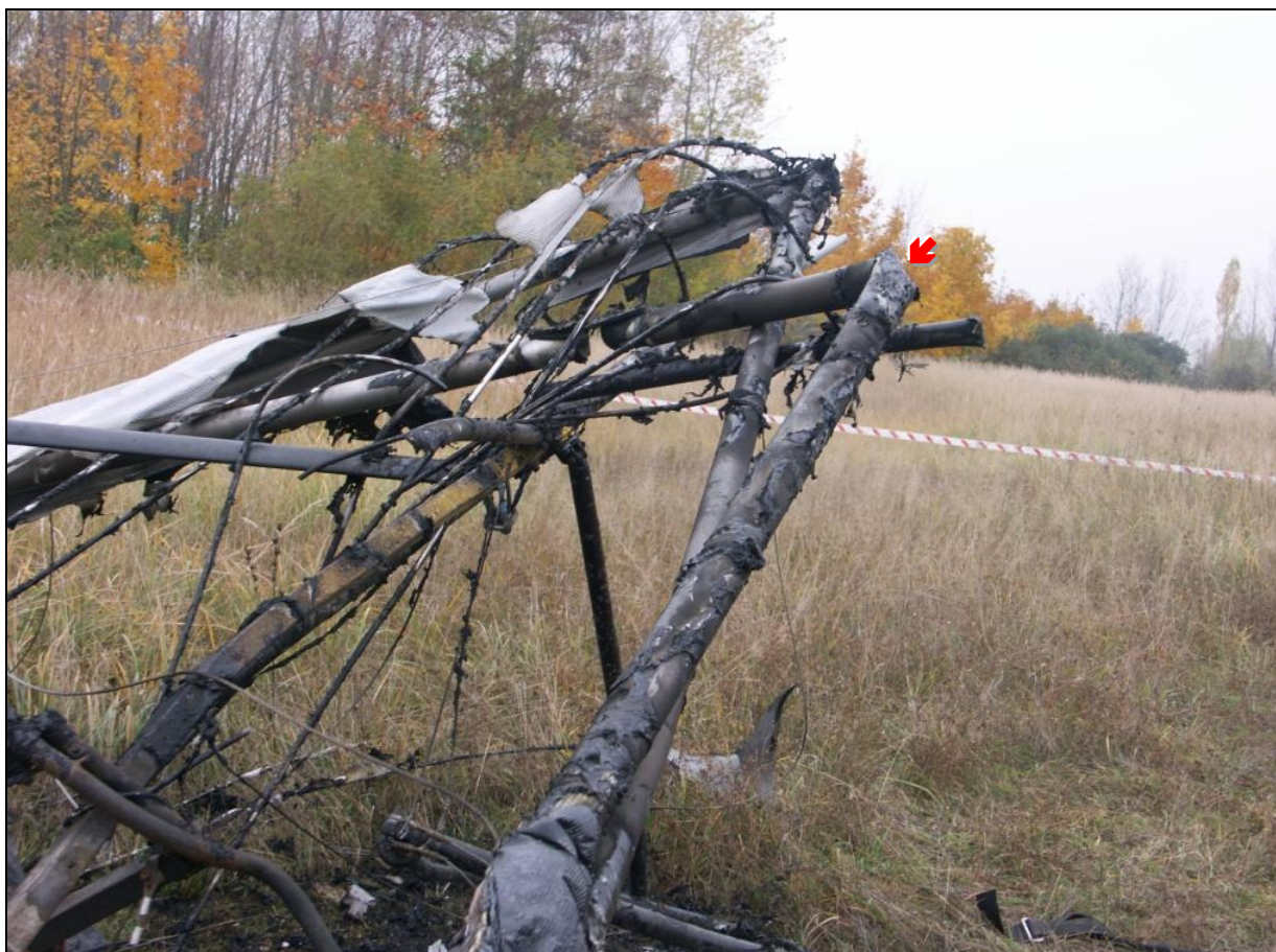
20 – Złamanie prawego dźwigara (wskazane strzałką).
