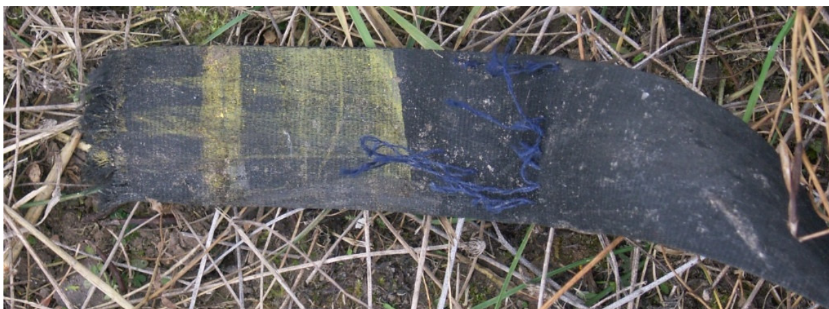
30 – Rozerwany szew końcówki pasa mocowanej do masztu wózka.
