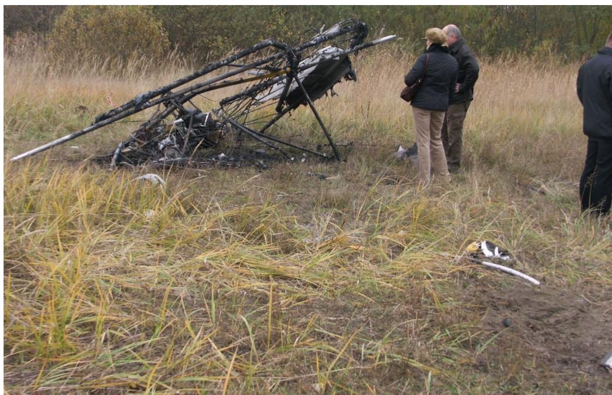
8 – Ogólny widok wraku motolotni po wypadku i akcji gaśniczej. W prawym dolnym rogu kadru widoczny ślad zderzenia z ziemią i szczątki, pokazane dalej na zdjęciu [9].
