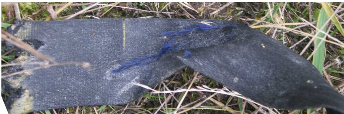
31 – Druga część końcówki pasa mocowanej do masztu wózka z rozerwanym szwem.
