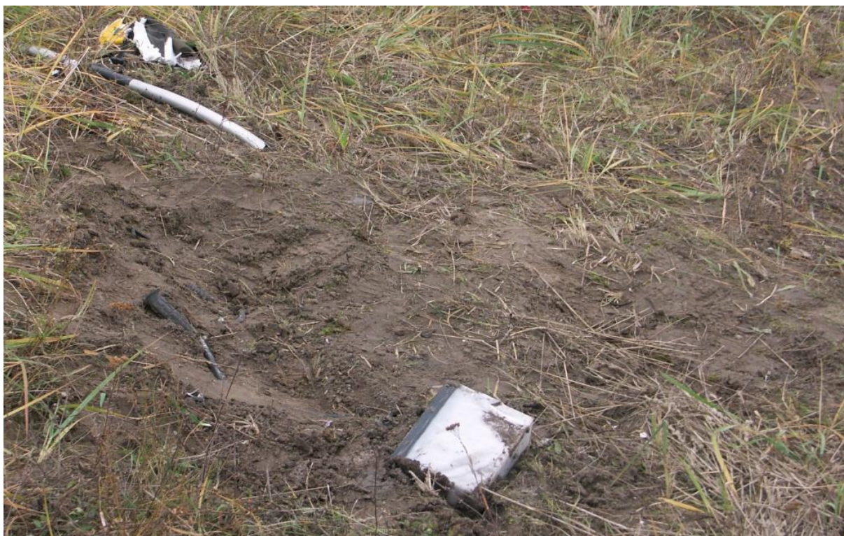
9 – Akumulator z kablem oraz wyłamany fragment przedniego zastrzału leżące w miejscu zderzenia z ziemią.
