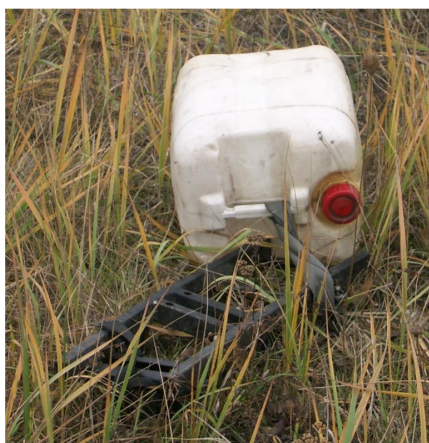
10 – Oderwany zbiornik paliwa z konsolą mocującą go do wózka.
