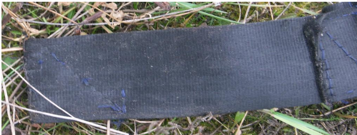
32 – Zbliżenie szwu na pasie bezpieczeństwa, umożliwiające ocenę jakości jego wykonania.
