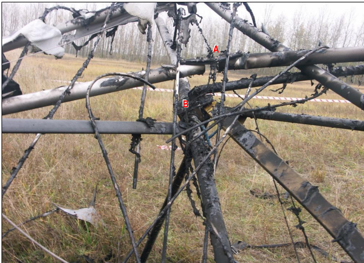
19 – Nie zniszczone węzły konstrukcji: A – dziobowy, B - centralny.
