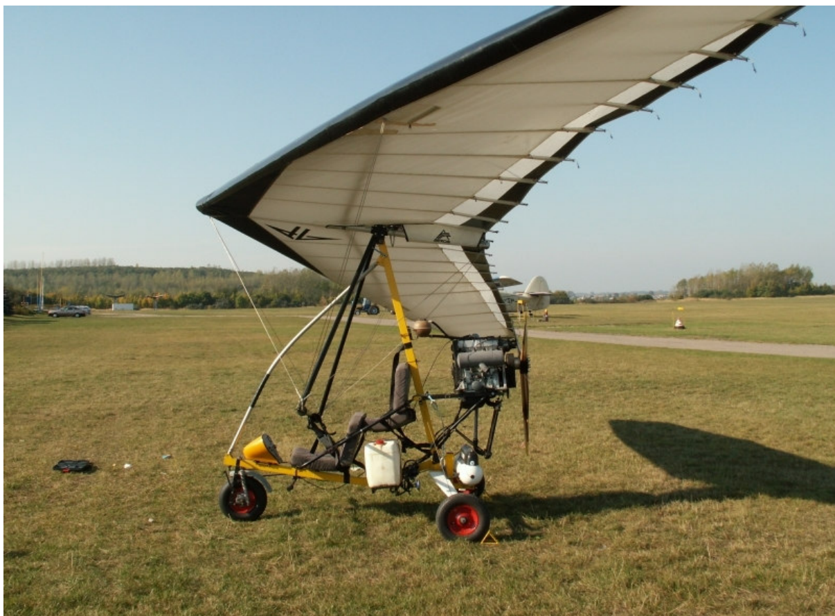
1 i 2 – Zdjęcia motolotni przed wypadkiem, jeszcze ze śmigłem trójłopatowym i bez znaków rozpoznawczych. Zwraca uwagę sposób umieszczenia i zamocowania zbiornika paliwowego (biały plastikowy kanister z lewej strony drugiego siedzenia) oraz spadochronowego pirotechnicznego układu ratunkowego BRS (pod silnikiem, za podwoziem głównym, z kierunkiem wyrzeliwania w lewo).
