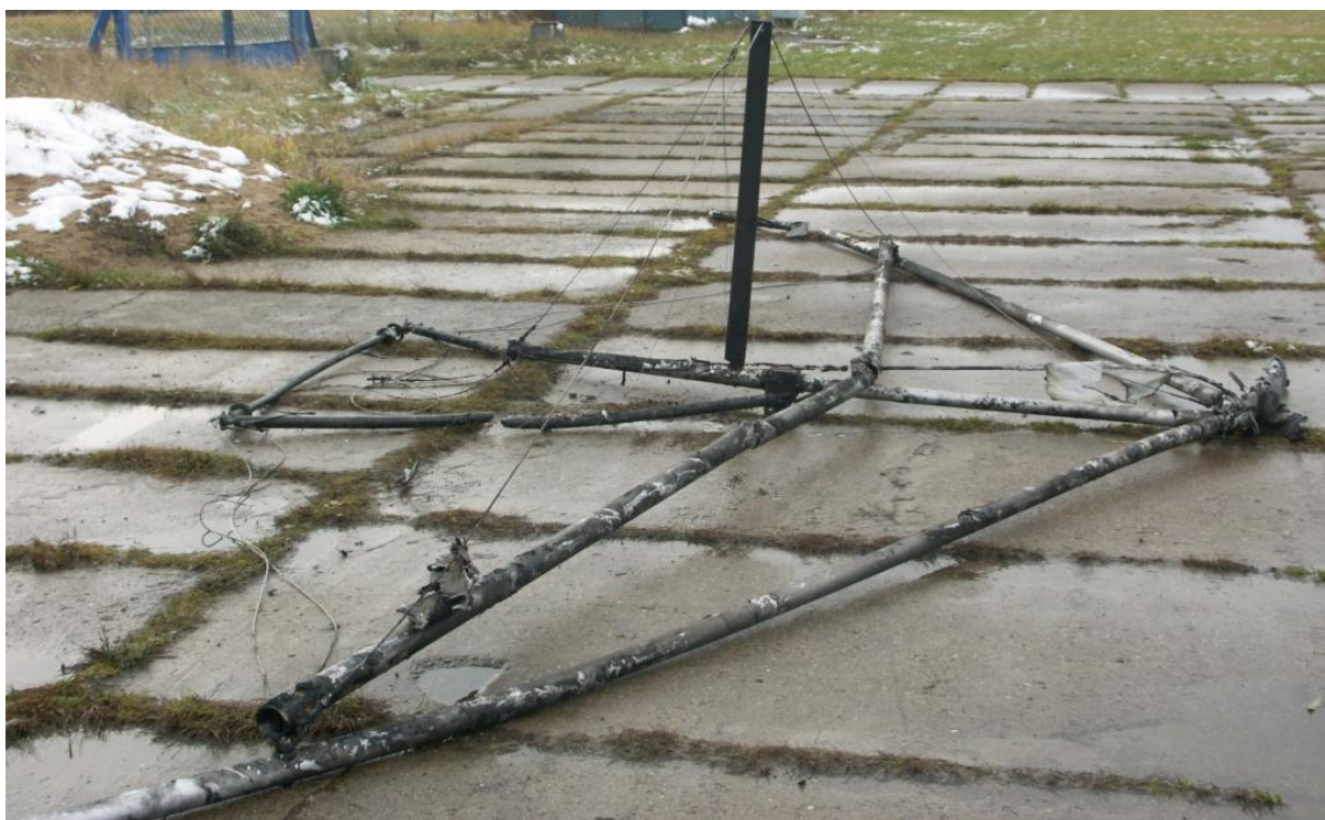
34 – Szkielet skrzydła z masztem, bez żeberek pokrycia. Widać nie uszkodzone linki.
