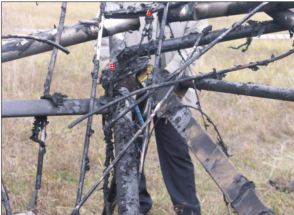
23 – Zbliżenie na nie zniszczone węzły: A – dziobowy, B – centralny.
