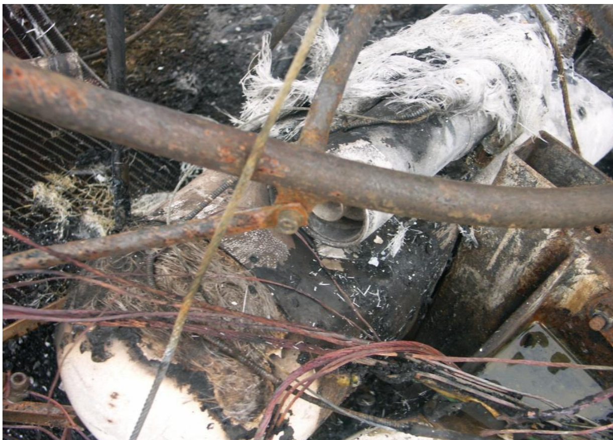
26 – Spadochronowy system ratunkowy BRS ze śladami oddziaływania ognia.
