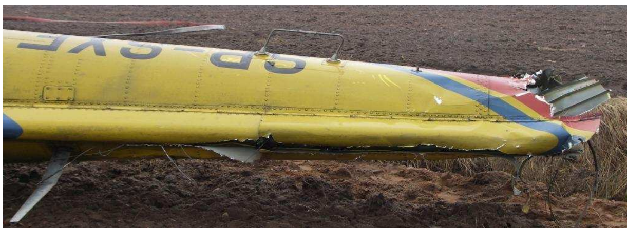
27 – Belka ogonowa – widoczne rozdarcie osłony wału linkami sterowania wirnikiem ogonowym.
