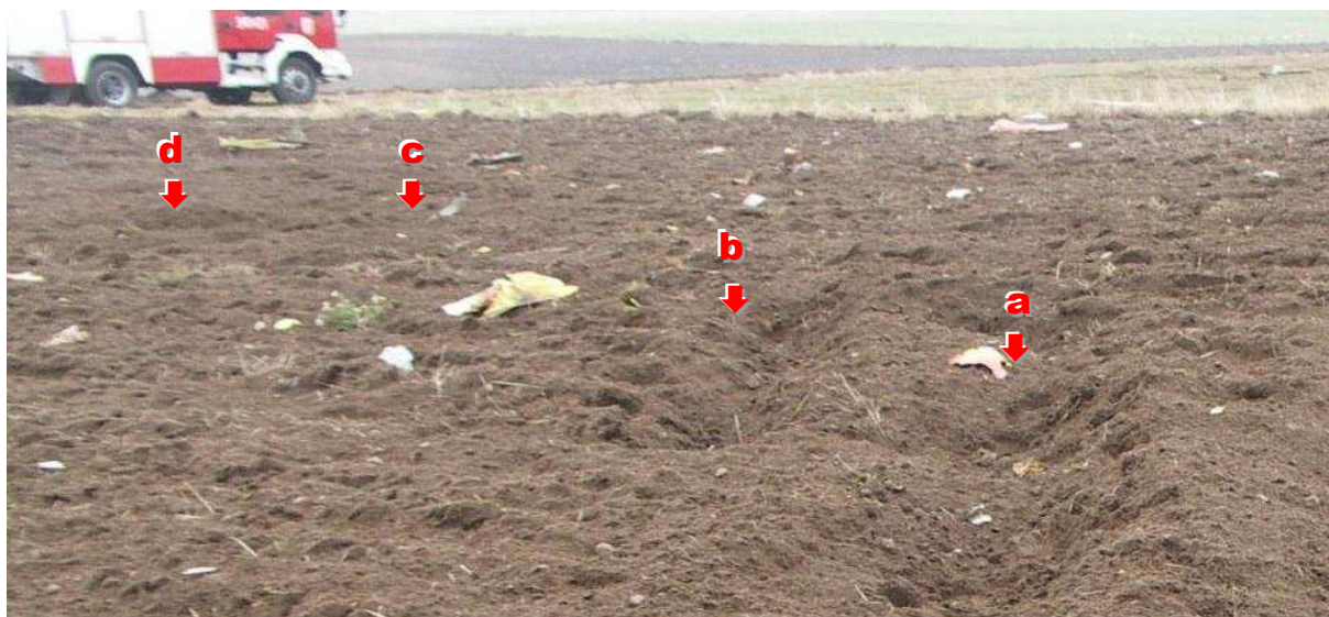
11 – Kolejno od prawej: głęboki ślad łopaty wirnika [a], ślad przewracania się kadłuba na lewy bok [b], ślad przemieszczania się kadłuba na boku [c] i ślad uderzenia przednią częścią kadłuba [d].
