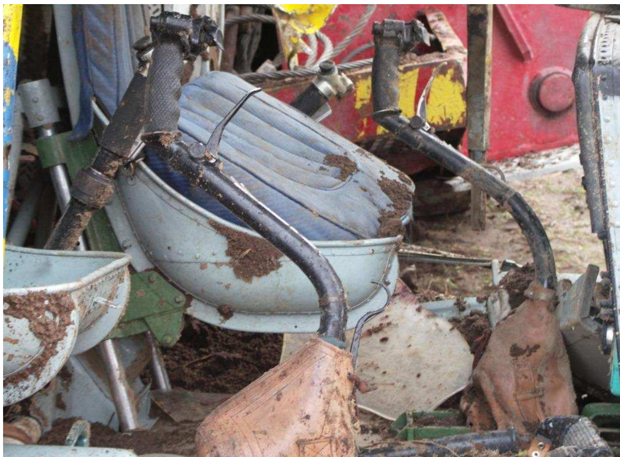
35 – Kabina załogi z lewej strony – widoczne położenie sterownic ręcznych oraz dźwigni skoku i mocy.
