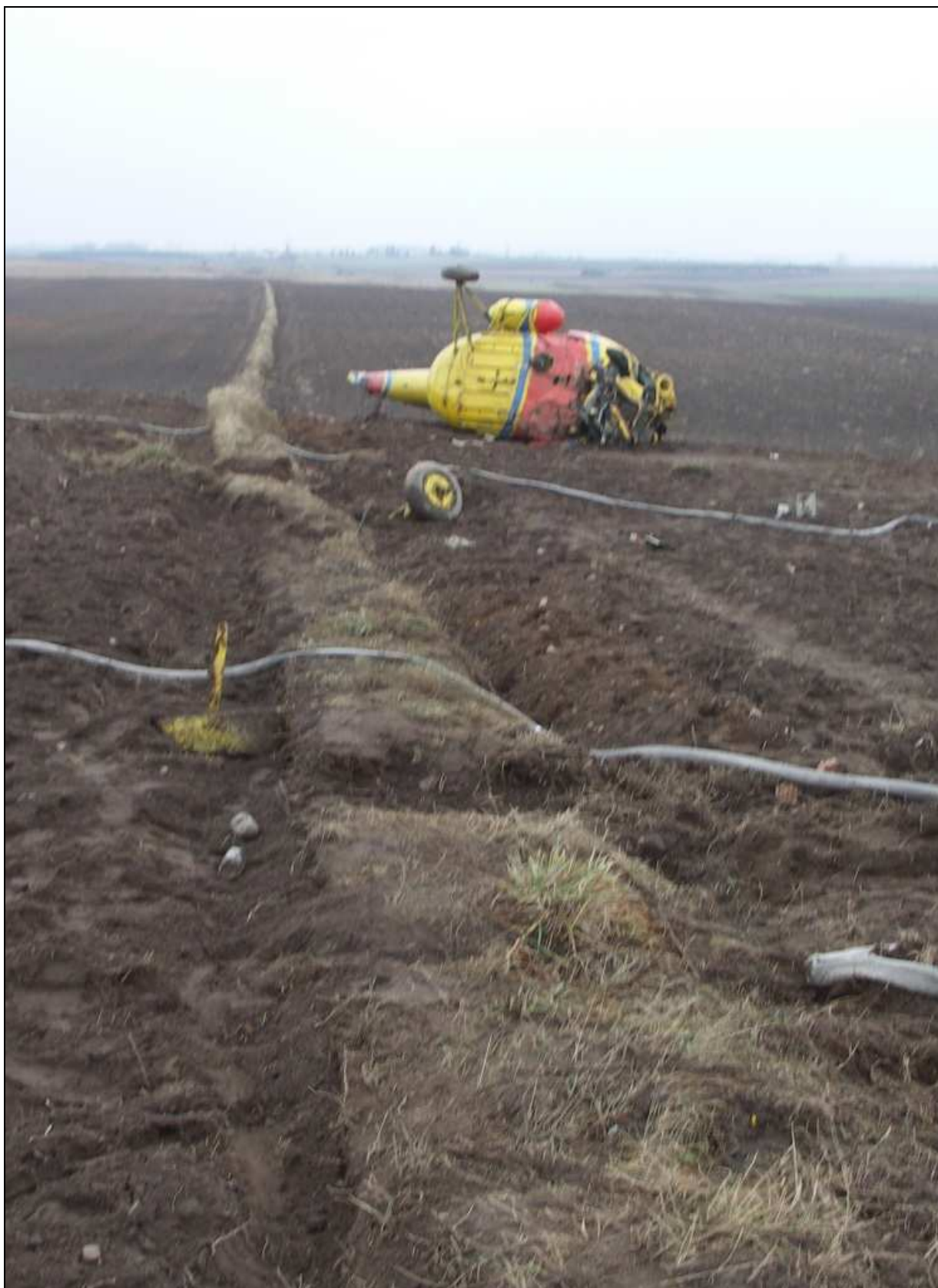
17 – Miedza za drogą polną, „wygładzona” przez ślizgający się po niej kadłub śmigłowca; na pierwszym planie widoczny oderwany stopień kabiny sanitarnej, dalej wyrwane lewe podwozie główne i (w prawo od podwozia) akumulator; wśród szczątków rozciągnięty wąż strażacki.
