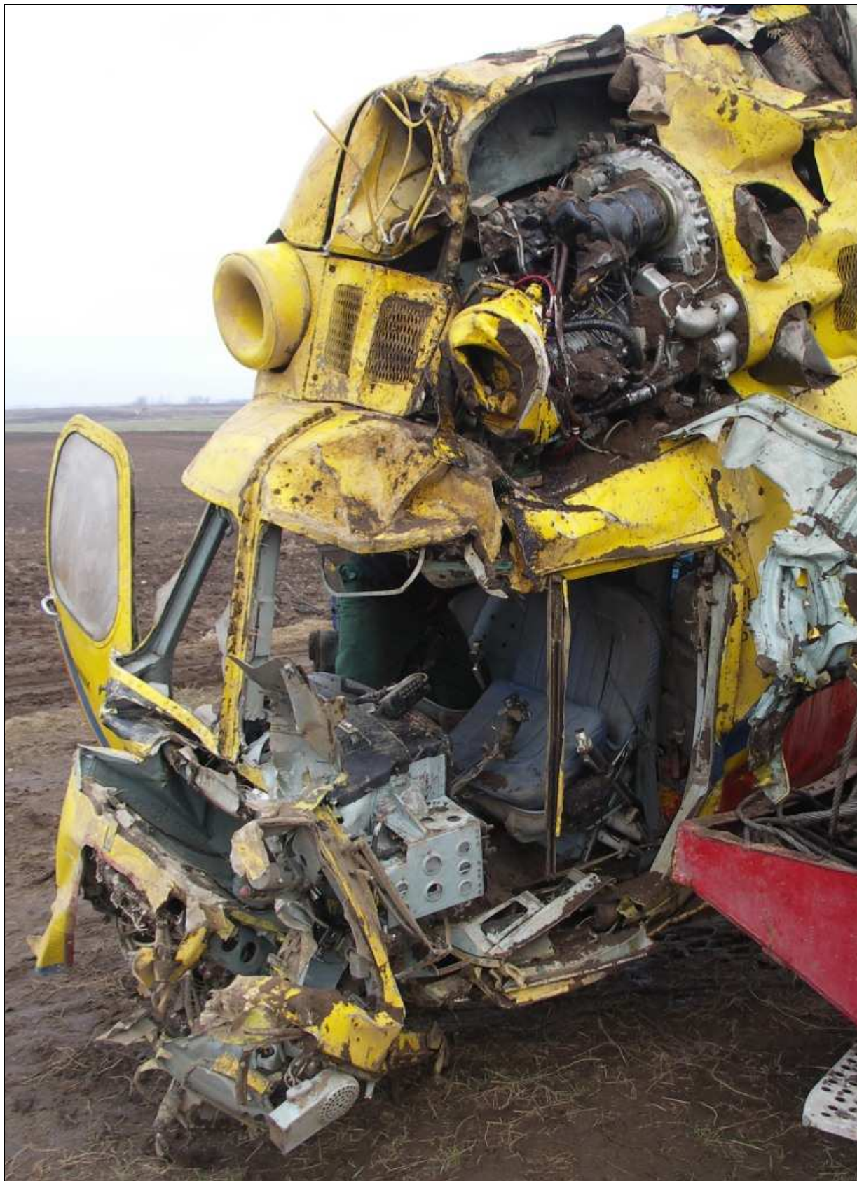
34 – Uszkodzenia przedniej części kadłuba śmigłowca z lewej strony, widoczne po jego podniesieniu.
