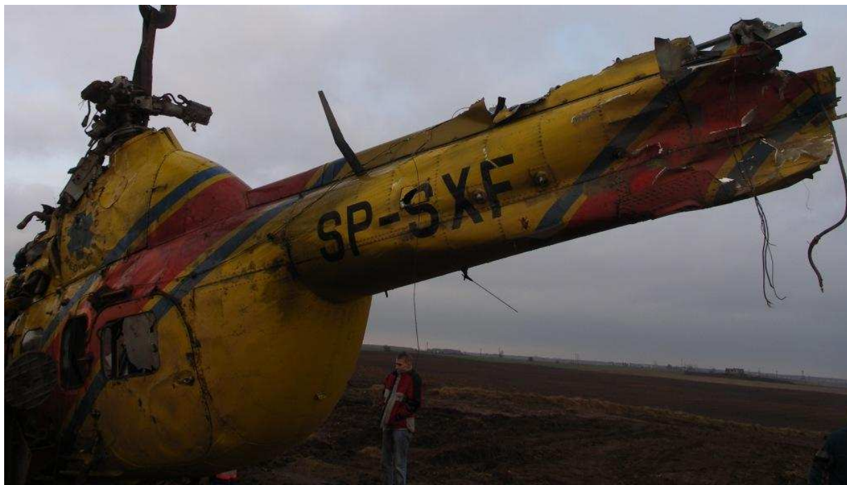
32 – Uszkodzenia belki ogonowej i lewej strony kadłuba, widoczne po jego podniesieniu
