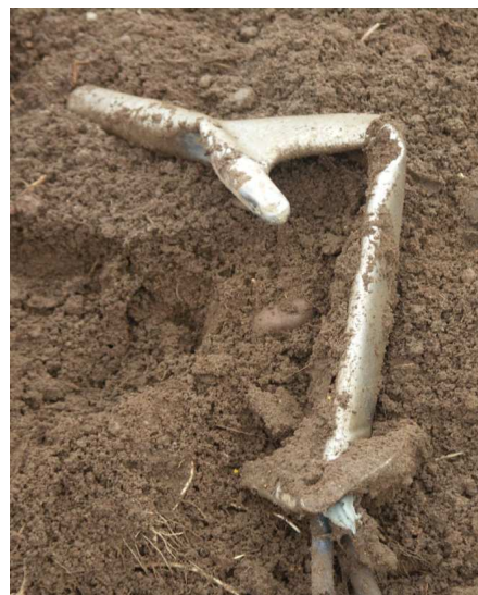
8 – Oderwana sonda Pitota.
