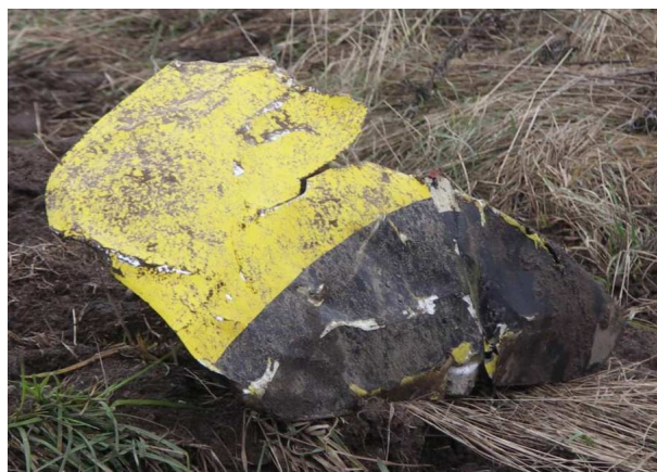
13 – Pokrywa luku akumulatorów.
