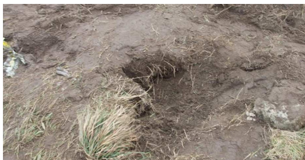
15 – Ślad uderzenia w ziemię tyłem belki ogonowej.
