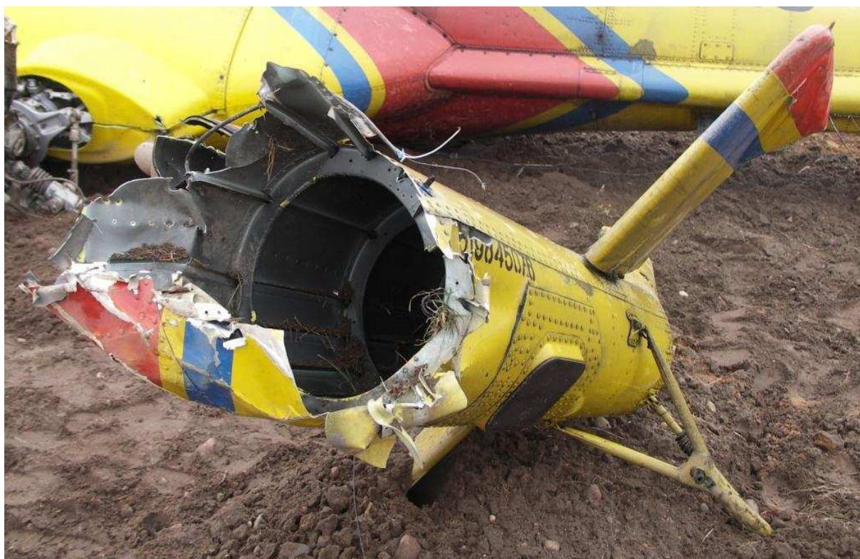
29 – Odłamany fragment belki ogonowej ze statecznikami.
