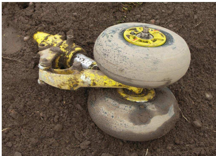
7 – Oderwane podwozie przednie.
