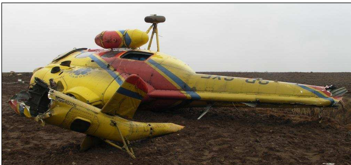
24 – Kadłub śmigłowca na miejscu wypadku w widoku \frac{3}{4} od tyłu i od góry; widoczny odłamany fragment belki ogonowej.
