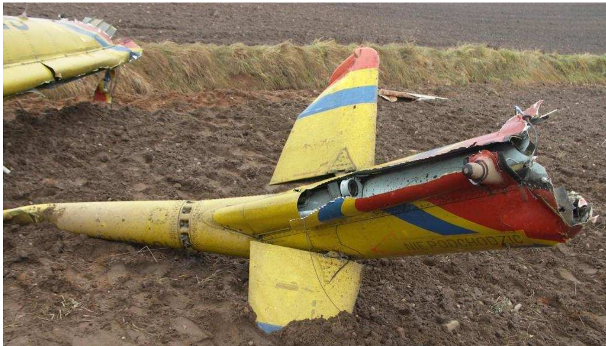
28 – Odłamany fragment belki ogonowej ze statecznikami.
