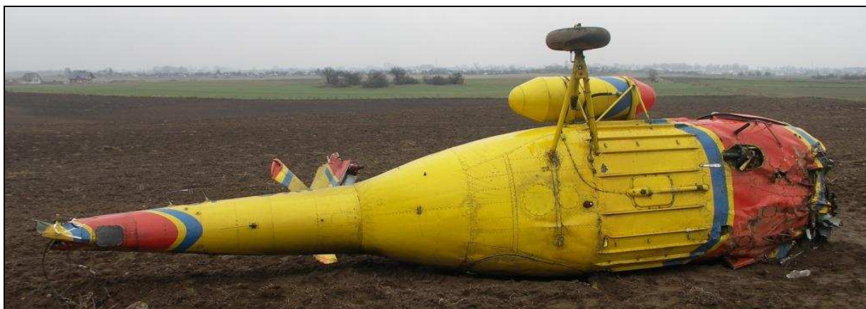
25 – Kadłub śmigłowca na miejscu wypadku w widoku od dołu.
