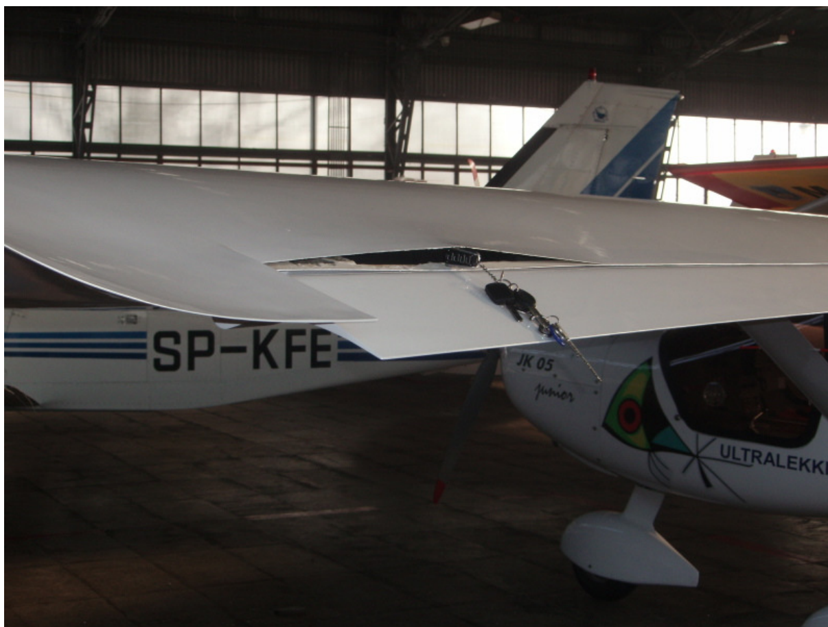
2 – Zbliżenie na uszkodzone skrzydło.
