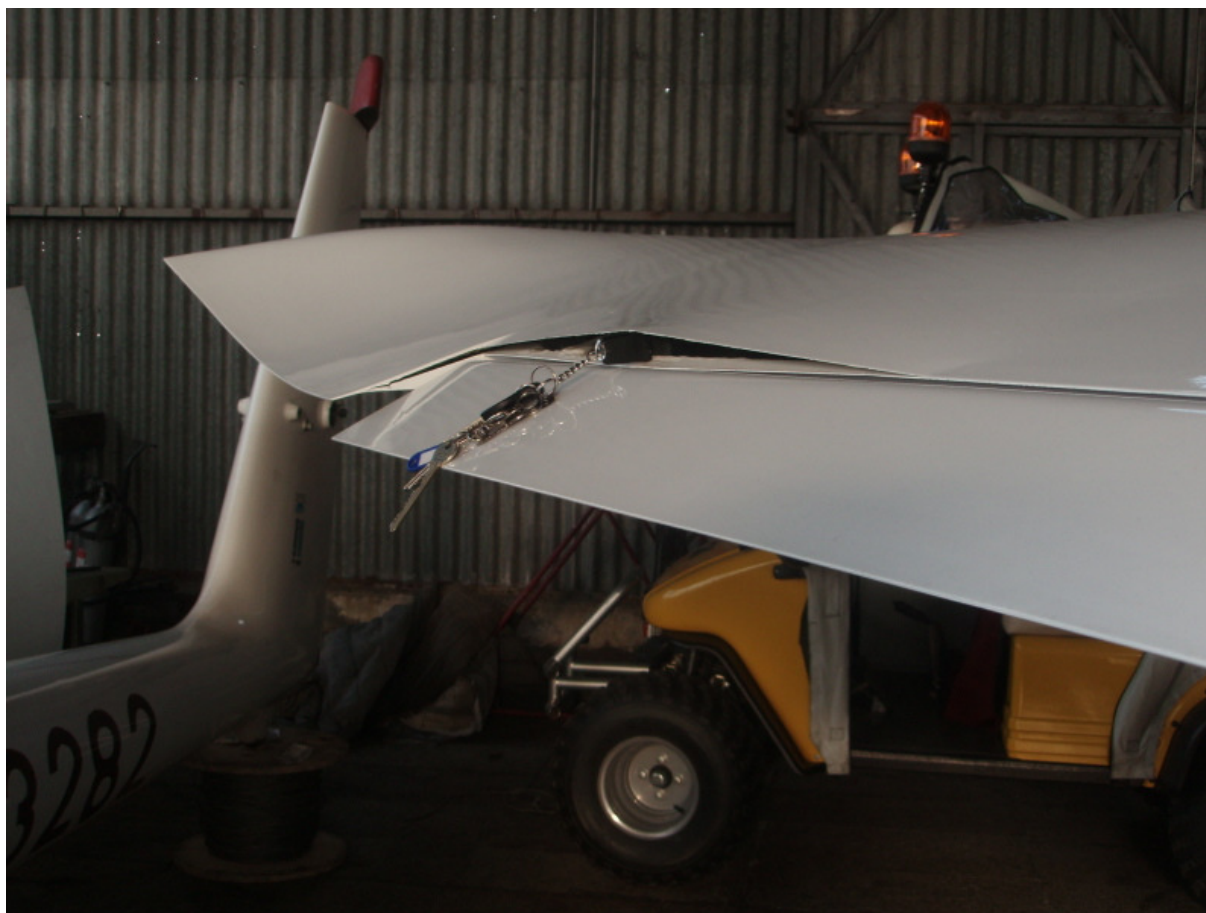
3 – Zbliżenie na uszkodzone skrzydło.
