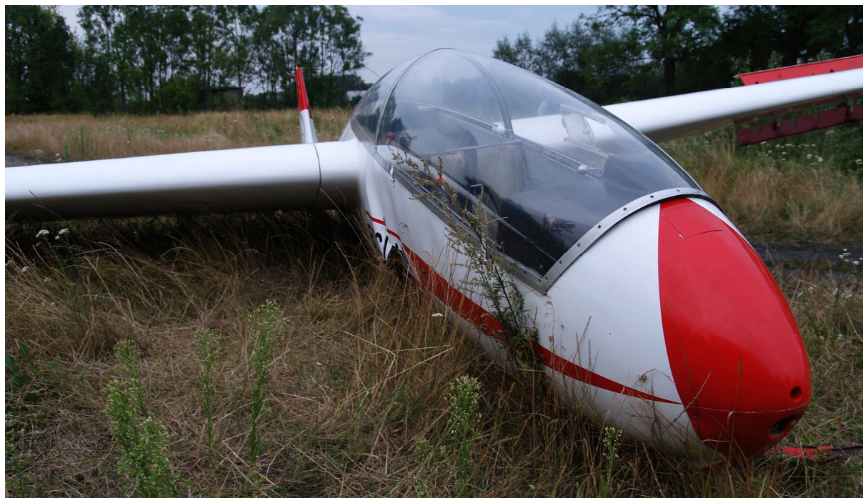
Fot. 3 Szczegóły uszkodzeń konstrukcji szybowca c.d.
