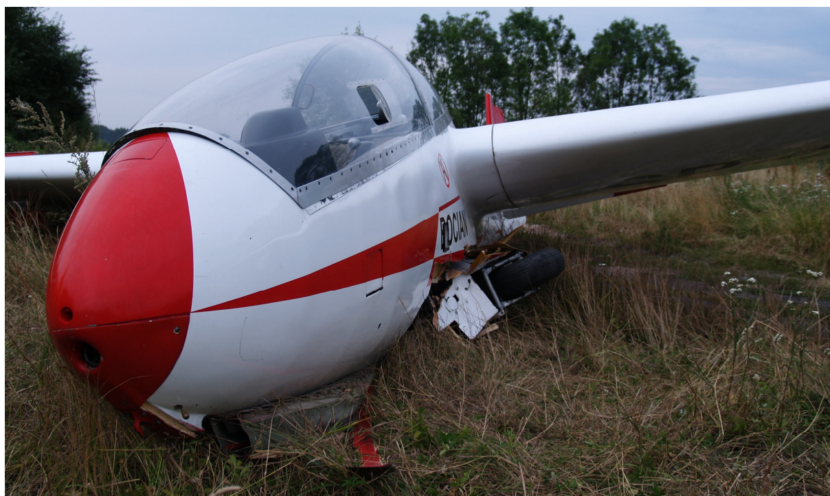
Fot. 2 Szczegóły uszkodzeń konstrukcji szybowca
