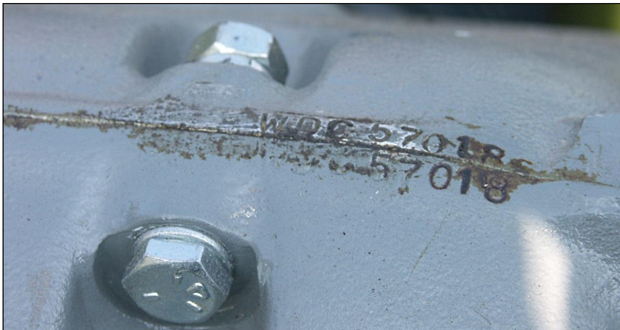
17 – Silnik: ślad nieszczelności na złączu połówek korpusu [foto: PKBWL].
