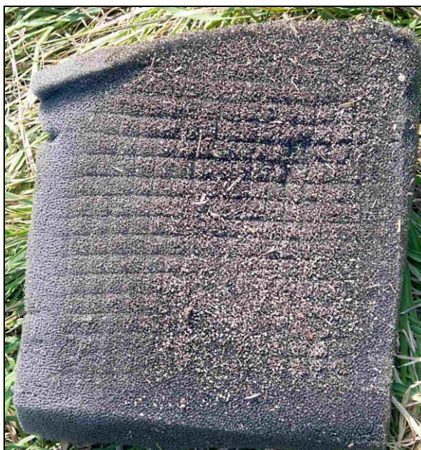
21, 22 – Stan wkładki filtra powietrza z wlotu do gaźnika [foto: PKBWL].
