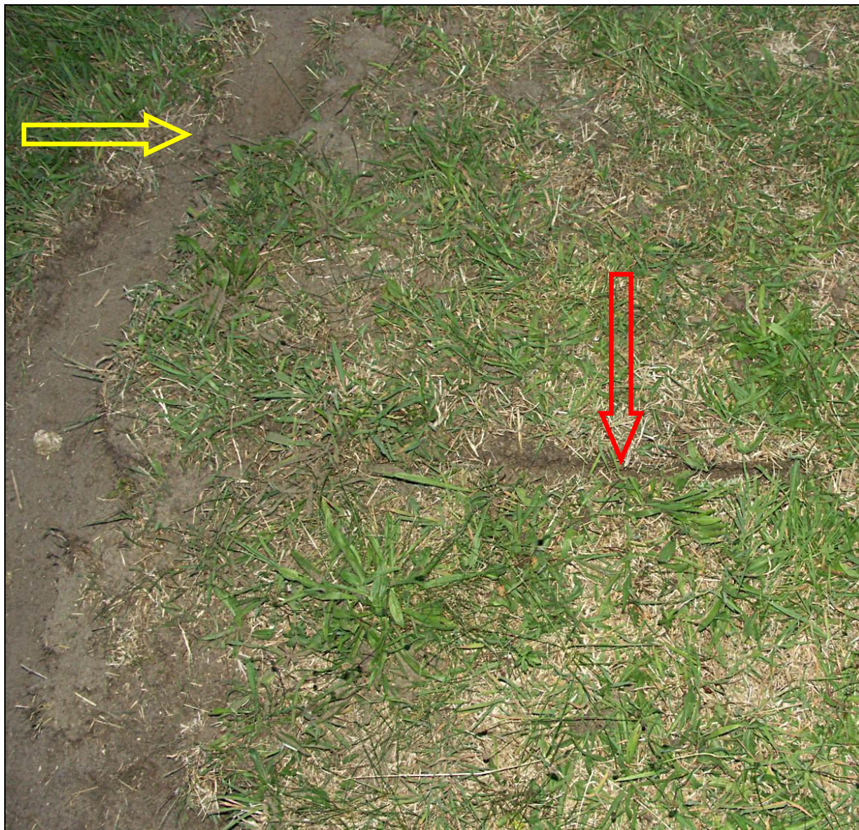
6 – Ślad rycia podwoziem [strzałka żółta z lewej] i ślad obracającego się śmigła [strzałka czerwona z prawej] [foto: PKBWL].
