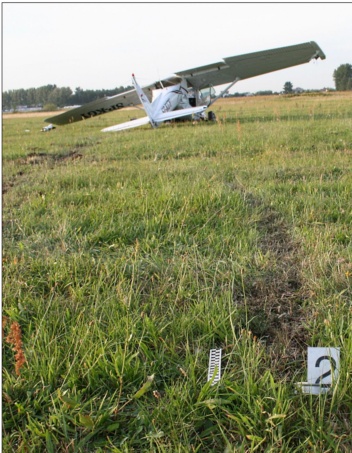
5 – Ślad przyziemienia prawego podwozia głównego [foto: Policja, M.Dutkowski].
