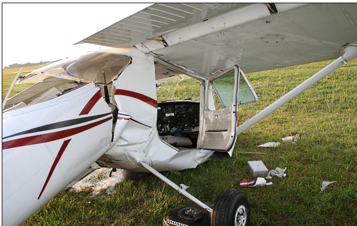
9 – Zbliżenie przełomu kadłuba i kabiny z prawej strony [foto: Policja, M.Dutkowski].
