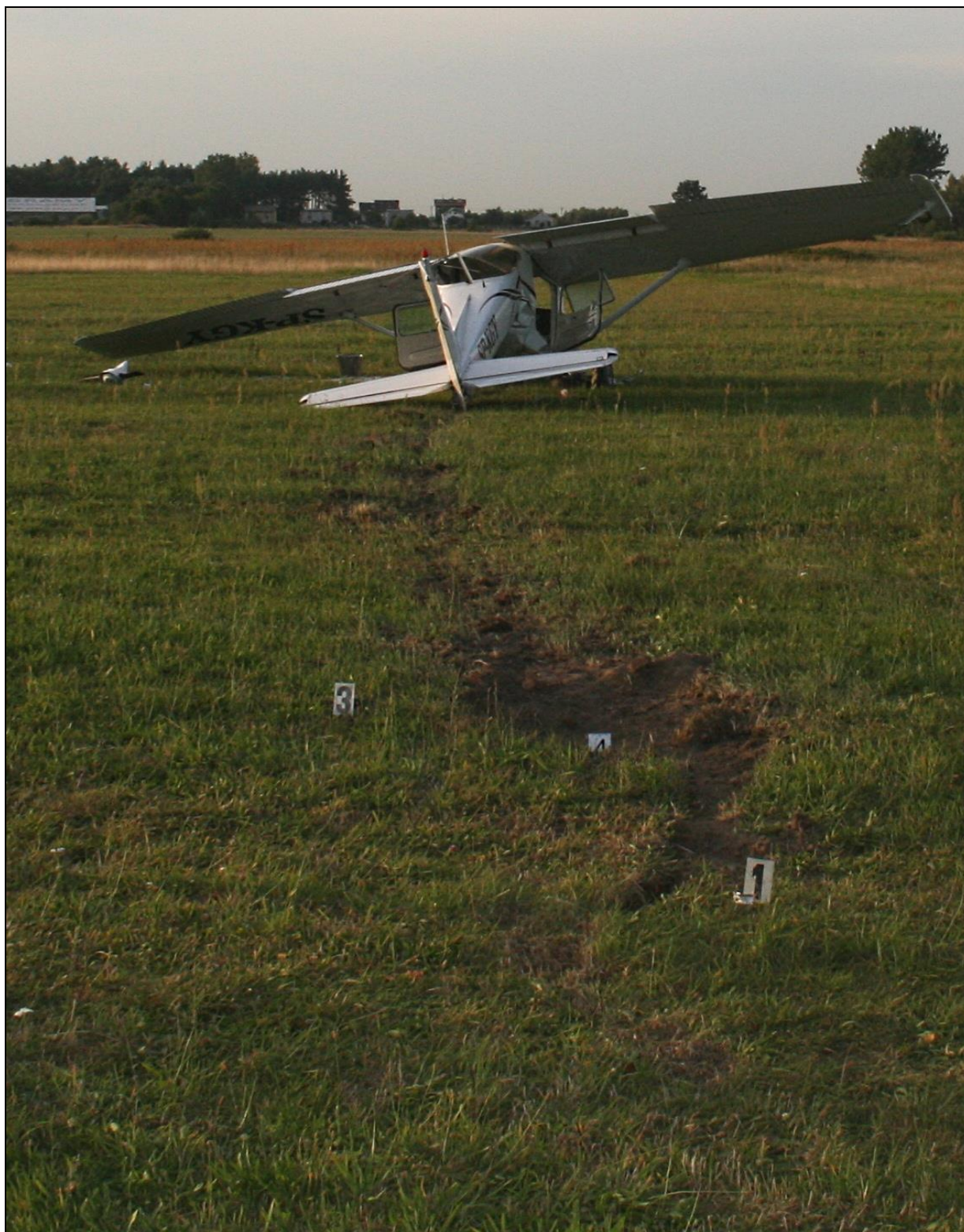
4 – Ślady przyziemienia oraz niszczenia lewego podwozia głównego i podwozia przedniego [foto: Policja, M.Dutkowski].
