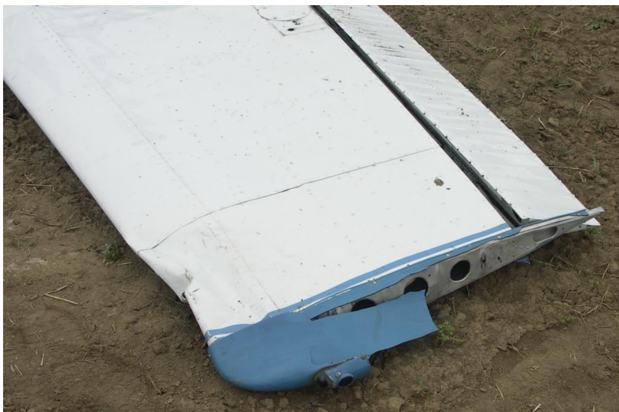
20 – Uszkodzona końcówka prawego skrzydła.
