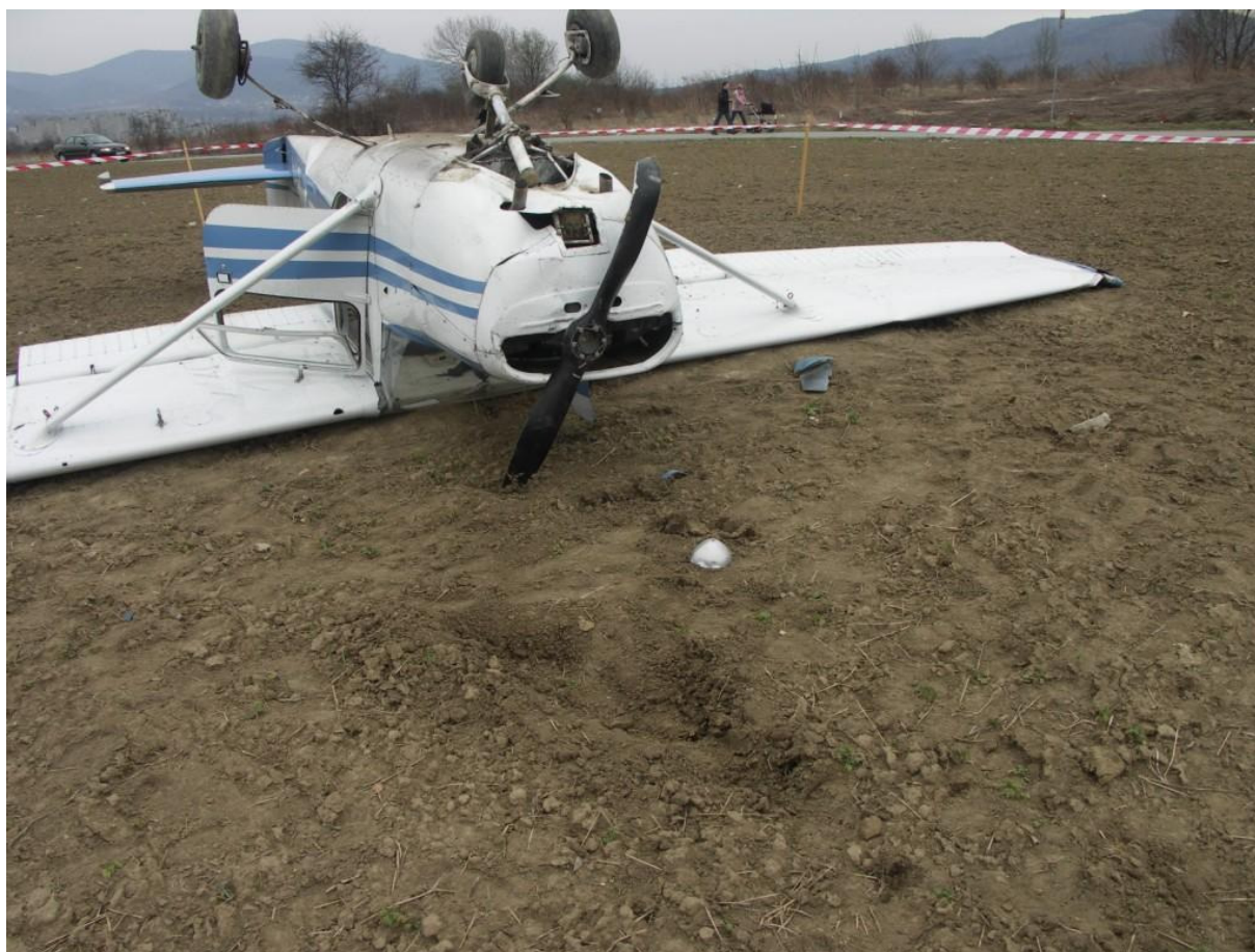
8 – Ślady uderzenia silnikiem i śmigłem.
