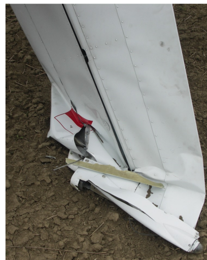
23 – Tylna część kadłuba i dolna część steru kierunku w zbliżeniu. Zwraca uwagę niesymetryczne usytuowanie dźwigni steru kierunku względem wykoju w kadłubie, świadczące o trwałych odkształceniach kadłuba.
