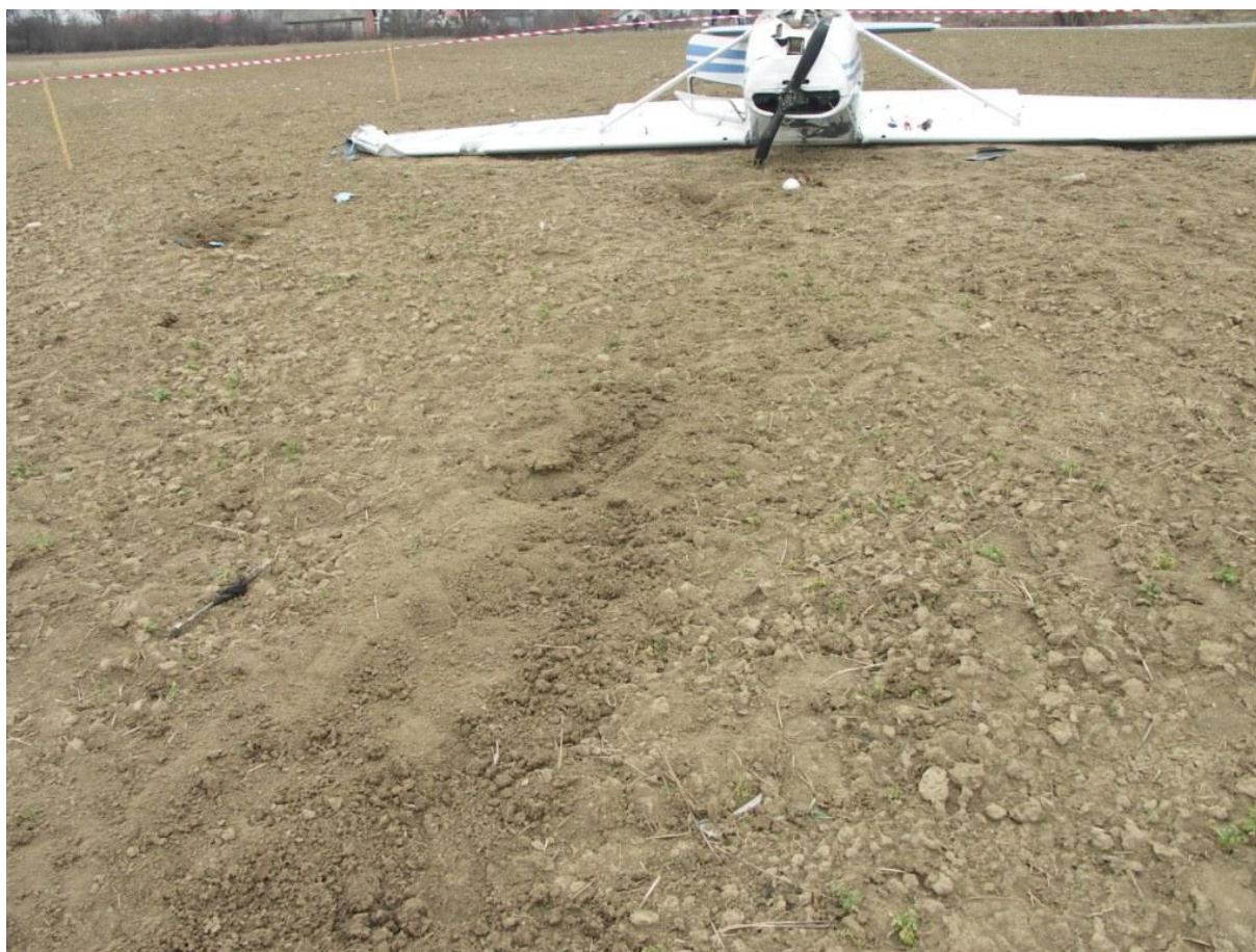
6 – Ślady przyziemienia – ślady uderzenia śmigłem i silnikiem. Widoczne oderwane szczątki.
