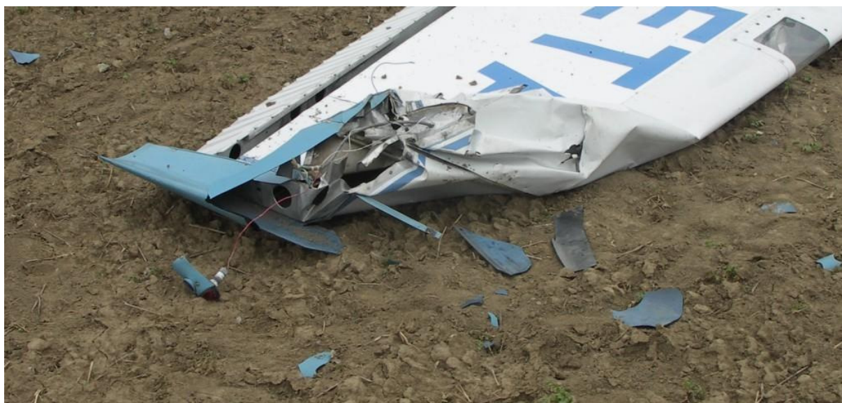
20 – Uszkodzona końcówka prawego skrzydła.
