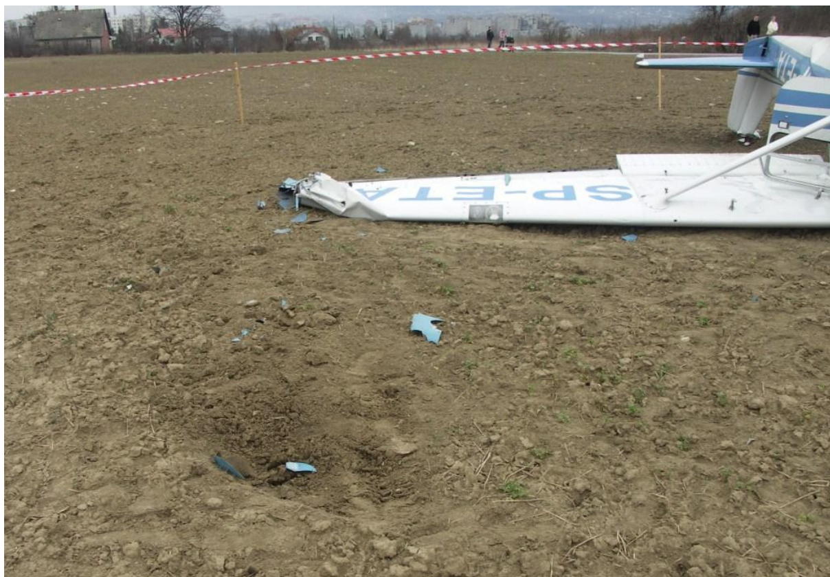
7 – Ślady przyziemienia – ślad uderzenia końcówką lewego skrzydła. Widoczne oderwane szczątki.
