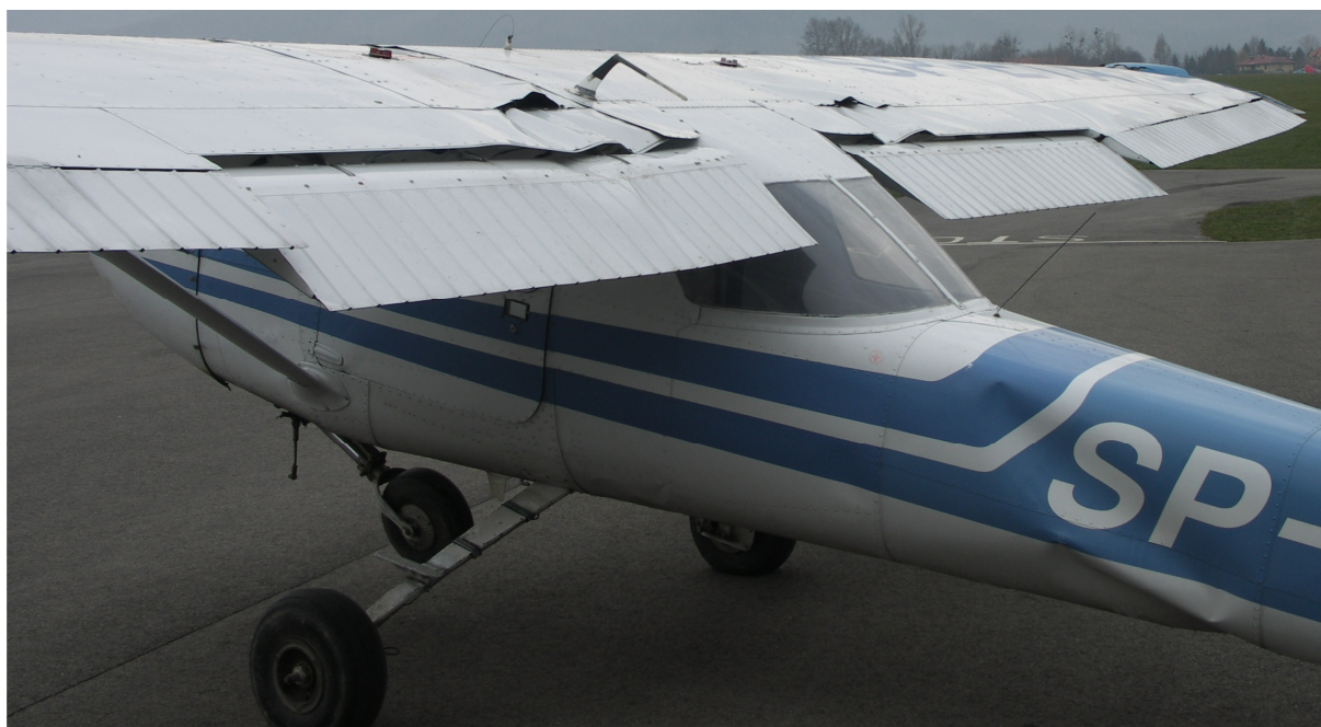
26 – Uszkodzenia górnych pokryć skrzydła.
