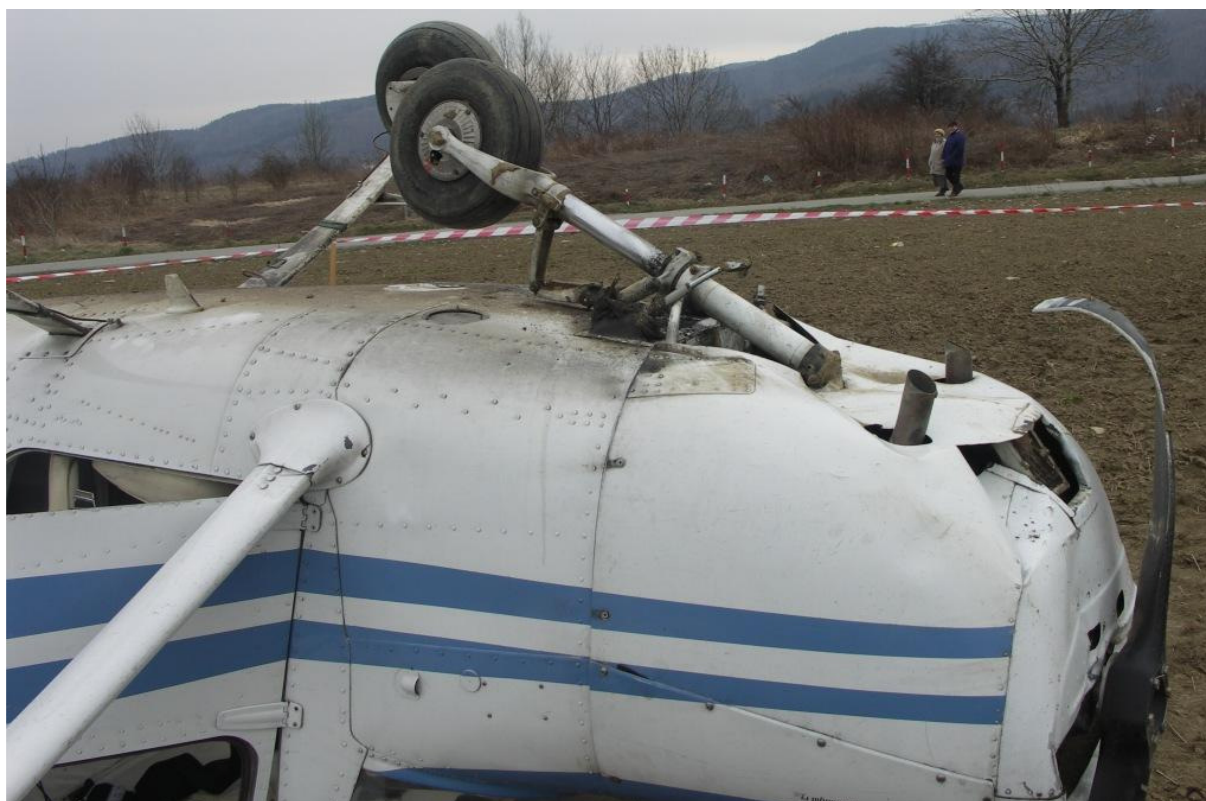
15 – Spód przedniej części kadłuba z lewej strony, widoczne złamane podwozie przednie, wgniecenia osłony silnika i zniszczone śmigło.
