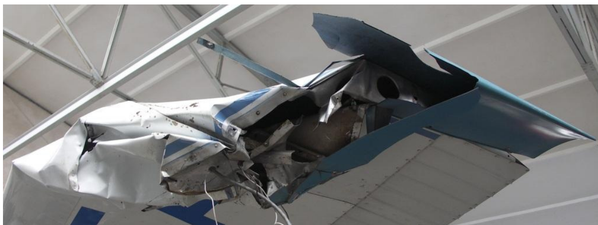
22 – Zniszczona końcówka lewego skrzydła
