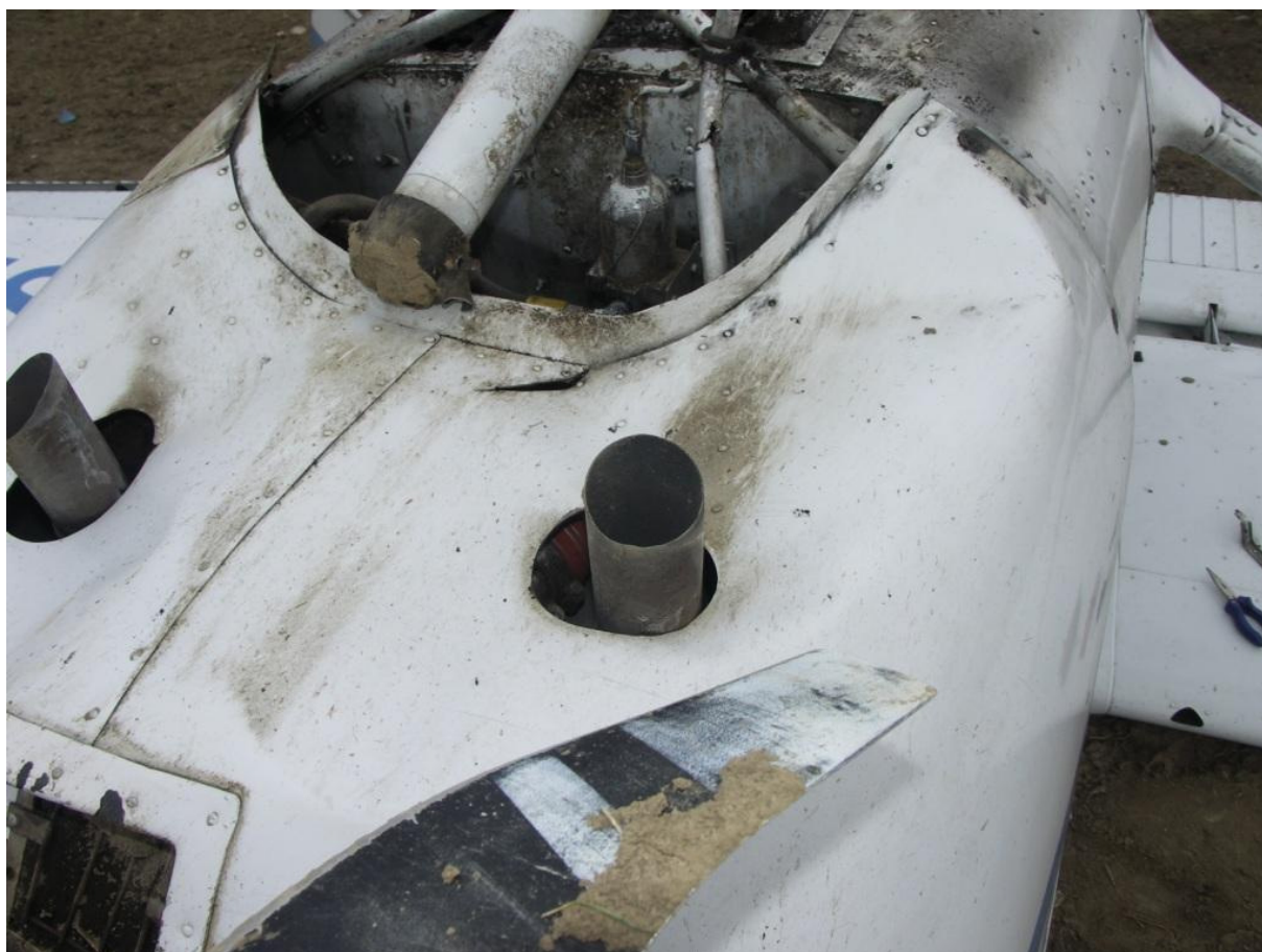
17 i 18 – Spód dolnej osłony silnika z widocznymi uszkodzeniami.
