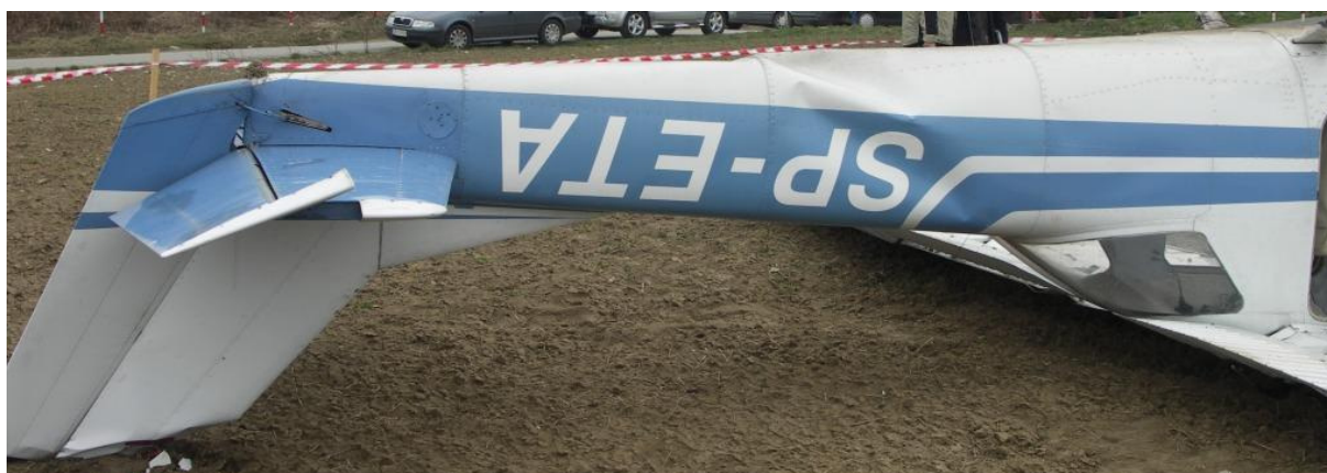
12 – Tylna część kadłuba z lewej strony - widoczne wgniecenia pokryw i zniszczone usterzenie pionowe.
