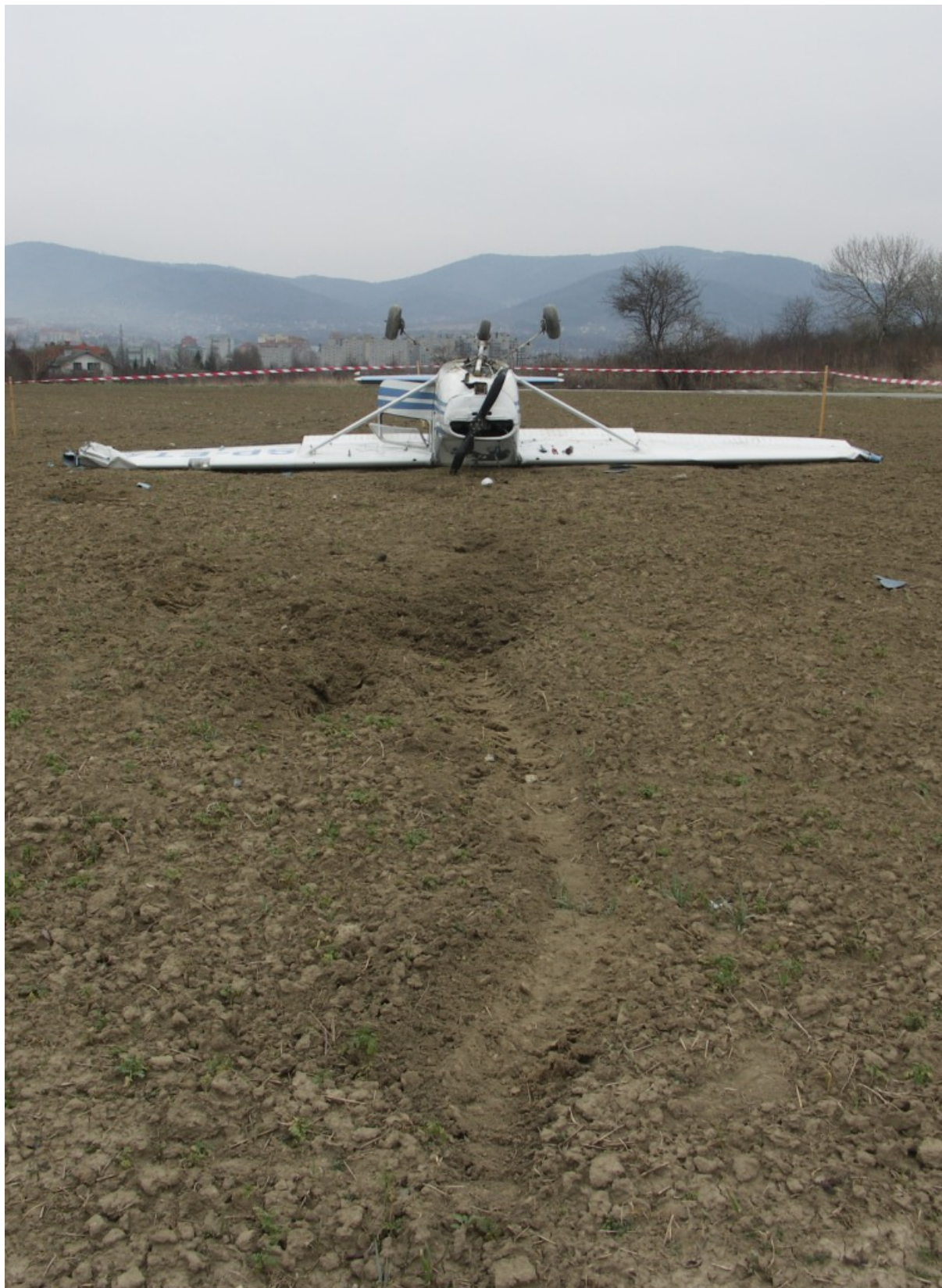
5 – Ogólny widok miejsca wypadku w kierunku lotu. Dobrze widoczne ślady przyziemienia.
