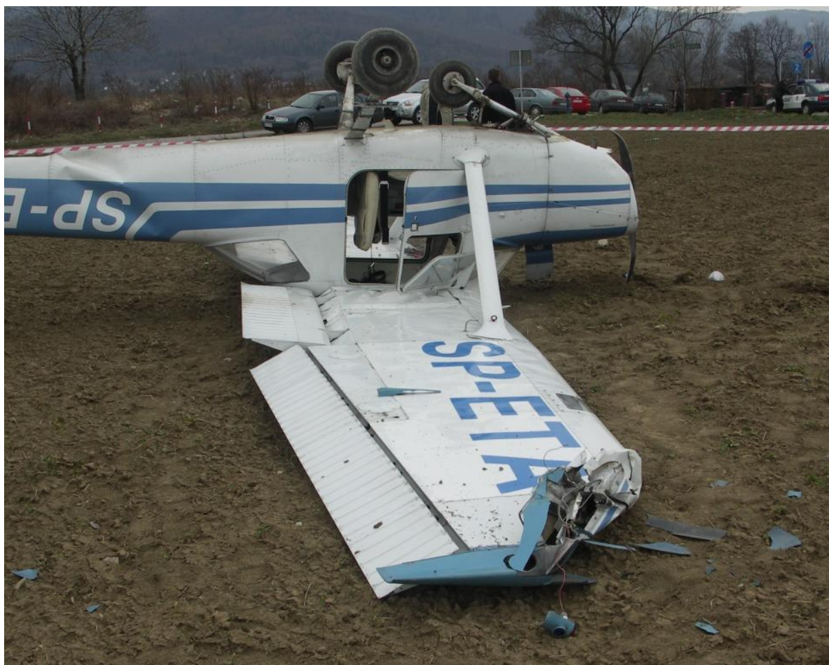
13 – Przednia część samolotu z lewej strony – widoczne uszkodzenia kadłuba, skrzydła i podwozia.
