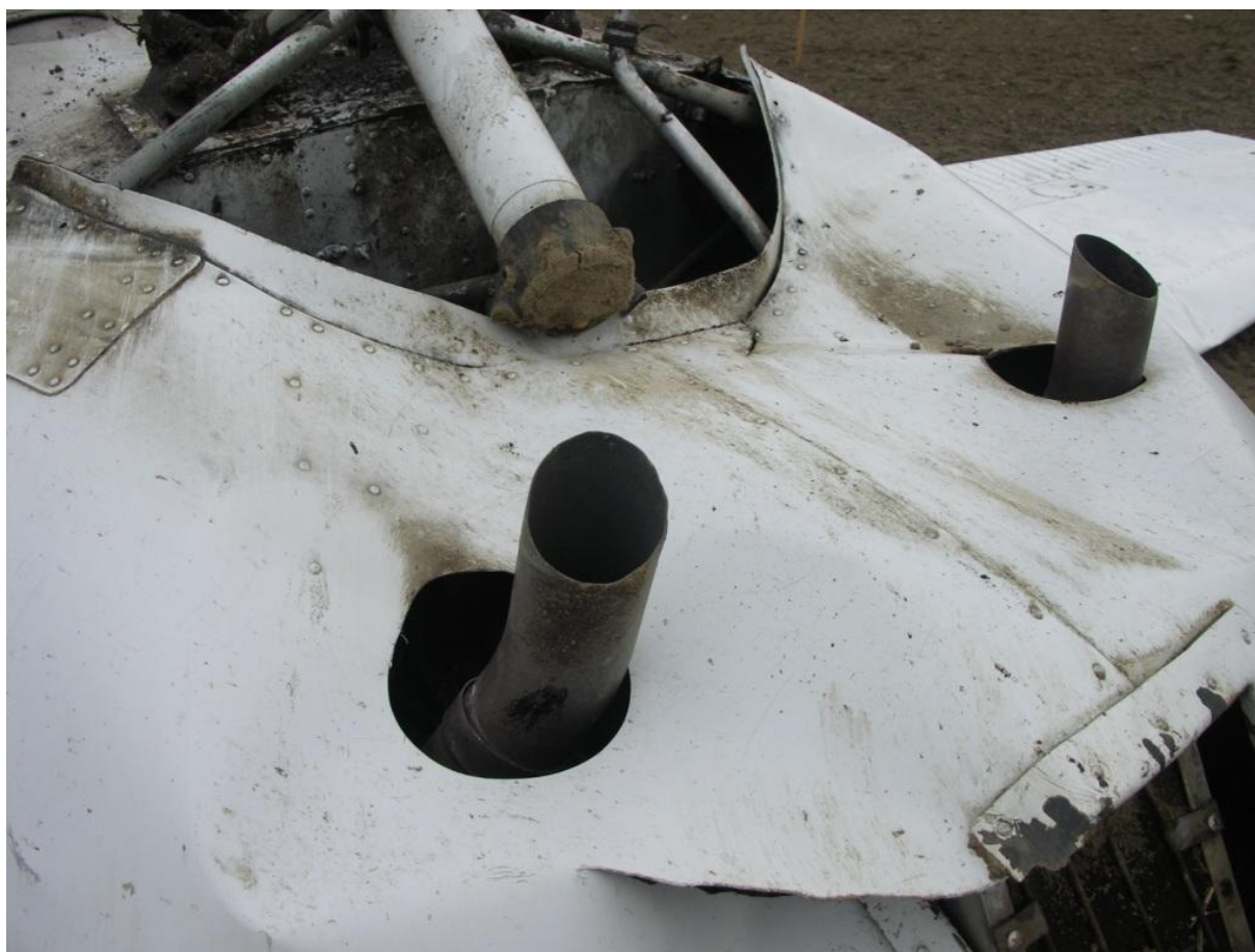
17 i 18 – Spód dolnej osłony silnika z widocznymi uszkodzeniami.
