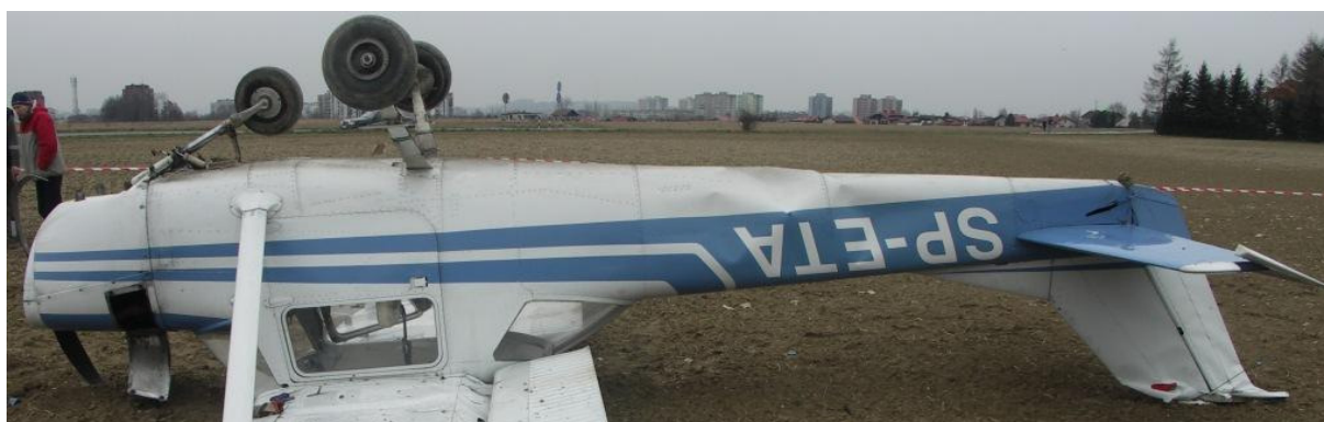
11 – Kadłub z prawej strony – widoczne wgniecenia pokryw w jego tylnej części i zniszczone usterzenie pionowe.
