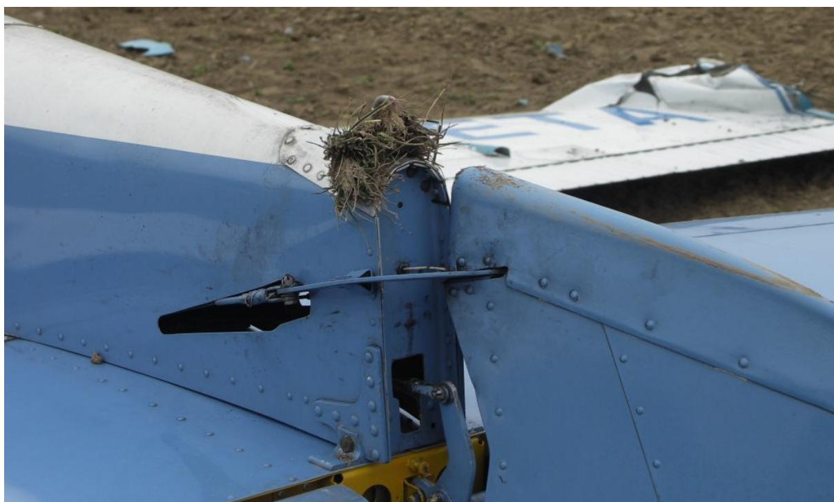
23 – Tylna część kadłuba i dolna część steru kierunku w zbliżeniu. Zwraca uwagę niesymetryczne usytuowanie dźwigni steru kierunku względem wykoju w kadłubie, świadczące o trwałych odkształceniach kadłuba.
