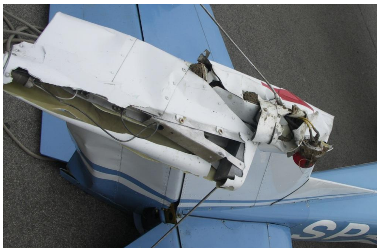
23 – Tylna część kadłuba i dolna część steru kierunku w zbliżeniu. Zwraca uwagę niesymetryczne usytuowanie dźwigni steru kierunku względem wykoju w kadłubie, świadczące o trwałych odkształceniach kadłuba.
