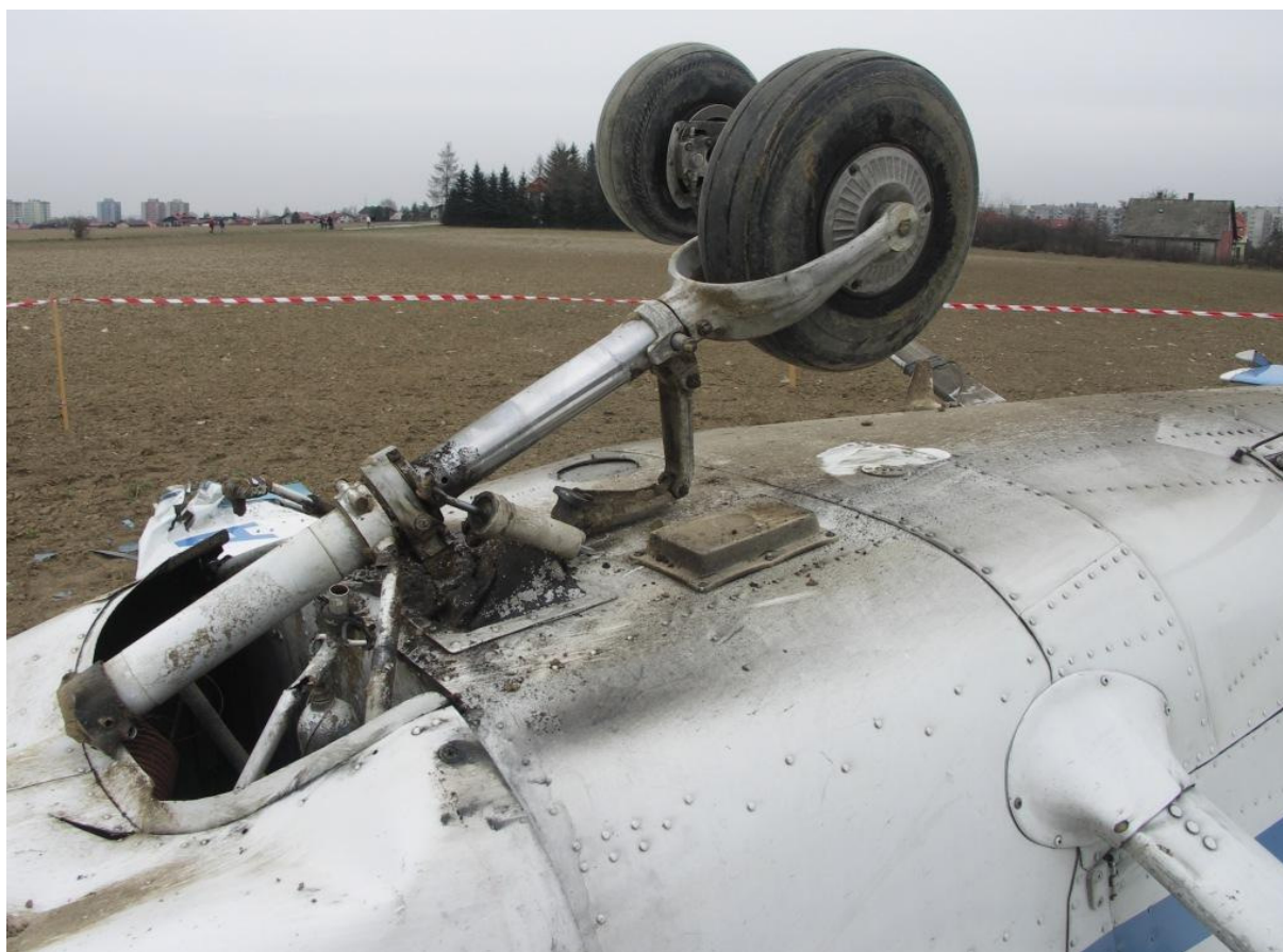
16 – Spód przedniej części kadłuba z prawej strony, widoczne złamane podwozie przednie i wgniecenia osłony silnika.
