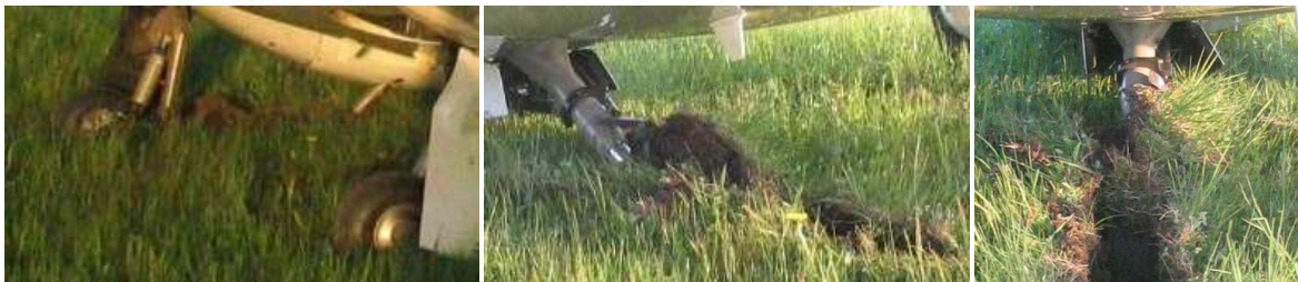
Rys.2. Samolot zaryty w grząskim gruncie – dobrze widoczne ślady kół podwozia
