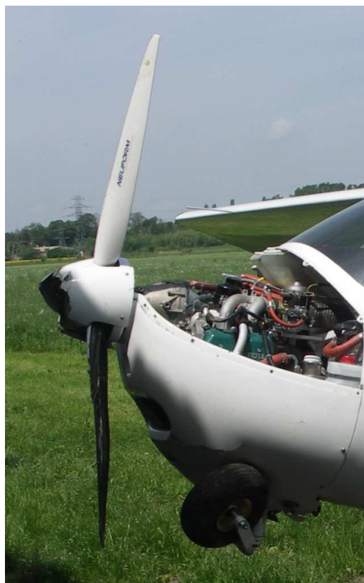
6 i 7 – Przednia część samolotu – zespół napędowy ze zniszczonym śmigłem, złamane podwozie przednie i uszkodzona dolna pokrywa silnika.
