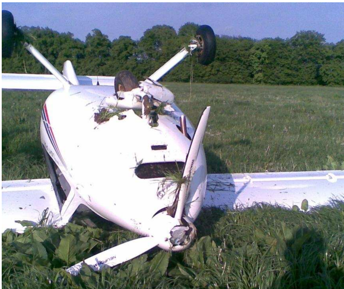
3 – Samolot bezpośrednio po kapotażu.
