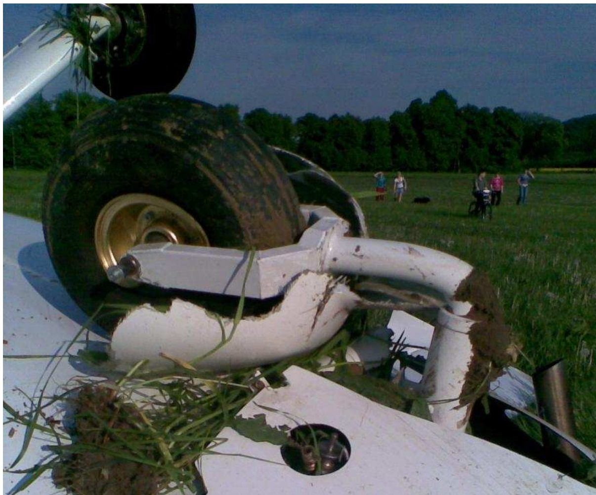
5 – Zbliżenie na złamane podwozie przednie przewróconego samolotu, widoczna zniszczona owiewka.
