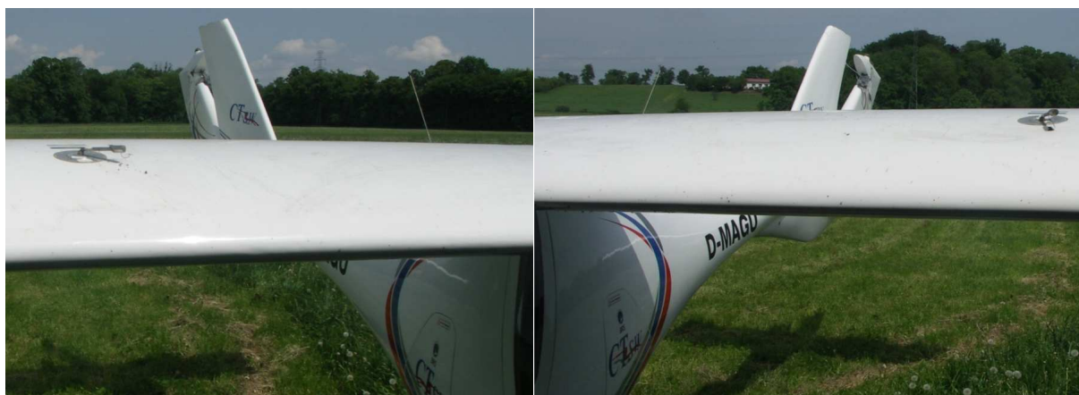
9 i 10 – Widok na górne pokrycia prawego i lewego skrzydła z odpowietznikami instalacji paliwowej.
