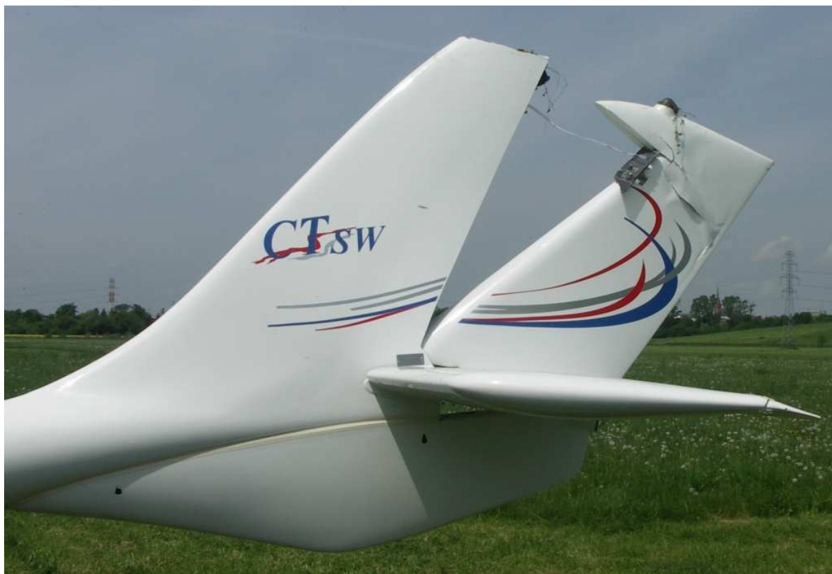
13 – Usterzenie pionowe z wyłamanym sterem kierunku, lewa strona.
