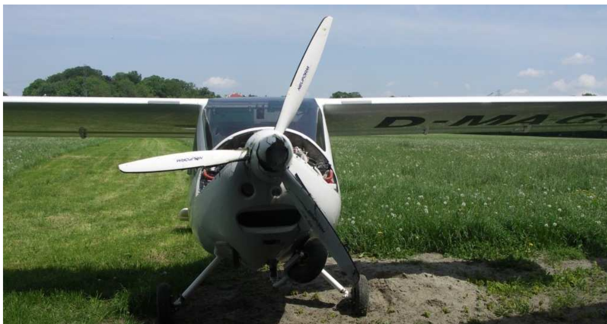
8 – Samolot po odwróceniu, widok od przodu. Widoczne zniszczone śmigło i złamane przednie podwozie.
