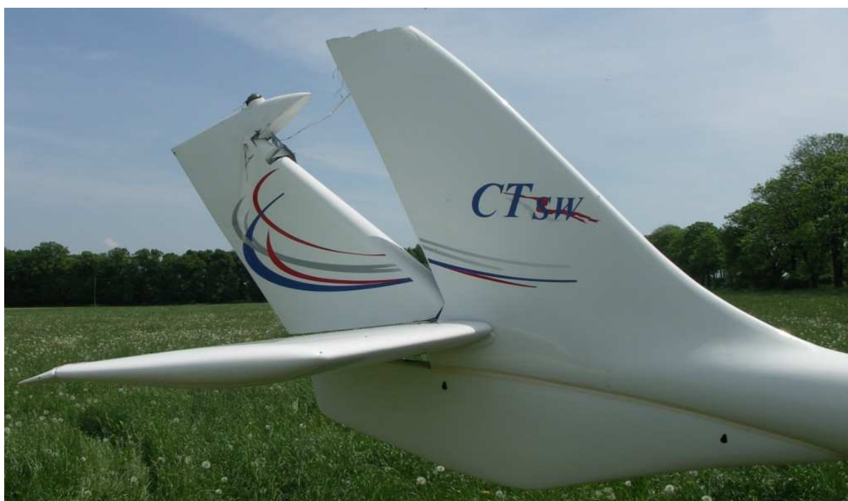
14 – Usterzenie pionowe z wyłamanym sterem kierunku, prawa strona.
