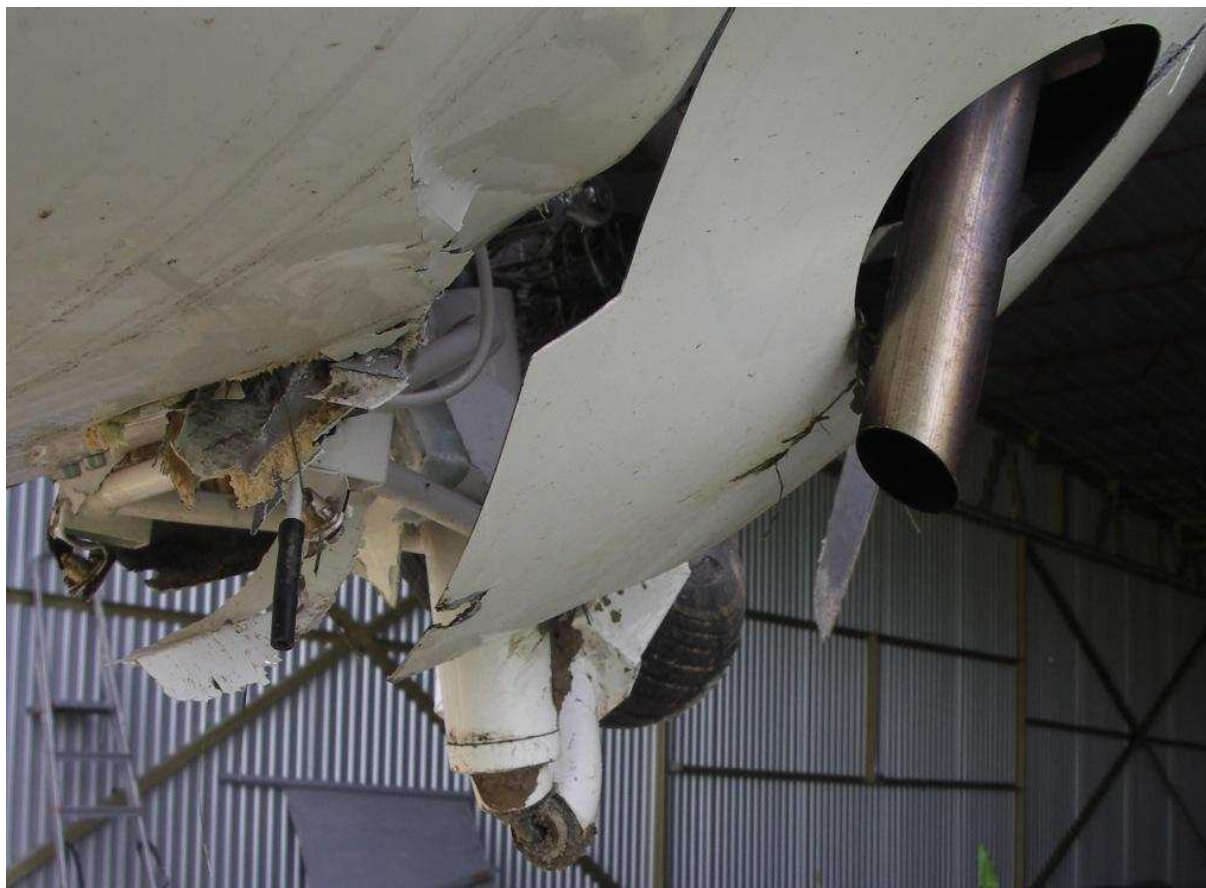
15 – Spód kadłuba w rejonie przegrody ogniowej – widać uszkodzenia dolnej osłony silnika, złamane podwozie przednie i zniszczoną owiewkę.
