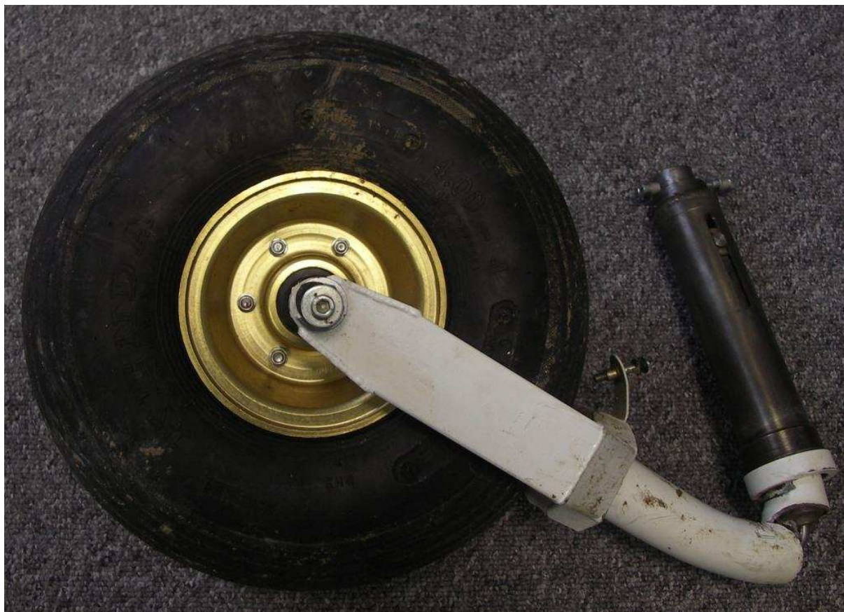
19 – Zdemonutowane podwozie przednie, lewa strona. Widoczny ślad „zagarniania” gruntu oponą i uszkodzenie widelca przy osi koła.
