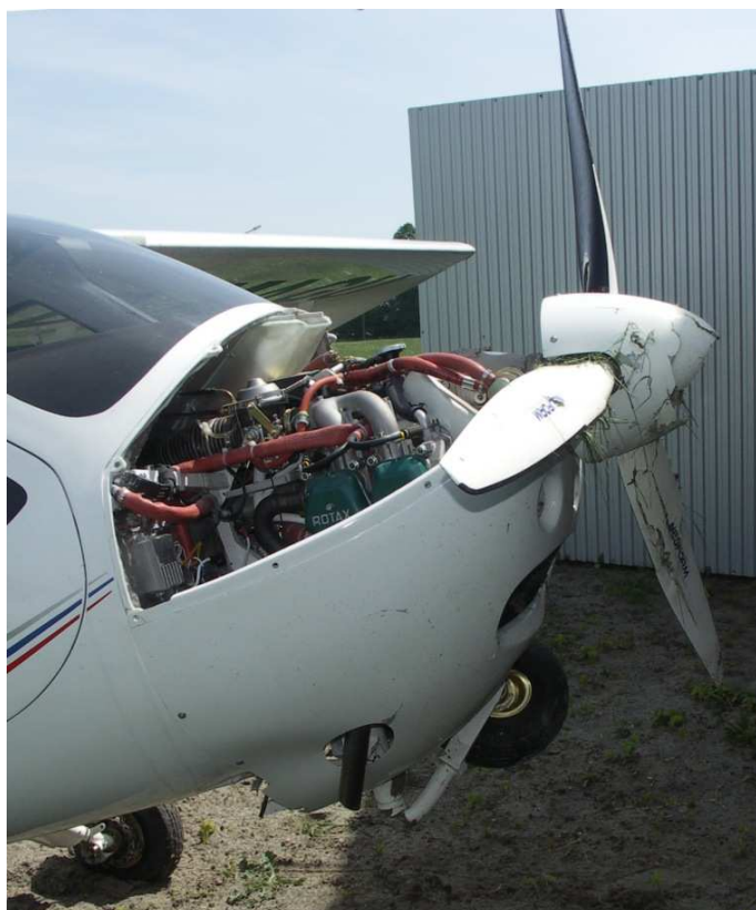
6 i 7 – Przednia część samolotu – zespół napędowy ze zniszczonym śmigłem, złamane podwozie przednie i uszkodzona dolna pokrywa silnika.
