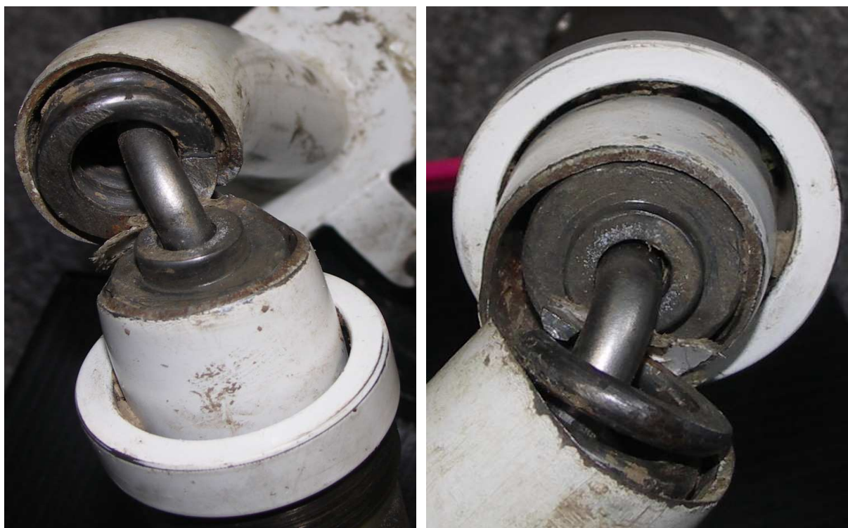
23 i 24 – Przełom rury goleni podwozia przedniego, pokazany w dwóch ujęciach na zbliżeniu.
