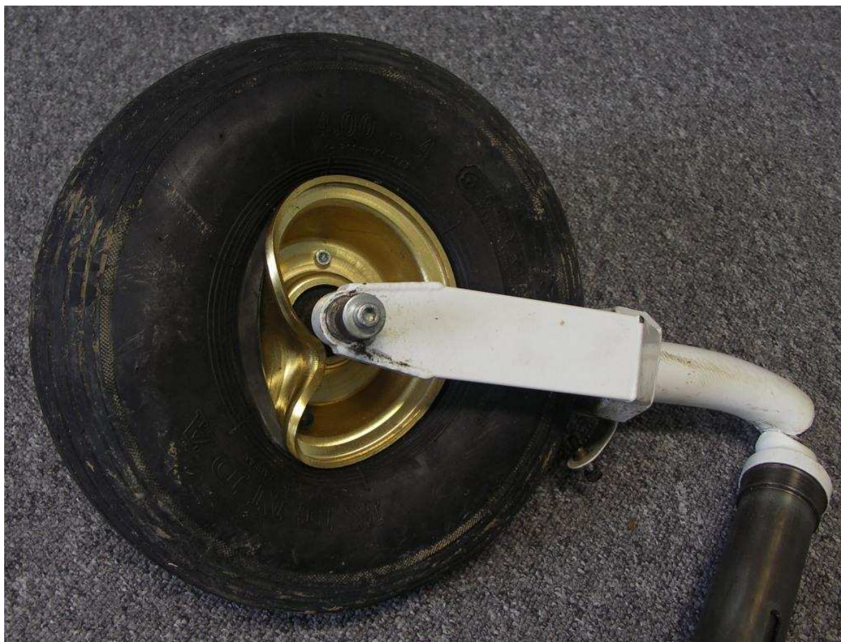
20 – Zdemonutowane podwozie przednie, prawa strona. Widoczne uszkodzenie obręczy oraz odciski obręczy i widelca na oponie.
