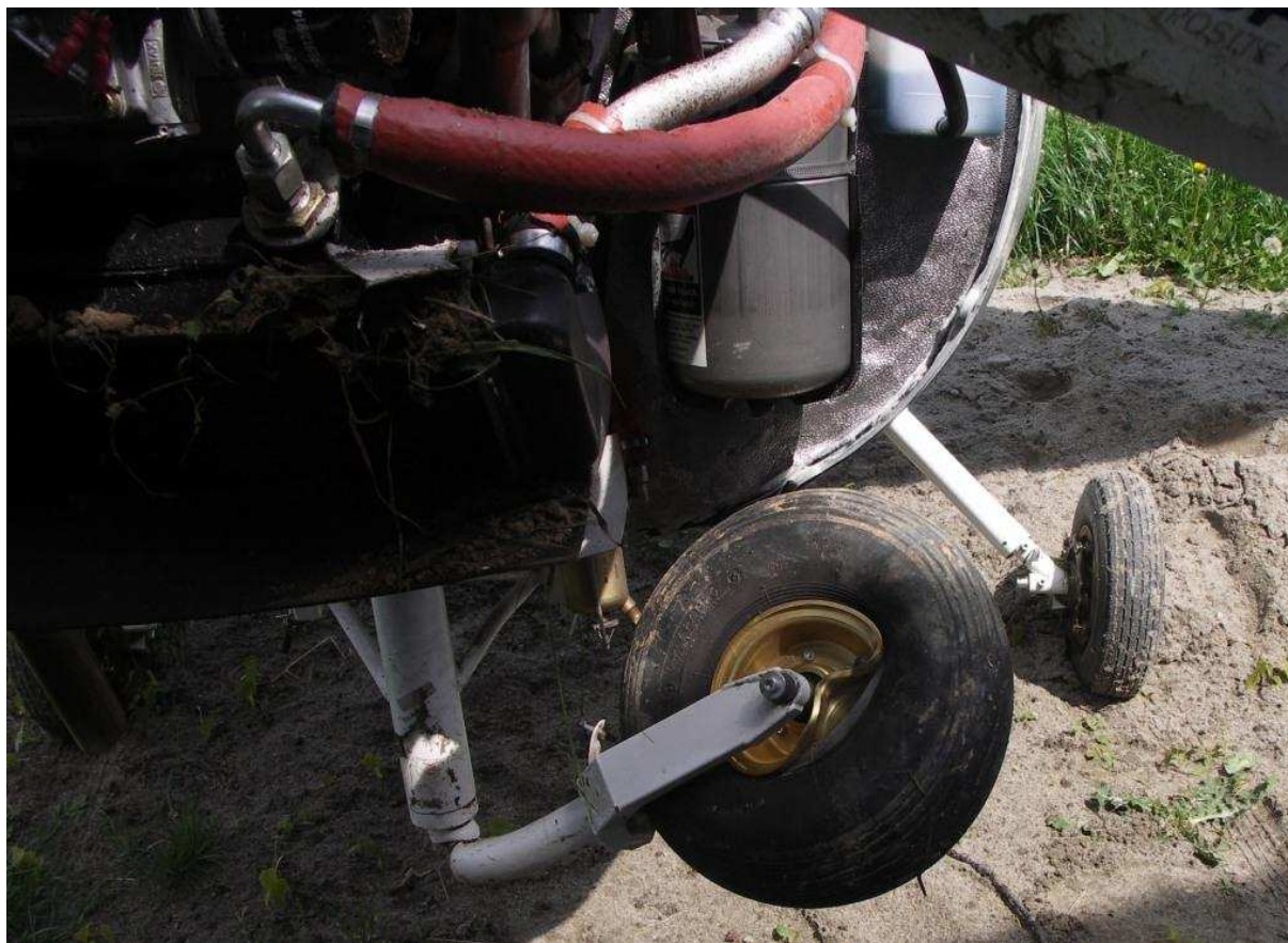
17 – Widok z przodu na wyłamane podwozie przednie.
