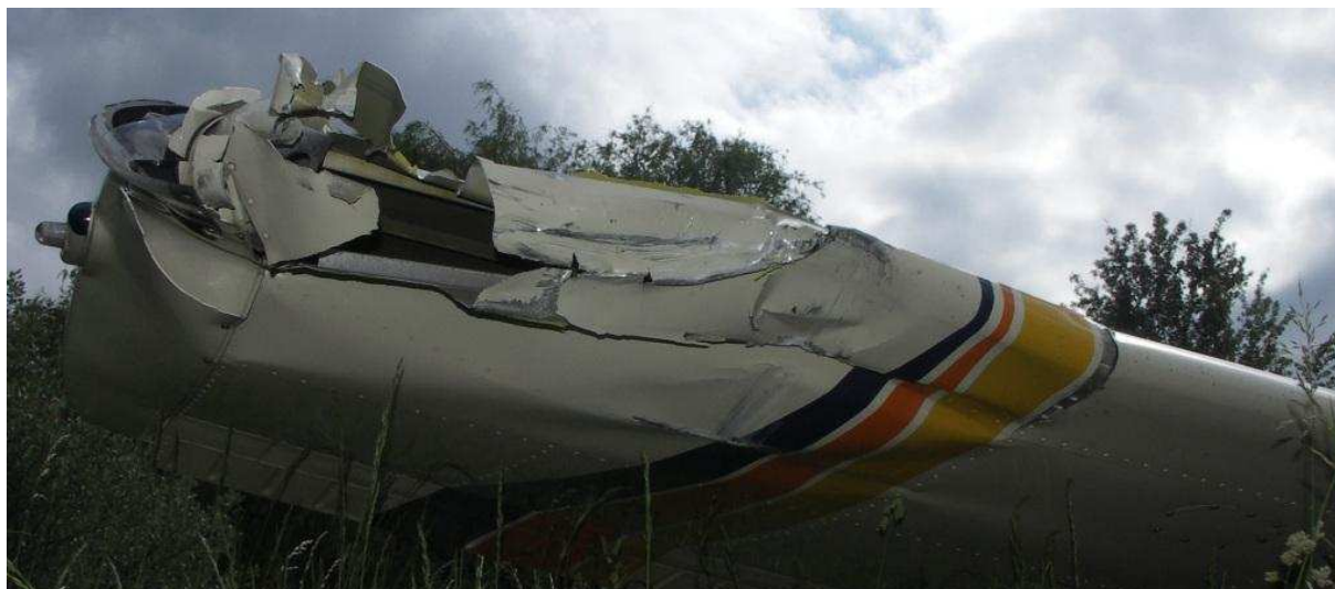
7 – Uszkodzenia końcówki prawego skrzydła samolotu D-EAKP.
