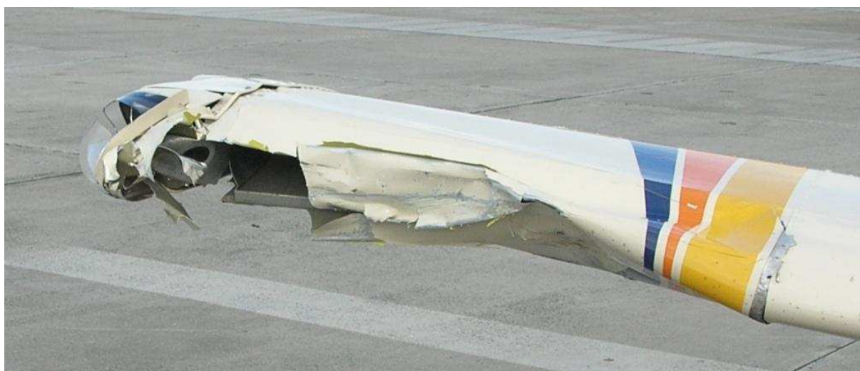
5 – Uszkodzenia końcówki prawego skrzydła samolotu D-EAKP.
