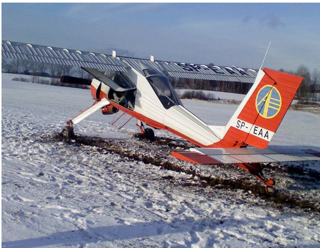
5 – Samolot po wylądowaniu. Koła podwozia prawie do połowy zagłębione w grząskim gruncie. Silniejsze zagłębienie prawego koła spowodowało lekkie zejście w prawo z kierunku dobiegu w jego ostatniej fazie.
