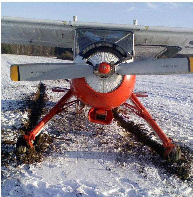
4 – Samolot po wylądowaniu. Koła podwozia głównego prawie do połowy zagłębione w grząskim gruncie. Śmigło nie uszkodzone.
