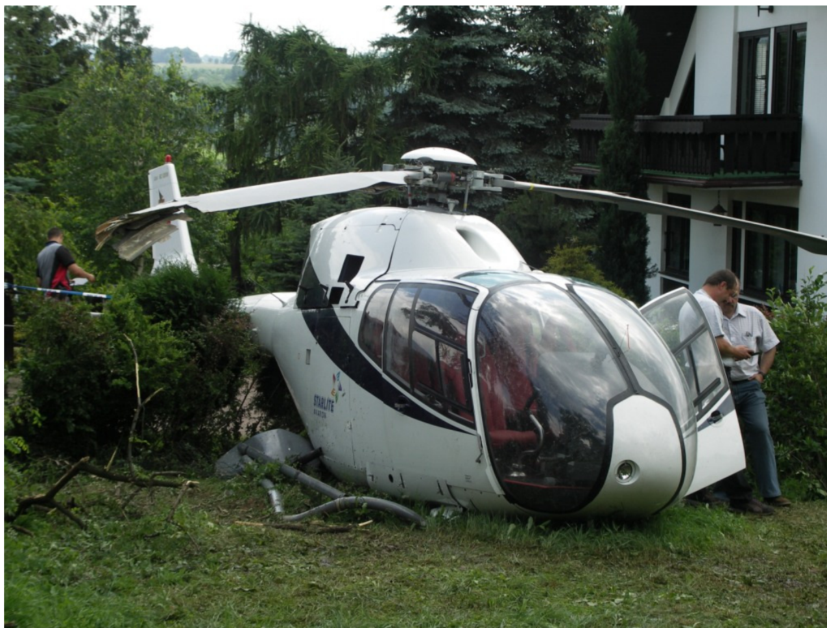
16 – Widok rozbitego śmigłowca \frac{3}{4} od przodu z prawej, widoczne zniszczone podwozie, wirnik nośny i szkody w roślinności.
