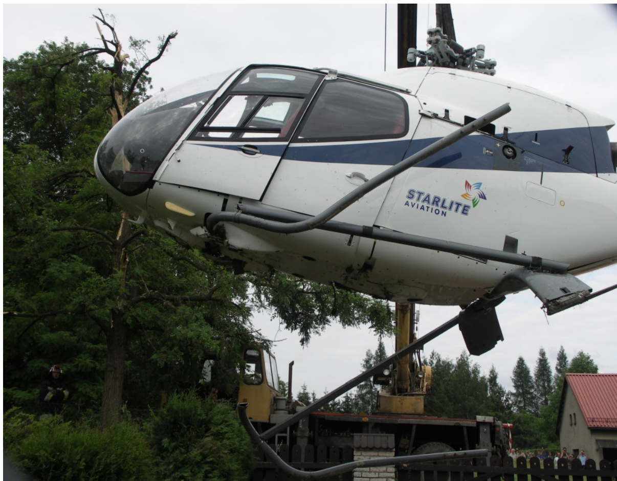
21 – Śmigłowiec podczas usuwania z miejsca wypadku. Dobrze widoczne zniszczone podwozie i uszkodzenia spodu kadłuba.
