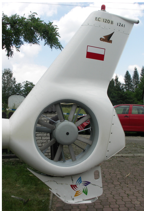
31 i 32 – Usterzenie pionowe z fenestronem z obu stron. Widoczne uszkodzenia płetwy dolnej z płożą.
