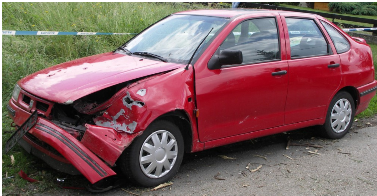
8 – Samochód uszkodzony odłamkami łopat wirnika nośnego śmigłowca (ciężarkami wyważającymi łopaty).
