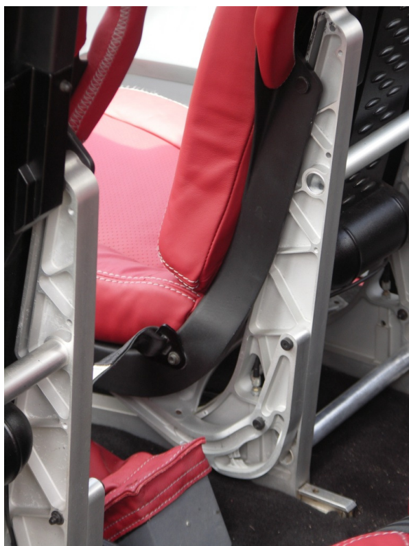
45 i 46 – Widok na strukturę nośną lewego i prawego fotela przedniego. Zwraca uwagę różnica w wyglądzie górnego zamocowania foteli, spowodowana oddziaływaniem ciężaru pilota na prawe siedzisko podczas awaryjnego lądowania i przejściem sworznia nośnego przez szczelinę hamującą, co pokazano na zbliżeniu po prawej stronie.
