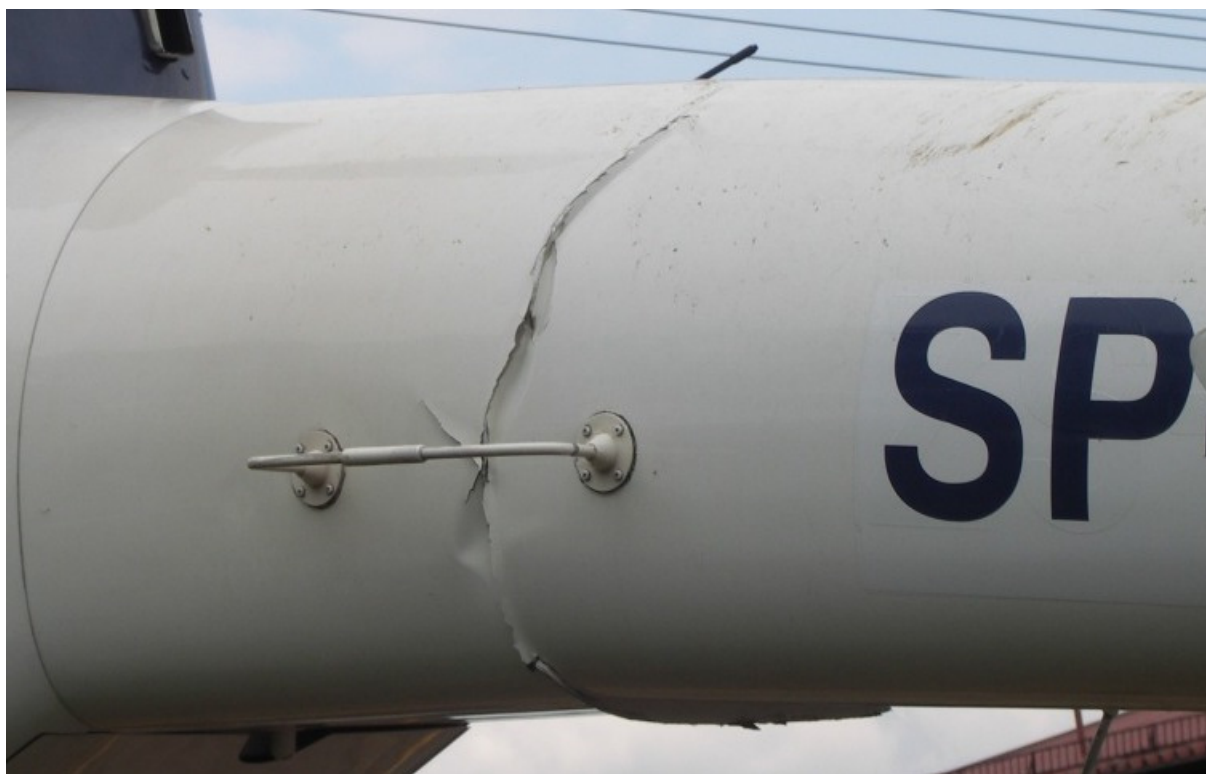
29 – Przełom belki ogonowej, lewa strona. Widoczna antena radiowysokościomierza.
