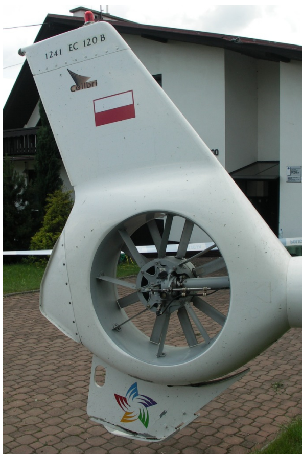
31 i 32 – Usterzenie pionowe z fenestronem z obu stron. Widoczne uszkodzenia płetwy dolnej z płożą.
