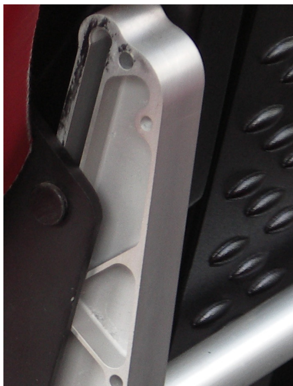
45 i 46 – Widok na strukturę nośną lewego i prawego fotela przedniego. Zwraca uwagę różnica w wyglądzie górnego zamocowania foteli, spowodowana oddziaływaniem ciężaru pilota na prawe siedzisko podczas awaryjnego lądowania i przejściem sworznia nośnego przez szczelinę hamującą, co pokazano na zbliżeniu po prawej stronie.
