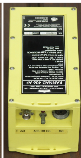
59 i 60 – Awaryjna radiostacja lokalizująca ELT, wymontowana ze śmigłowca.
