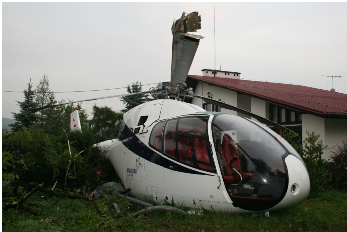
17 – Widok rozbitego śmigłowca \frac{3}{4} od przodu z prawej, widoczne zniszczone podwozie, wirnik nośny i szkody w roślinności.
