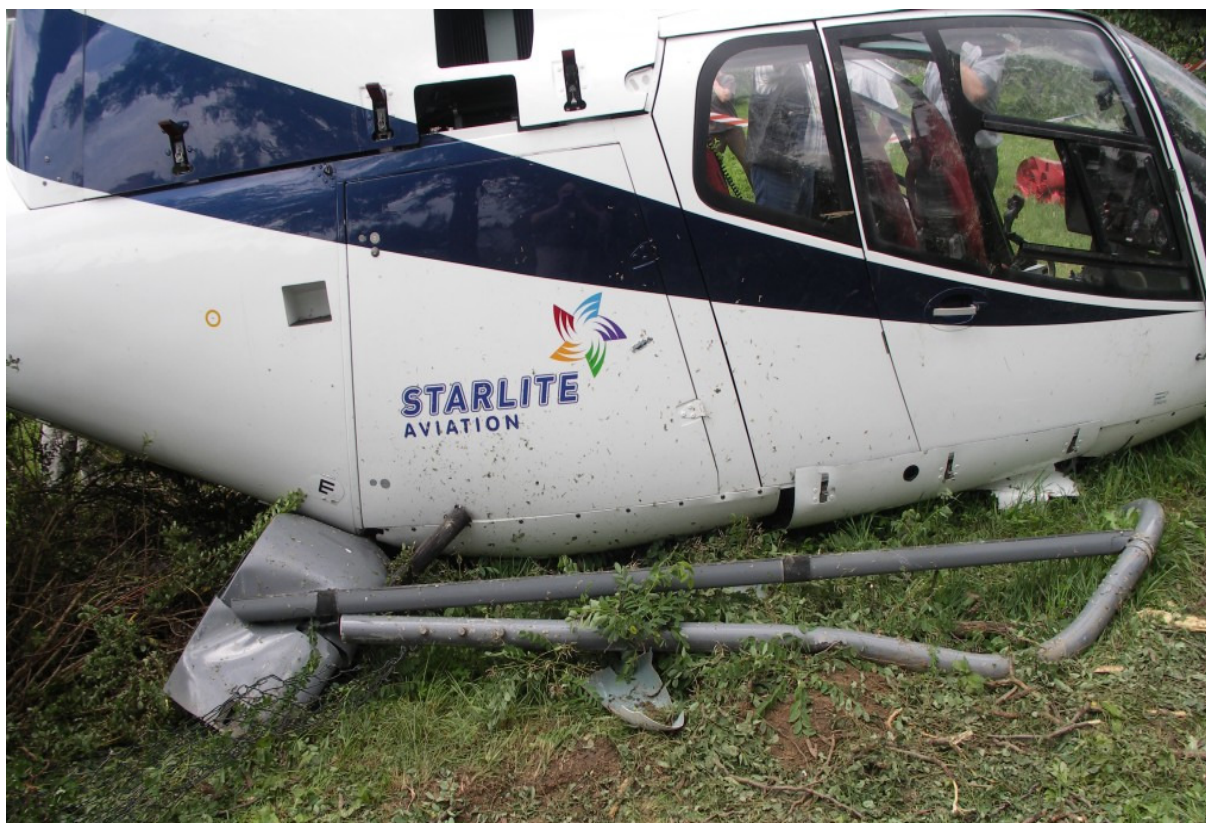
15 – Prawa strona kadłuba, dobrze widoczne zniszczone podwozie płozowe.
