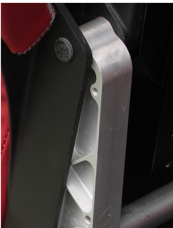
47 i 48 – Widok na strukturę nośną lewego fotela przedniego. Zwraca uwagę różnica w wyglądzie górnego zamocowania foteli – w przypadku lewego przedniego fotela nie miało miejsca oddziaływanie ciężaru pilota na siedzisko (fotel był wolny) i sworznie nośny pozostał w górnym położeniu w szczelinie hamującej, co pokazano na zbliżeniu po prawej stronie.
