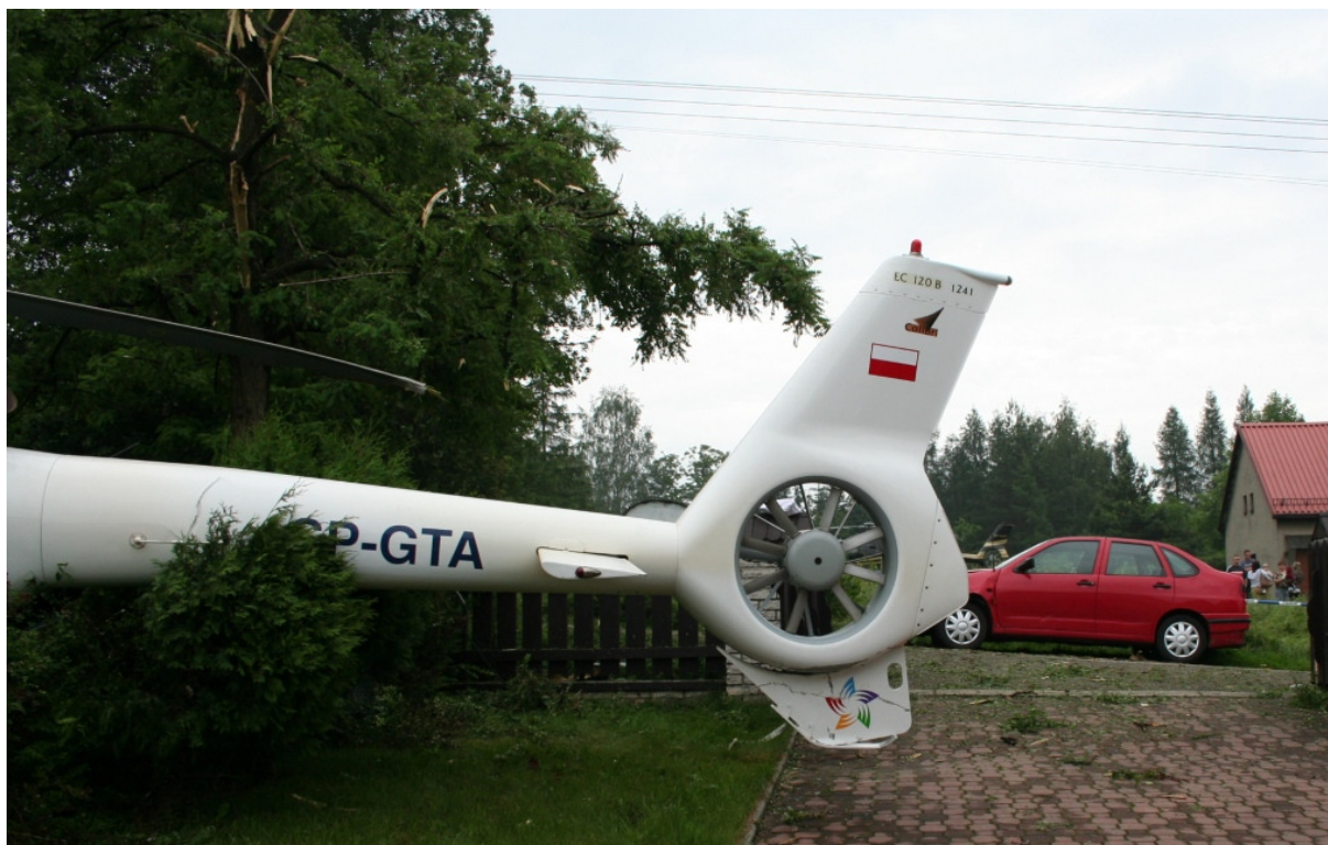
7 – Widok belki ogonowej rozbitego śmigłowca od strony domu Słoneczna 37. W tle samochód uszkodzony odłamkami łopat wirnika nośnego.
