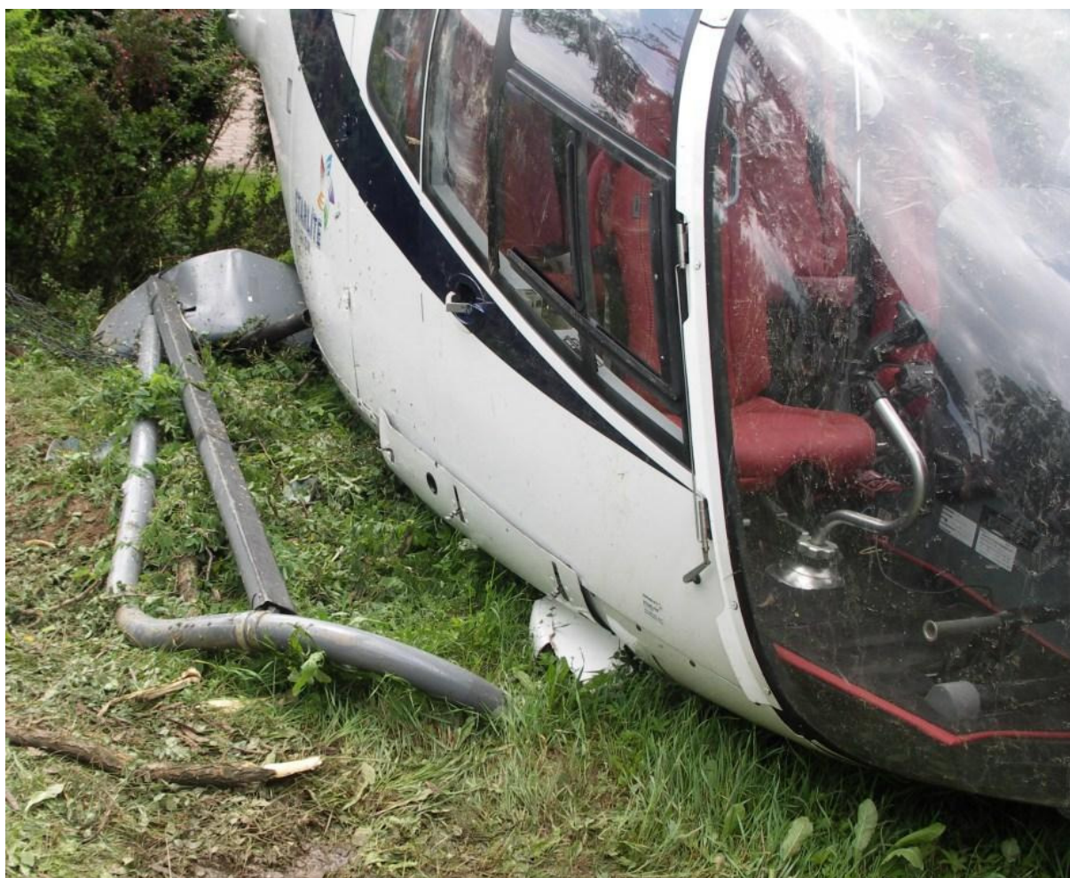
18 – Zbliżenie na zniszczoną prawą płozę podwozia.
