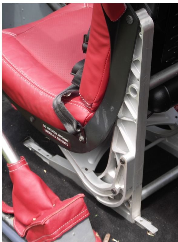
47 i 48 – Widok na strukturę nośną lewego fotela przedniego. Zwraca uwagę różnica w wyglądzie górnego zamocowania foteli – w przypadku lewego przedniego fotela nie miało miejsca oddziaływanie ciężaru pilota na siedzisko (fotel był wolny) i sworznie nośny pozostał w górnym położeniu w szczelinie hamującej, co pokazano na zbliżeniu po prawej stronie.
