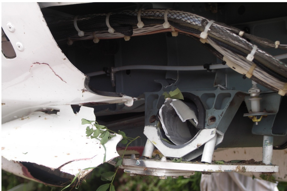
25 – Prawe przednie okucie rurowej goleni podwozia z resztką wyłamanej goleni.
