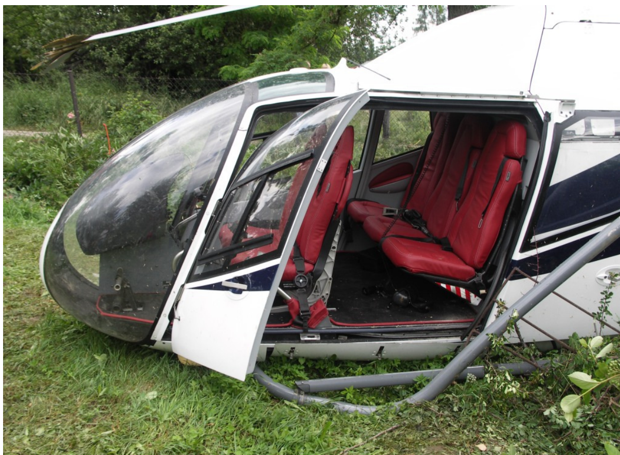
20 – Widok kabinowej części kadłuba z lewej strony. Widoczna zniszczona lewa płyta podwozia.
