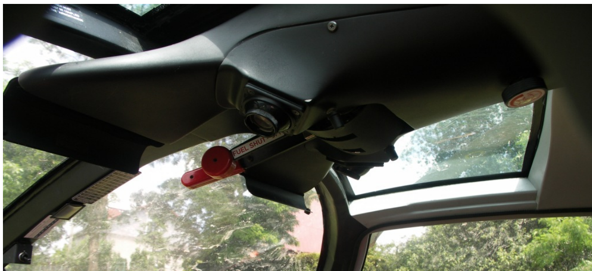
61 – Pulpit górny z lewej strony – dobrze widoczne położenie dźwigni.
