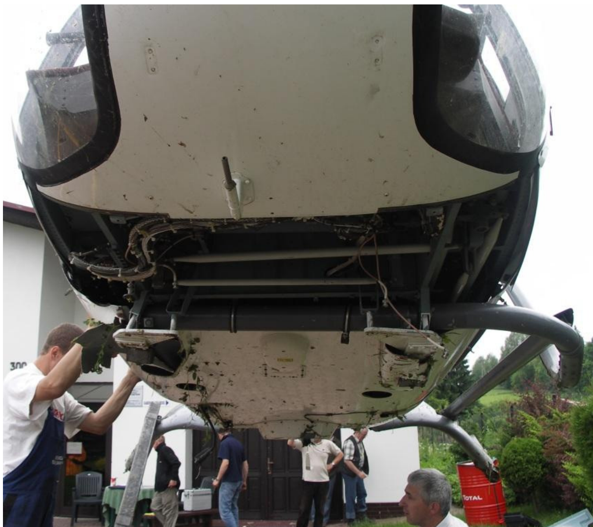
26 – Śmigłowiec podczas usuwania z miejsca wypadku. Widoczne uszkodzenia dolnych osłon kadłuba. Przednia osłona zdjęta.
