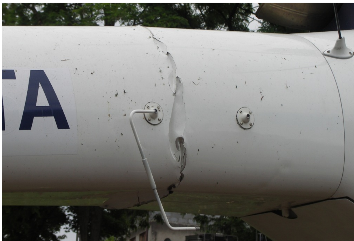
28 – Przełom belki ogonowej, prawa strona. Widoczna oderwana antena radiowysokościomierza.
