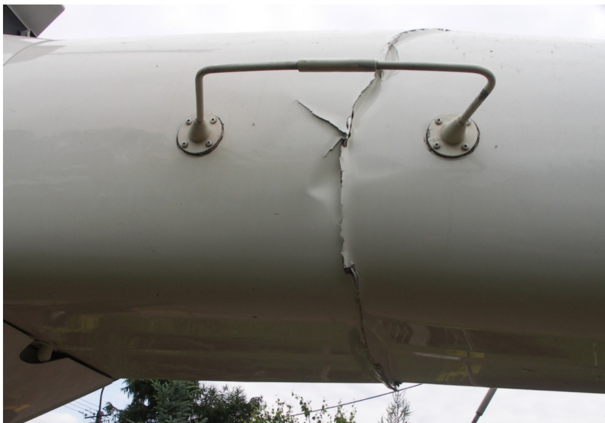
30 – Przełom belki ogonowej, spód i lewa strona. Widoczna antena radiowysokościomierza.
