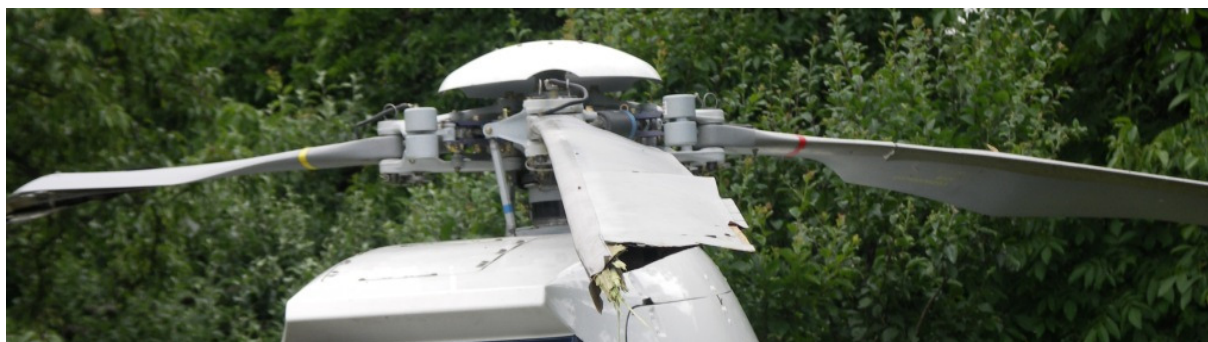
37 – Głowica wirnika nośnego. Widoczne resztki łopat.
