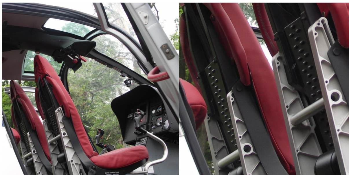
49 i 50 – Widok na strukturę nośną lewego i prawego fotela przedniego z prawej strony. Zwraca uwagę różnica w wyglądzie górnego zamocowania foteli, spowodowana oddziaływaniem ciężaru pilota na prawe siedzisko i przejściem sworznia nośnego przez szczelinę hamującą, co pokazano na zbliżeniu po prawej stronie.
