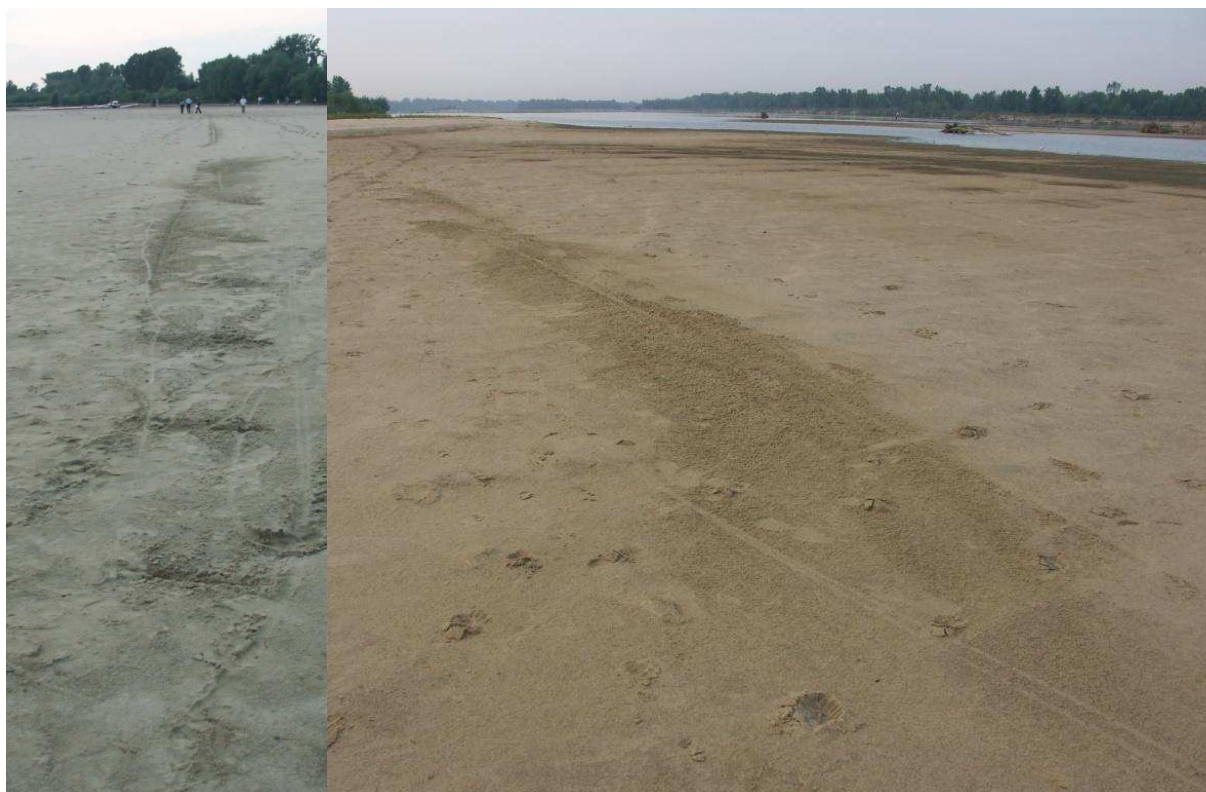
5 i 6 – Ślady przyziemienia samolotu na piaszczystej plaży przy wschodnim brzegu Wisły. Z lewej widok w kierunku lądowania, z prawej – w kierunku przeciwnym. Dobrze widoczne ślady kontaktu łopat śmigła z ziemią i ślad zagłębiającego się stopnia na kadłubie.
