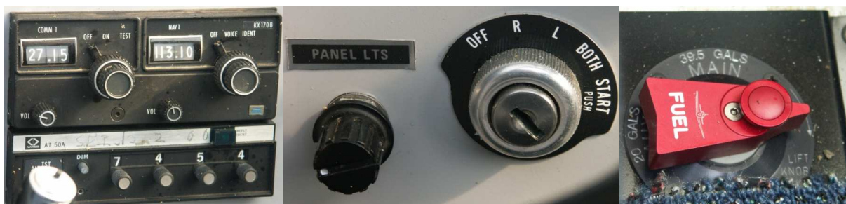
33, 34, 35 – Radiostacja (z widocznymi nastawami częstotliwości), stacyjka zapłonowa (w położeniu OFF) i główny zawór paliwowy.
