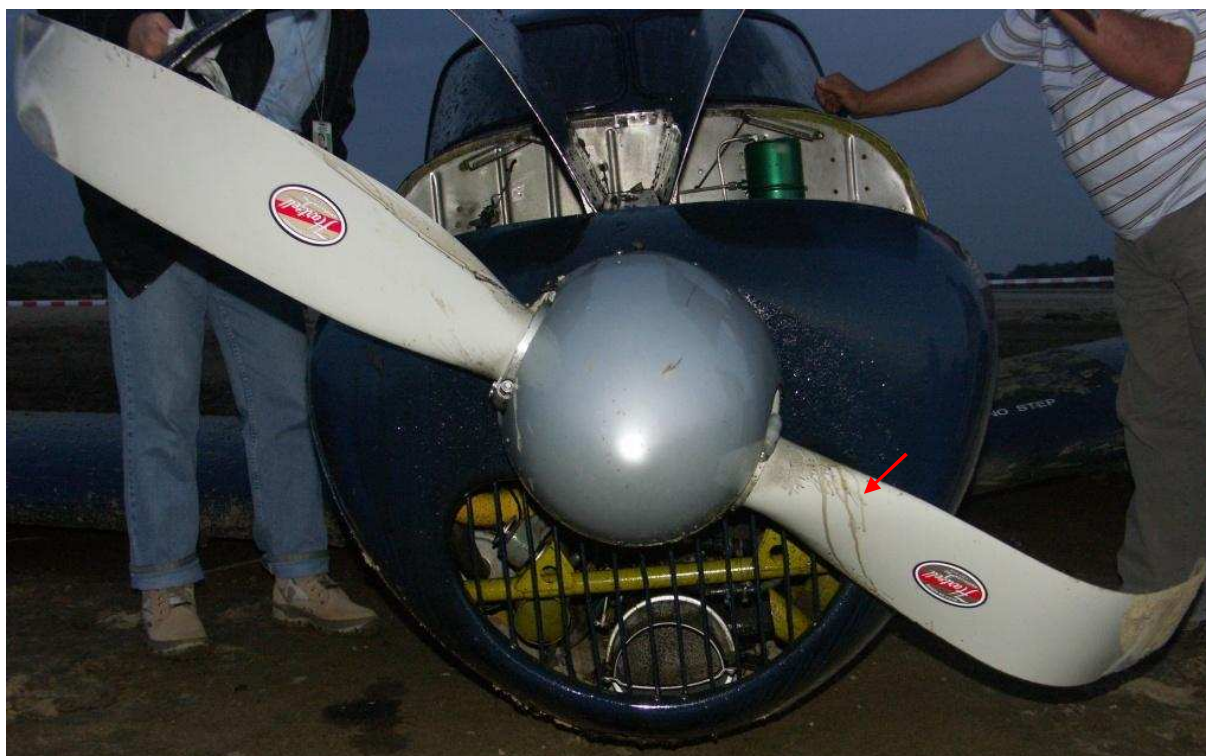
20 – Przód samolotu. Widoczne zniszczone śmigło z wyraźnymi zaciekami (strugami) oleju w okolicy piasty; szczegóły konstrukcji zespołu napędowego za wlotem powietrza.
