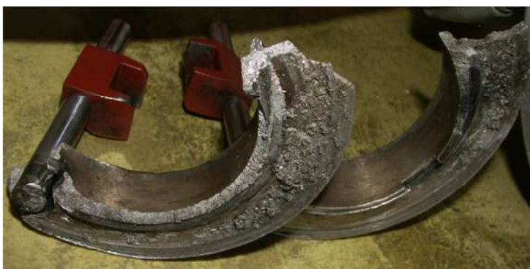
39 – Dwie części złamanej obrotowej tarczy sterującej B-87 JACK PLATE.
