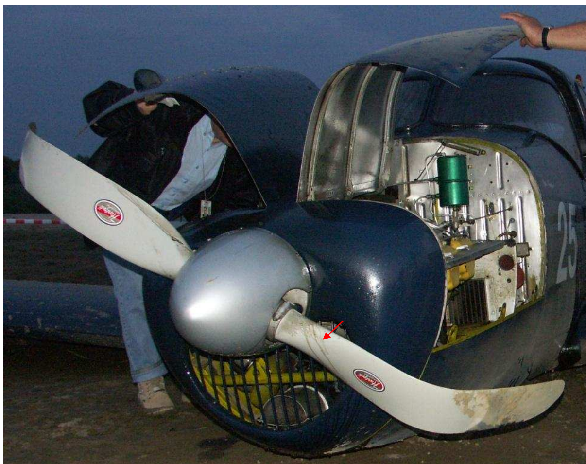
22 – Zniszczone śmigło z wyraźnymi zaciekami (strugami) oleju w okolicy piasty. Ostony zespołu napędowego otwarte.
