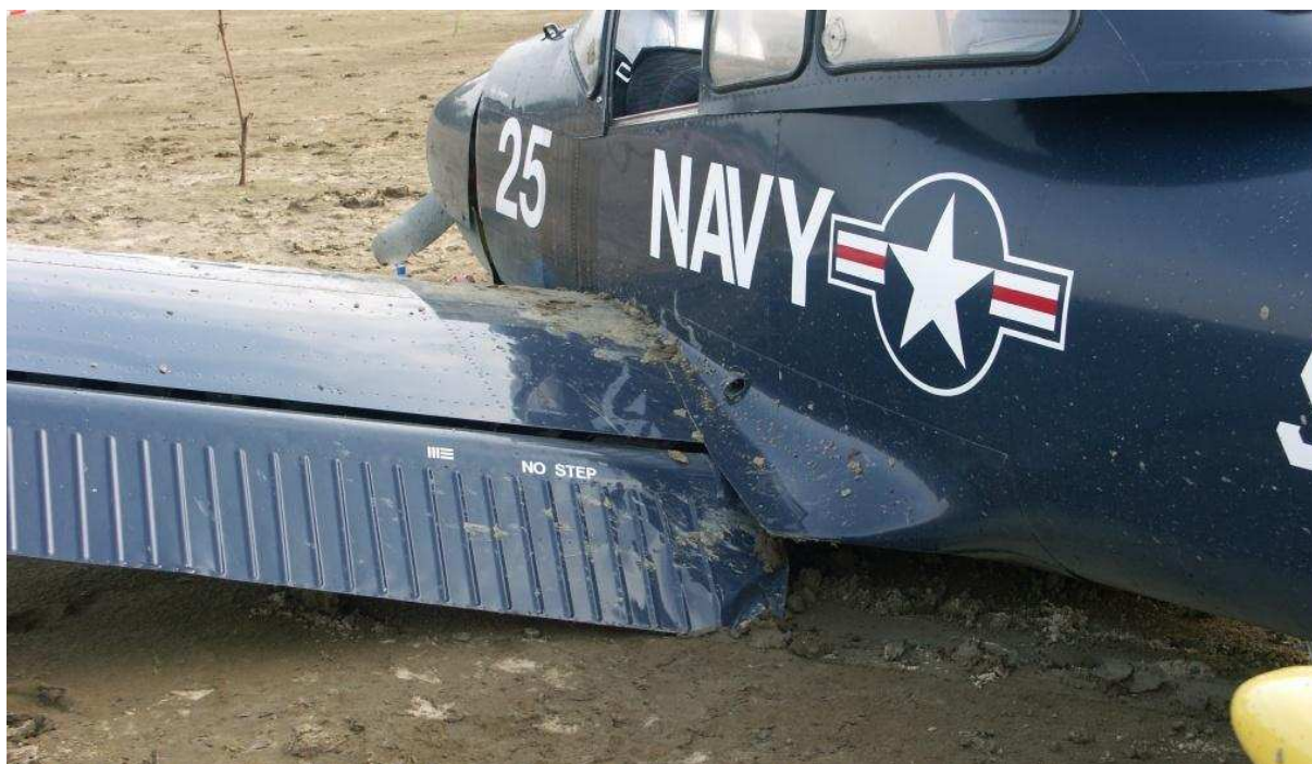
16 – Lewa strona środkowej części kadłuba. Widoczne uszkodzenia naroża kłapy lewego skrzydła u nasady.
