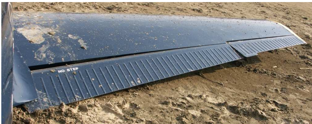
11 – Prawe skrzydło samolotu. Zwraca uwagę nierównomierność szczeliny klapy, sygnalizująca uszkodzenie konsol jej zawieszenia na skrzydle.
