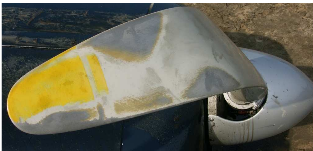
23 – Zbliżenie końcówki zniszczonej łopaty śmigła. W wykroju kółpaka śmigła widoczne szczegóły konstrukcji piasty.
