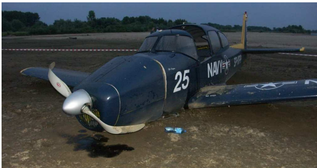
14 – Samolot \frac{3}{4} od przodu z lewej strony. Dobrze widoczne zniszczone śmigło i plama po wycieku oleju na ziemi.
