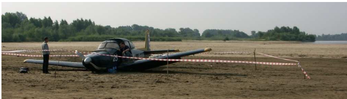
9 – Ślad ostatniego odcinka awaryjnego lądowania ze skośnym przemieszczaniem się samolotu. Granica odcieni kolorów piasku wyraźnie oznacza lekki uskok nawierzchni, który spowodował skośne przemieszczanie się samolotu w ostatniej fazie.
