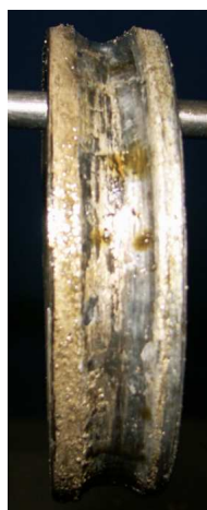
43 – Zniszczona bieżnia wewnętrznego pierścienia łożyska (A-38).
