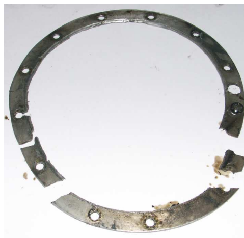
44 – Resztki zniszczonej płytki osłony łożyska (B-12 COVER PLATE).
