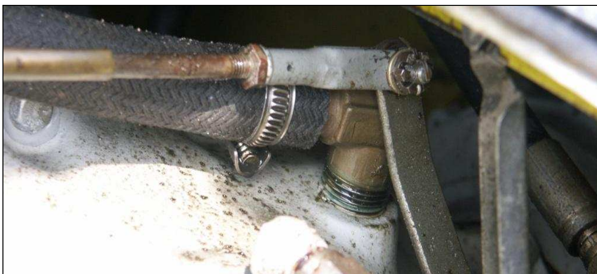
28 – Popychacz elastyczny i dźwignia sterowania skokiem łopaty śmigła na zespole napędowym.
