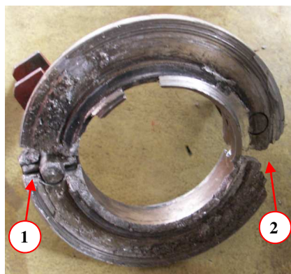
38 – Obrótowa tarcza sterująca (B-87): 1 - pierwsze pęknięcie tarczy; 2 - drugie pęknięcie tarczy.
