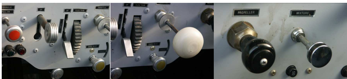
30, 31, 32 – Manetki, pokrętła i dźwignie sterowania płotowcem oraz zespołem napędowym na pulpicie poziomym pod tablicą przyrządów.
