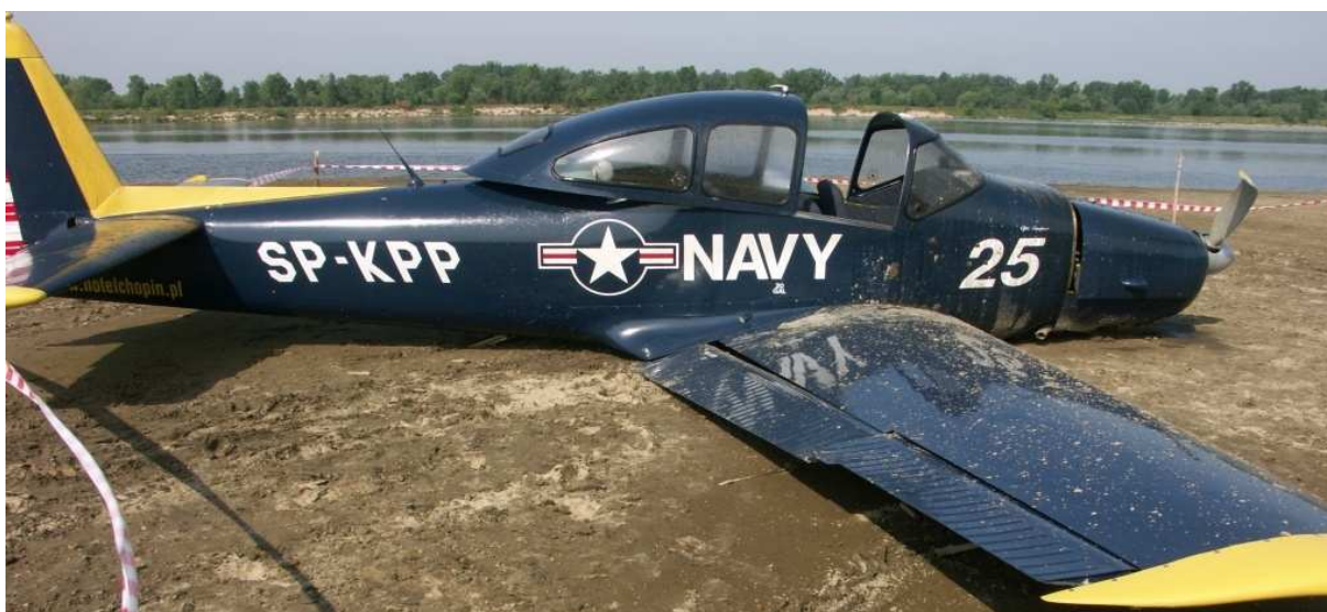
10 – Samolot po zatrzymaniu się, prawa strona. Zwraca uwagę nierównomierność szczeliny klapy, sygnalizująca uszkodzenie konsol jej zawieszenia na skrzydle.
