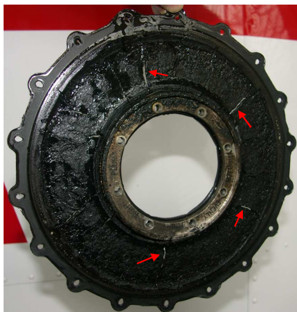
47, 48 – Przepona (B-119 DIAPHRAGM) przymocowana do C-111-7 po zdjęciu z silnika; wyraźnie widać liczne promieniowe pęknięcia.
