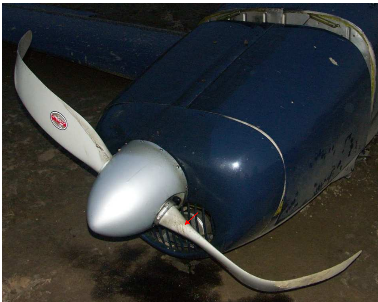
21 – Zniszczone śmigło z wyraźnymi zaciekami (strugami) oleju w okolicy piasty. Osłony zespołu napędowego zamknięte.
