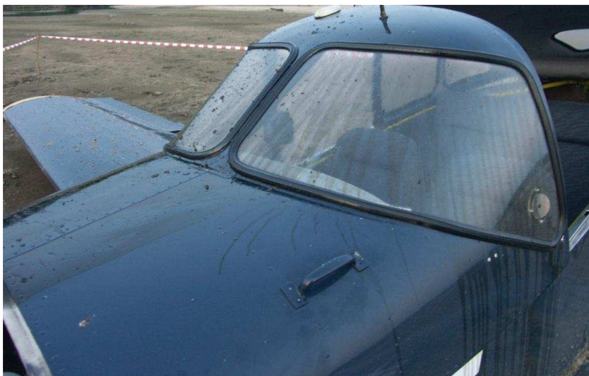
15 – Wiatrochron i przednia część kadłuba \frac{3}{4} od przodu z lewej strony. Zwraca uwagę wyraźne „odcięcie” plamy oleju na kadłubie przed wiatrochronem, spowodowane asymetrią opływu podczas podejścia i lądowania z bocznym ślizgiem.
