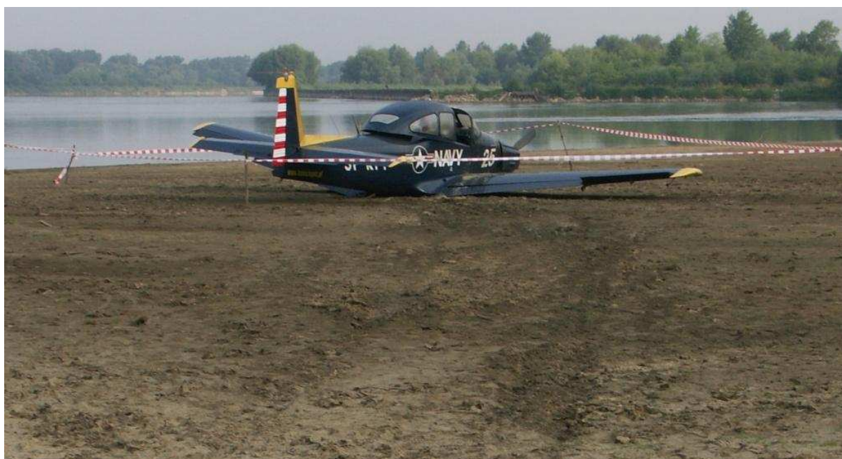
8 – Ślad ostatniego odcinka awaryjnego lądowania ze skośnym przemieszczaniem się samolotu.
