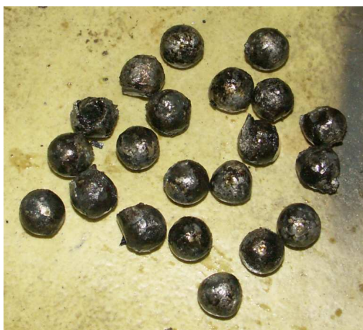
42 – Zniszczone kulki łożyska (A-38 BEARING).
