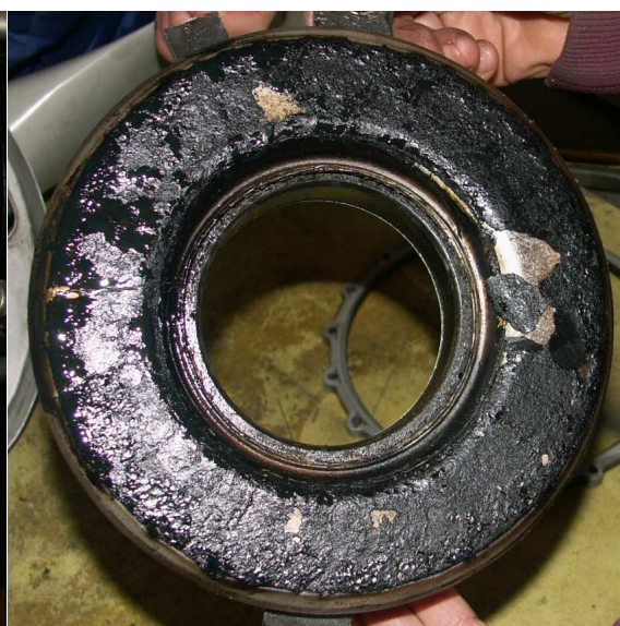
46 – Warstwa przepony (B-119 DIAPHRAGM) przywulkanizowana do tłoka (C-112 PISTON).
