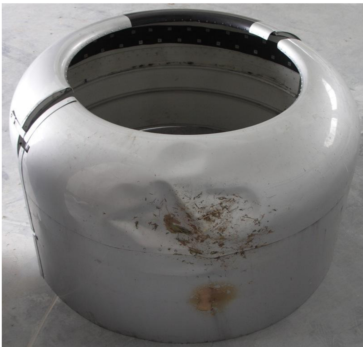
45 – Osłony silnika. Widoczne uszkodzenie dolnej osłony wskutek kontaktu z nawierzchnią lotniska.
