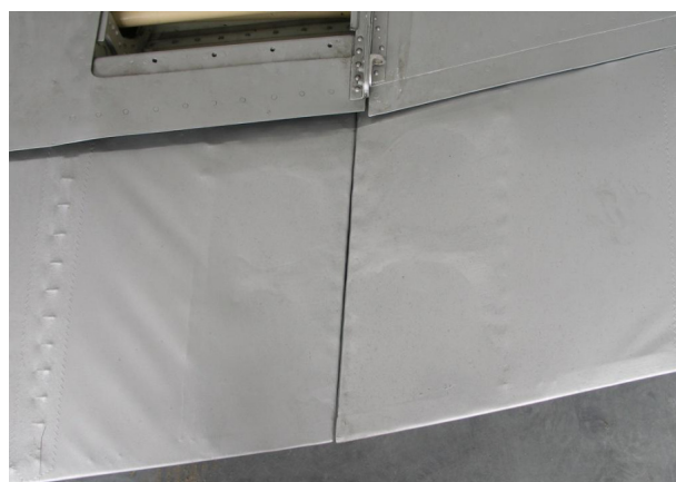
35 i 36 – Szczeliny między klapą zewnętrzną a wewnętrzną na lewym i prawym skrzydle. Widoczna asymetria szczelin spowodowana przemieszczeniem kłapy na prawym skrzydle w kierunku kadłuba wskutek zgięcia wsporników jej zawieszenia oraz skutki uszkodzenia końcówki prawej kłapy wewnętrznej (zmarszczenie pokrycia).
