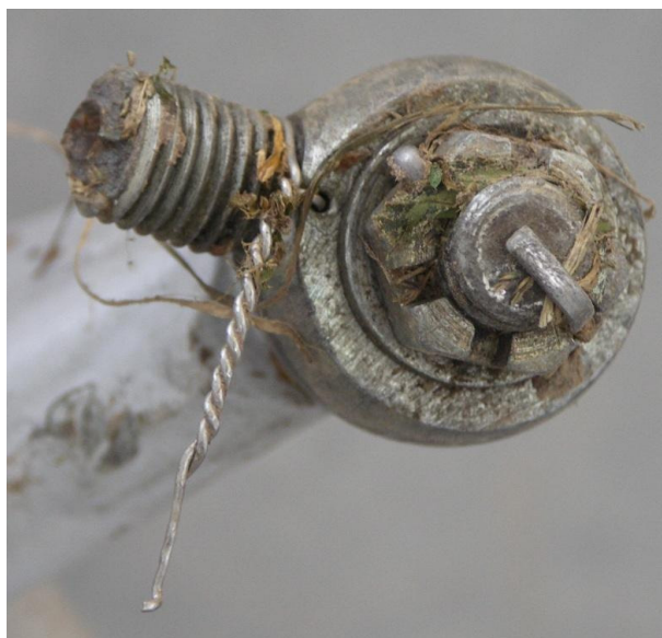
55 i 56 – Odłamana końcówka trzpienia siłownika pneumatycznego, pozostała na dźwigni goleni podwozia przedniego. Wyraźnie widoczny doraźny charakter zniszczenia.
