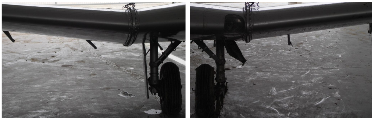
23 i 24 – Widok od przodu na skrzydła. Widoczne podwozie główne oraz uszkodzenia (zgięcie) wsporników klap na prawym skrzydle.
