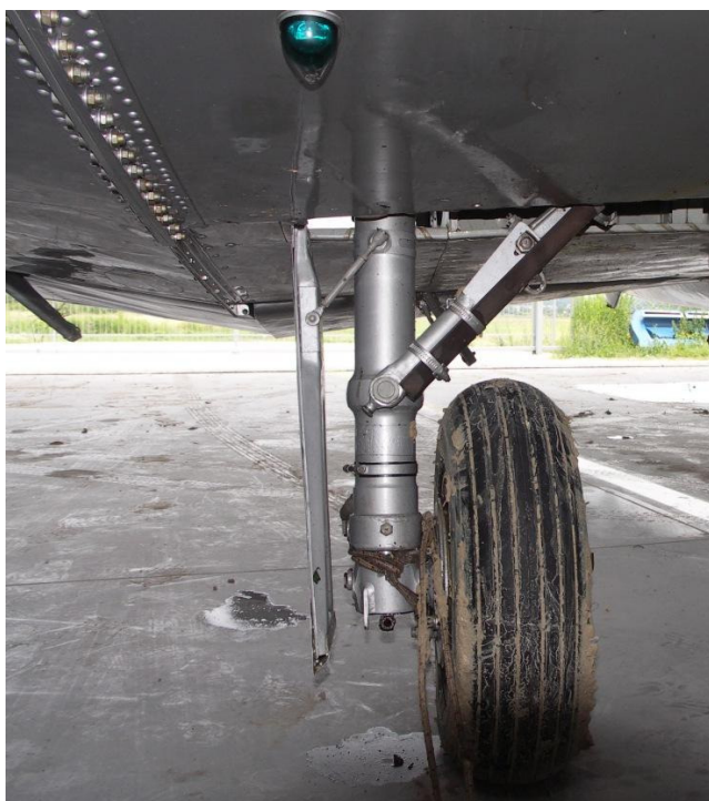
21 i 22 – Widok od przodu na prawe [z lewej] i lewe [z prawej] podwozie główne. Widoczne unieruchomione tubkami zastrzały i uszkodzenie pokrywy gołeni lewego podwozia głównego.
