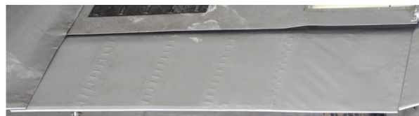
37 i 38 – Widoczna wyraźnie asymetria szczelin kłap wewnętrznych na lewym i prawym skrzydle spowodowana przemieszczeniem kłapy na prawym skrzydle w kierunku kadłuba wskutek zgięcia wsporników jej zawieszenia.
