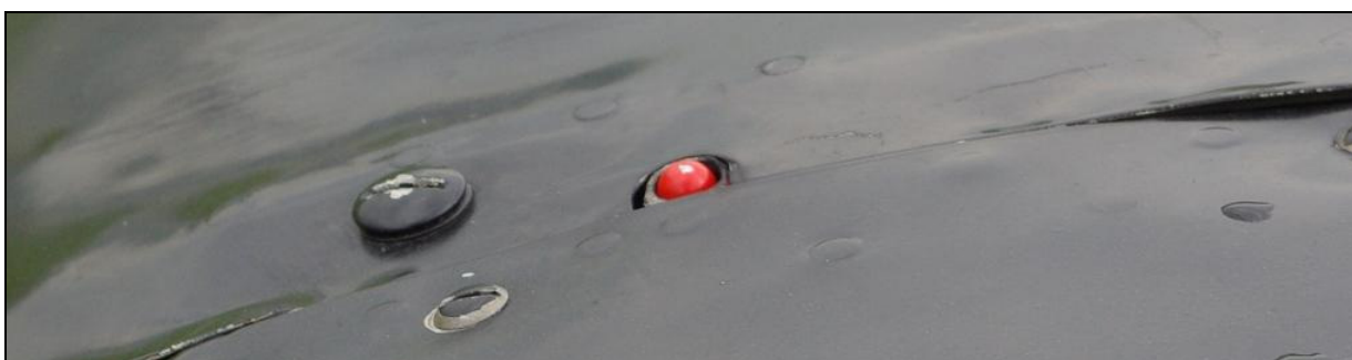
11 – Widok mechanicznego sygnalizatora położenia przedniego podwozia z kabiny samolotu po awaryjnym lądowaniu – wskazuje położenia przedniego podwozia „SCHOWANE” (brak wyłamanej nogi, a zatem brak elementu uruchamiającego sygnalizację mechaniczną).
