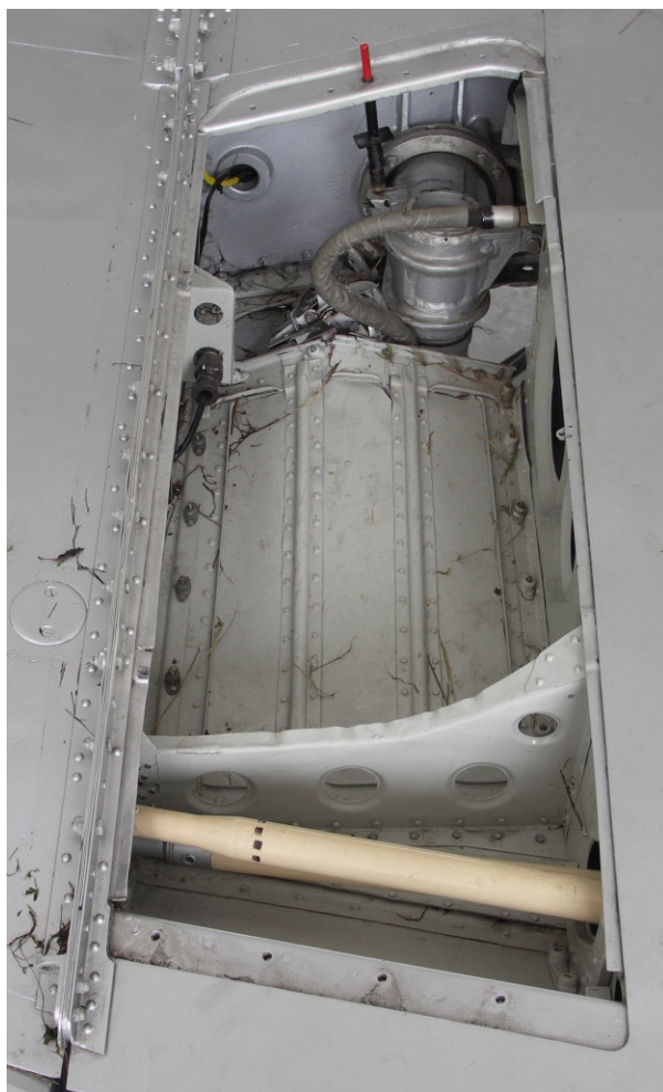
30 i 31 – Widoki wnętrza lewego i prawego luku górnego podwozia głównego. Widoczne uszkodzenia zamocowania goleni w lewym luku.
