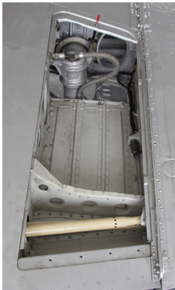
30 i 31 – Widoki wnętrza lewego i prawego luku górnego podwozia głównego. Widoczne uszkodzenia zamocowania goleni w lewym luku.
