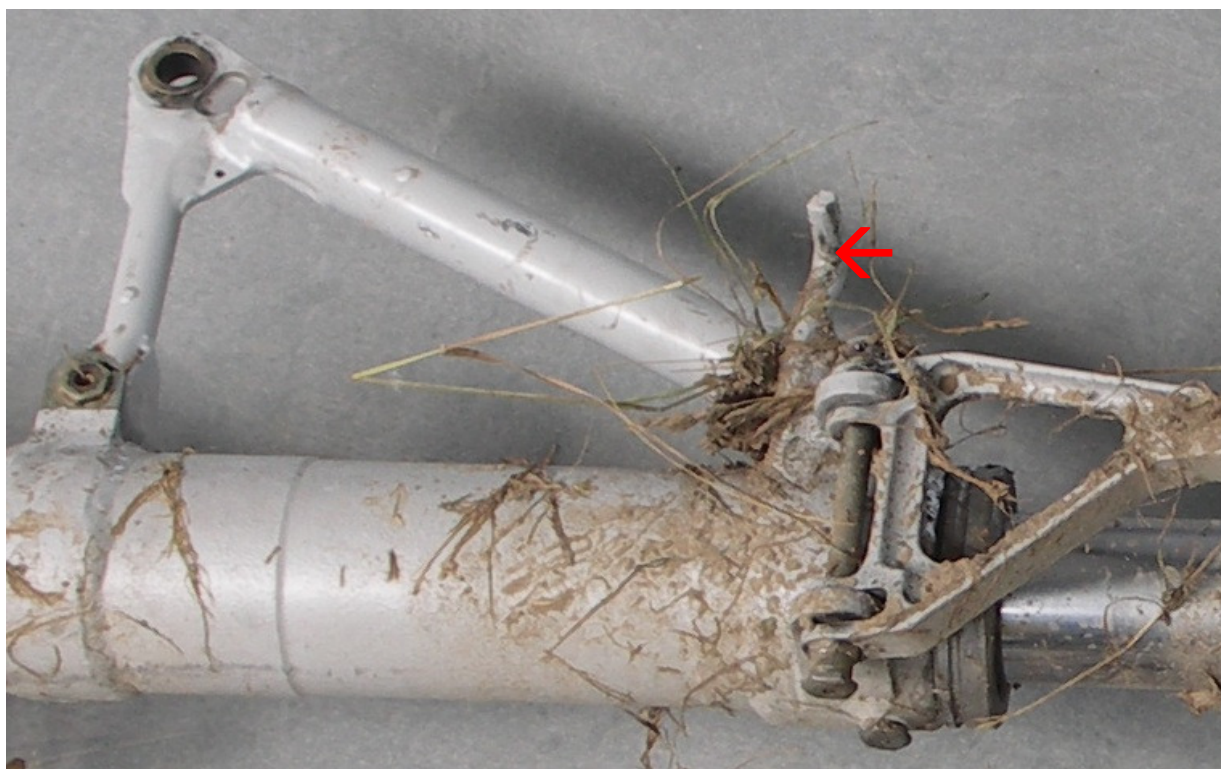
57 – Fragment goleni podwozia przedniego. Strzałką wskazany hak do zamka położenia schowanego podwozia.
