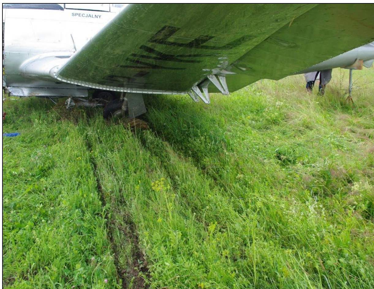
4 – Samolot po zatrzymaniu z obrotem o ok. 90°. Widoczne uszkodzone podwozie i ślady przez nie pozostawione.
