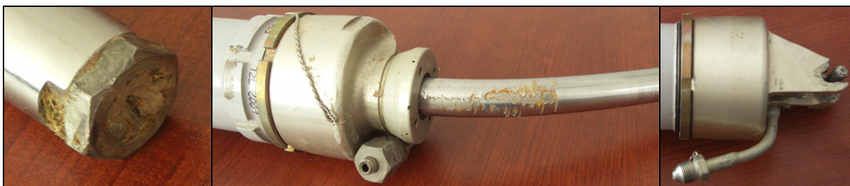
69, 70 i 71 – Od lewej: miejsce po odłamanej końcówce na trzonie siłownika (p.zdjęcia 55 i 56), dolna część korpusu siłownika z oderwaną końcówką przewodu zasilającego (w kierunku chowania) oraz górną część korpusu ze zniszczonymi uchami mocującymi siłownik do płatuwca i złączem zasilania z instalacji pneumatycznej (w kierunku wypuszczania).
