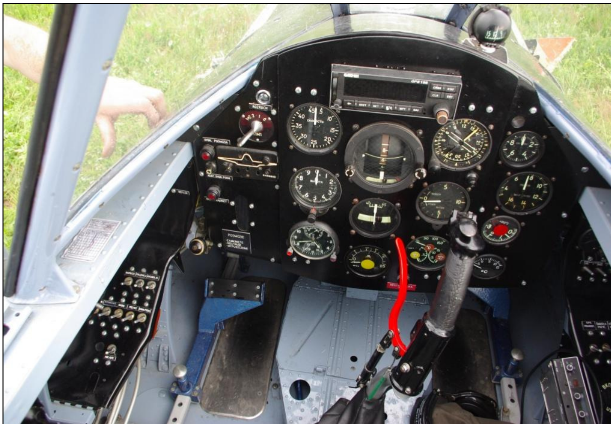
12 – Wnętrze przedniej kabiny – tablica przyrządów.
