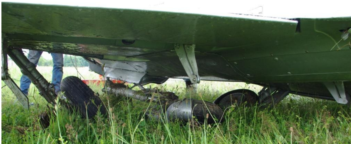
15 – Podwozie samolotu złożone i uszkodzone przy lądowaniu. Zdjęcie wykonane podczas podnoszenia samolotu.
