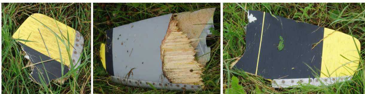
8, 9 i 10 – Odkłamki łopaty zniszczonego śmigła, odnalezione przy trasie dobiegu samolotu.
