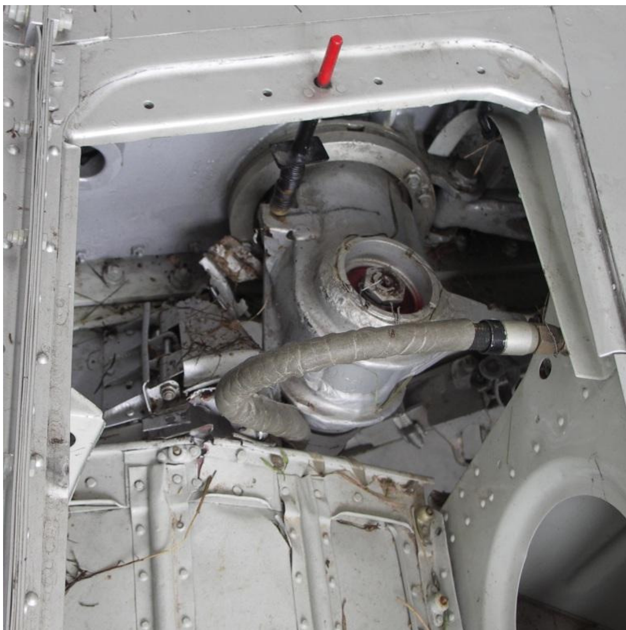
32 – Fragment lewego górnego luku podwozia głównego w zbliżeniu. Widoczne uszkodzenia zamocowania goleni podwozia i pokrywy dolnej.
