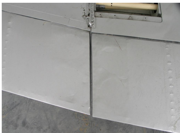
35 i 36 – Szczeliny między klapą zewnętrzną a wewnętrzną na lewym i prawym skrzydle. Widoczna asymetria szczelin spowodowana przemieszczeniem kłapy na prawym skrzydle w kierunku kadłuba wskutek zgięcia wsporników jej zawieszenia oraz skutki uszkodzenia końcówki prawej kłapy wewnętrznej (zmarszczenie pokrycia).
