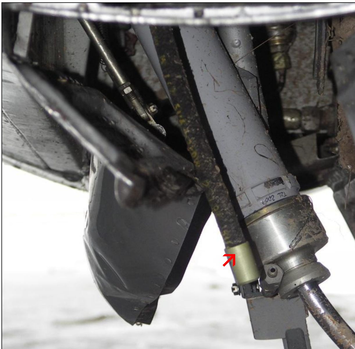
52 – Zbliżenie na uszkodzony siłownik pneumatyczny i elastyczny przewód jego zasilania z instalacji pneumatycznej (wskazany strzałką) w kierunku chowania podwozia, oderwany od złącza na siłowniku, widoczny obok wskazanej strzałką końcówki przewodu.
