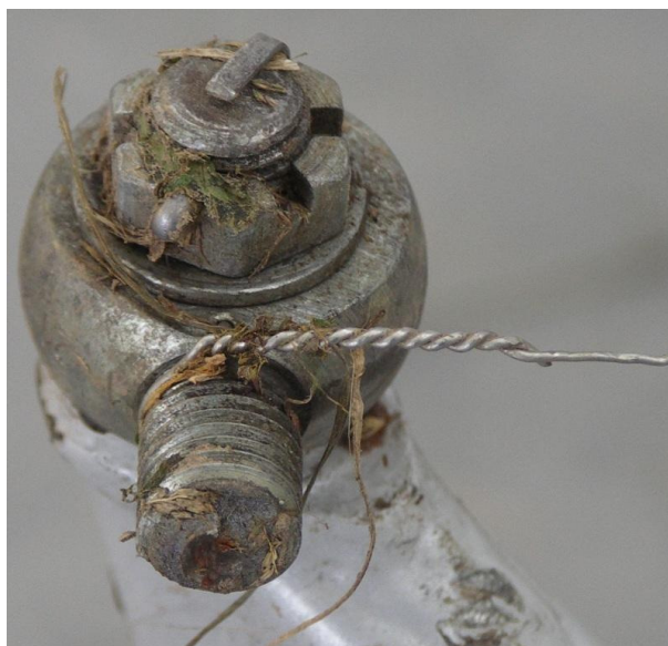
55 i 56 – Odłamana końcówka trzpienia siłownika pneumatycznego, pozostała na dźwigni goleni podwozia przedniego. Wyraźnie widoczny doraźny charakter zniszczenia.
