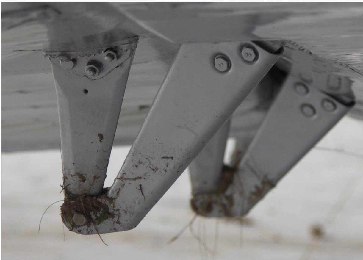
26 – Uszkodzone (zgięte) wsporniki klap na prawym skrzydle - zbliżenie.
