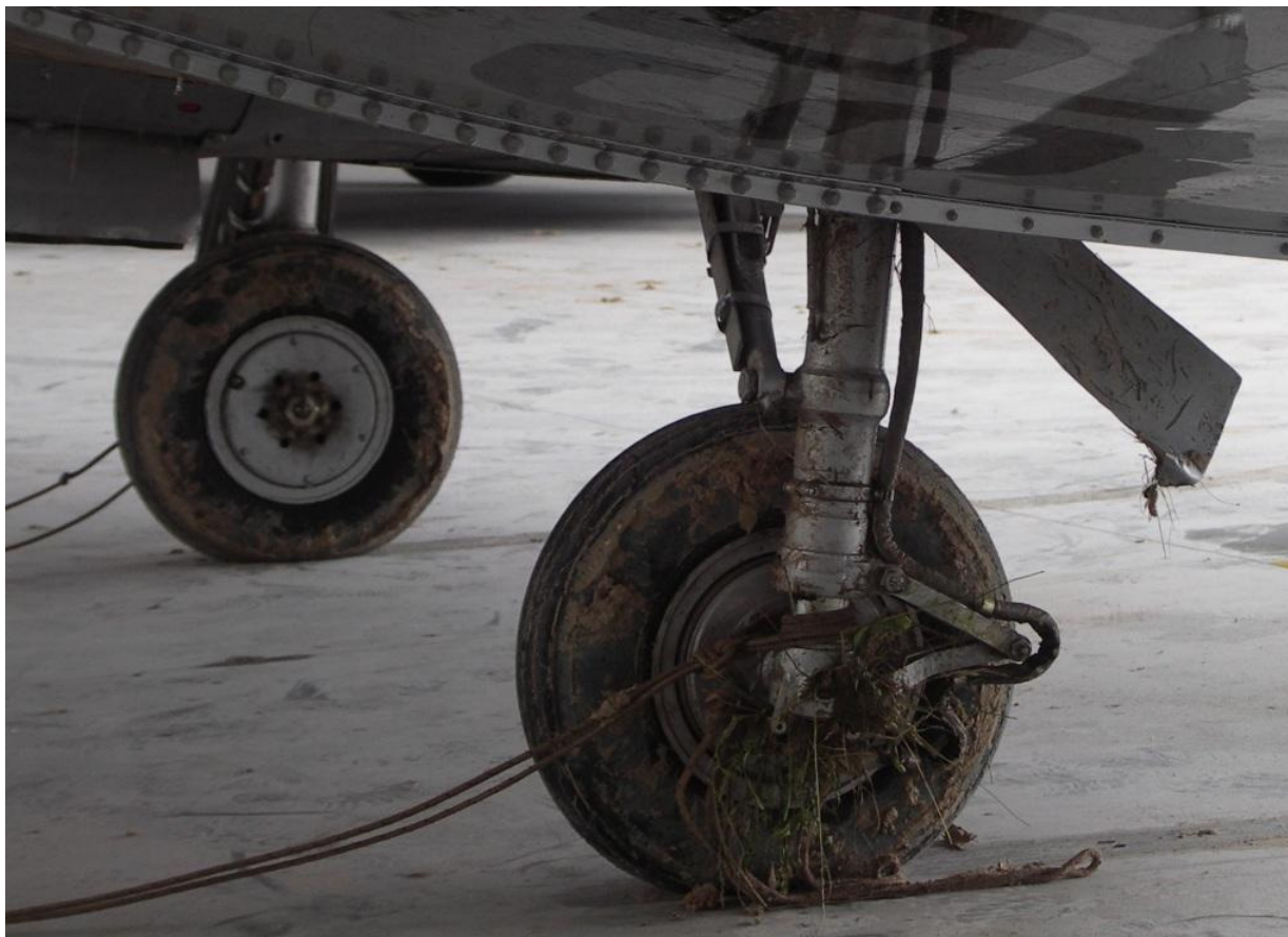
20 – Podwozie główne z lewej strony. Widoczne uszkodzenia zastrzałów i pokrywy lewego podwozia.
