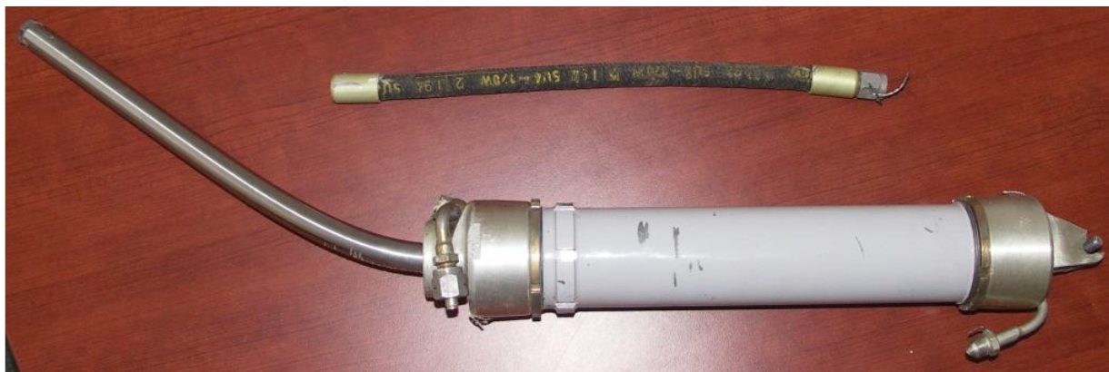
68 – Pneumatyczny siłownik podwozia przedniego i przewód jego zasilania (w kierunku chowania) z instalacji pneumatycznej samolotu.
