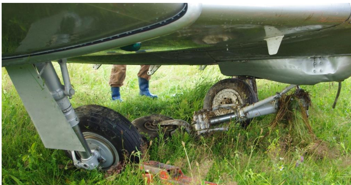
16 – Podwozie samolotu złożone i uszkodzone przy lądowaniu. Zdjęcie wykonane podczas podnoszenia samolotu.
