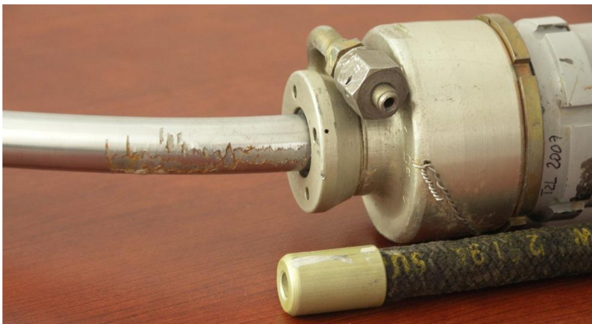
72 – Dolna część korpusu siłownika i dolny koniec przewodu zasilającego z oderwaną końcówką – na niej widoczny ślad uderzenia.
