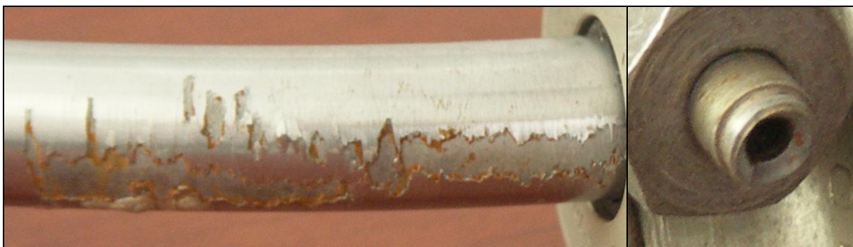
73 i 74 – Uszkodzenia powierzchni trzonu siłownika i zerwana dolna końcówka przewodu zasilania z instalacji pneumatycznej - zbliżenie.
