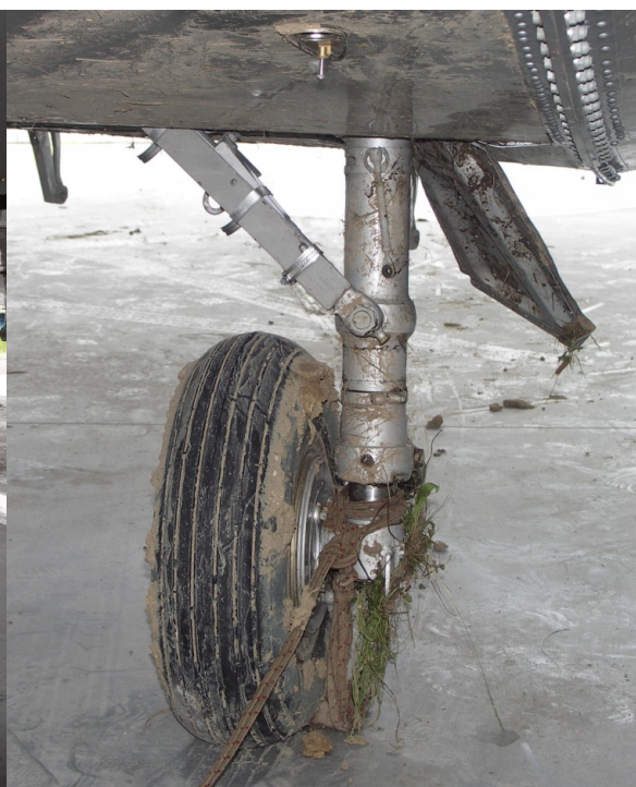
21 i 22 – Widok od przodu na prawe [z lewej] i lewe [z prawej] podwozie główne. Widoczne unieruchomione tubkami zastrzały i uszkodzenie pokrywy gołeni lewego podwozia głównego.
