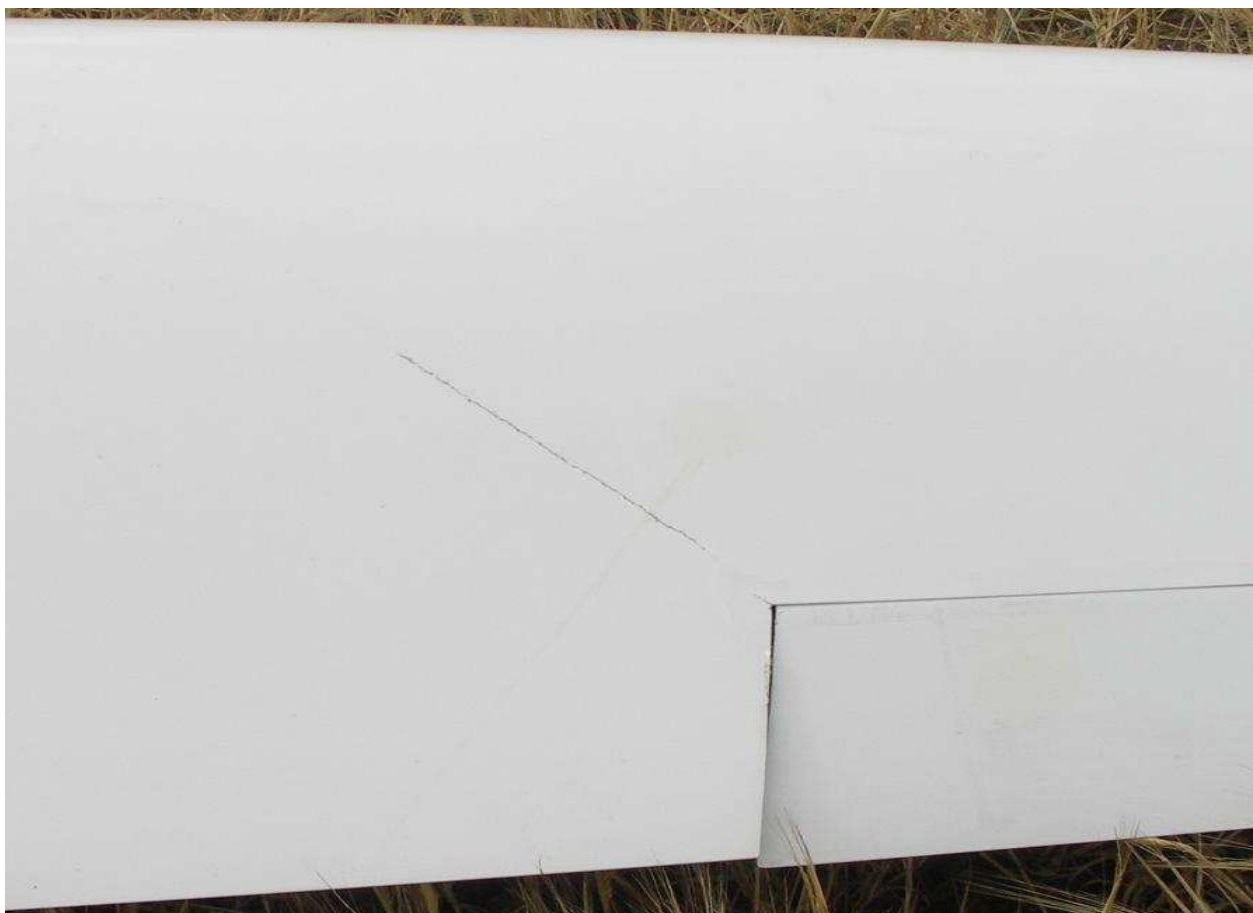
37 – Pęknięcie górnego pokrycia skrzydła, biegnące od wewnętrznego naroża wykroju lotki.
