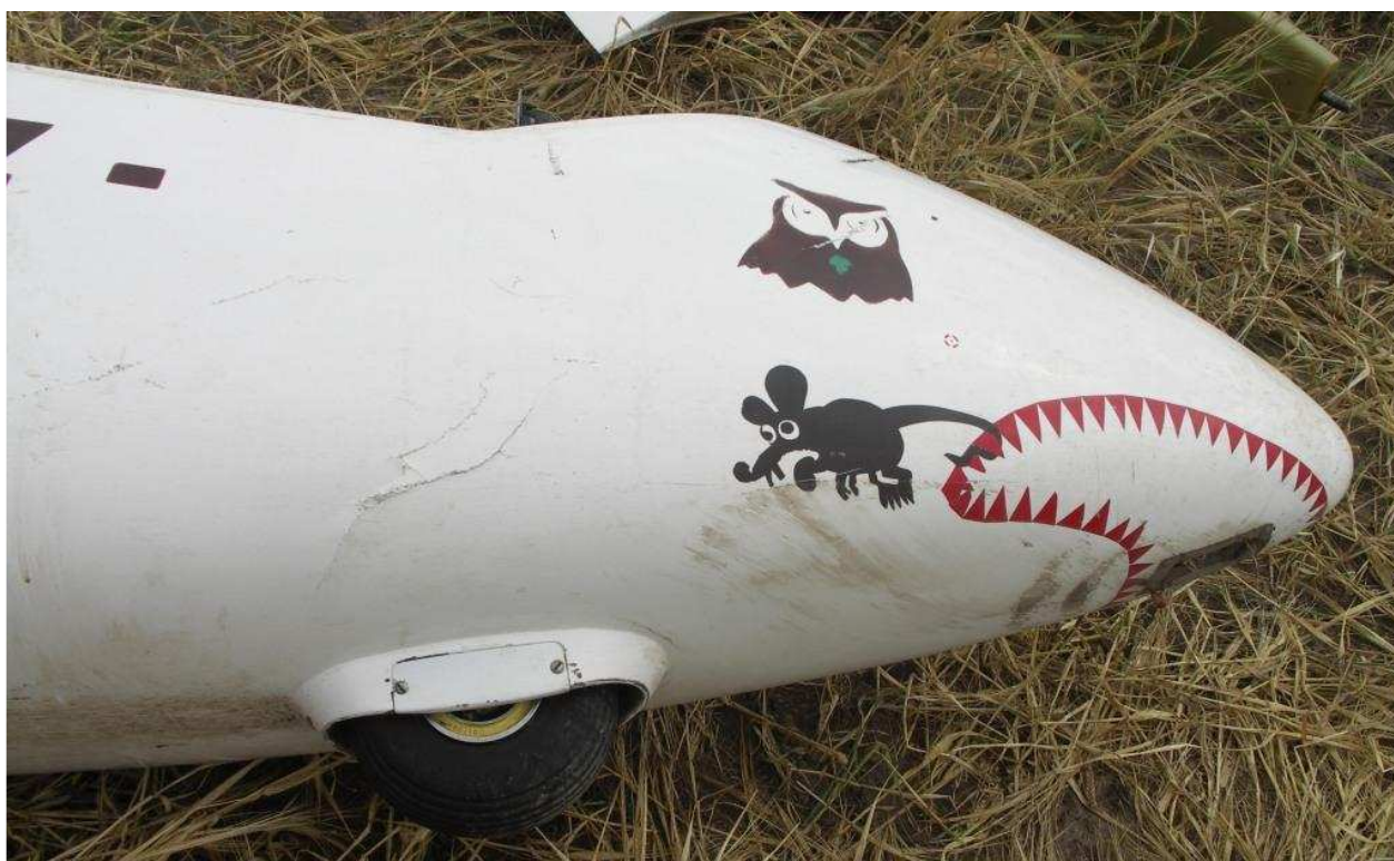
19 – Zbliżenie na uszkodzenia noska kadłuba z prawej strony i od spodu.
