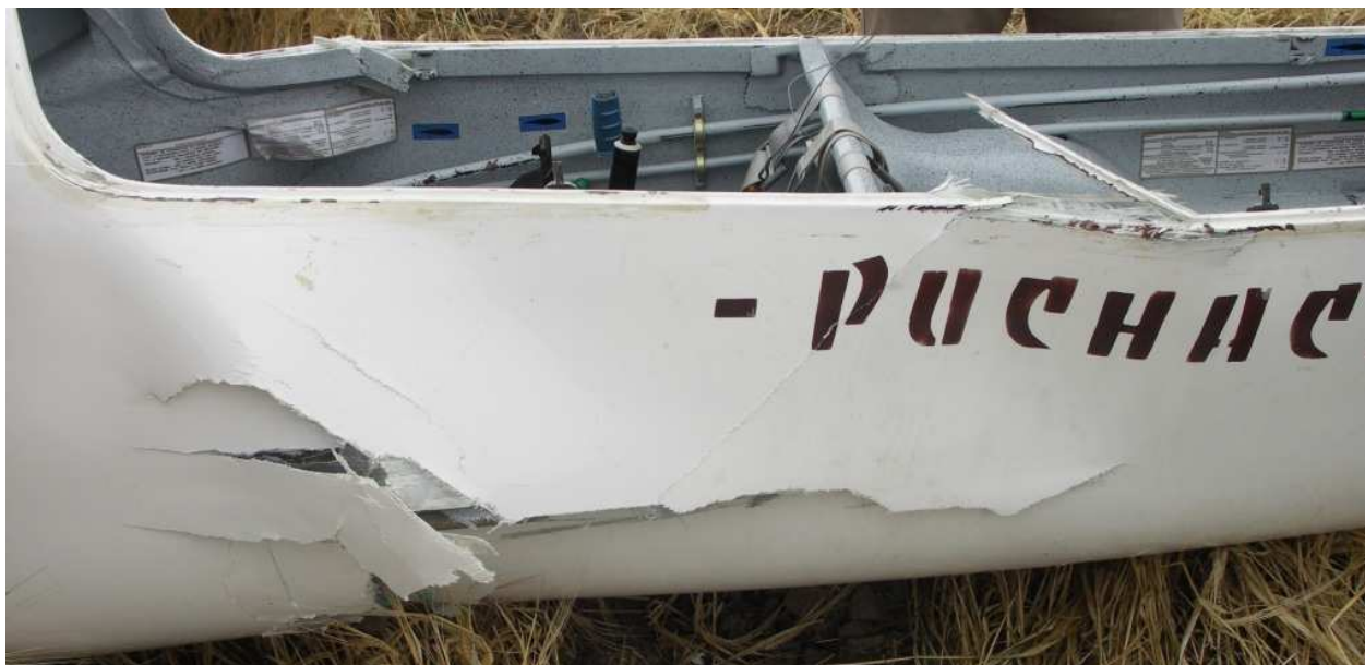
15 – Złamanie przedniej części kadłuba i zniszczenia pokryć z prawej strony.
