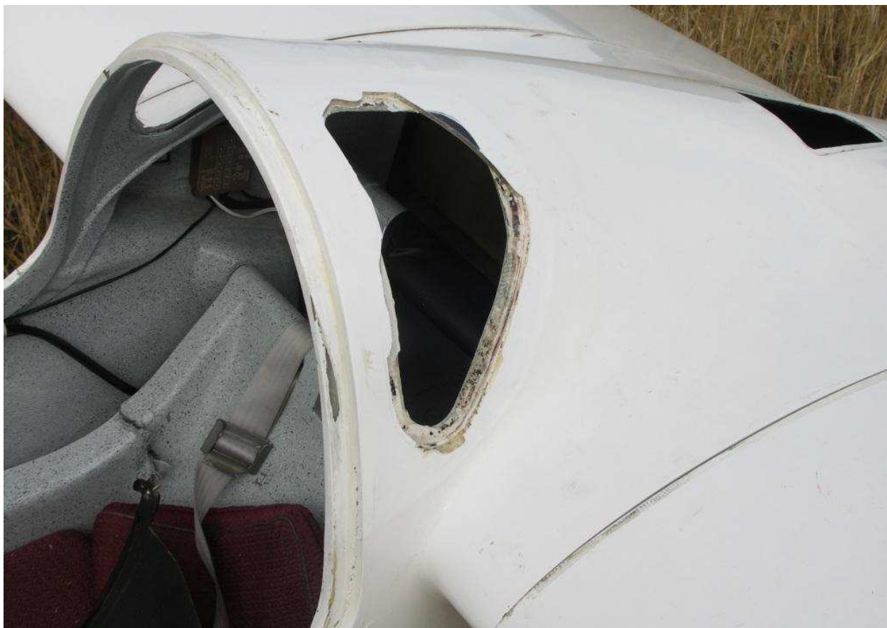
31 – Tylna wręga kabiny – widoczny brak oszklenia okienka po lewej stronie.
