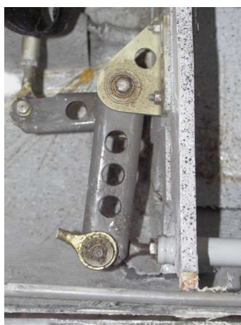
41, 42, 43 – Dźwignia pośrednia sterowania lotkami z odłamaną końcówką popychacza oraz dwa widoki odłamanego końca popychacza ze zniszczoną końcówką.
