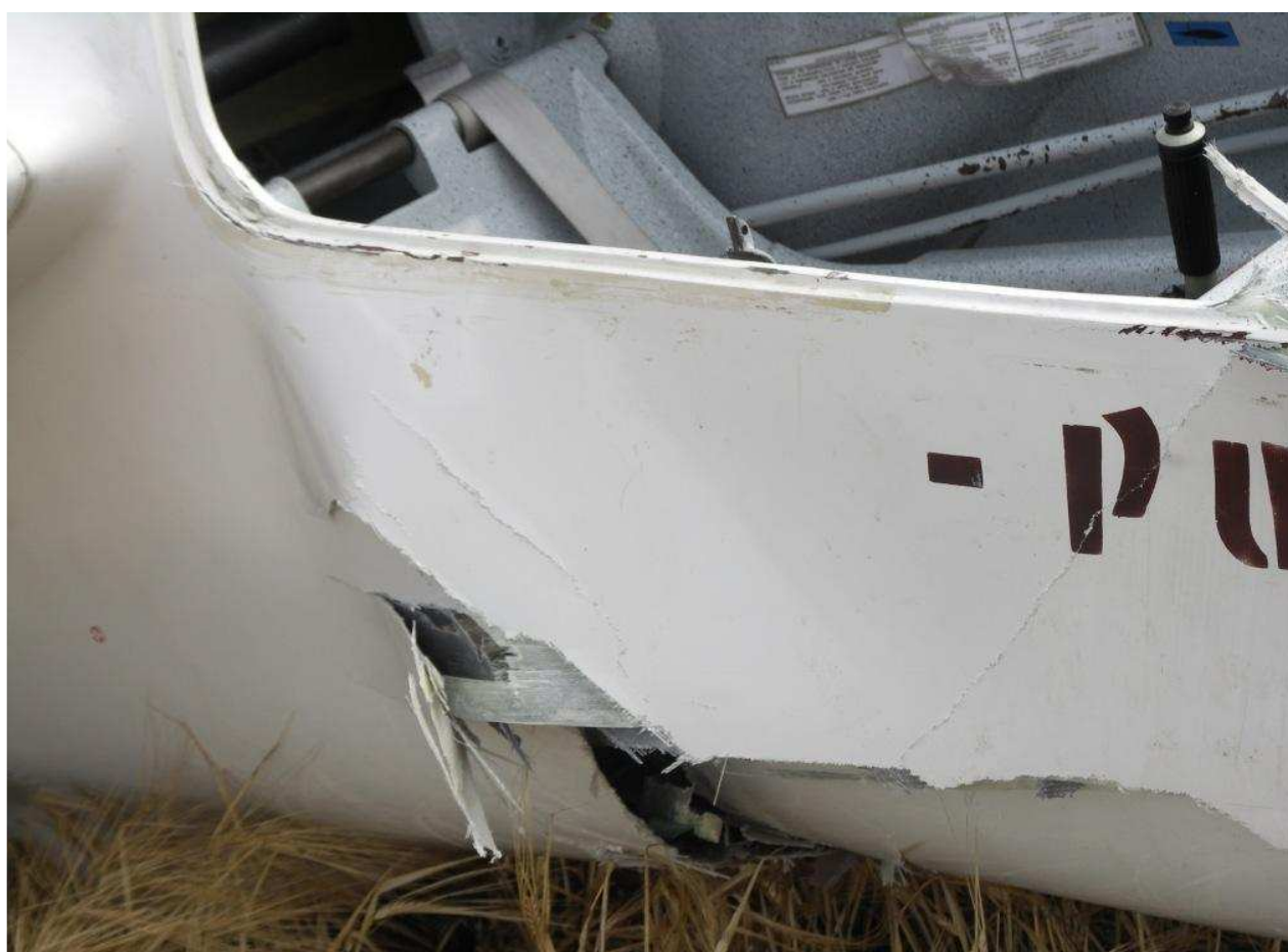
12 – Uszkodzenia przedniej części kadłuba – prawa strona przy tylnym fotelu.
