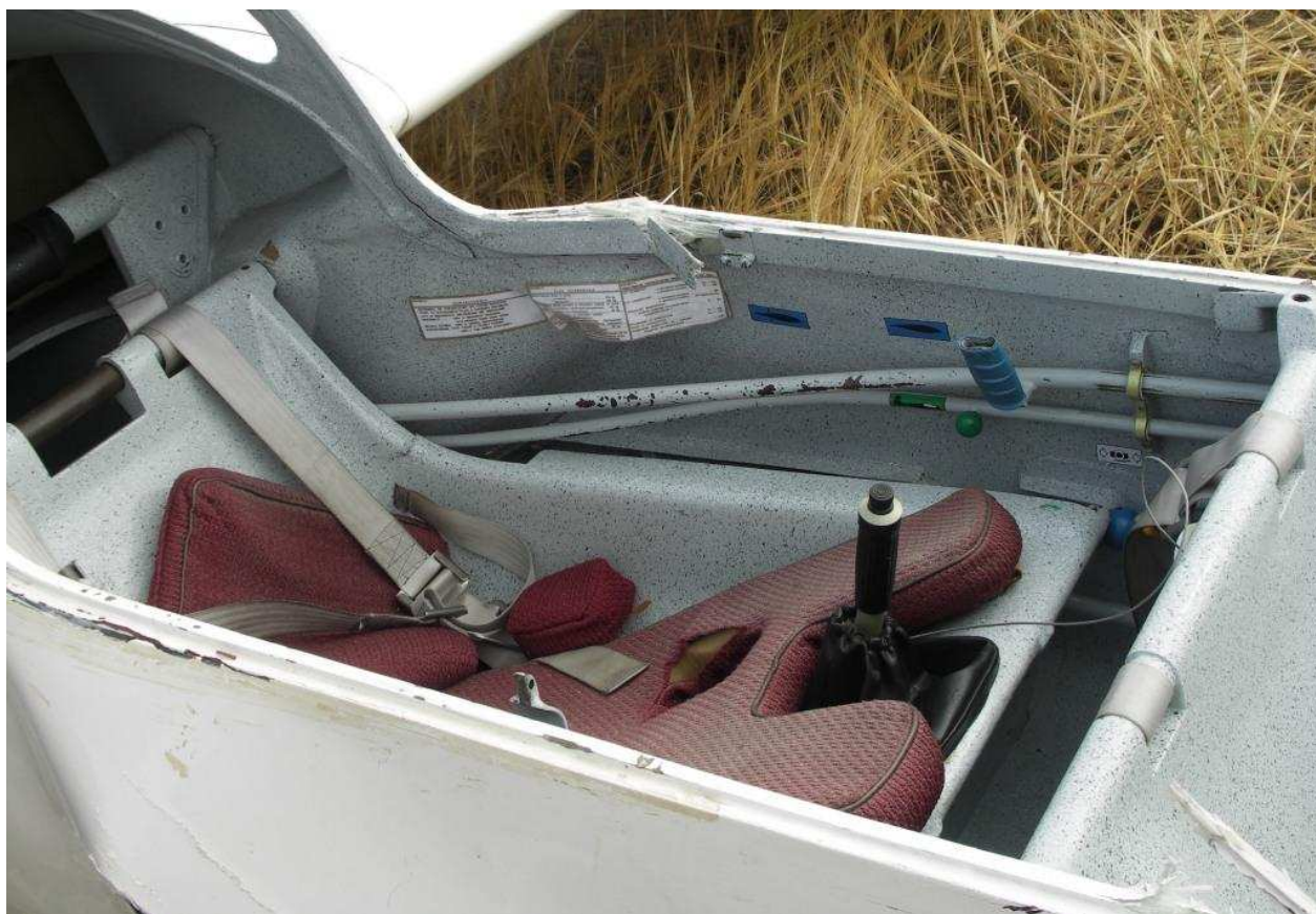
25 – Kabina instruktora z prawej strony. Widoczne uszkodzenia struktury kadłuba i oparcia fotela.
