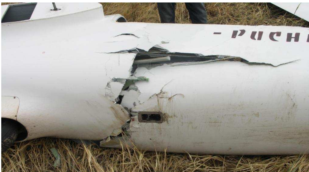
17 – Zbliżenie na złamanie kadłuba z prawej strony i od spodu – widoczny złamany popychacz sterowania sterem kierunku.
