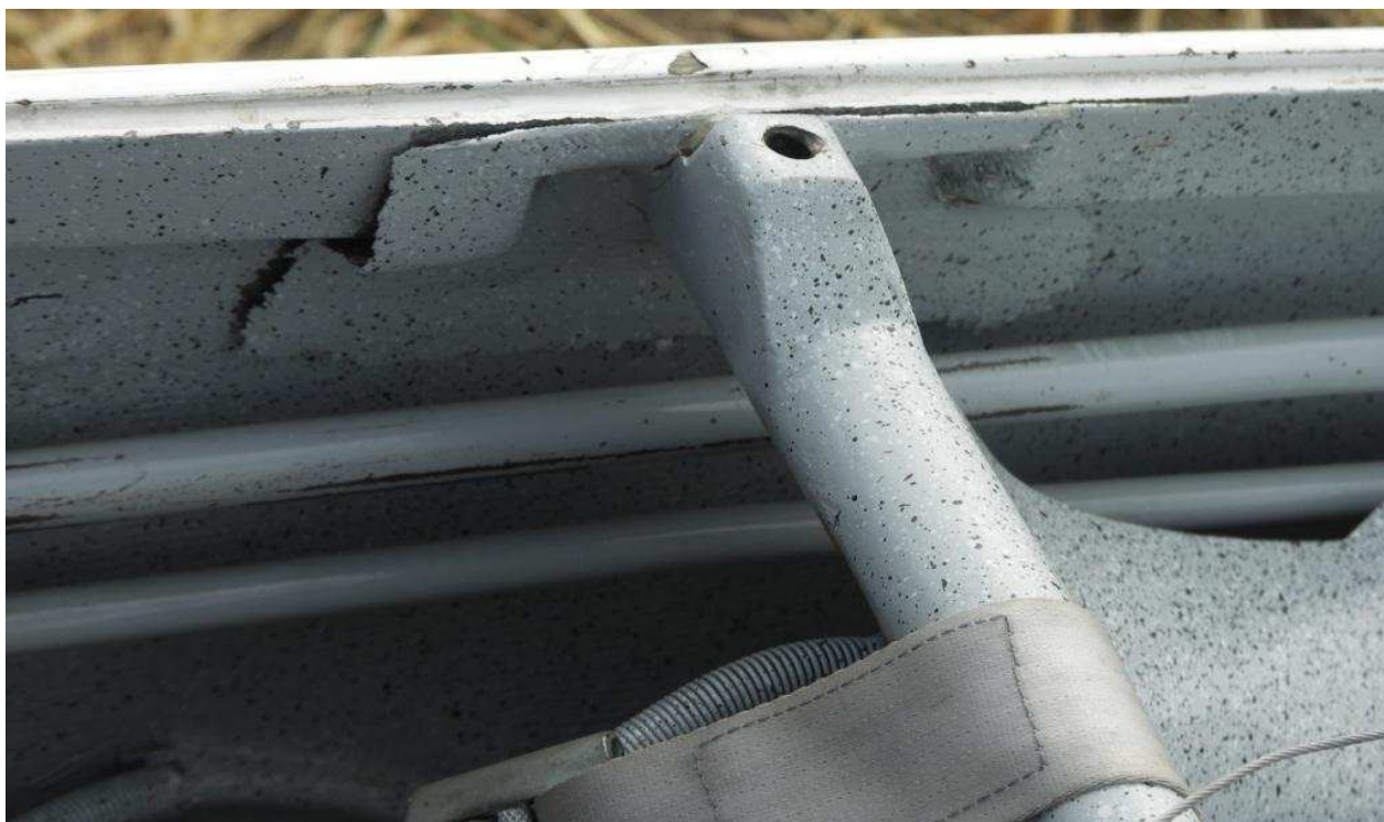
27 – Uszkodzenie wklejenia w lewą burtę poprzeczki podpierającej oparcie przedniego fotela i tablicę przyrządów instruktora (która wypadła z szybowca).
