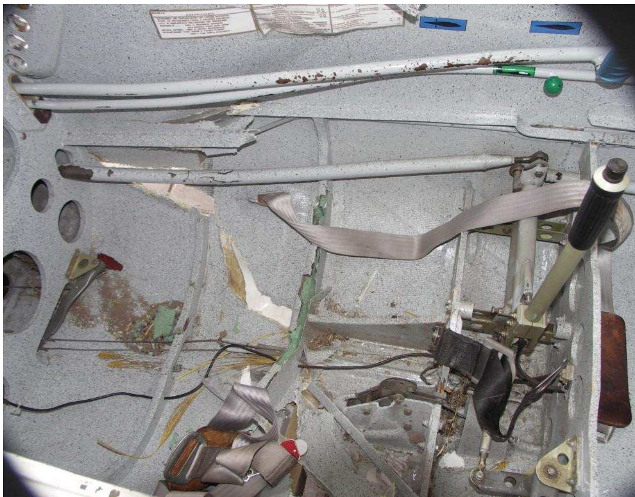
40 – Wnętrze kadłuba po usunięciu siedziska instruktora – widok z lewej strony. Widoczne pęknięcia pokrycia i rozklejenia.
