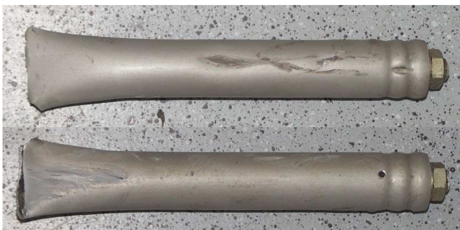
41, 42, 43 – Dźwignia pośrednia sterowania lotkami z odłamaną końcówką popychacza oraz dwa widoki odłamanego końca popychacza ze zniszczoną końcówką.
