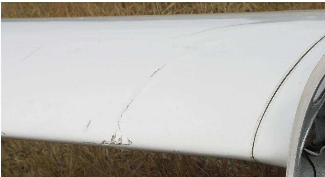
32 – Uszkodzenie (rozklejenie noska i pęknięcie pokrycia) u nasady prawego skrzydła.
