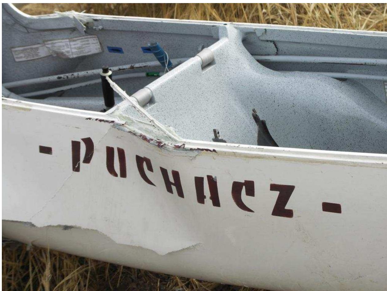
13 – Uszkodzenia przedniej części kadłuba – prawa strona przy przednim fotelu.
