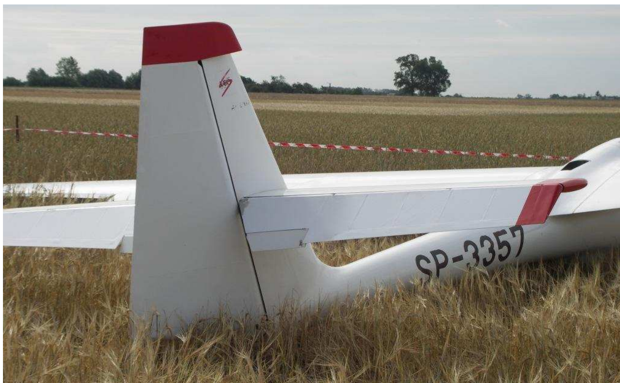
47 – Usterzenie, prawa strona. Widoczne wychylenie trymerów steru wysokości „ciężki na ogon”.
