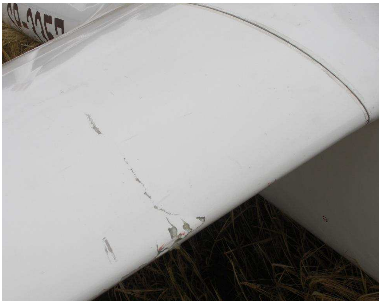
33 – Uszkodzenie (rozklejenie noska i pęknięcie pokrycia) u nasady prawego skrzydła.
