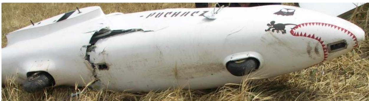
16 – Złamanie przedniej części kadłuba i zniszczenia pokryć z prawej strony i od spodu.
