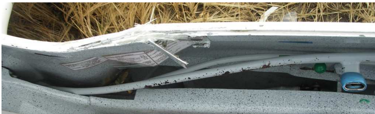
26 – Złamanie wzdłużnika lewej burty przy fotelu instruktora – zbliżenie.
