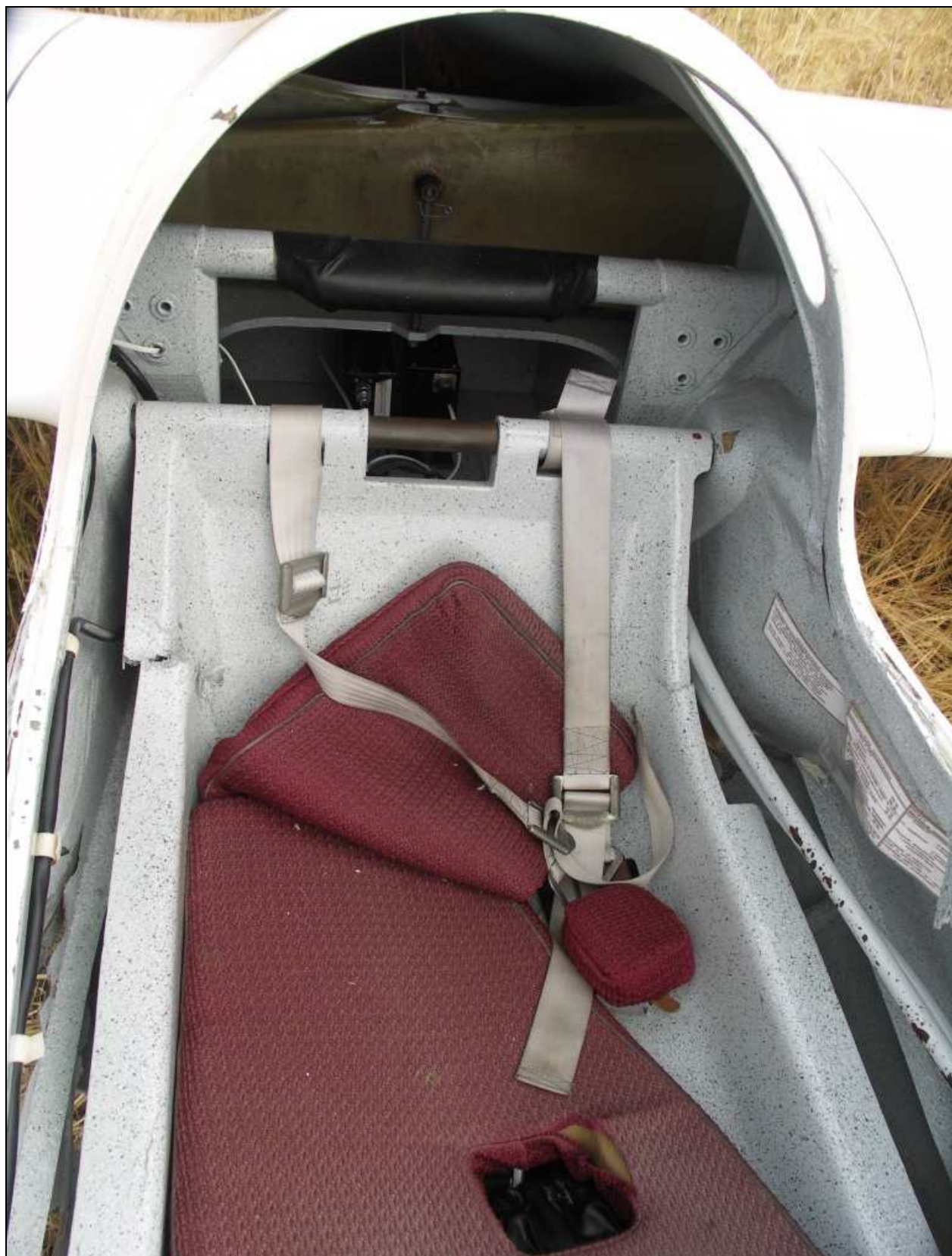
23 – Widok na oparcie fotela instruktora. Widoczne uszkodzenia struktury kadłuba i oparcia fotela, w głębi połączenie dźwigarów skrzydła i radiostacja.
