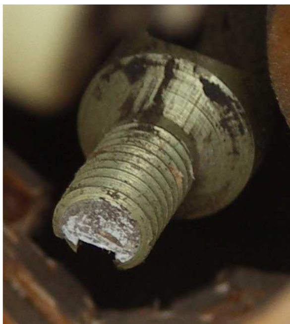
57 – Zerwana końcówka widelkowa popychacza kadłubowego, pozostała przy dźwigni pośredniej – widok przełomu. Cechy przełomu świadczą o doraźnym charakterze zniszczenia części.
