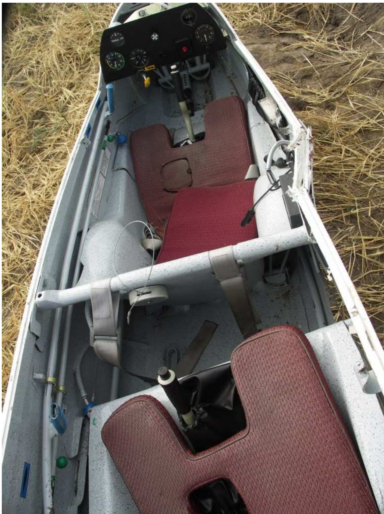
22 – Widok wnętrza kabiny od tyłu. Zwraca uwagę złamanie prawego wzdłużnika burty kadłuba oraz brak tylnej tablicy przyrządów, która została wyłamana.
