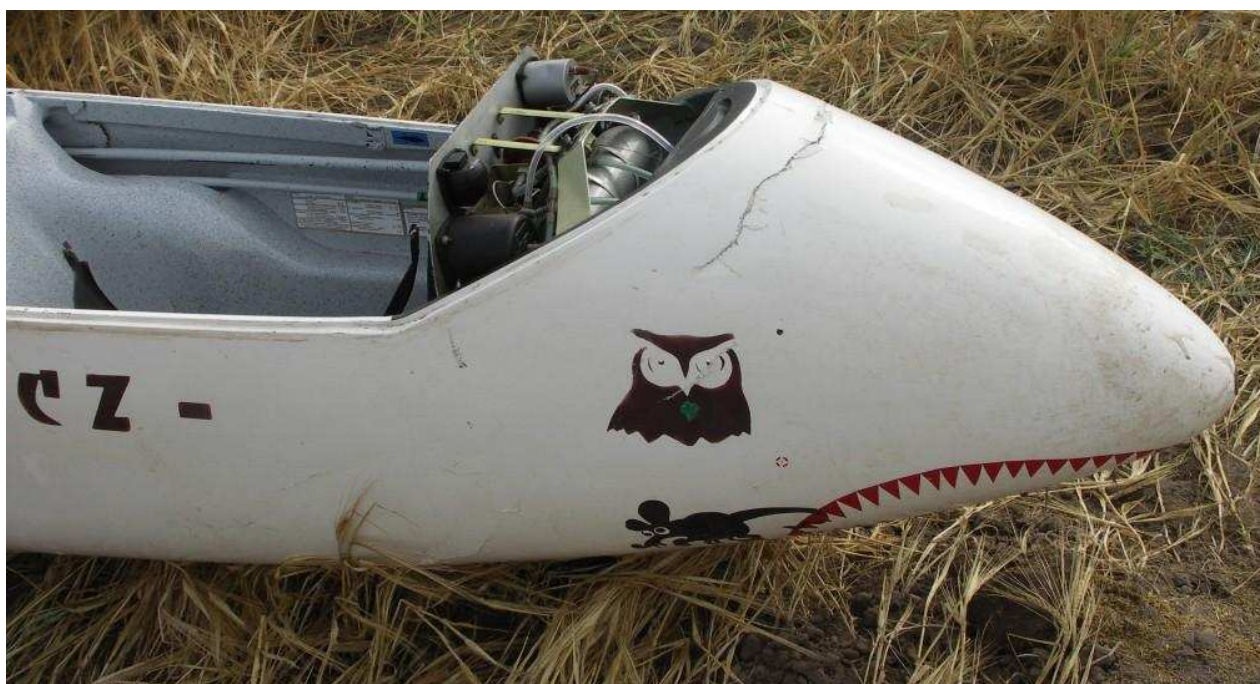
14 – Uszkodzenia przedniej części kadłuba – prawa strona noska kadłuba.
