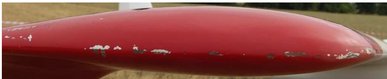
39 – Uszkodzenia końcówki prawego skrzydła.
