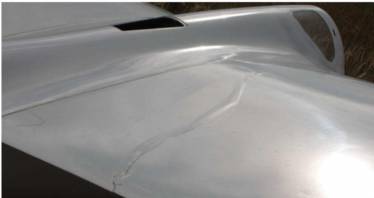
36 – Uszkodzenie u nasady prawego skrzydła – pęknięcie pokrycia przy krawędzi spływu, penetrujące w kierunku rozklejenia noska.
