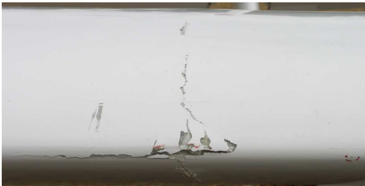
34 – Uszkodzenie (rozklejenie noska i pęknięcie pokrycia) u nasady prawego skrzydła – zbliżenie noska.
