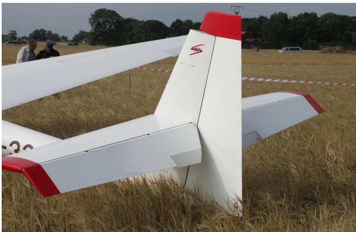
48 – Usterzenie, lewa strona. Widoczne wychylenie trymerów steru wysokości „ciężki na ogon”.
