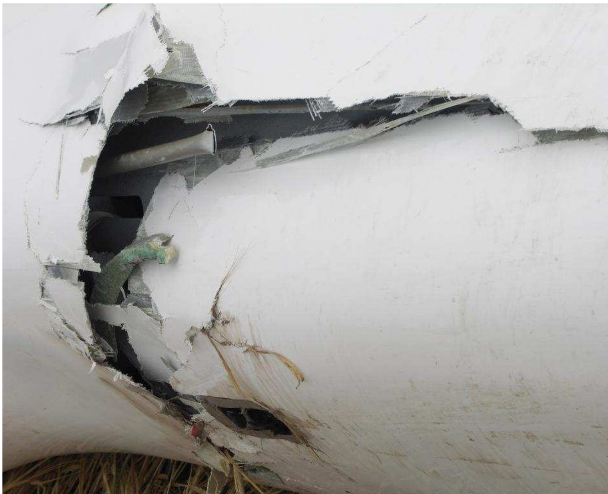
18 – Zbliżenie na złamanie kadłuba z prawej strony i od spodu – widoczny złamany popychacz sterowania sterem kierunku.
