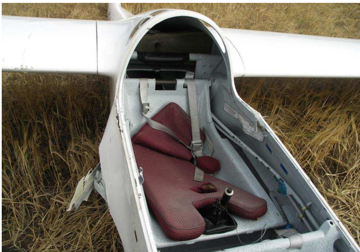
21 – Wnętrze kabiny instruktora widziane od przodu, widoczne uszkodzenia struktury kadłuba.
