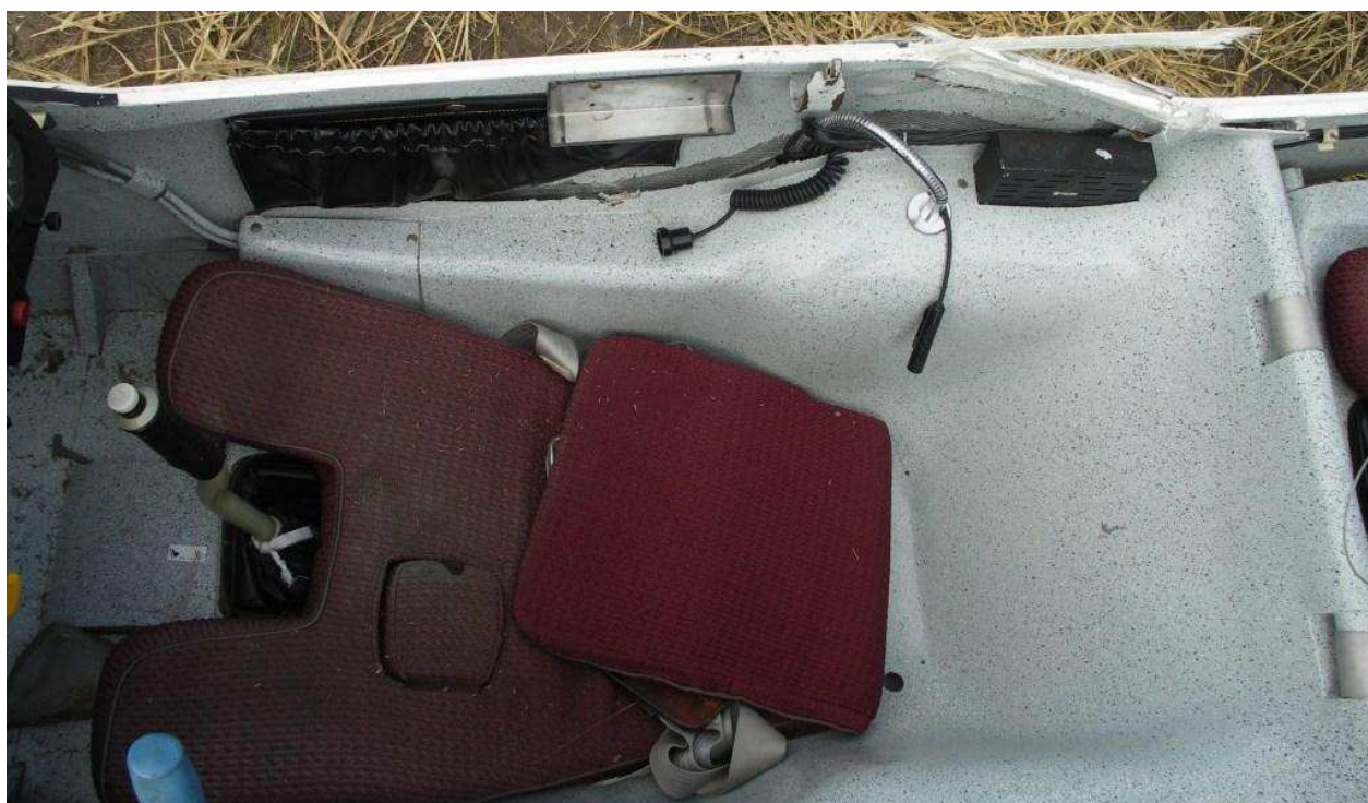
24 – Kabina ucznia z góry. Widoczne złamanie wzduźnika prawej burty kadłuba i odklejenie prawego pulpitu od burty.
