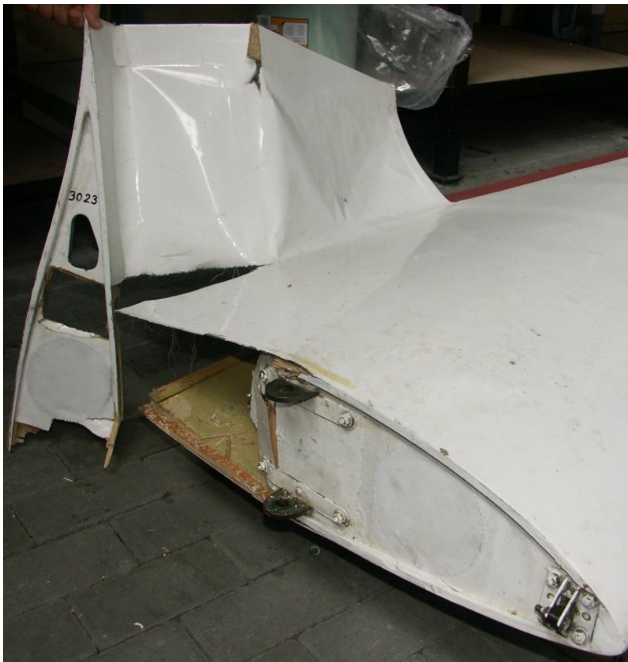
14 – Zniszczenia w okolicy nasady zewnętrznej części lewego skrzydła.
