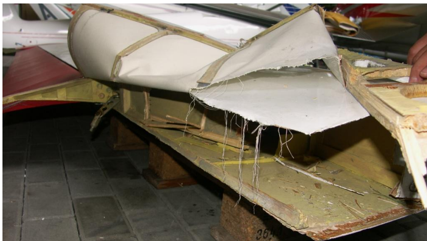
17 i 18 – Zniszczona struktura splayowej części lewego skrzydła przy nasadzie oraz zbliżenie na końcówkę zerwanego popychacza napędu lotki, pozostała przy dźwigni napędu lotki.
