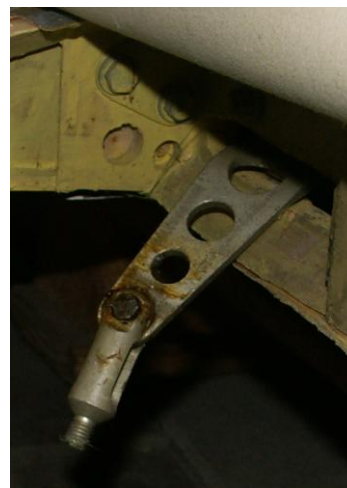
17 i 18 – Zniszczona struktura splayowej części lewego skrzydła przy nasadzie oraz zbliżenie na końcówkę zerwanego popychacza napędu lotki, pozostała przy dźwigni napędu lotki.
