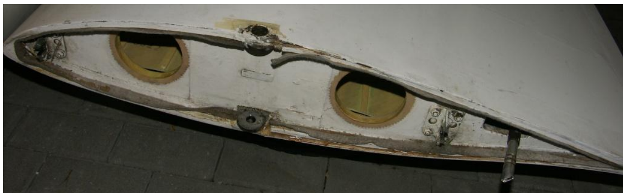
12 – Lewe żebro końcowe centroplata po demontażu, widoczne uszkodzenia okuć i zerwany popychacz napędu lotki.
