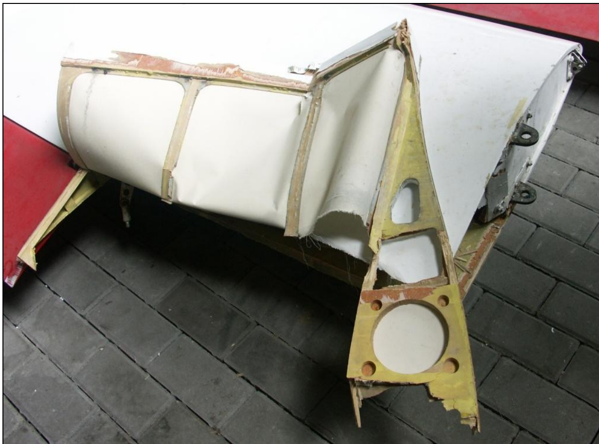
16 – Zniszczona splayowa część lewego skrzydła w okolicy nasady.
