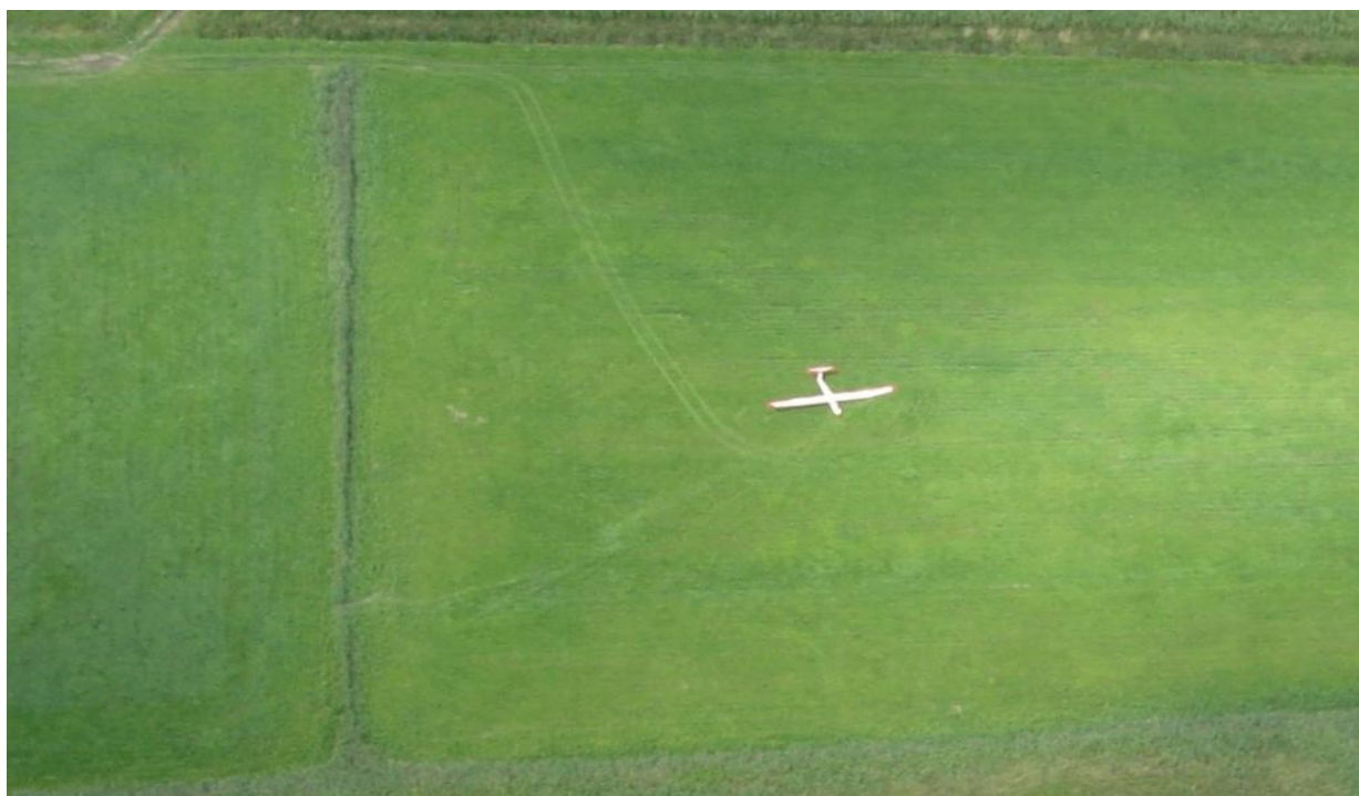
4 – Ogólny widok szybowca na miejscu wypadku – widoczne ślady przyziemienia i dobiegu, zdjęcie lotnicze.
