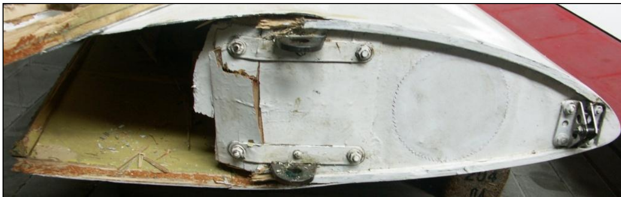
15 – Żebro nasadowe lewego skrzydła, widoczne zniszczenia struktury i uszkodzenia okuć.
