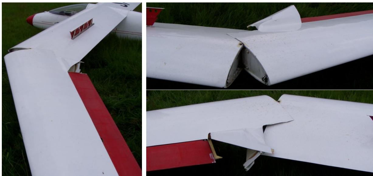
9, 10 i 11 – Złamanie lewego skrzydła szybowca w różnych ujęciach, stan z miejsca wypadku.
