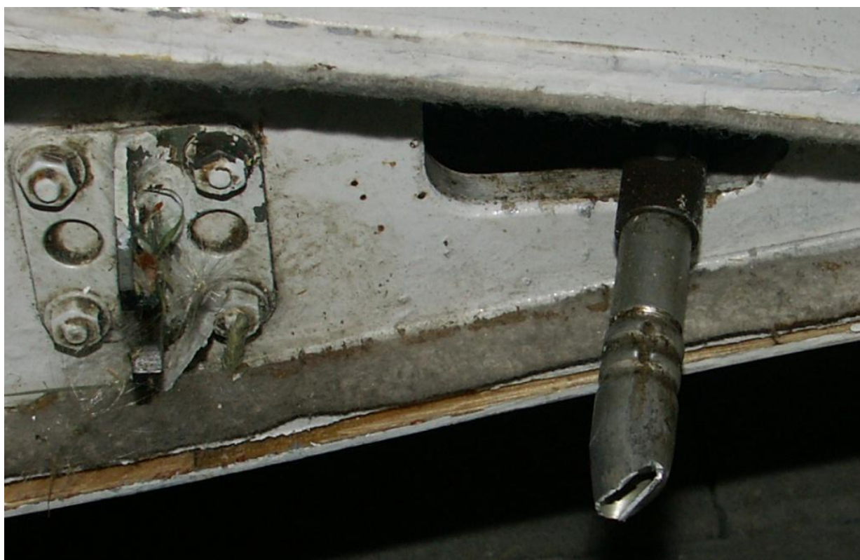
13 – Zbliżenie zniszczonego okucia tylnego na żebrze centroplata i zerwanego popychacza napędu lotki.
