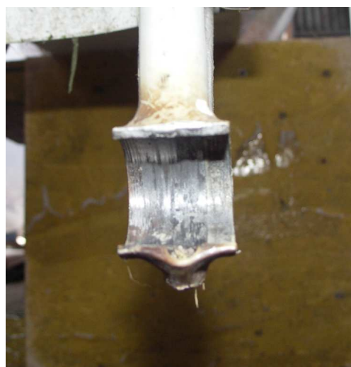
Rys. 8 Zbliżenie na przełom tulejki
