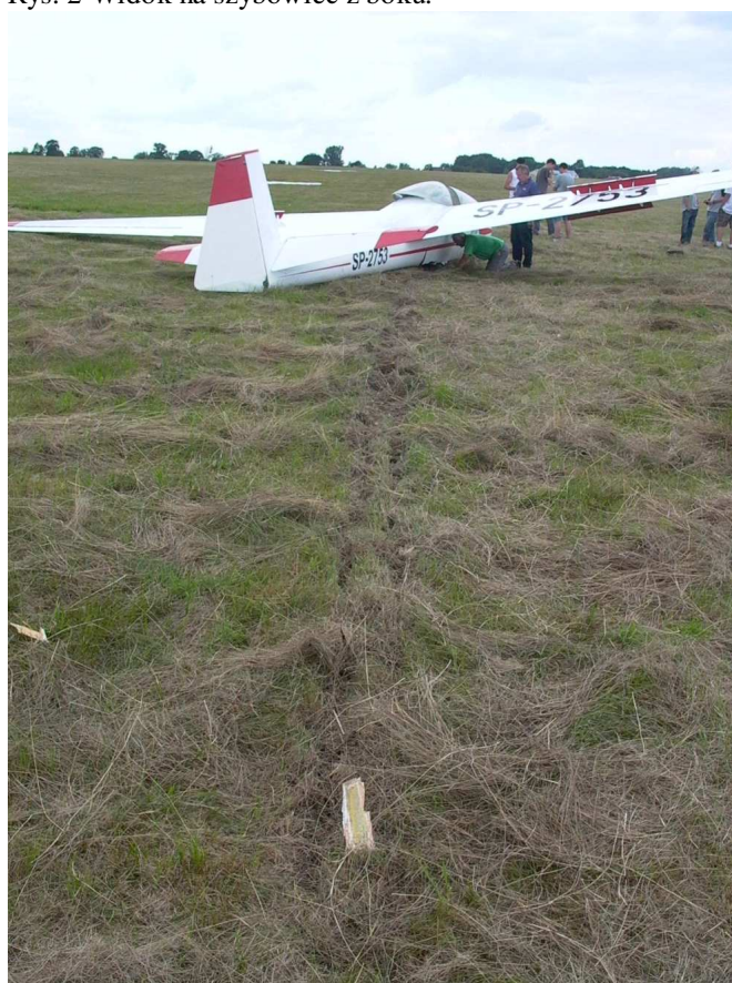
Rys.4 Widoczny ślad wryty w ziemi kratownicą podwozia oraz kawałki pokrycia sklejkowego kadłuba.
