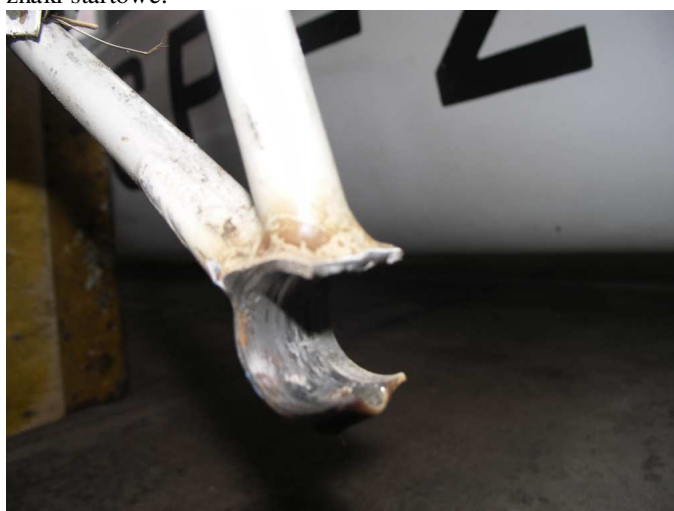
Rys. 7 Goleń wahacza – widoczna tulejka mocowania osi koła z wyrwaną częścią obwodu.
