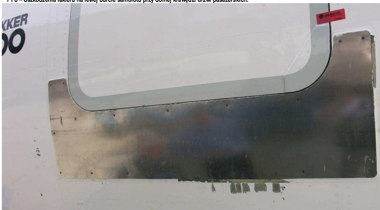
7 i 8 – Uszkodzenia lakieru na lewej burcie samolotu przy dolnej krawędzi drzwi pasażerskich.
