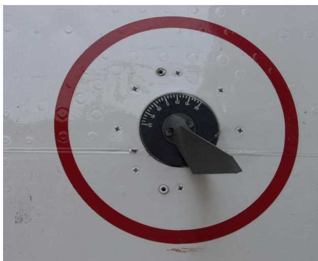
9 i 10 – Skrzydełkowy nadajnik kąta natarcia.
