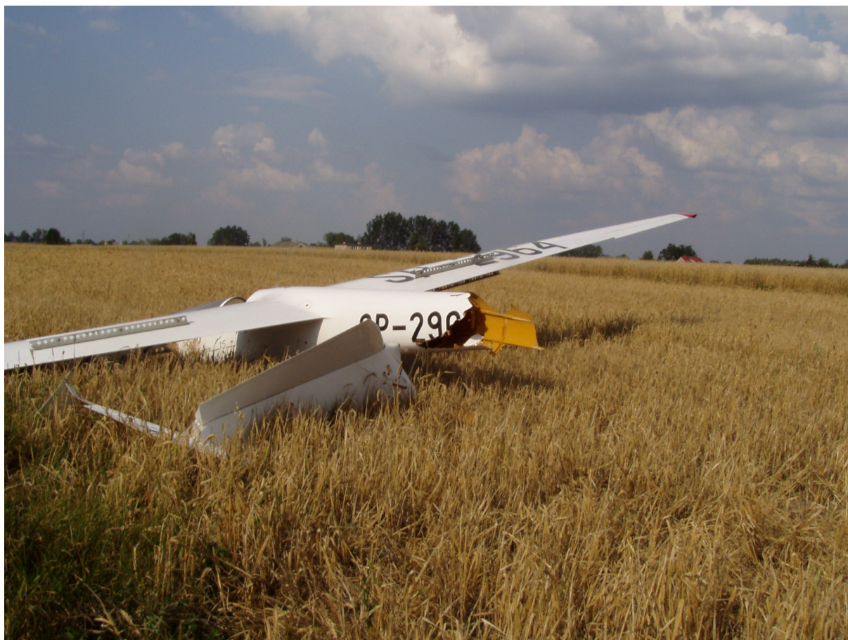
Fot. 1 Widok uszkodzeń szybowca po obrocie w lewo
