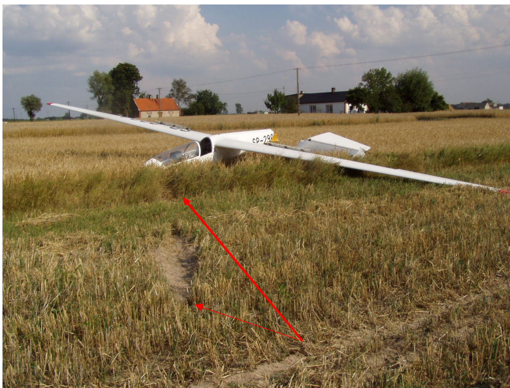
Fot. 3 Zdjęcie w kierunku 45° od zamierzonego kierunku lądowania. Wyraźnie widoczny ślad bocznego przesuwania się kółka podwozia.
