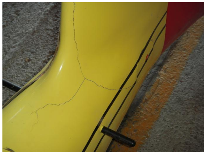
Rys. 7 Pęknięte pokrycie belki i statecznika
