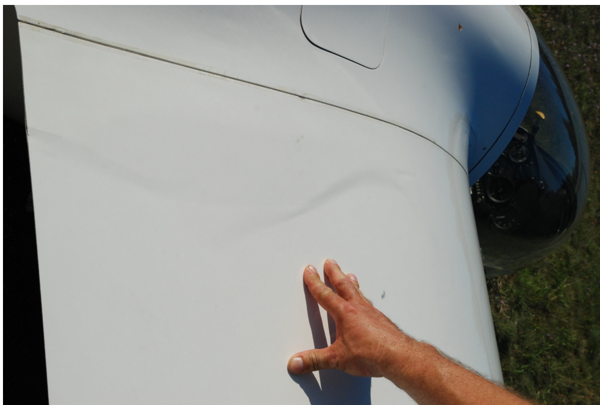
Fot. 4 Widok pękniętego górnego pokrycia skrzydła oraz rozwarstwionej krawędzi spływu.
