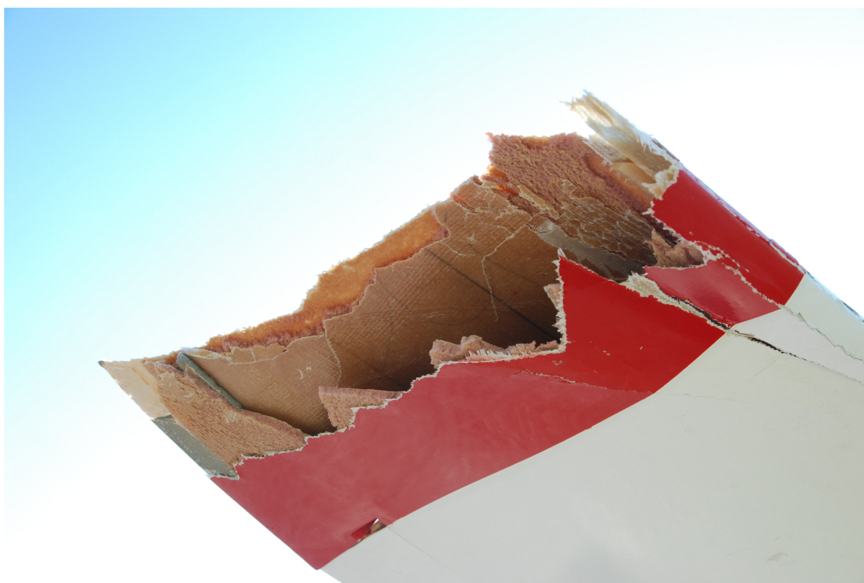
Fot. 2 Uszkodzona końcówka skrzydła
