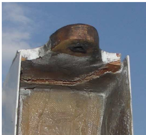
5 – Usterzenie szybowca ze zdemontowanym sterem kierunku, widoczne uszkodzenie pokrycia lewego segmentu steru wysokości.
