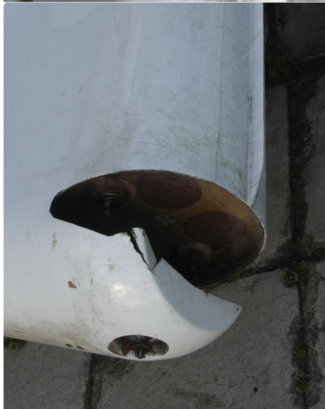
8 i 9 – Uszkodzenia górnego (u góry) i dolnego (u dołu) węzła zawieszenia steru kierunku.
