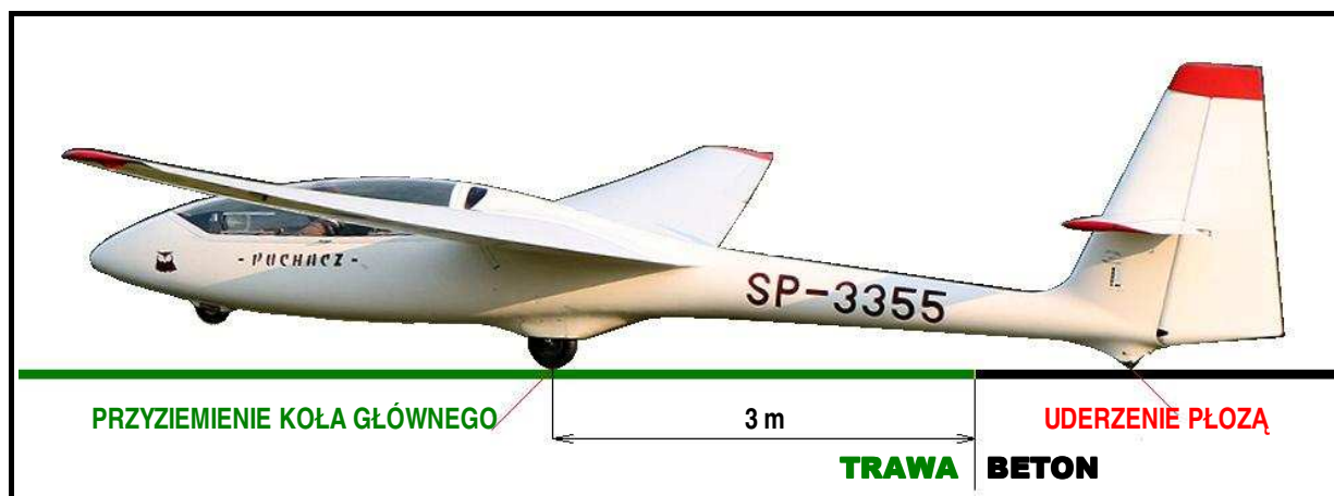
3 – Schemat przyziemienia szybowca, wyjaśniający przyczynę powstałych uszkodzeń.
