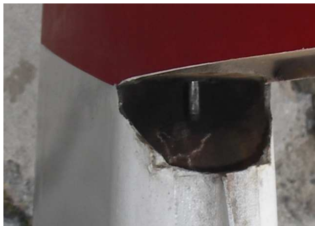
5 – Usterzenie szybowca ze zdemontowanym sterem kierunku, widoczne uszkodzenie pokrycia lewego segmentu steru wysokości.
