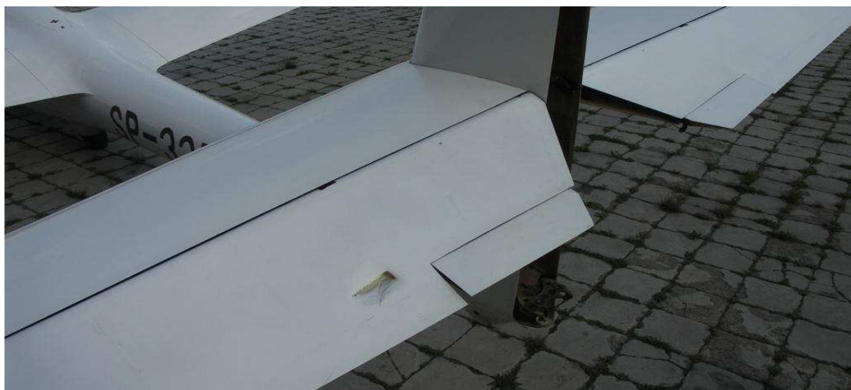
5 – Usterzenie szybowca ze zdemontowanym sterem kierunku, widoczne uszkodzenie pokrycia lewego segmentu steru wysokości.
