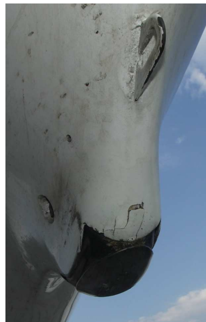
11 – Uszkodzenia płozy tylnej.
