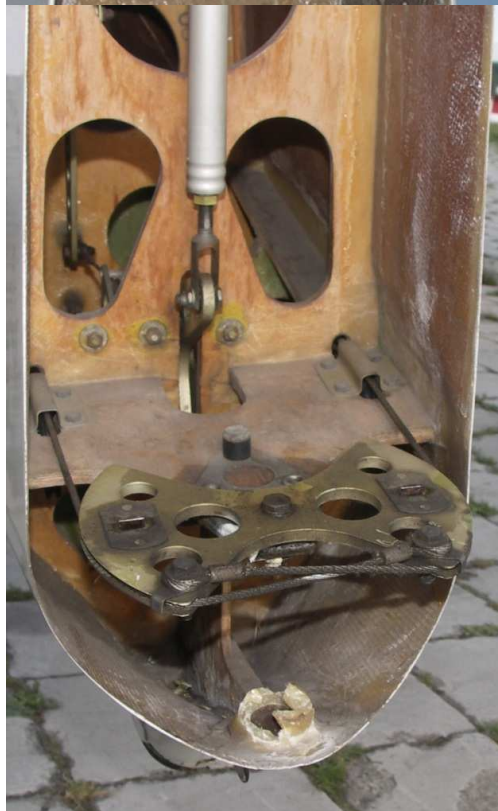
6 i 7 – Uszkodzenia górnego (u góry) i dolnego (u dołu) węzła zawieszenia steru kierunku na stateczniku.
