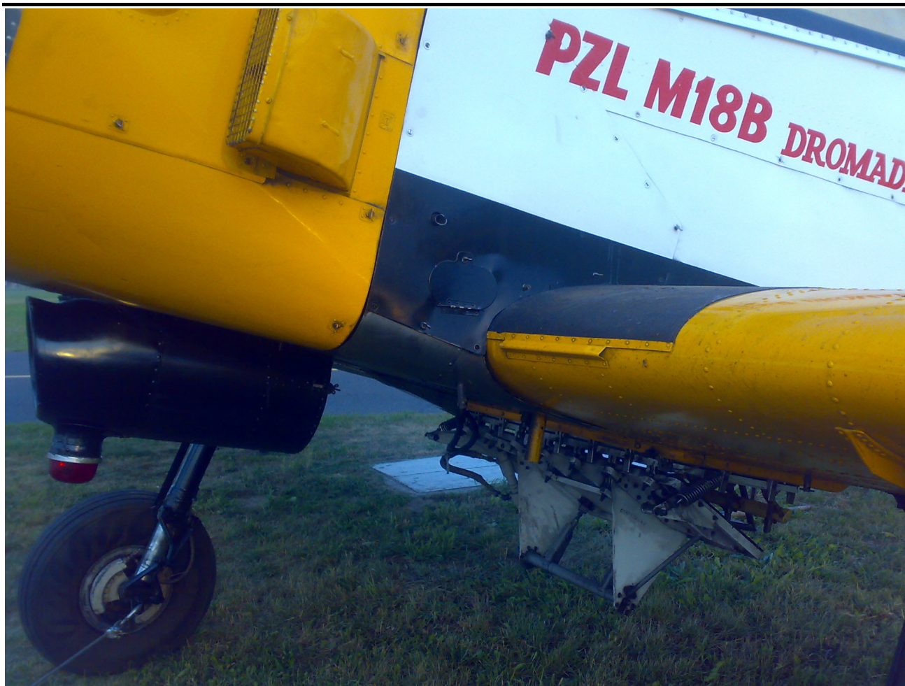
10. – Zniszczone poszycie kadłuba, widok z lewej strony.
