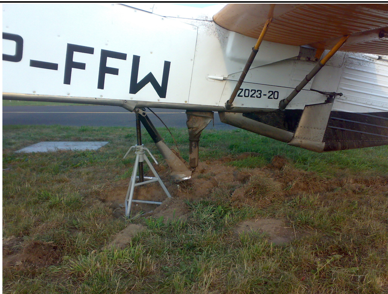
5. – Urwane koło podwozia tylnego samolotu.
