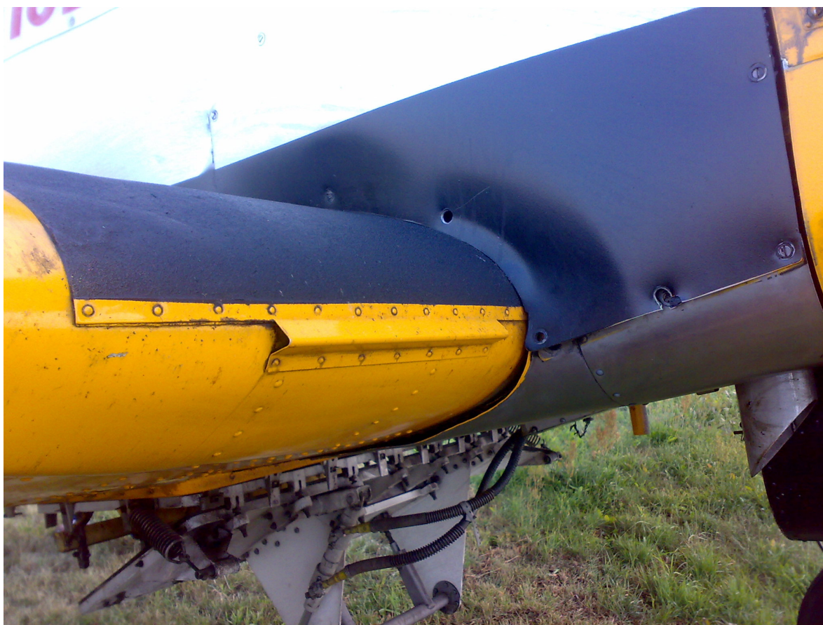
9. – Zniszczone połączenie nitowe na poszyciu kadłuba, widok z prawej strony
