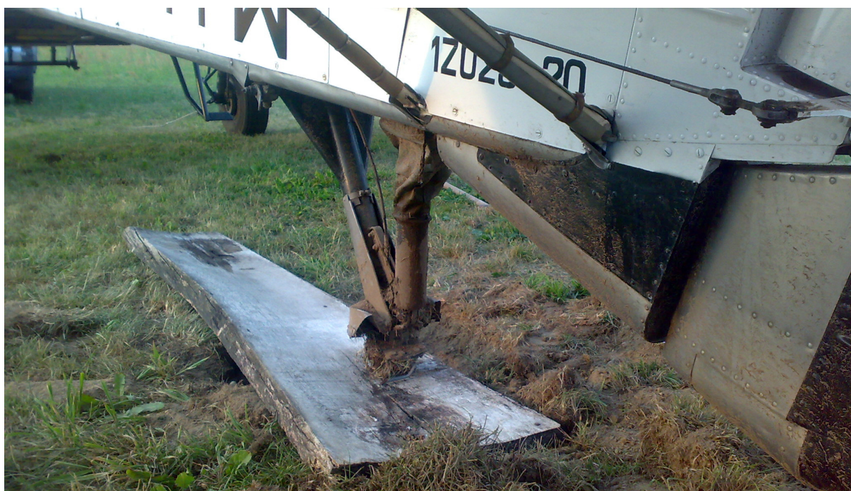
Fot. 2 Goleń kółka ogonowego z urwanym widelcem
