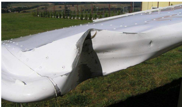
6 i 7 – Uszkodzenia płyty usterzenia od przodu i od spodu (po prawej).
