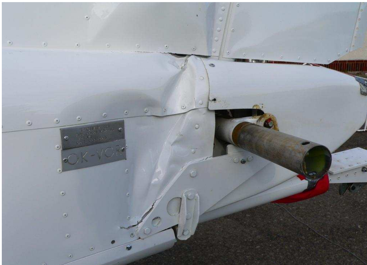
8 – Uszkodzenia tylnej części kadłuba, lewa strona.
