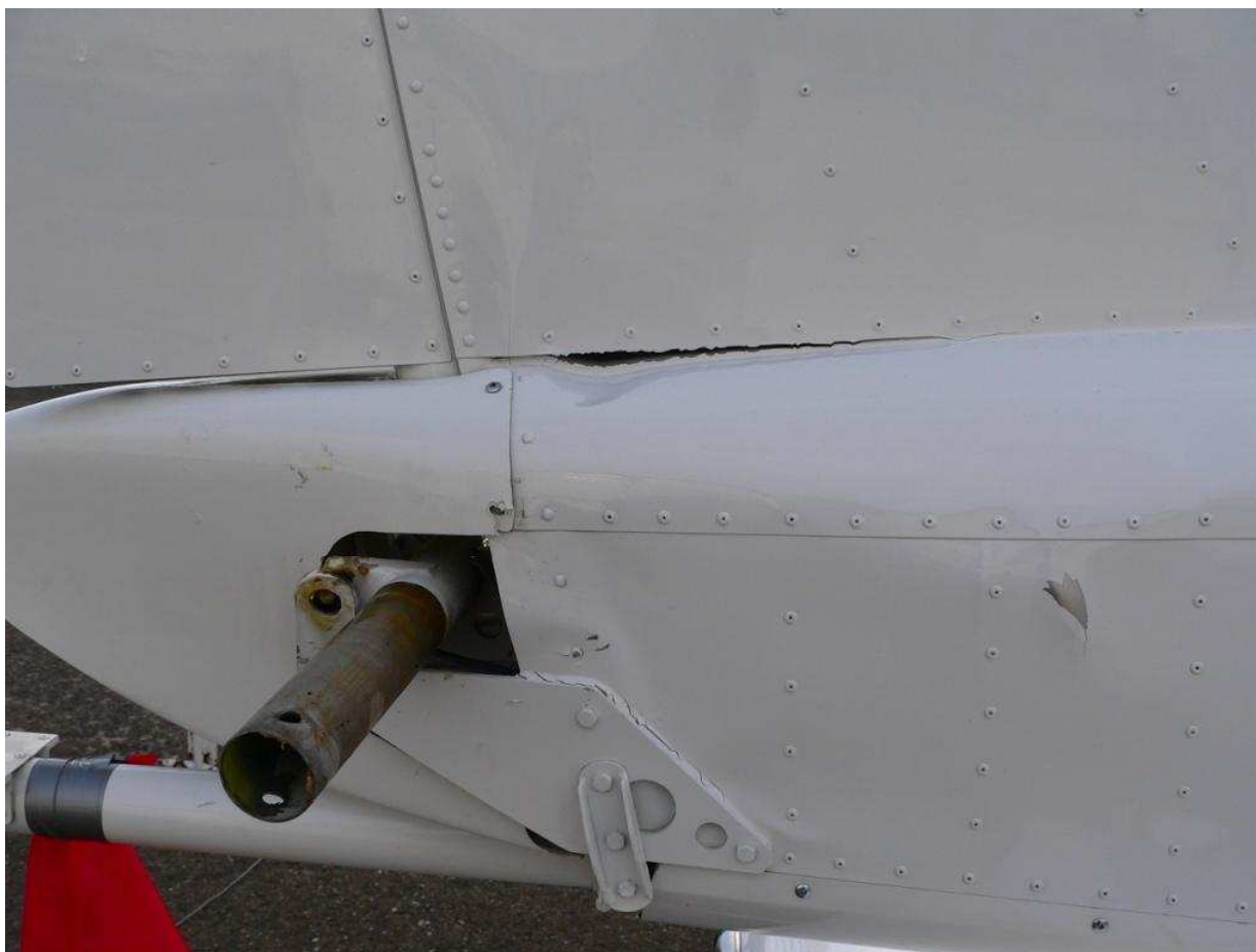
15 – Uszkodzenia tylnej części kadłuba, prawa strona.
