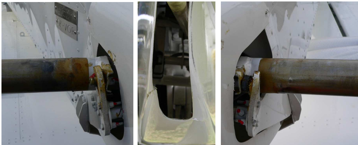
12, 13 i 14 – Z lewej i z prawej uszkodzenia okuć mocowania płyty statecznika poziomego, w środku – uszkodzenie owiewki końcowej kadłuba
