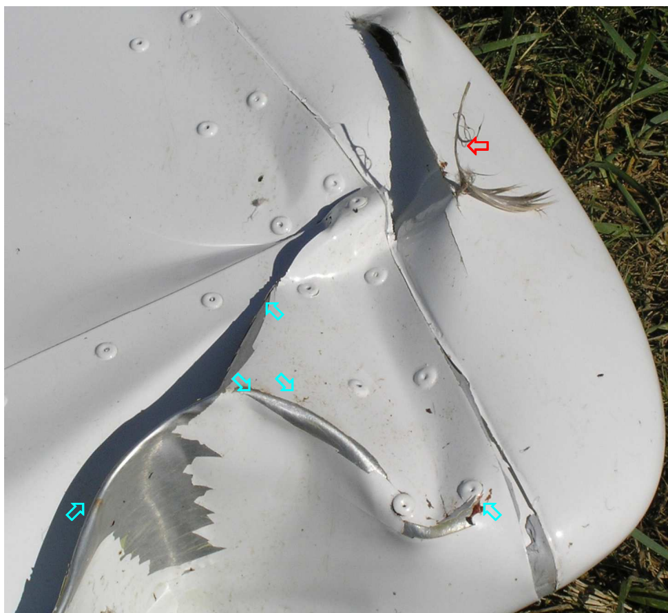
Nosek prawej końcówki płyty usterzenia poziomego, widok od dołu.
