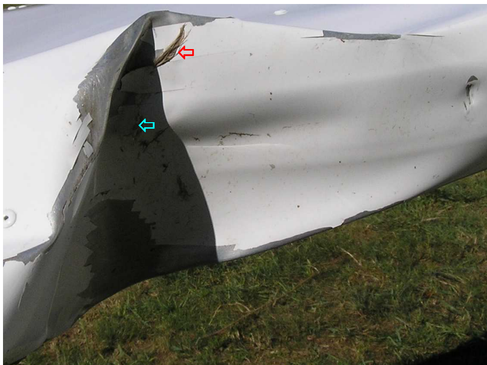
Krawędź natarcia płyty usterzenia poziomego przy prawej końcówce, widok od przodu. Widoczne duże wgłębienie w nosku wskutek zderzenia z korpusem ptaka. Po prawej stronie kadru małe wgłębienie pokrycia – prawdopodobnie skutek zderzenia z czaszką ptaka.
